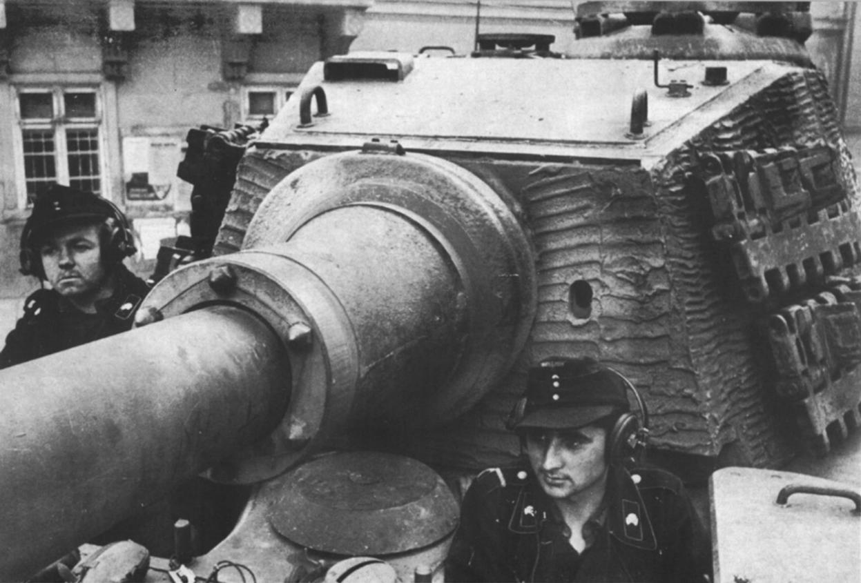
Diese Aufnahme läßt besonders gut Einzelheiten des Kruppturnes erkennen. Vorn rechts der Fahrer, links der Funker und Schütze des Bug-MG (BA).
