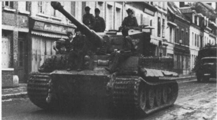
Oben: Ein Tiger I mit Stahllaufrollen. Sie kamen wegen Gummimangel bei dem späteren Tiger I (und II) zum Einbau. Weitere Abbildungen davon sind in den Bänden 1 (Seiten 42 und 44), sowie 31 (Seiten 23 und 39) zu finden (BA).
