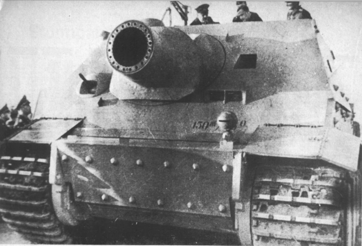
Oben: Hier wird ein Prototyp des Sturmpanzer IV vorgeführt (20. 10. 1943). Die Gasaustrittslöcher zwischen dem Innenfutter und Außenmantel des Werfers sind geringer an Zahl und kleiner. Außerdem zeigt er eine aufgenietete zusätzliche Bugpanzerung. An Hitler und seiner Begleitung im Verhältnis zum Sturmpanzer ist gut die Größe des Sturmpanzers zu erkennen (N).
