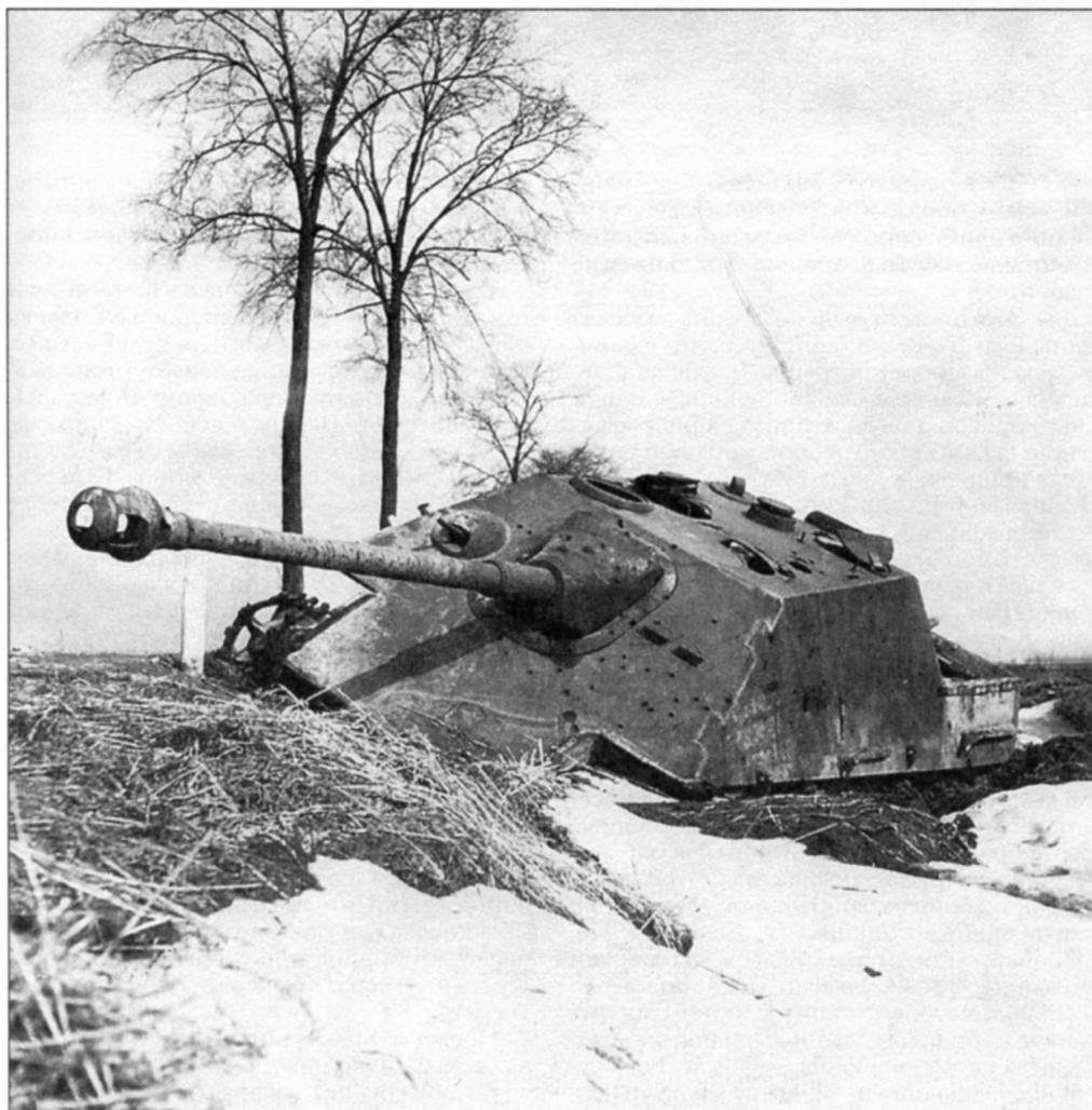
Сгоревшая «Ягдпантера». Обращают на себя внимание два перископа механика-водителя, как у машин самого раннего выпуска, и характерный для более поздних моделей составной ствол 88-мм пушки. Венгрия, март 1945 года
