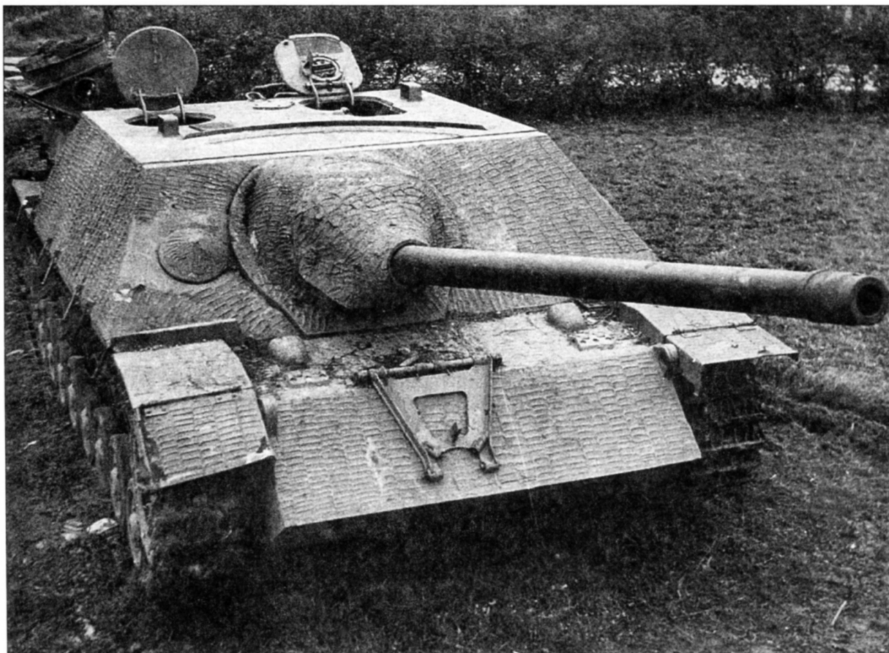
Истребитель танков Panzer IV/70 производства фирмы Vomag
