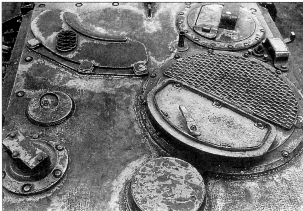
Крыша рубки «Ягдтигра». Вверху справа — командирская башенка с лючком для сте-реотрубы, перед ней — посадочный люк командира, вверху слева — ду-гообразная амбразура перископического прицела
