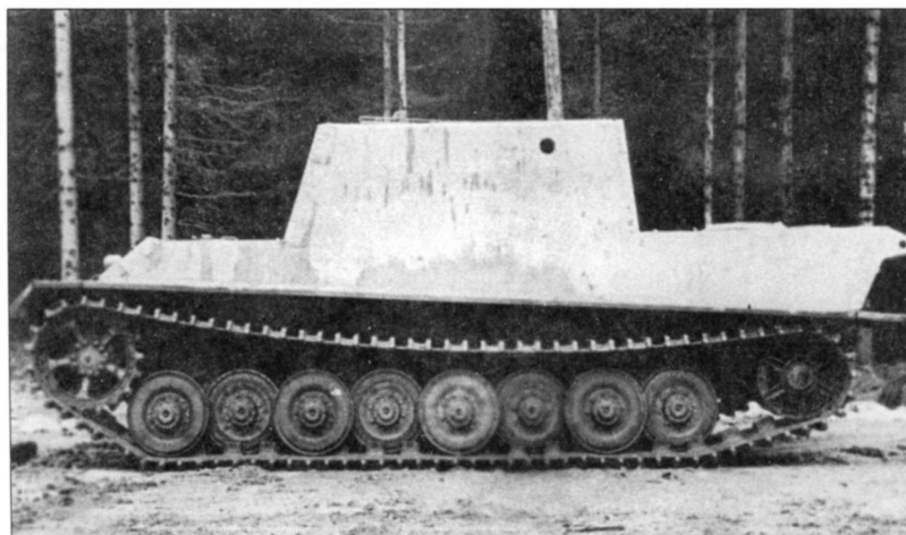
Прототип «Ягдтигра» с ходовой частью конструкции Ф. Порше на полигоне. Вооружение еще не установлено. Весна 1944 года
