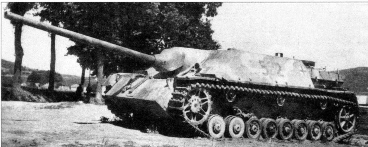
Panzer IV/70 поздних выпусков, о чем можно судить по двум передним необрезиненным опорным каткам
