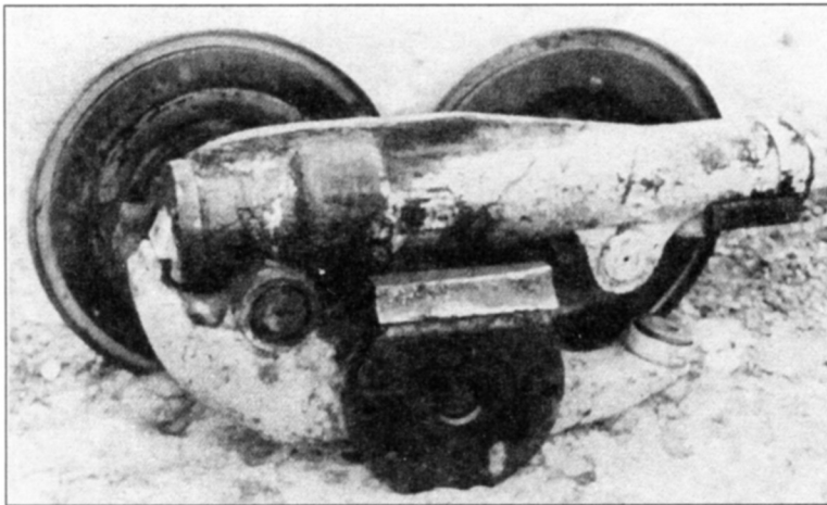
Общий вид тележки подвески конструкции Ф.Порше (слева и в центре), сломавшейся во время испытаний из-за некачественного материала
