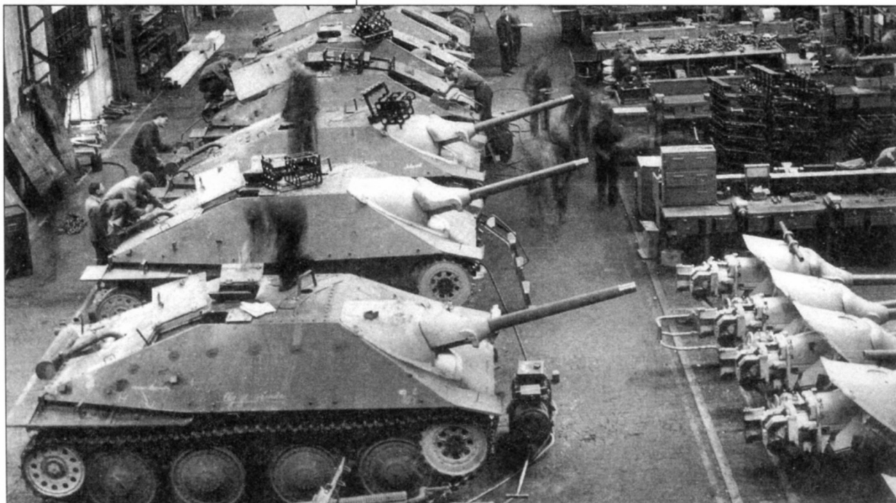
Сборка серийных САУ Jagdpanzer 38 Hetzer в цеху завода фирмы ВММ. 19 июня 1944 года
