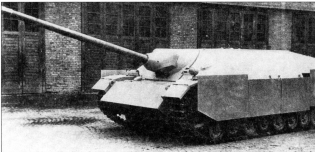
Прототип истребителя танков Panzer IV/70(V) во дворе завода
