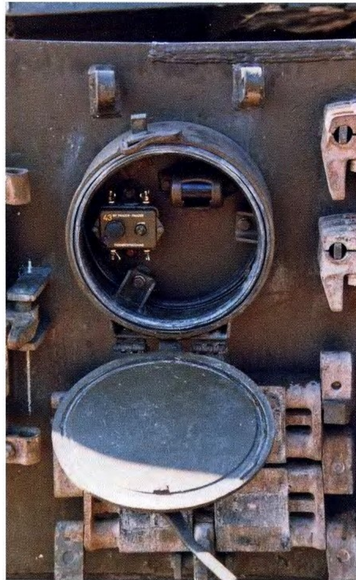
Die runde Ausführung wird nach unten geklappt und kam ab dem 2. Baulos für alle weiteren Ausführungen zum Einsatz. (HH) The circular-shaped version of the infantry telephone's cover is tilted down and was first introduced with the 2 nd and all the following batches.
