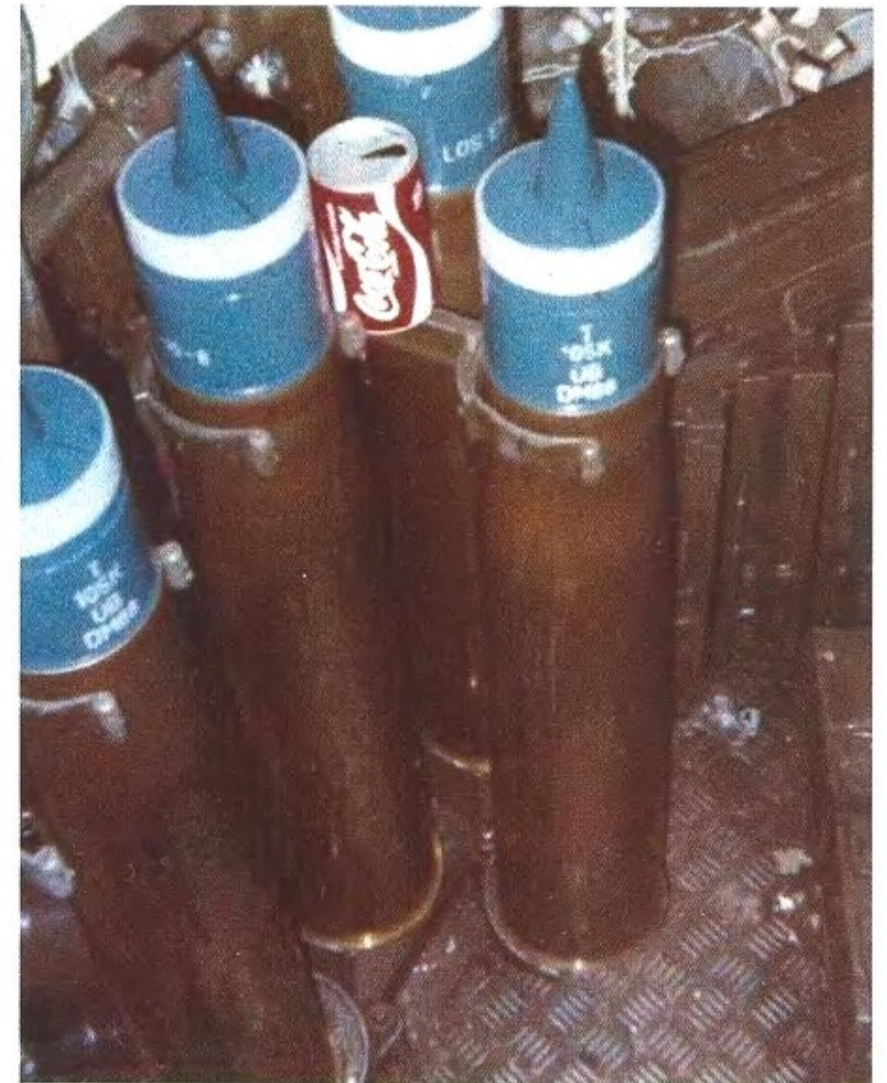
APDS Üb, als panzerbrechende Munition, wiederum in den Bereitschaftsmunitionshalterungen. Sie wurde durch die APFSDS ersetzt, welche flügelstabilisiert (FS = fin stabilised) ist, die alte Munition bekam ihren Drall durch die Züge und Felder der Bordkanone. Training round for Armour-Piercing Discarding Sabot ammunition, again as part of the ready ammunition set. This ammunition has been replaced by APFSDS, which adds fin-stabilisation, while the older ammunition received its spin through the lands and grooves of the main gun. (JP)
