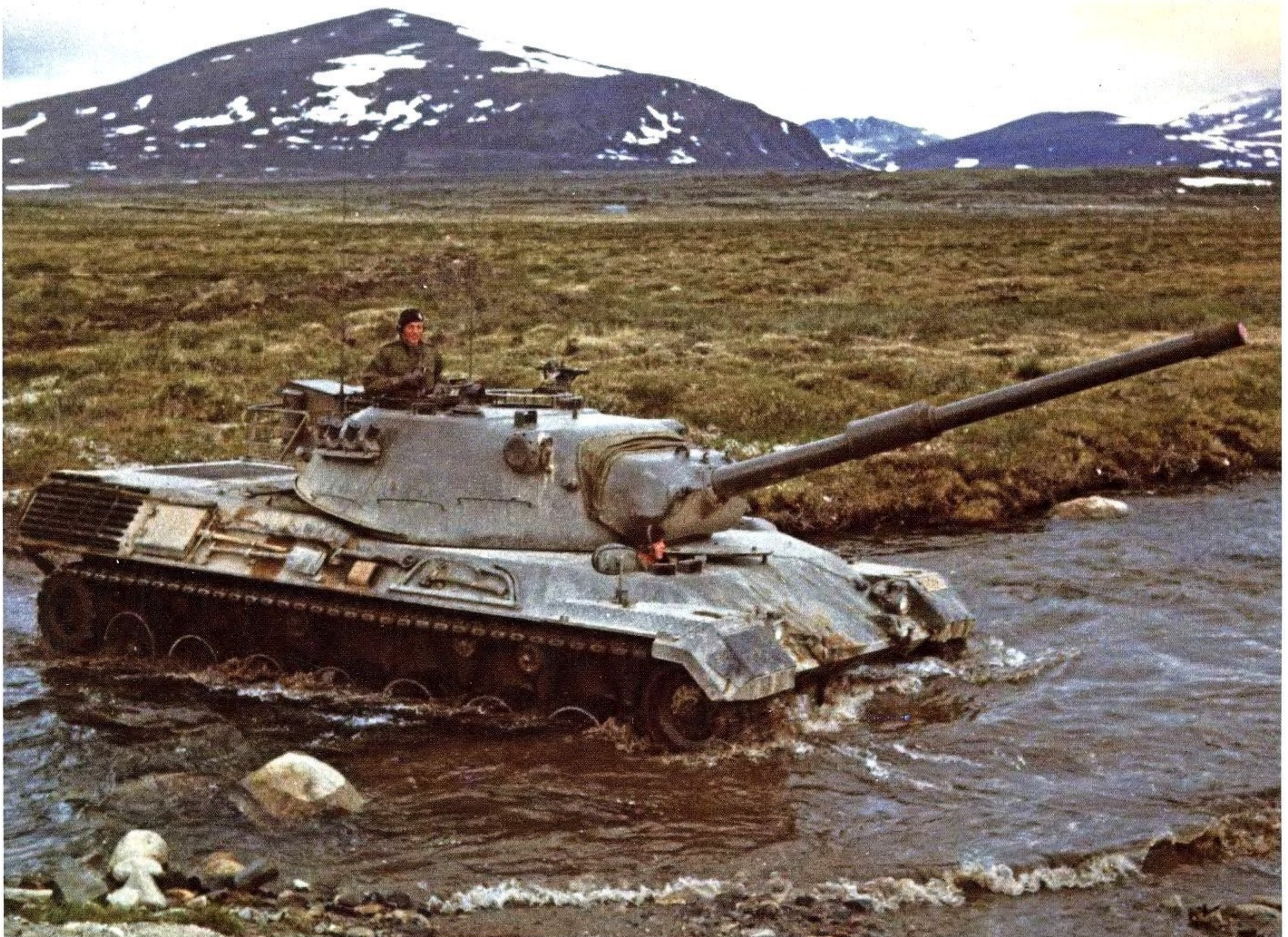
Neben der runden Außenbordsprechstelle wurde ab dem 2. Baulos (600 Stück) eine Regenrinne am Turmheck angebracht. Den ballistischen Schutzring gegen Handwaffenmunition gab es nicht von Anfang an. Abgebildet ist ein früher Leopard 1 des 2. Loses bei Tests in Norwegen 1966/67. Beginning with the 2 nd production batch (600 tanks) all tanks received a circular-shaped infantry telephone box and an additional rain drain on the turret rear. The ballistic protection ring against infantry ball ammunition was not fitted on early vehicles. Shown is such an early Leopard 1 MBT of the 2 nd batch during troop trials in Norway in 1966/67. (KMW)
