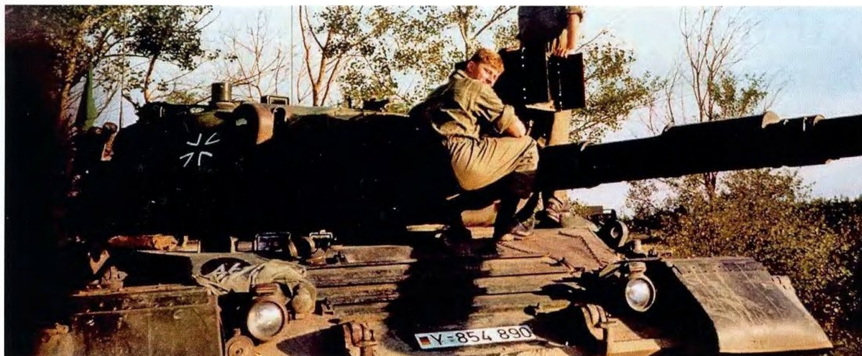
Hier wird an einem Leopard 1A2 in Shilo/Kanada die Nachtkampfbereitschaft hergestellt. Das IR-ZF ist bereits eingebaut, der Scheinwerfer muss noch bei Tageslicht justiert werden. Here the night fighting readiness of a Leopard 1A2 MBT is being established in Shilo/Canada. The IR sight has been fitted already, while the searchlight has still to be aligned during daylight. (HPZ)
