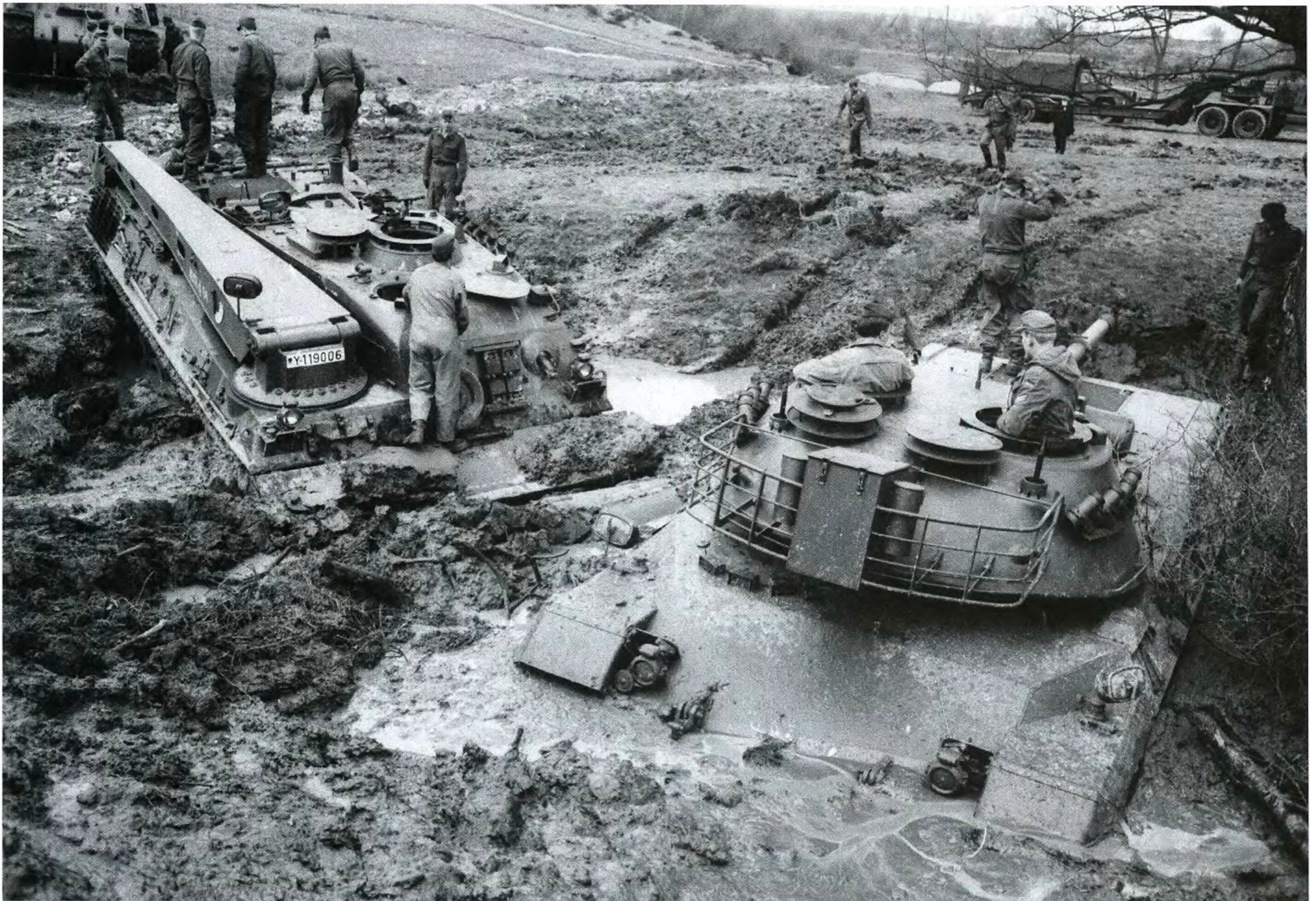
Diese Schlamm Schlacht ist Absicht, da es sich um einen „Berge-Lehrgang“ handelt. Beachte die leere Bugplatte des Leoparden 1. Baulos. This mud battle is intentional, as part of a recovery training course. Note the empty glacis plate of the Leopard of the 1 st production batch. (Bw via HP)
