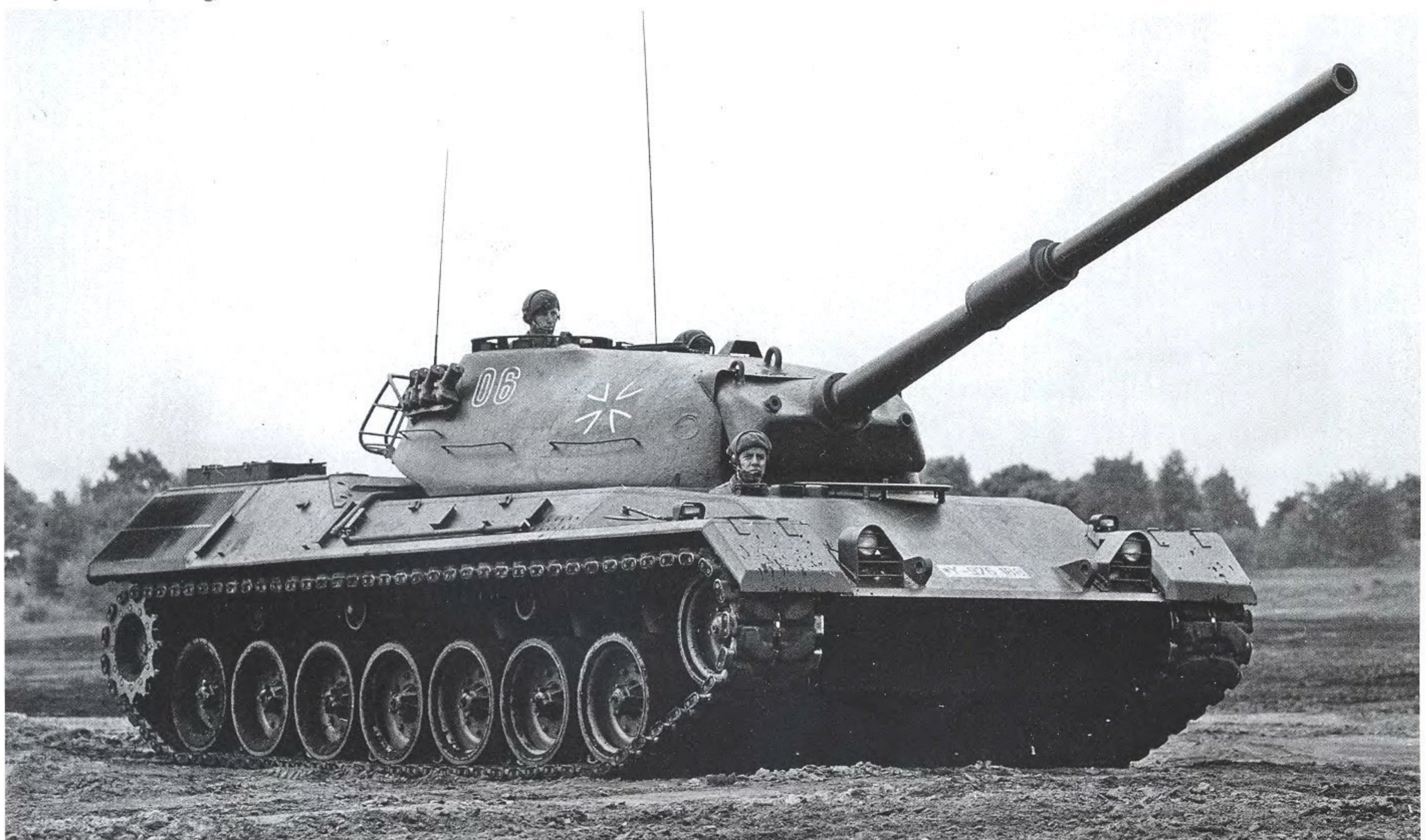
Die Gestaltung der Blende sorgte für Diskussionsstoff, mancher hielt sie für eine ballistische Schwachstelle. Die äußere Form betreffend, fand hier später die größte Änderung statt. Vergleiche dazu die Blenden der Vorserie und Serie. The design of the mantlet caused discussions within the designer community often declaring the mantlet as ballistically inferior. The shape was later changed extensively. Compare the design of this mantlet with that of pre-series and series vehicles. (BMVg)
