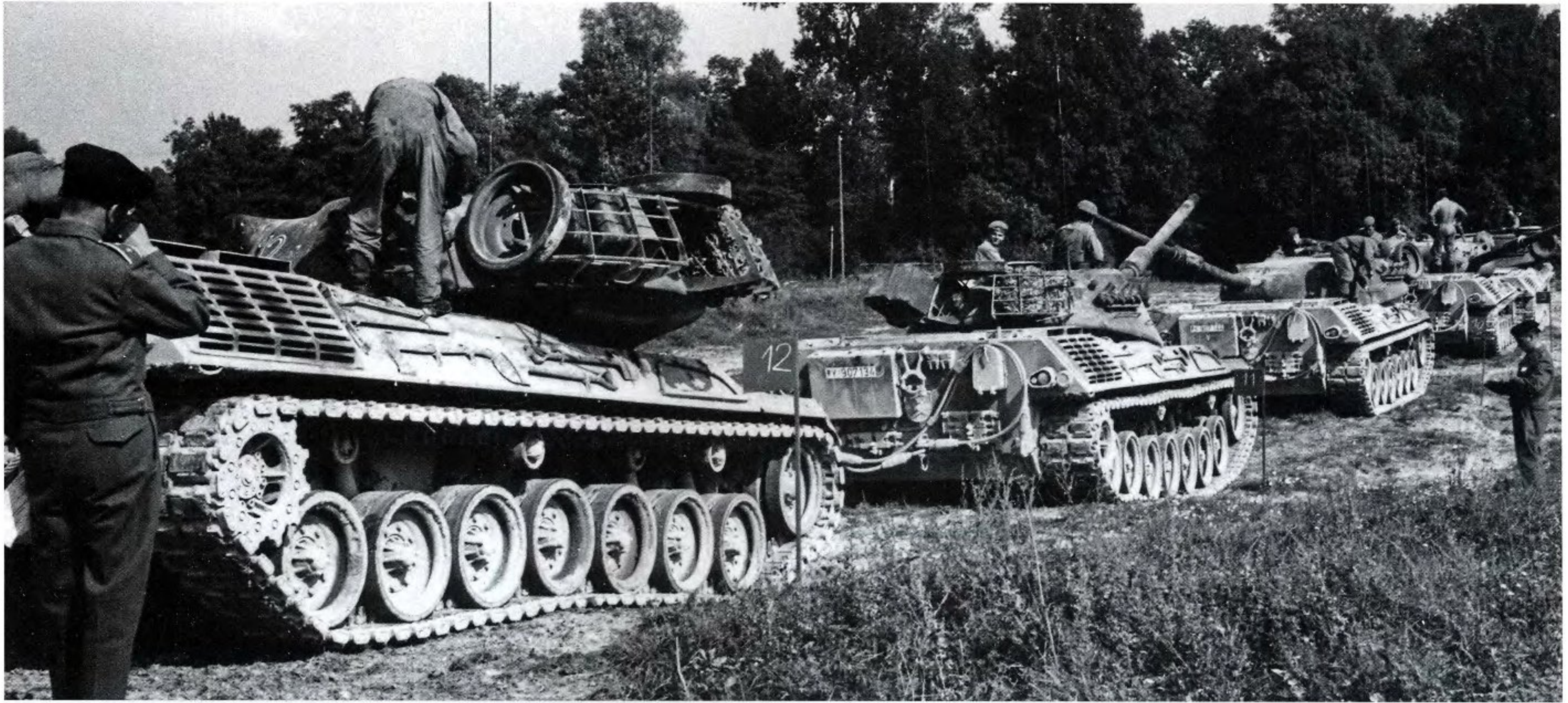
Ausländische Beobachter begutachten die Truppenerprobung von Vorserien Leoparden. Beachte die zusätzlich mitgeführten Laufrollen. Foreign observers watch troop trials of pre-series Leopards. Note the roadwheels carried additionally. (KMW)
