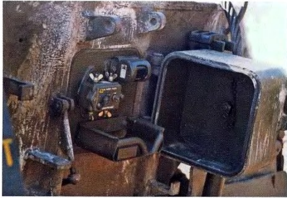
Die für das 1. Baulos typische, eckige Außenbordsprechstelle klappt nach rechts. Der Handapparat fehlt hier. The rectangular infantry telephone box is typical for the 1 st batch and opens to the right side. The hand apparatus is missing here. (HH)
