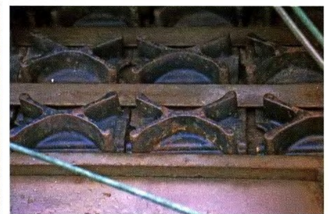
Die X-förmigen Greifer wurden gegen circa jedes neunte Gummipolster aufgetauscht. Die Firma Diehl entwickelte dieses seinerzeit neue und seitdem oft kopierte Verfahren. When fitted the x-shaped grousers replace approximately each ninth rubber pad. At its time company Diehl had developed this grouser design, often copied since.
