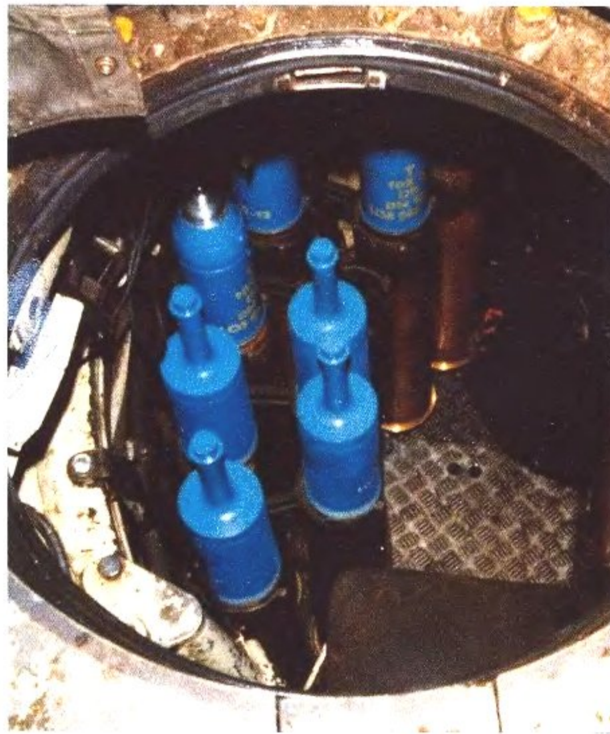
Blick durch die Ladeschützenluke auf die am Rand der Drehbühne aufrecht gelagerten Patronen. Die blauen Gefechtsköpfe weisen sie als Übungsmunition aus. 13 Patronen können derart gelagert werden. View through the loader's hatch onto rounds stowed in the standing position of the turret basket. The blue heads indicate training rounds. 13 rounds can be stowed this way. (JP)
