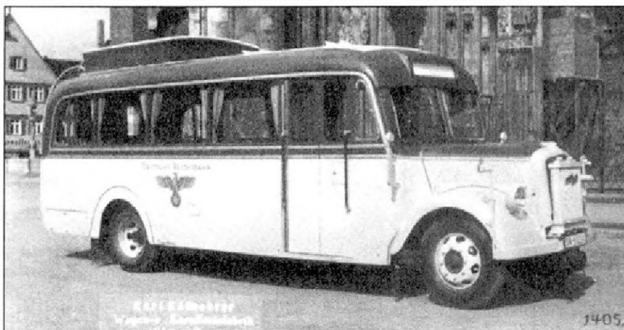
Газогенераторный автобус на шасси Opel 3t
