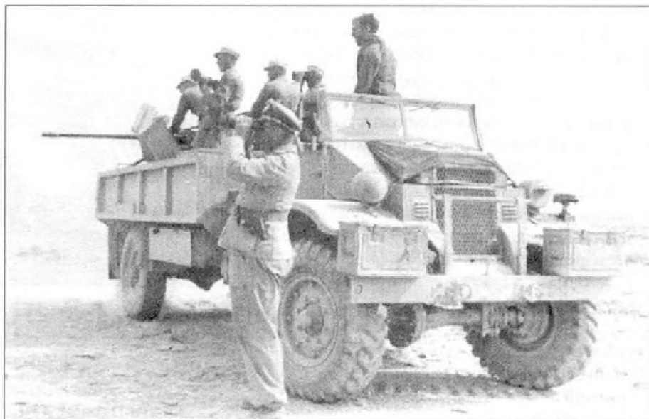
Зенитка 2см Flak 30 установлена в кузове трофейного канадского грузовика СМВ. На машине ни номеров, ни знаков, только флаг со свастикой на капоте. Война в Ливии.
