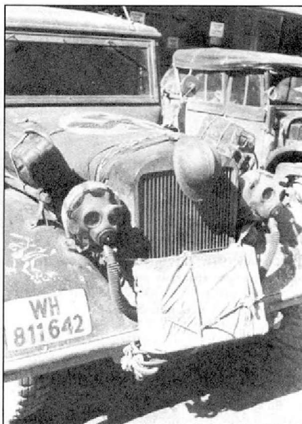
Балканская кампания. Kfz.15 из состава 11-й танковой дивизии. Интересна светомаскировка фар из противогазов. На капоте фашистский флаг для авиационного опознавания.
