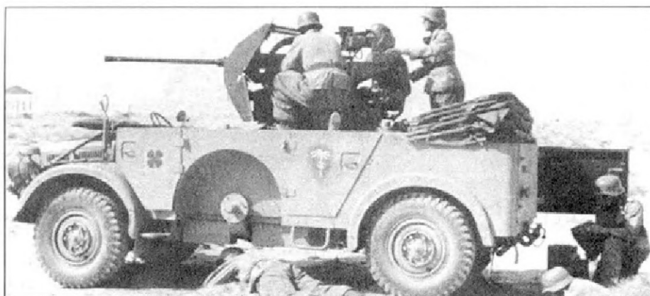
2cm Flak 38, установленная на Horch Kfz. 69 s.E. Pkw, ведет огонь. Машина перекрашена в желто-коричневый цвет, но при покраске «пальма» (эмблема DAK) оставлена на темно-сером фоне. Кадр не пропагандистская демонстрация: на машине нет запасного колеса, свободные члены расчета залегли или пригнулись.
