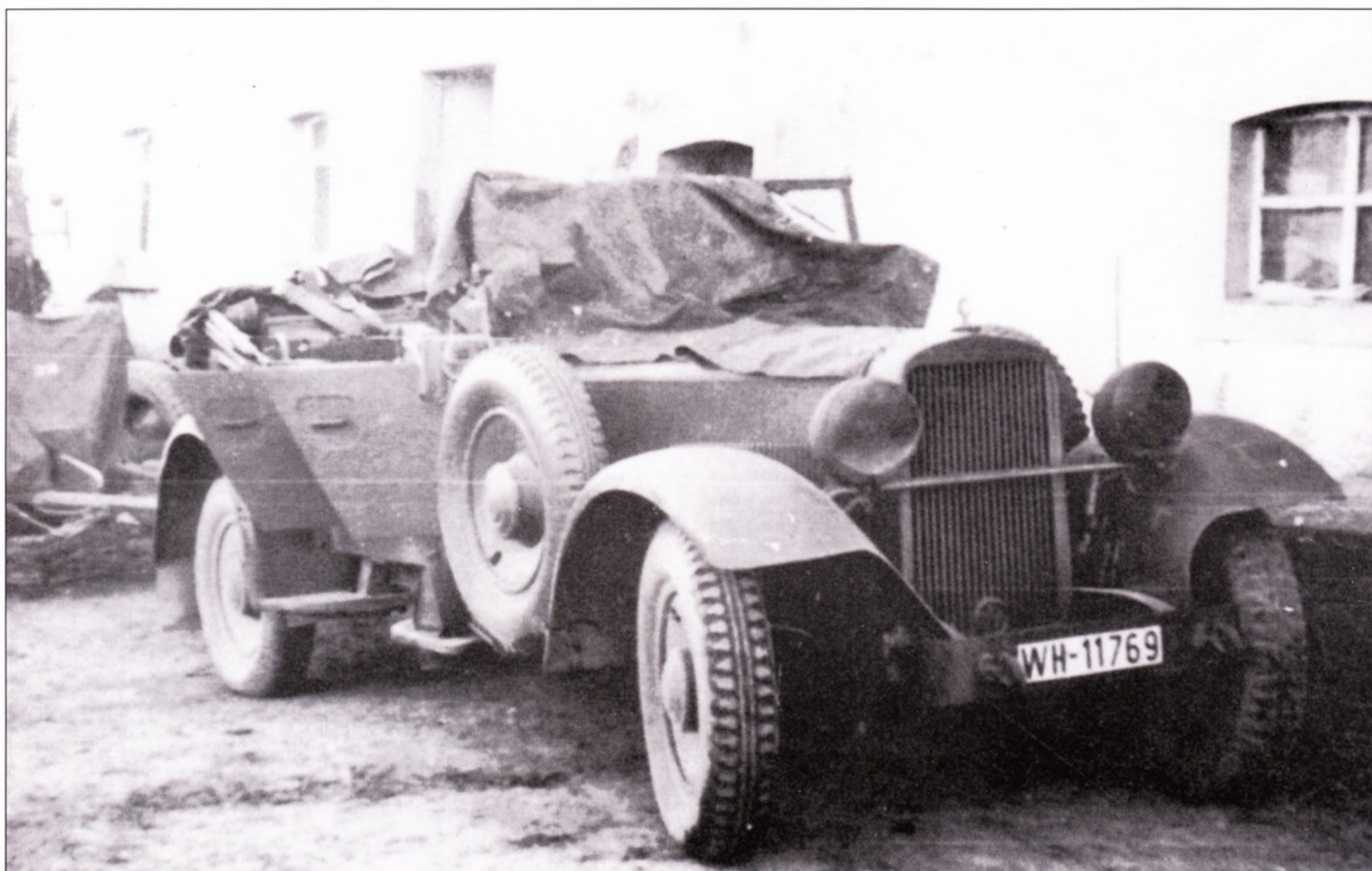
С 1937 по 1941 г.г. было изготовлено более 2700 автомобилей Вандерер W11 с двигателями с объемом цилиндров 3,0 л, от предшественников их отличал как раз более мощный (60 л.с.) и габаритный двигатель. Внешние отличия - скругленный капот мотора и дверцы в кузове.
