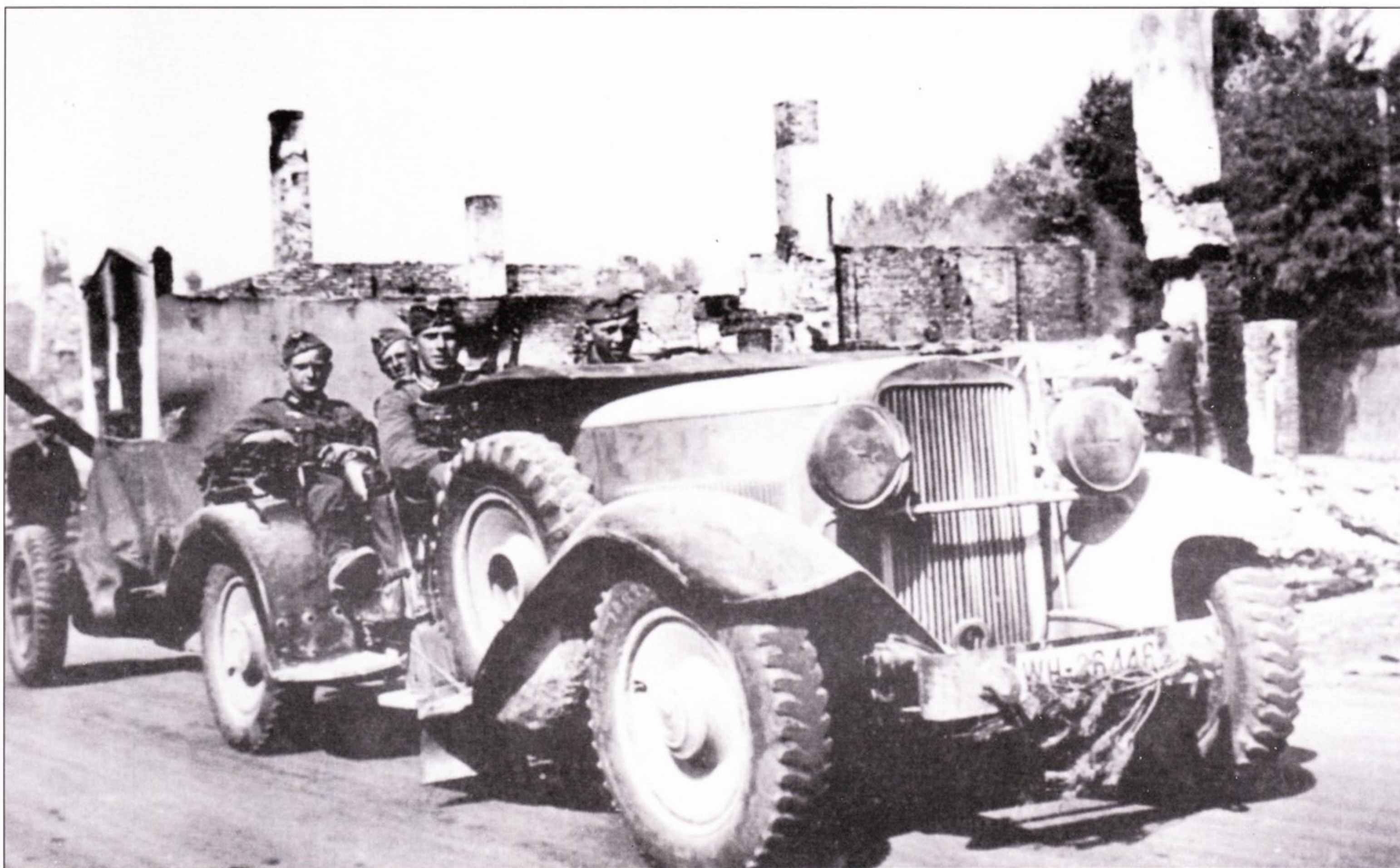
Автомобильный Союз с 1933 по 1936 г.г. произвел более 2800 автомобилей Вандерер W 11 (6-цилиндровый мотор мощностью 50 л.с.). Эти машины использовались, главным образом, для буксировки легких противотанковых пушек. На фото - тягач из 31-го противотанкового батальона, Куков, Польша, 1939 г.
