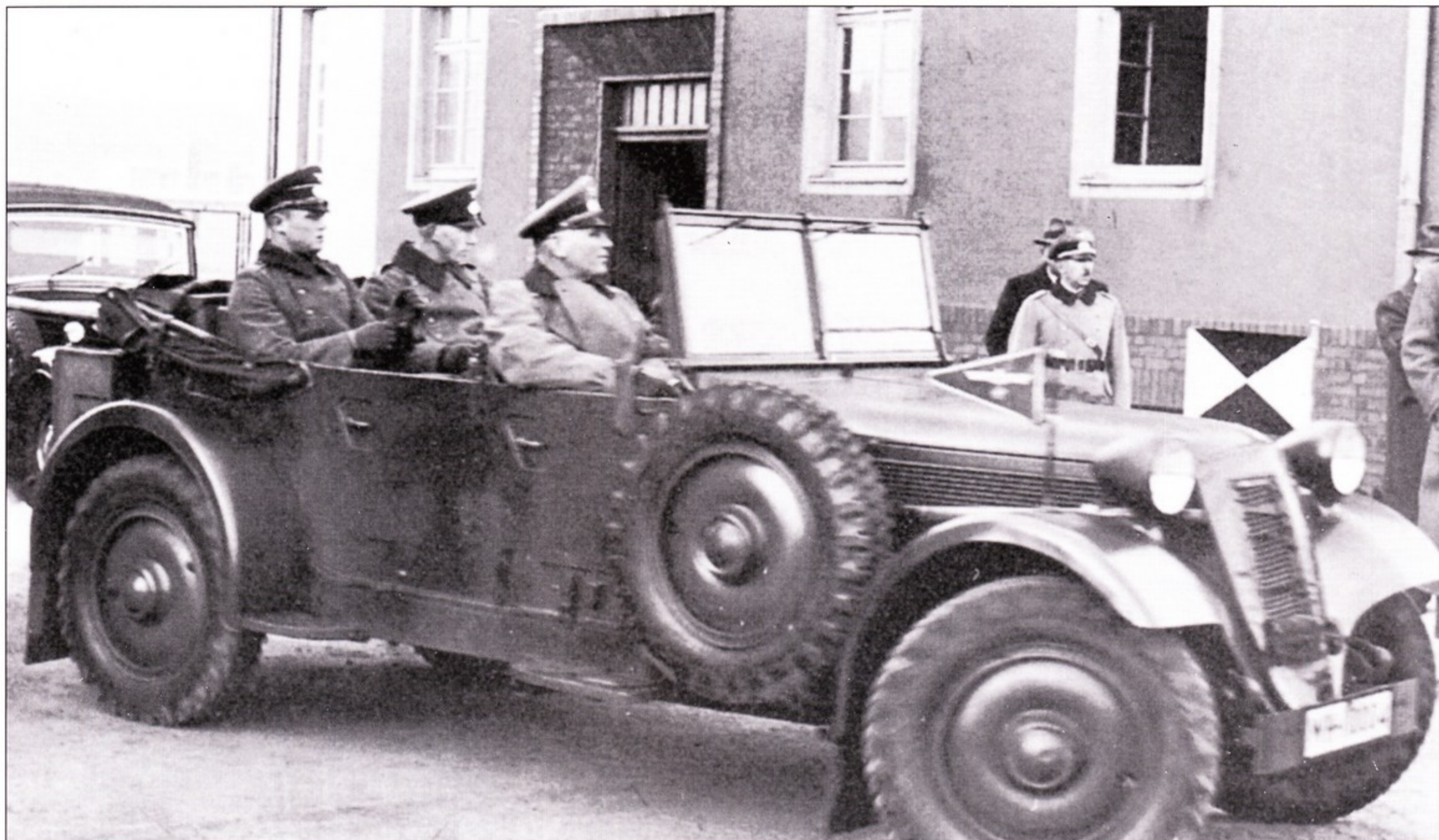
Адлер тип 3 Gd с генералом на борту. Обратите внимание на горизонтальные жалюзи в стенках капота мотора.
