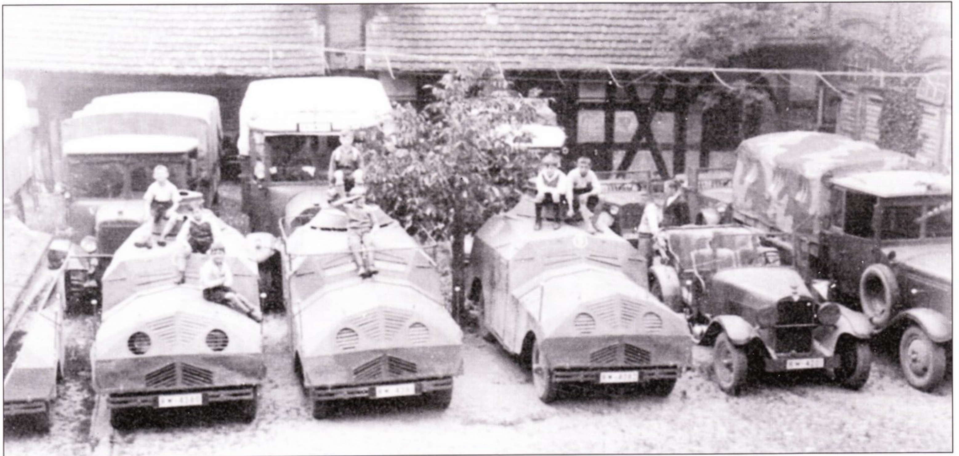
На учениях рейхсвера использовались макеты танков и бронеавтомобилей, что позволяло отрабатывать тактику действий мотомеханизированных подразделений. На фото - имитации бронеавтомобилей на шасси авто Адлер Standard-6, одна машина оборудована радиостанцией (обратите внимание на антенну рамного типа). Справа - обычный Адлер. На заднем плане - автомобили разных типов.
