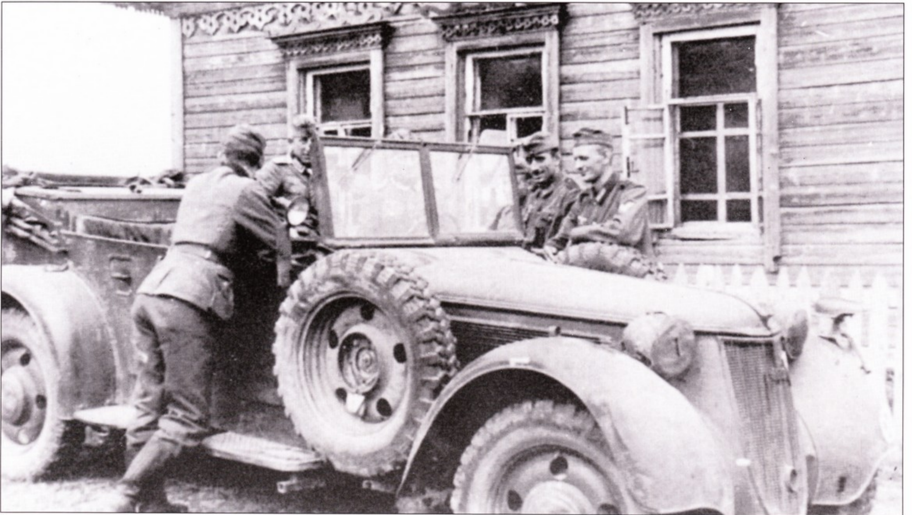
Вандерер W 23S, доработанный из стандартного W 23: тот же мотор мощностью 62 л.с. с усиленной задней осью.
