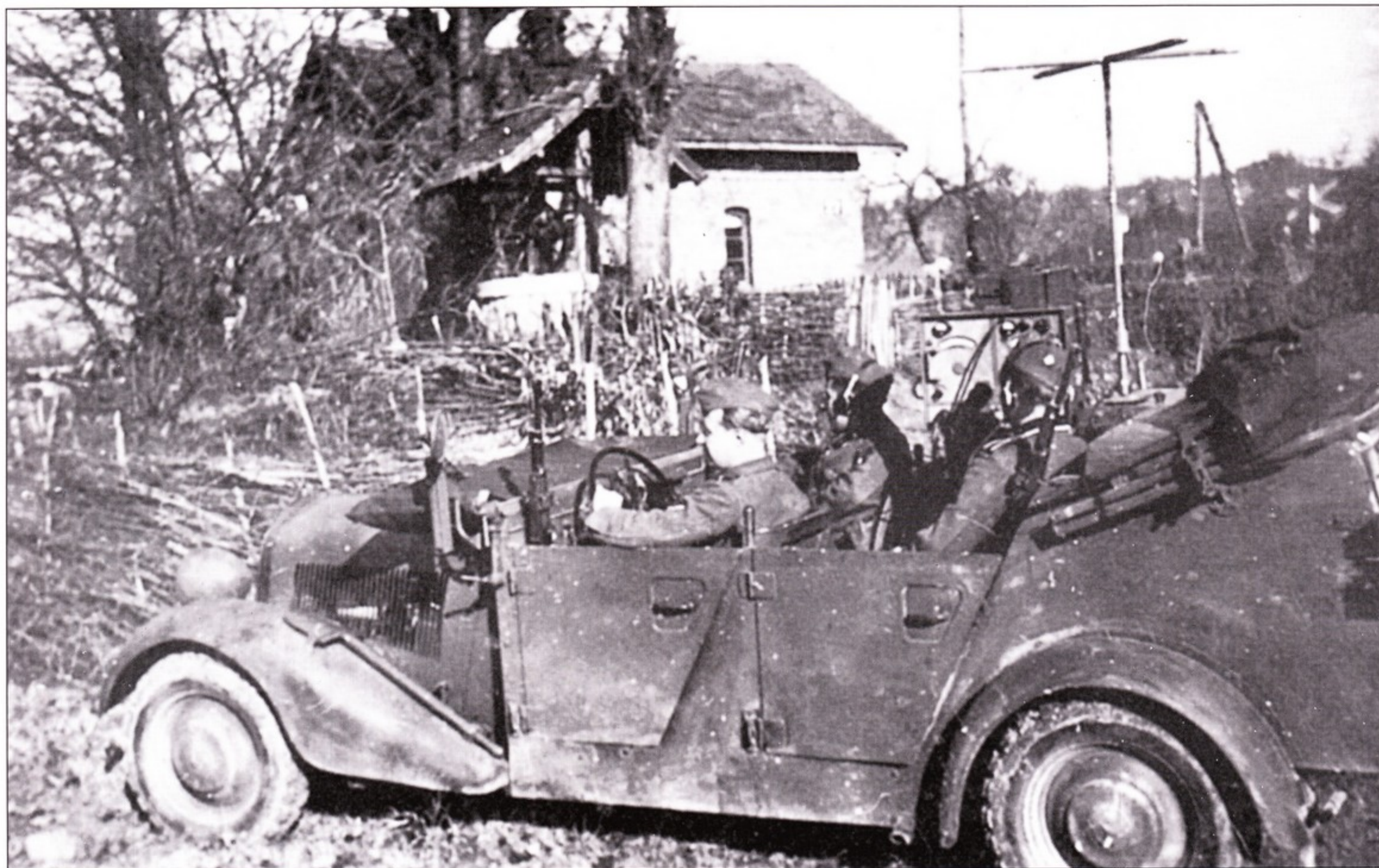
Мерседес-Бенц тип 170 VK в варианте радиомашины (Kfz. 2) Румыния. На вершине антенны смонтирован крест для снижения дальности распространения сигнала - дабы противник не подслушал.
