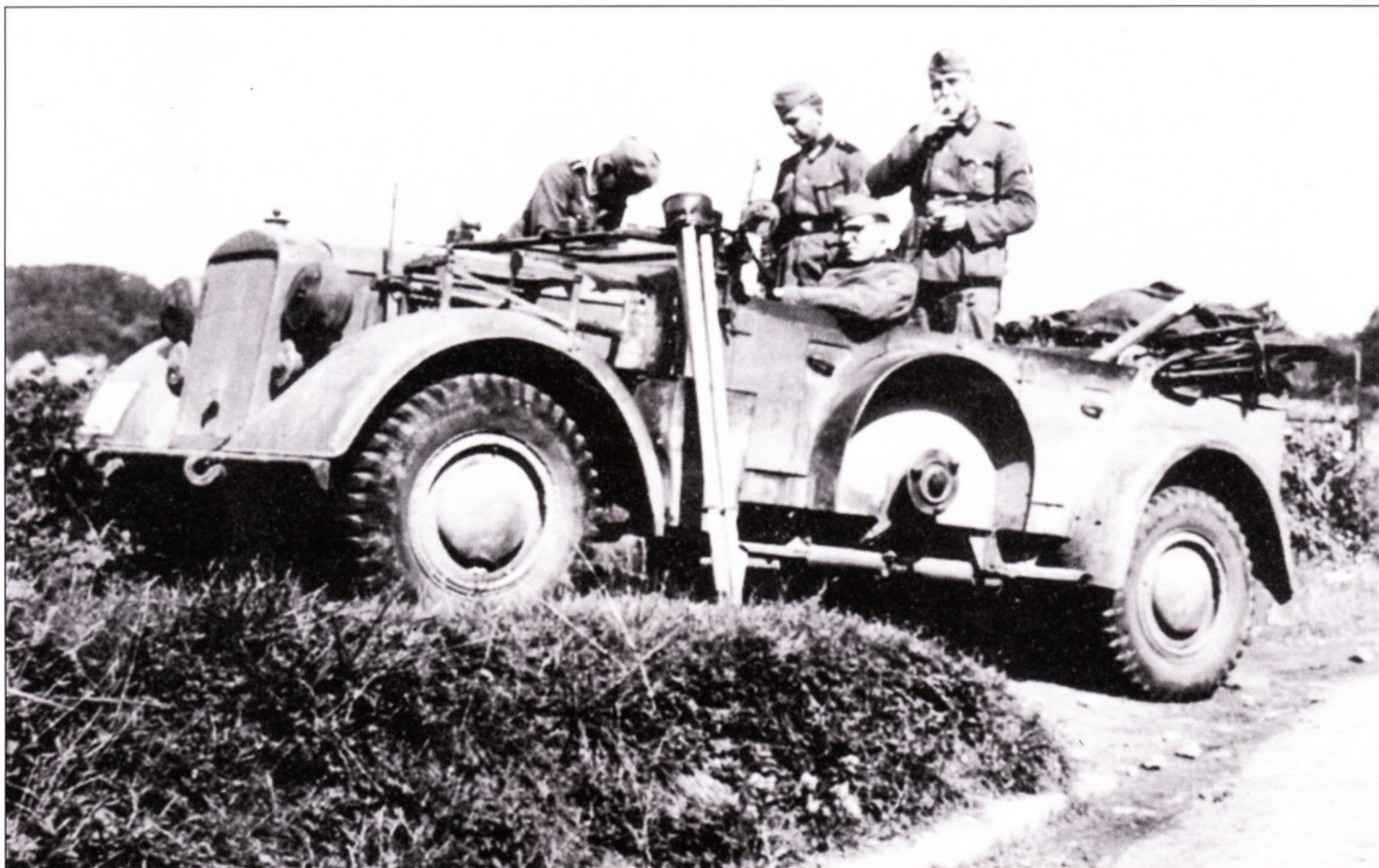
Штабной автомобиль 5-й роты 3-го железнодорожного саперного батальона в разведке под Бастонью. Судя по креплениям для троса, смонтированным на крыле в кадр попала «разведывательная автомашина (Kfz. 15) на универсального шасси среднего Pkw».
