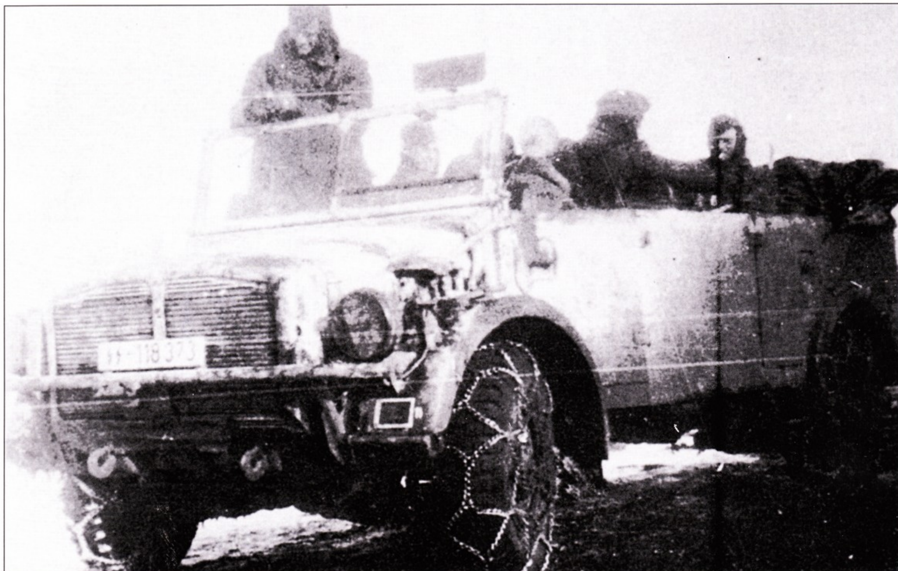
В 1940 г. появился вариант универсального шасси II тяжелого Pkw тип 40 с уширенным кузовом, внутри которого помещались запасные колеса, заливочные горловины топливных баков вывели наружу. Такие машины собирались заводами Форда и Хорьха. Машины комплектовались двигателями Хорьх мощностью 90 л.с. или Форд мощностью 78 л.с.
