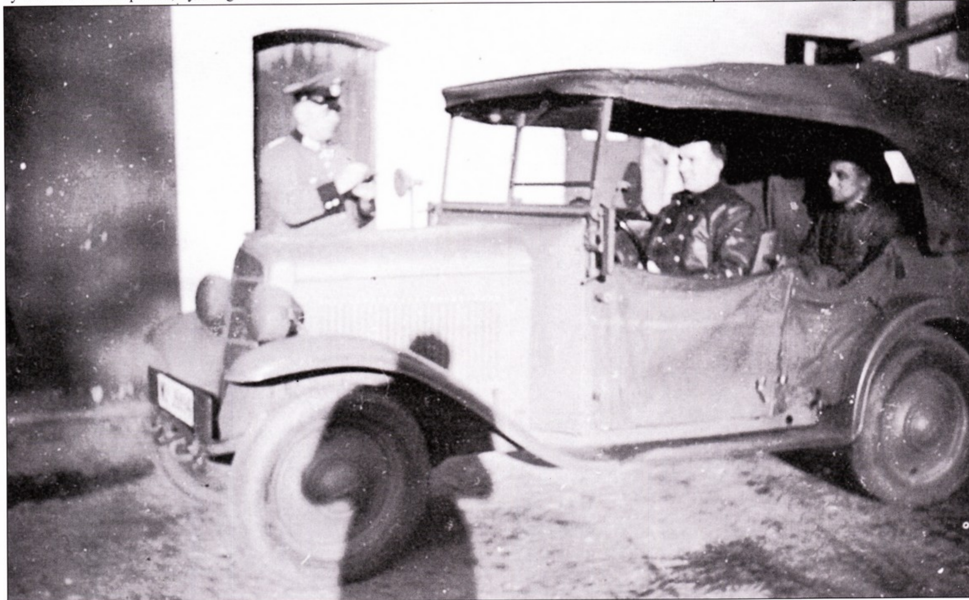
По причине нехватки автомобилей в вермахте приходилось использовать даже Опель Р4 в варианте с усиленным шасси, машина оснащена 4-цилиндровым мотором мощностью 26 л.с. На фронте такие авто почти не попадались.
