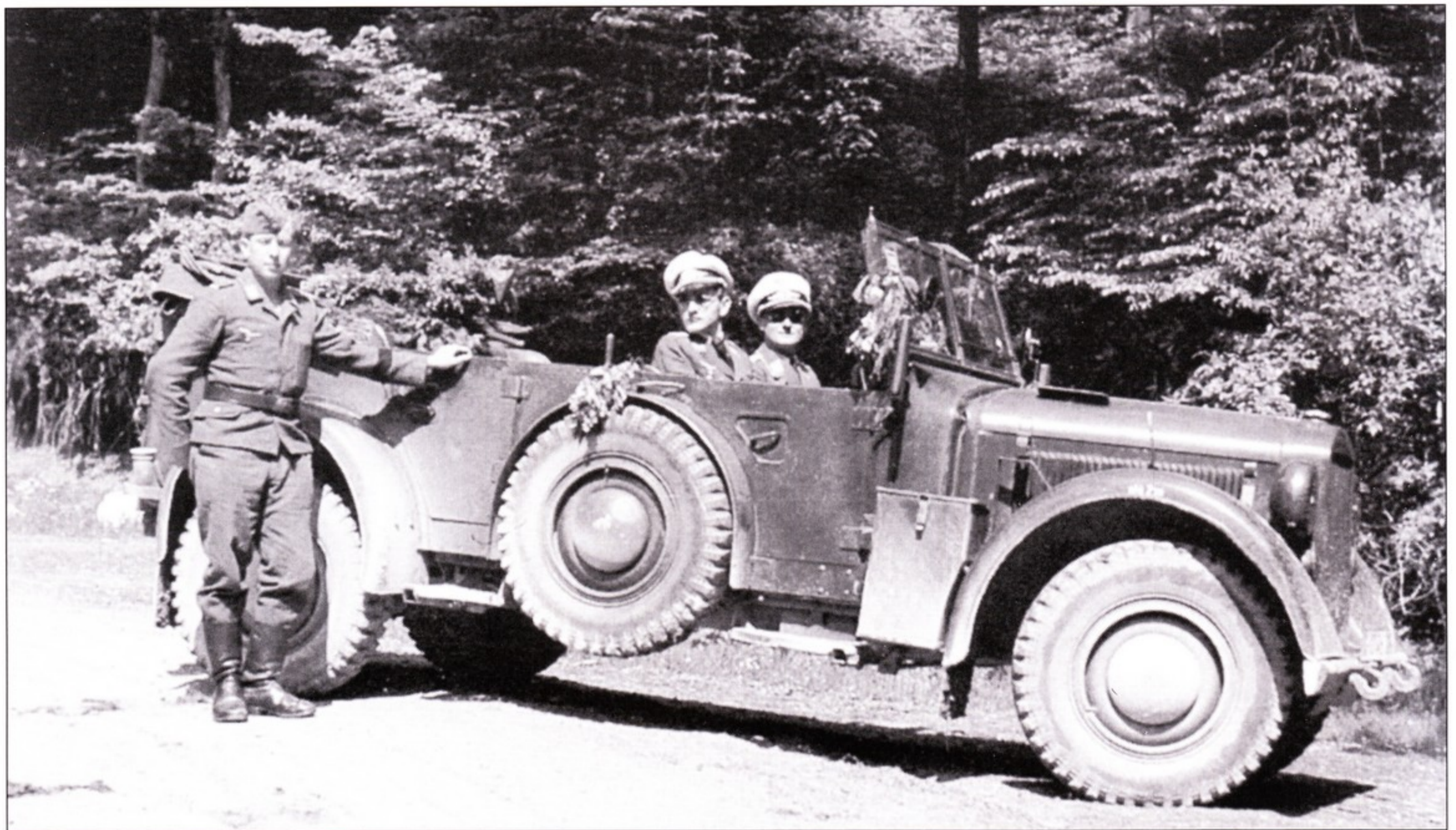
«Средний внедорожный Pkw с универсальным шасси для т.Рkw» подразделения люфтваффе. Согласно HDv 68/5 от 1 апреля 1943 г. это - «т.г.l.Рkw (Kfz.12)» и «т.г.l.Рkw с инструментальным ящиком (Kfz.15)», больших внешних отличий между двумя данными вариантами замечено не было. В войсках чаще всего встречались Kfz.15. Инструментальные монтировались по бортам сразу за передними крыльями. Обычно в ящиках хранили цепи для шин.
