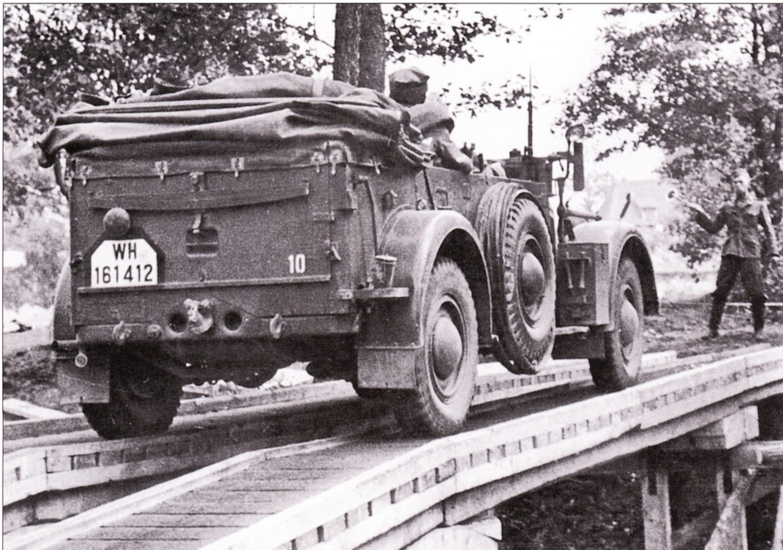
Опять задок автомобиля E Rkw с креплением для пилы. Фото сделано в период кампании в Польше. Обратите внимание на наличие ограждения горловины топливного бака за правым задним крылом.
