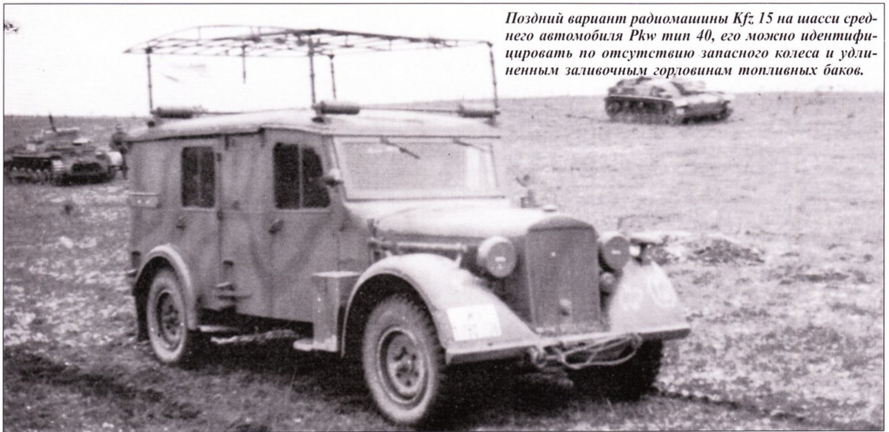
Бойцы осматривают небо Воронежа, июль 1942 г. В кадре - «средний разведывательный автомобиль (Kfz. 16) на универсальном шасси среднего Rkw (тип 40)» 1-й батареи артиллерийского полка дивизии «Великая Германия». На заднем плане - первый вариант танка Pz.Kpfw. IV с длинной пушкой - Ausf. F2, 200 таких танков фронт получил в марте 1942 г.
