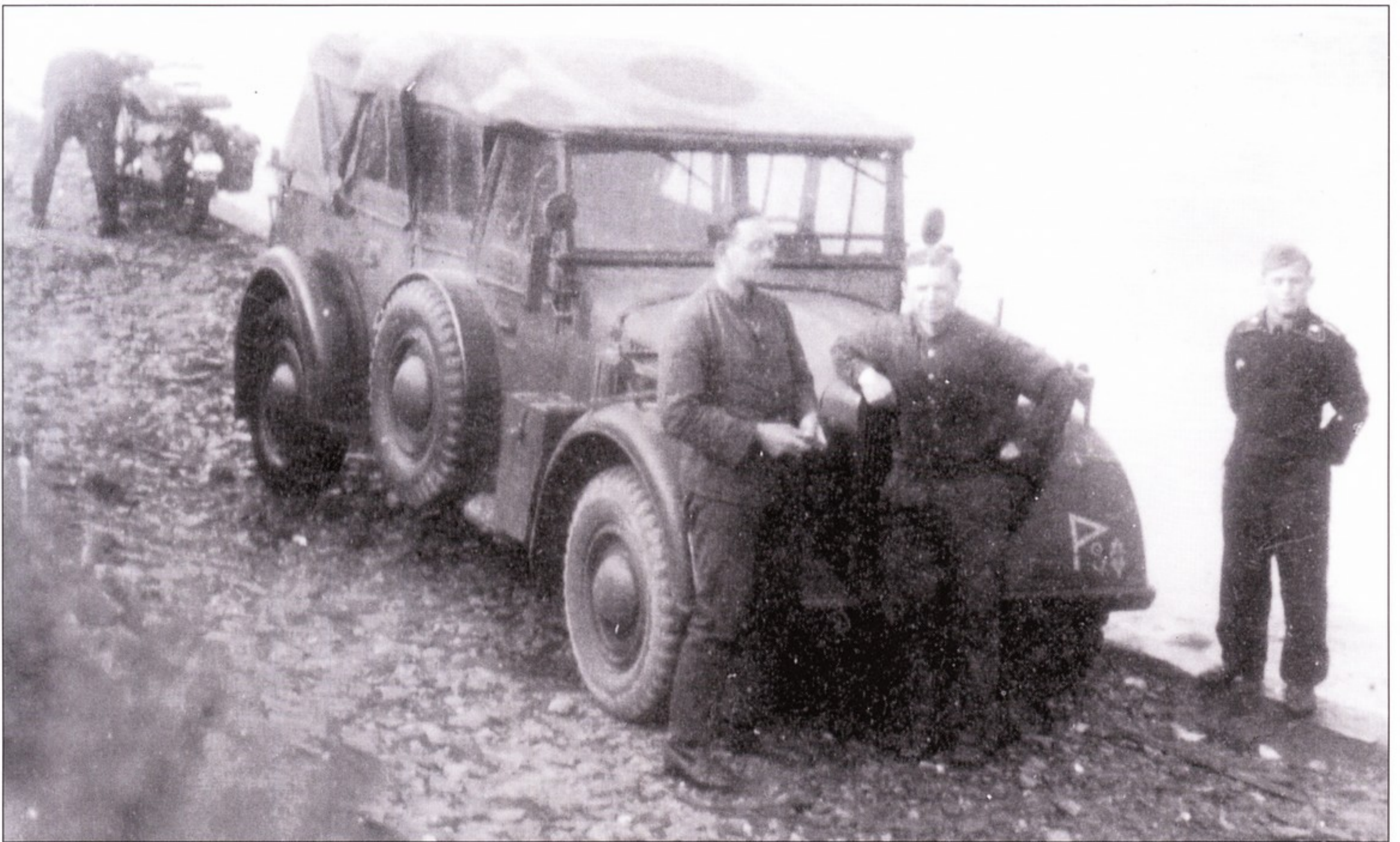
Хорьх 901 из штаба батальона 1-й панцердивизии. Машина сохранила камуфляжную окраску времен рейхсвера. Над кузовом установлен тент. Самым комфортабельным являлся штабной вариант тип 901, тяжелый тип 108 использовался как многоцелевой полевой автомобиль. На машине состоял двигатель V8 с 4-скоростной коробкой передач. Запасные колеса крепились по бортам корпуса, они подвешивались на осях, несколько улучшая проходимость машины при преодолении препятствий. Из-за наличия колес в средней части корпуса, двери получились очень узкими.
