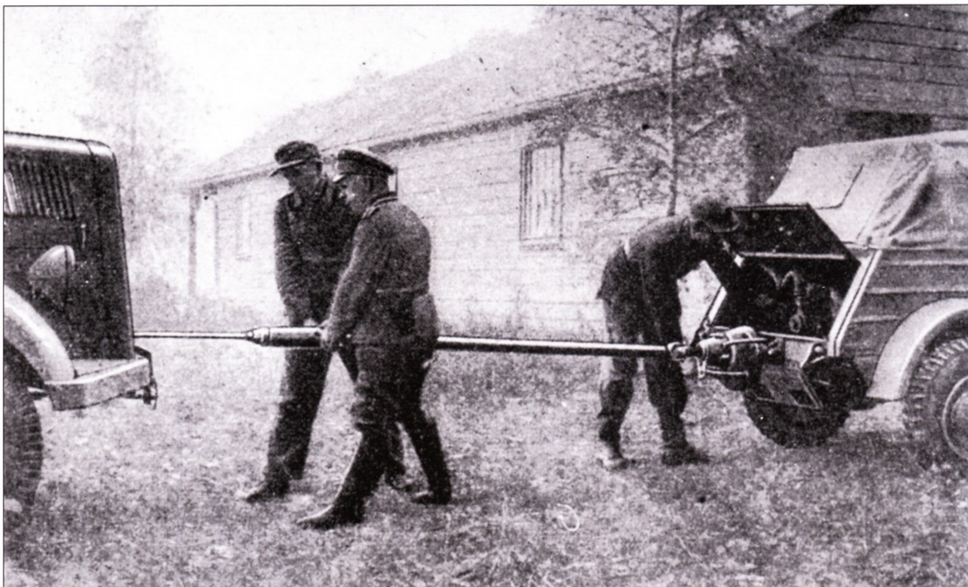
Кюбельваген Фольксвагена изначально предназначался для выполнения широкого круга задач. На фото - «автостартер тип 198 для моторов Kfz на базе легкого Pkw К 1, тип 82». Посредством кюбельваген народ пытается завести двигатель грузовика Опель «Блиц», кюбельваген применялся также для запуска двигателей танков «Пантера». Приводной вал нормально перевозился в кузове кюбельвагена. Запасные части к кюбельвагену, согласно указанию от 8 декабря 1944 г., следовало заказывать только на фирме Фольксваген GmbH.
