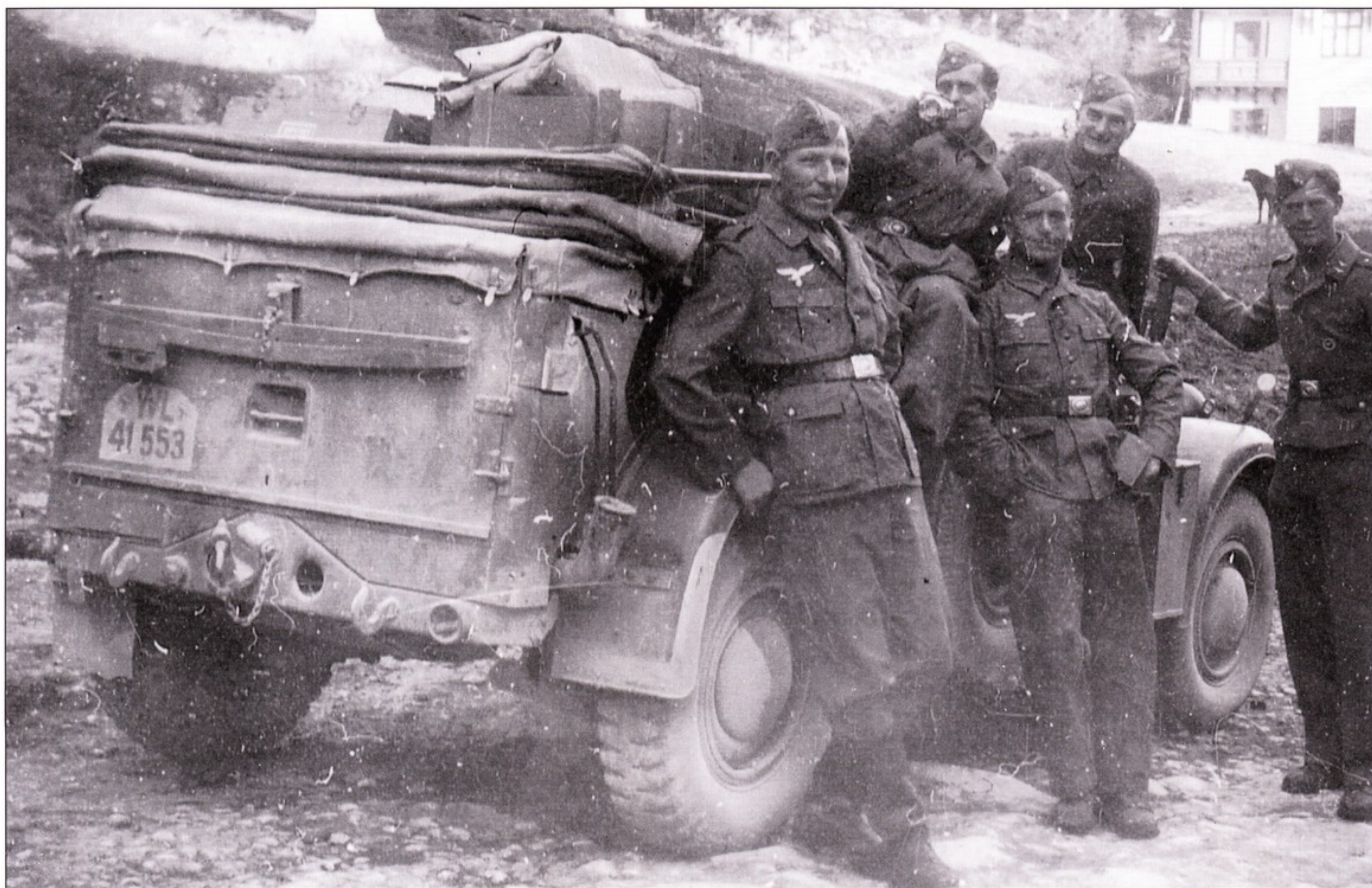
Автомобиль E Rkw из неустановленного подразделения люфтваффе, предвоенные учения. Хорошо видна детализировка кормы автомобиля. На крышке багажного отсека закреплено ложе для пилы - обычно его снимали.
