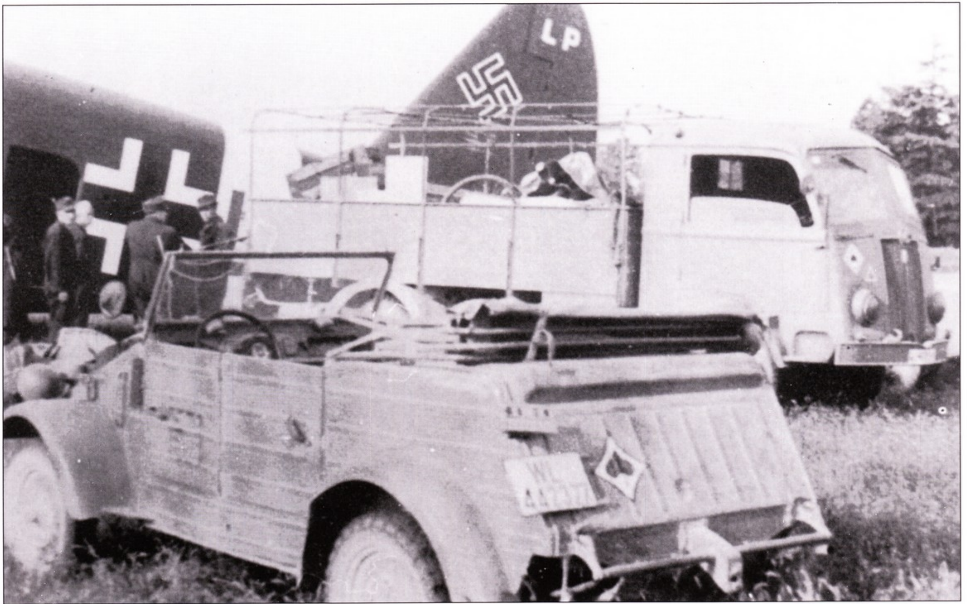
Фольксваген кюбельваген тип 82 53-й истребительной эскадры, на заднем плане - трофейный грузовик Fiat тип 626 и трофейный же самолет Савойя-Маркетти SM.84. Кюбельвагены Фольксвагена поздней постройки снабжались задними бамперами.
