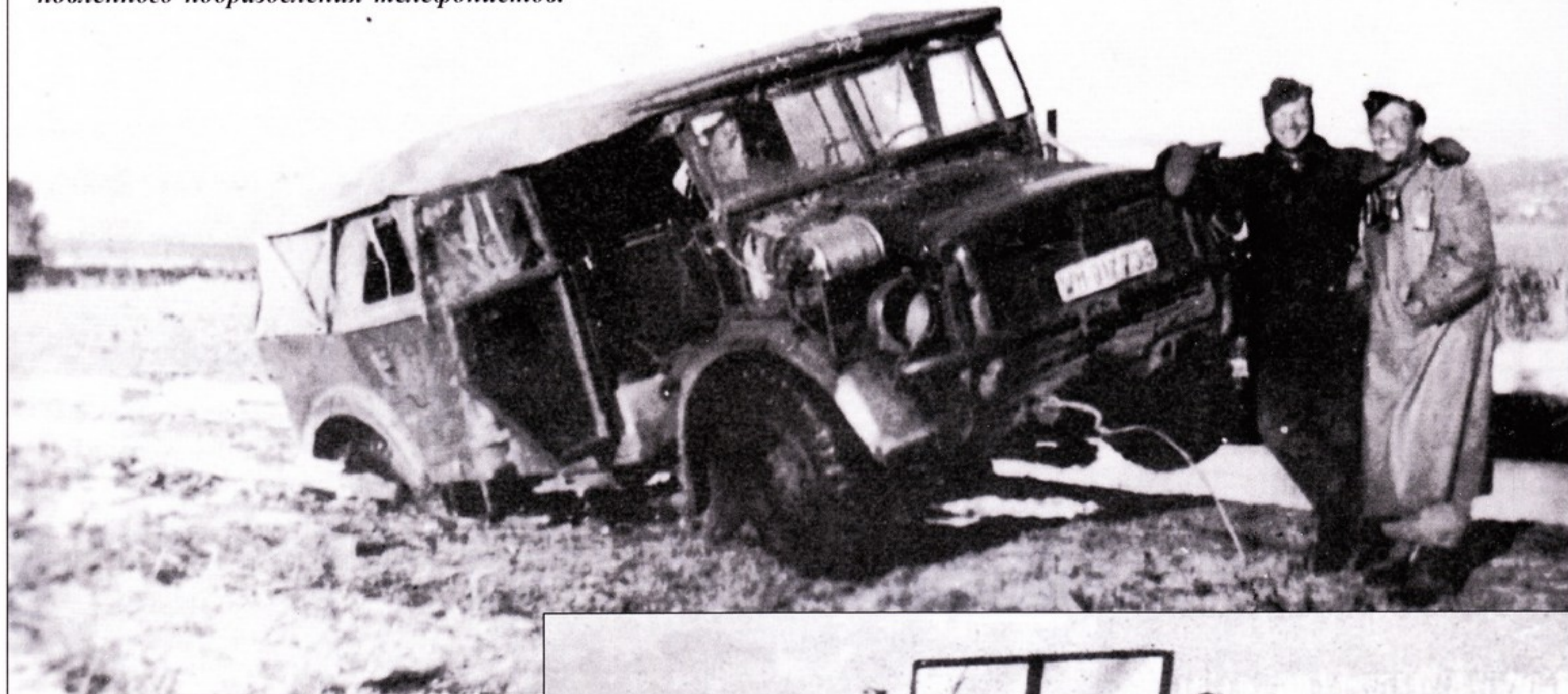
Легкий снегоочиститель тип E на базе универсального шасси II тяжелого Pkw (WH-97 574). Угол разворота отвала регулировался. Машина лишена тента, который мог бы малость защитить экипаж от непогоды.
