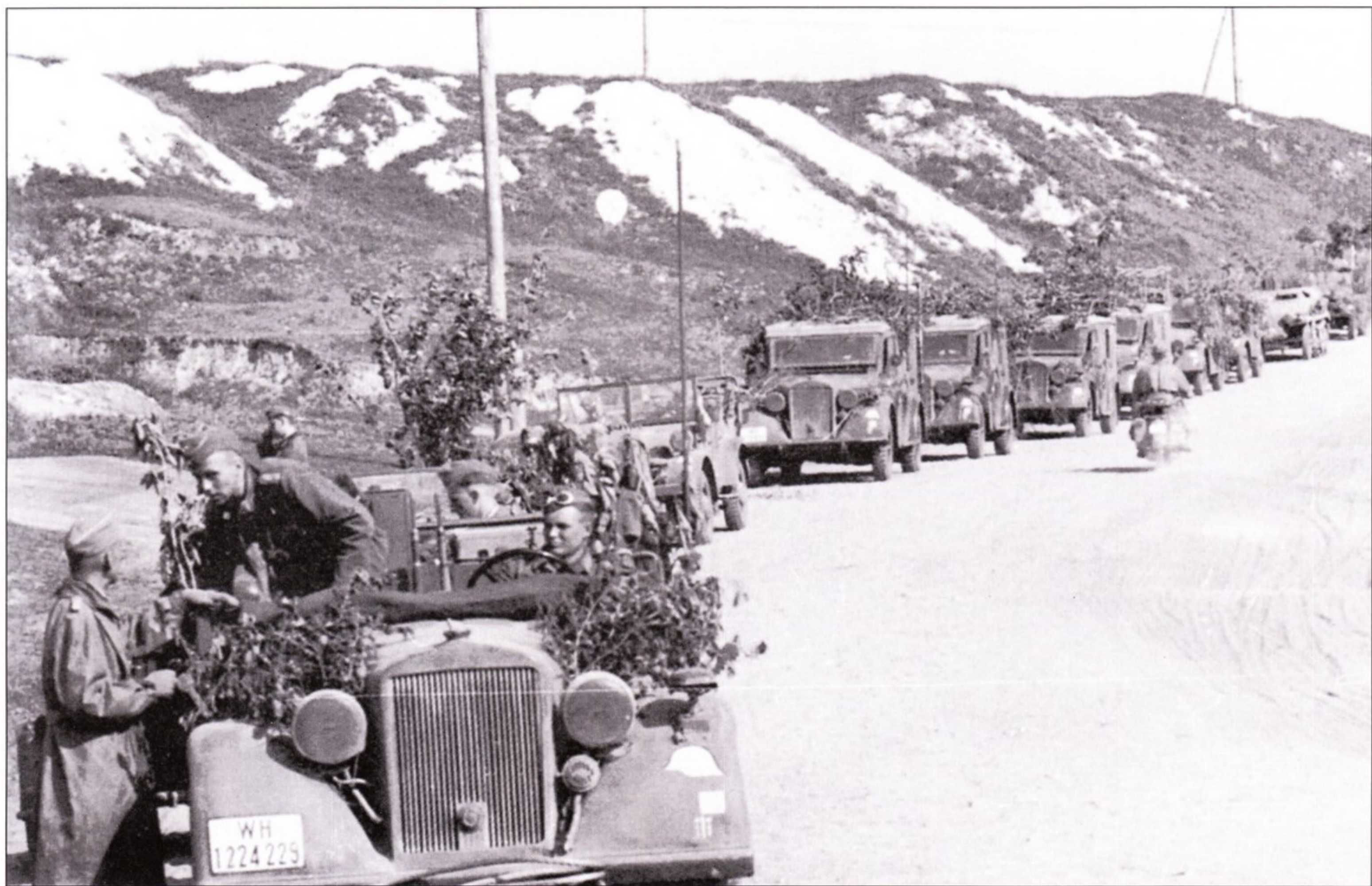
Техника дивизии «Великая Германия» на марше в сторону Томаровки, весна 1943 г. Головная - радиомашинка Kfz 15 на универсальном шасси Pkw тип 40. Ниже эмблемы дивизии (каска) изображен на крыле тактический знак штаба моторизованного артиллерийского полка. Следом в колонне идет радиомашинка Kfz. 2 на универсально шасси I легкого Pkw. , далее - две радиомашинки Kfz. 17/1 со штыревыми антеннами и две радиомашинки Kfz. 17 с рамными антеннами. Масса снаряженной машины Kfz. 17 превышала 3,6 т.
