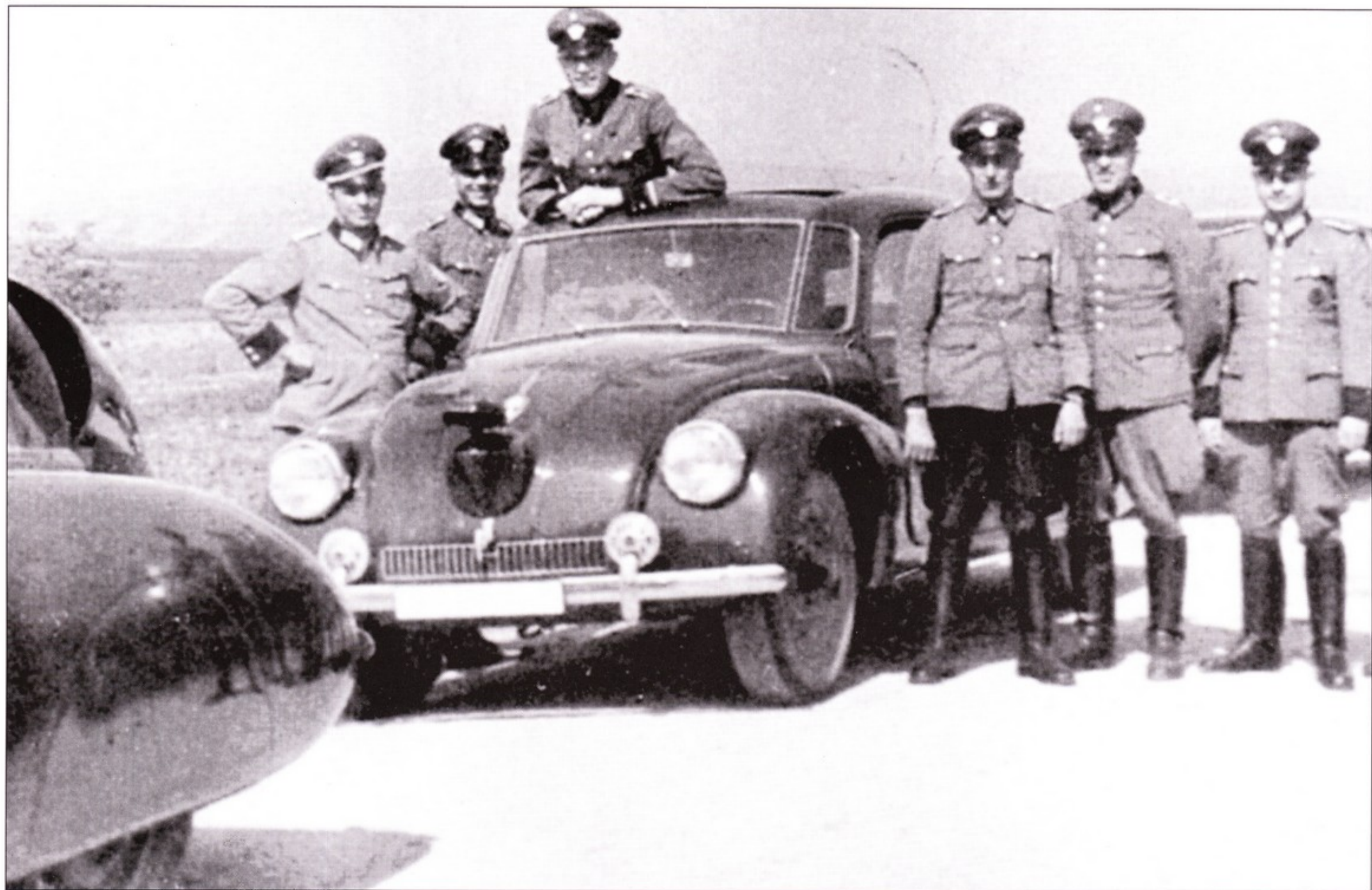
Автомобили Татра 87 использовались полицией Рейха в Югославии и в Италии. У этой Татре по центру установлена светомаскировочная фара Нотек. На Татре-87 стоял двигатель воздушного охлаждения V8 мощностью 72 л.с.
