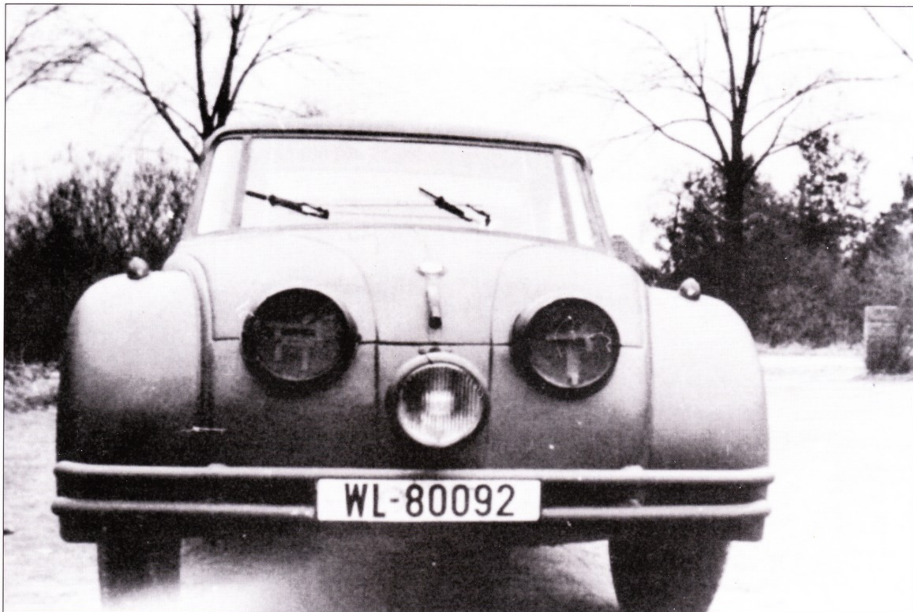
Стремительные обводы кузова, установленный в корме мотор, большой несущий корпус, разрезные оси - вот она, «гроссе Татра» образца 1934 г. Машина и сегодня приковывает взгляд своим необычным обликом. На фото - Татра 77 (3-я модель) подразделения люфтваффе. На машине установлен двигатель воздушного охлаждения V8; такие Татры строились в 1934 - 1936 г.г.
