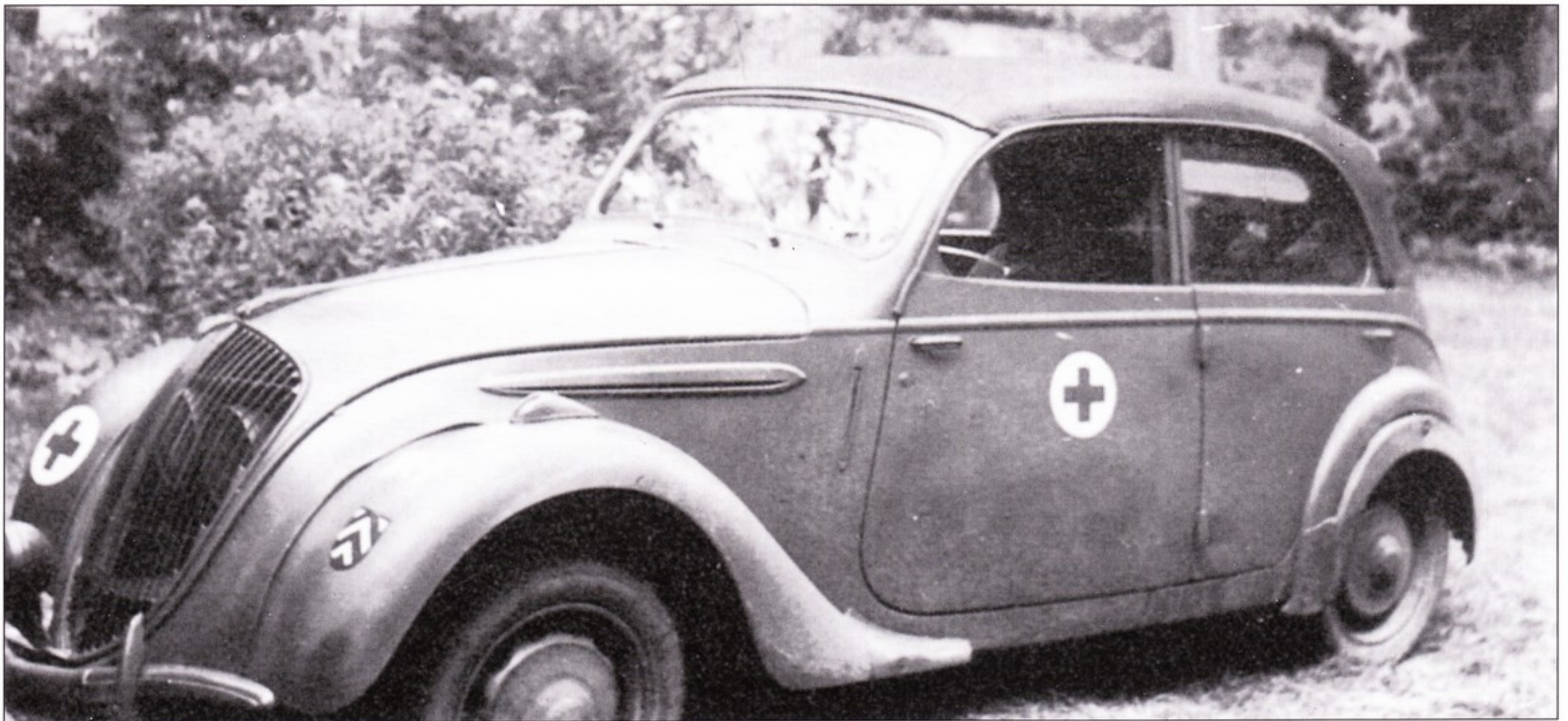
На Пежо 202 стоял 4-цилиндровый двигатель мощностью 30 л.с. Фары установлены типично для этой фирмы за облицовкой радиатора. На фото - машина 6-й пехотной дивизии, Люксембург.
