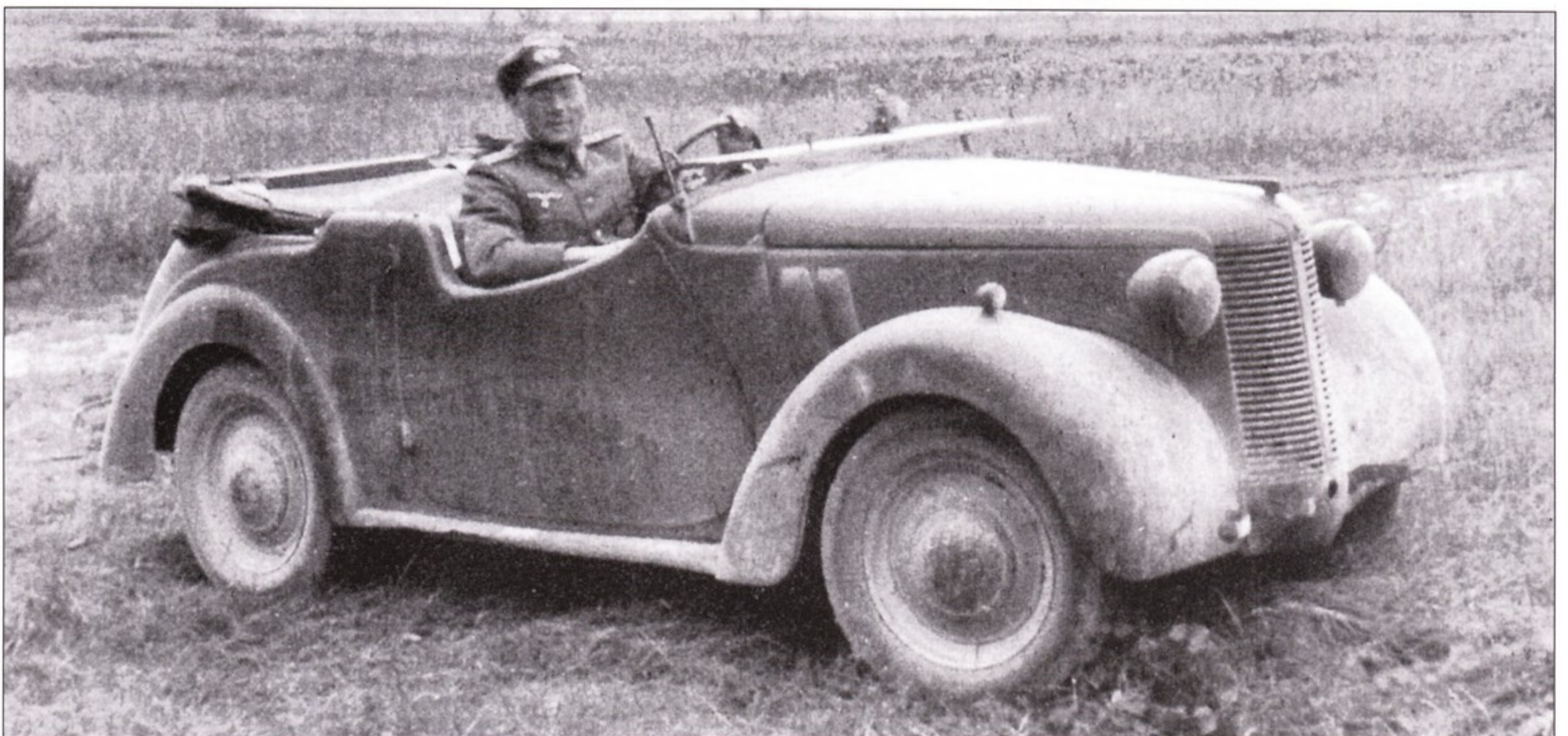
Британский Остин 8 серия HP AP, маркировки - никакой, но принадлежность автомобиля вермахту очевидна. Заднеприводные остин оснащён 4-цилиндровым двигателем мощностью 23,5 л.с. и четырехскоростной трансмиссией. Длина автомобиля - 370 см, ширина 14- см, высота 158 см, база шасси - 226 см, масса - всего-то 680 кг. Маленький и легкий автомобиль всем был хорош, но в джипы не годился совершенно. Размер шин - 5.00-16, тормоза механические, а подвеска колес - рессорная.
