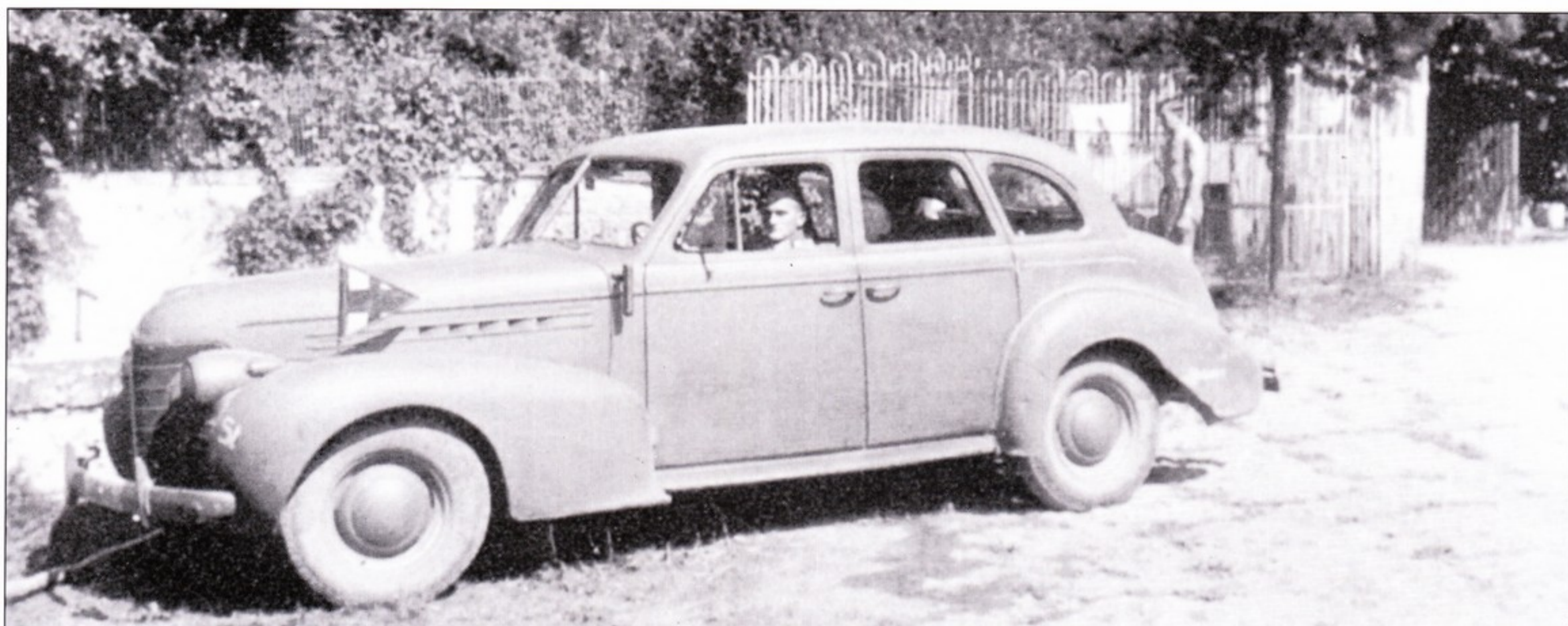
Олдсмобиль: 20-я пехотная дивизия вермахта была сформирована всего за несколько месяцев до вторжения германских войск во Францию. На фото - автомобиль Олдсмобиль тип 60 модель 1939 г. (6 цилиндров, 90 л.с.) командира 20-го саперного батальона. Олдсмобиль - одна из марок Дженерал Моторс.
