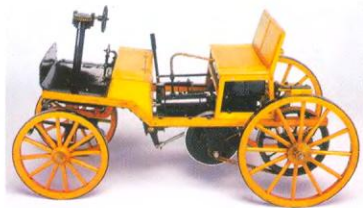
4 Изобретенный Зигфридом Маркусом в 1875 году автомобиль считается самым ранним из дошедших до нас машин с бензиновым двигателем (модель).
