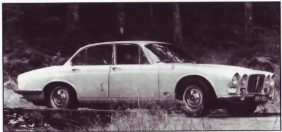
добраться почти совершенно полного отсутствия вибраций. Несущий кузов, новая независимая подвеска спереди и сзади, дисковые тормоза Girling с усилителем, рулевое управление также с усилителем, привод задний. Предлагалась два вида трансмиссии: ручная и автоматическая, последнюю заказывали более часто, она лучше соответствовала характеру *XJ*. Максимальная скорость составляла 193 км/час, разгон до скорости 96 км/час занимал 10,1 секунд.
