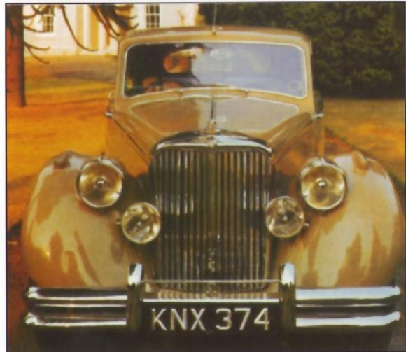
Технические характеристики: мотор – шесть цилиндров, расположенные в ряд, с рабочим объемом 2663 куб.см. и мощностью 103 л.с. при 4600 об./мин., шасси коробчатого типа, подвеска независимая передняя и полуэллиптическая задняя, ручная четырехскоростная трансмиссия, привод задний, барабанные тормоза *Girling* с гидроусилителем, максимальная скорость 140 км/час, разгон до скорости 96 км/час происходил за 17 секунд.
