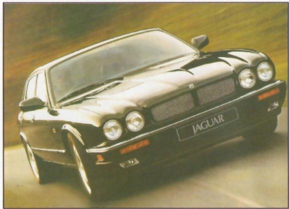
Максимальная скорость 250 км/час (ограниченная электроникой), время разгона до 100 км/час 6,3 секунды для версий с ручной трансмиссией, 7,0 секунды для машин с автоматической коробкой. Расход топлива от 8,6 до 16,7 л на 100 км.
