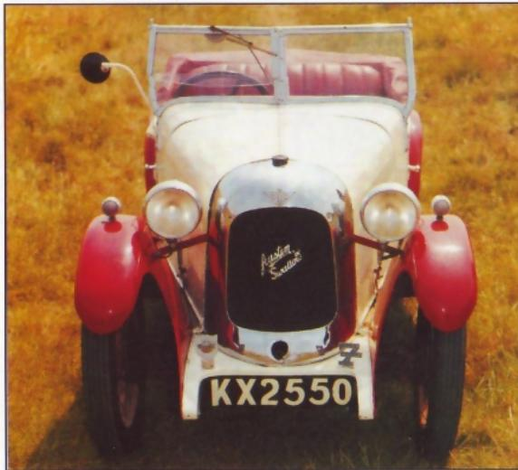
минуту, подвеска из поперечных балок, барабанные тормоза, ручная трехскоростная трансмиссия, привод задний, максимальная скорость 80 км/час, разгон до 60 км/час требовал 37 секунд.
