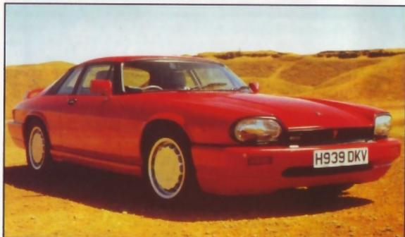
по-настоящему спортивная версия, с мотором V12 объемом 6 литров и мощностью 333 л.с., она развивала максимальную скорость 254 км/час и разгонялась до скорости 96 км/час за 6,2 секунды, что подтверждается тестами *Autocar*. Конечно, эта модель обладала более острым рулевым управлением и жесткой подвеской, вес удалось снизить до 1790 кг.
