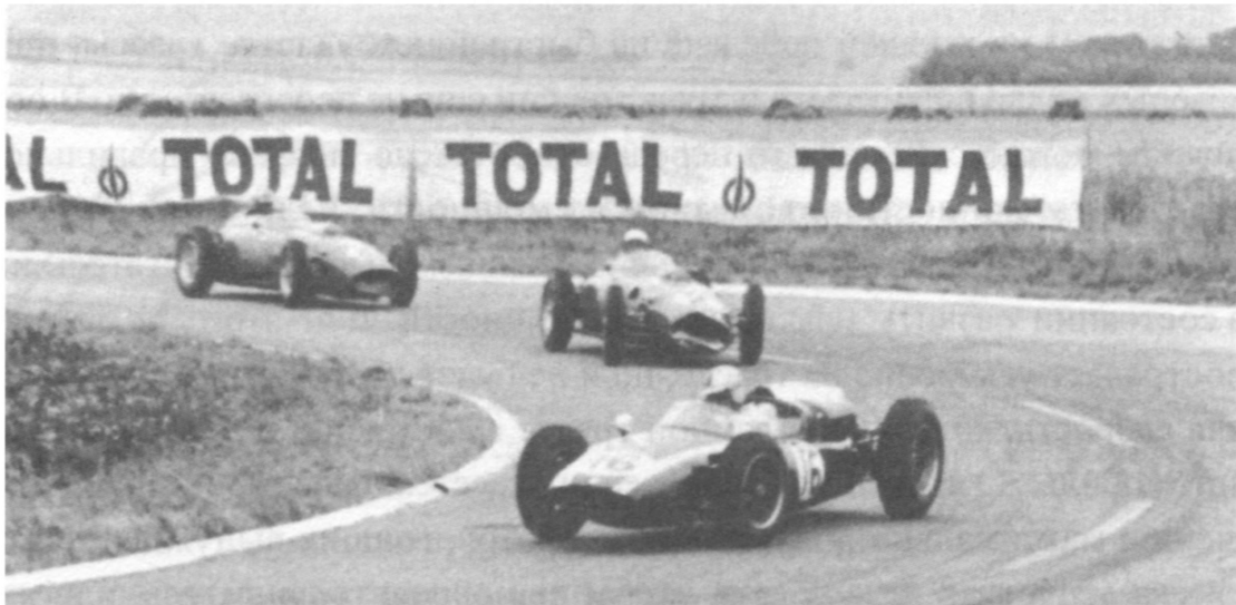
Рис. 50. Фил Хилл и У. фон Трип за ним на «Феррари» с большой недостаточной поворачиваемостью следуют за Бребхемом на Купере-Климакс с почти нейтральной поворачиваемостью. (Гран-при Франции, 1960 г., Реймс).
