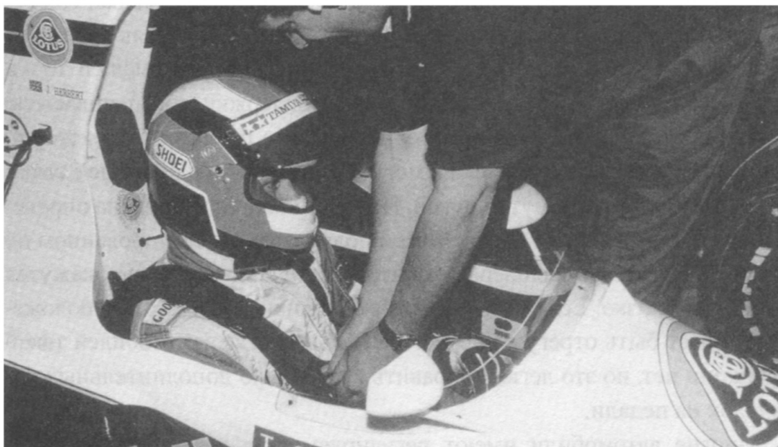
Рис. 9. Если автомобиль оснащен полноразмерными гоночными ремнями безопасности, водитель жестко удерживается в своем кресле. Если руль находится слишком далеко, управление будет затруднено.
