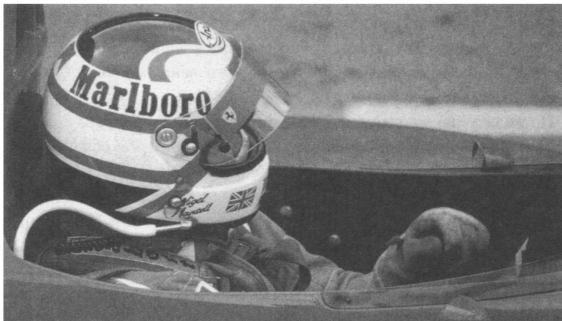
Рис. 54. Необходимо использовать только омологированные шлемы. Трубка, присоединенная к этому шлему Найджела Менселла, снабжает гонщика кислородом в случае пожара. Некоторые гонщики предпочитают отказаться от нее, опасаясь, что кислород может способствовать возгоранию.
