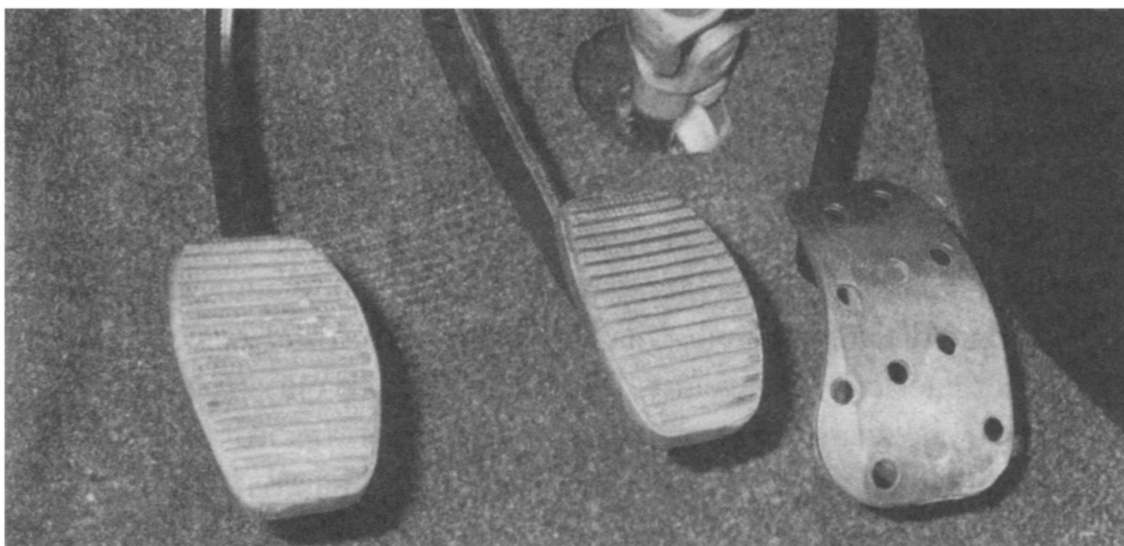
Рис. 13. В некоторых спортивных автомобилях педаль газа имеет специальную форму для упрощения перегазовки пяткой, как в этом Фиате Уно Турбо.
