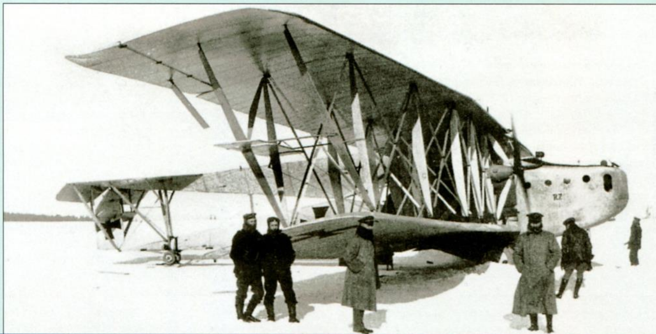
Самолеты-гиганты фирмы «Сименс-Шуккерт» отличались причудливой формы фюзеляжем – высоким и узким, с раздвоенной в вертикальной плоскости хвостовой частью
