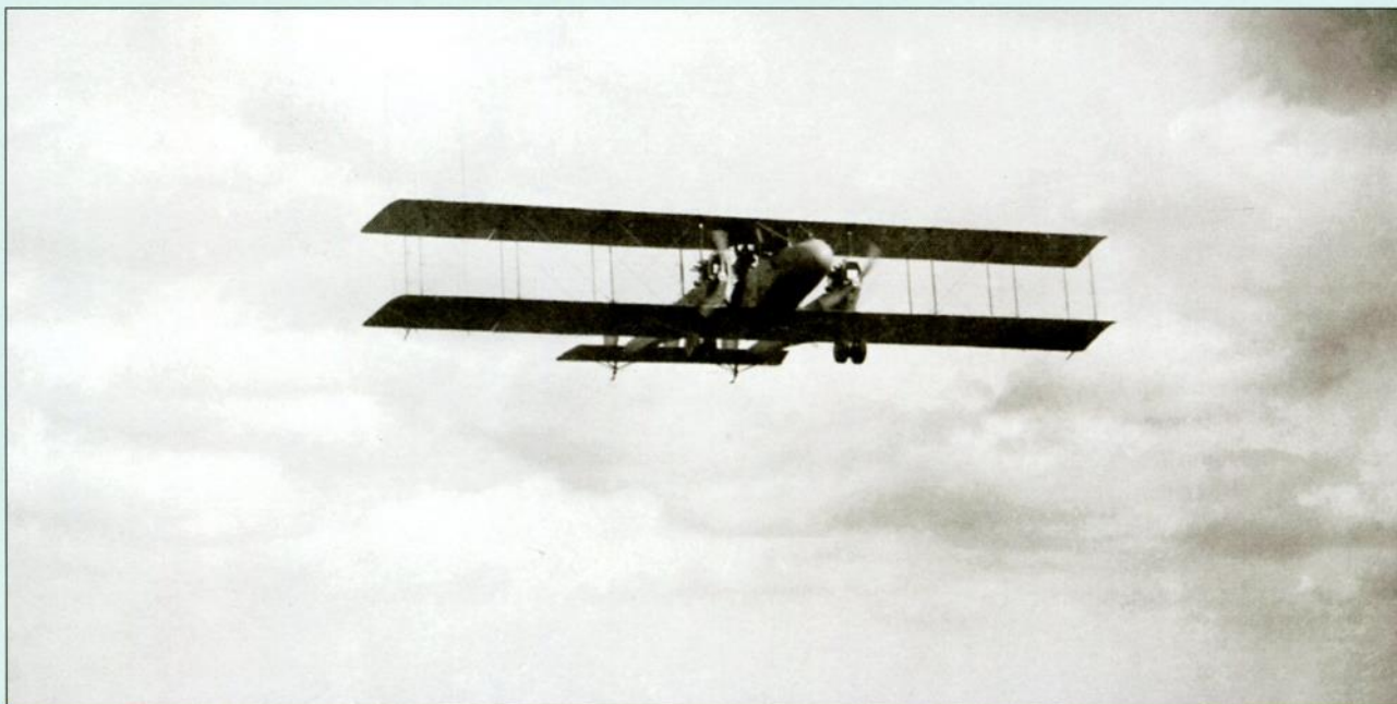
«Капрони» Са.5 отличался от Са.3 значительно увеличенным крылом и другими усовершенствованиями
