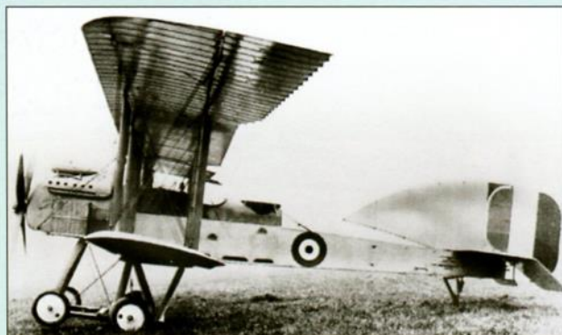
«Бомбер» отличался оригинальным четырехколесным шасси
