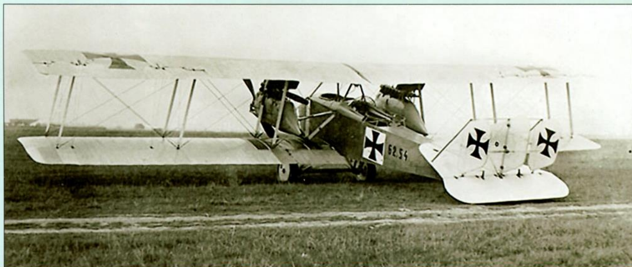
«Ганза-Бранденбург» G.I представлял собой двухмоторный биплан с трехкилевым оперением
