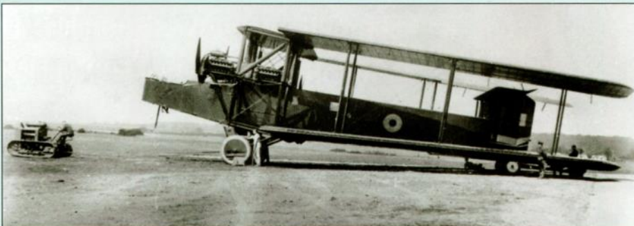
Для удобства хранения в ангаре и перевозки наземным транспортом консоли крыла V/1500 могли складываться
