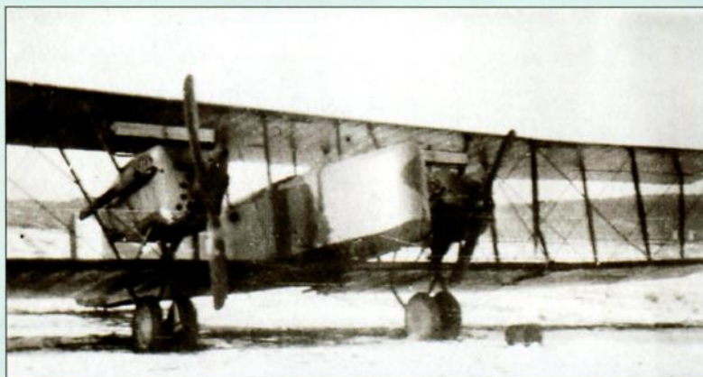
Силовая установка «Фармана» F.50 состояла из моторов «Лоррэн-Дитрих»
