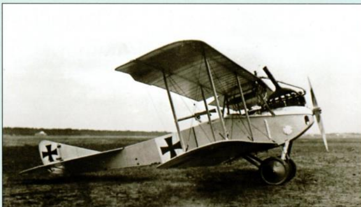
LVG C.II одним из первых получил эффективное оборонительное вооружение
