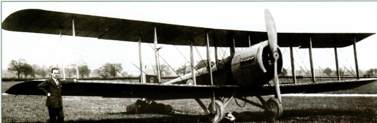
Т.1 «Кукку» стал первым в мире колесным самолетом, специально спроектированным для базирования на авианосцах
