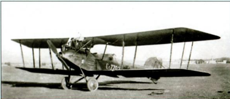
«Саблатниг» N.I отличался довольно большим размахом крыла
