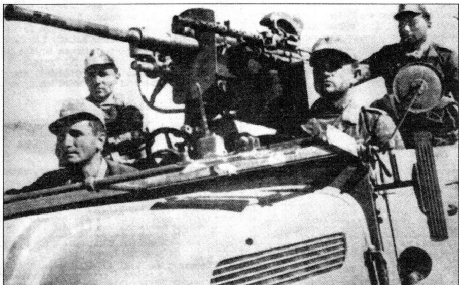
Самоходная установка на базе автомобиля Steyr с 20-мм артилле- рийским орудием и спаренным с ним пулемётом. Экипаж — четыре человека (фото вверху)
