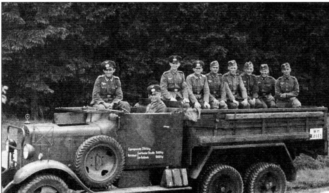
Бортовой грузовик Mercedes-Benz G3a для перевозки пехоты. На довоенном фото видны необычные номера на дверце кабины. Стекло кабины опущено, перед левой дверью — фара-искатель, видны фары сбоку капота, подфарники на крыльях. В деревометаллическом кузове установлены скамейки вдоль бортов
