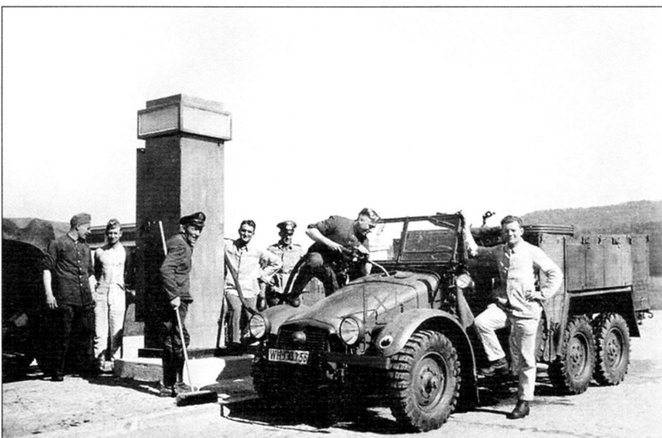
Заправка автомашины Krupp L2H143. Крышка заливной горловины в верхней части капота перед лобовым стеклом. Фотография из рекламного проспекта 1940 г.
