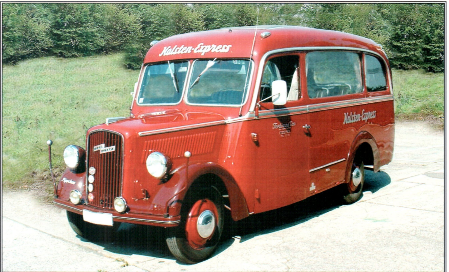
Лёгкий автобус на шасси 1,5-тонного Opel-Blitz 2,5-32. В 1939—1940 гг. гражданские машины этого типа были мобилизованы. Превращение в «военные» заключалось в перекраске в армейский серый цвет и снятии хромированных деталей. На фронте большинство из них использовались как санитарные фургоны Kfz 31, а также в частях службы пропаганды
