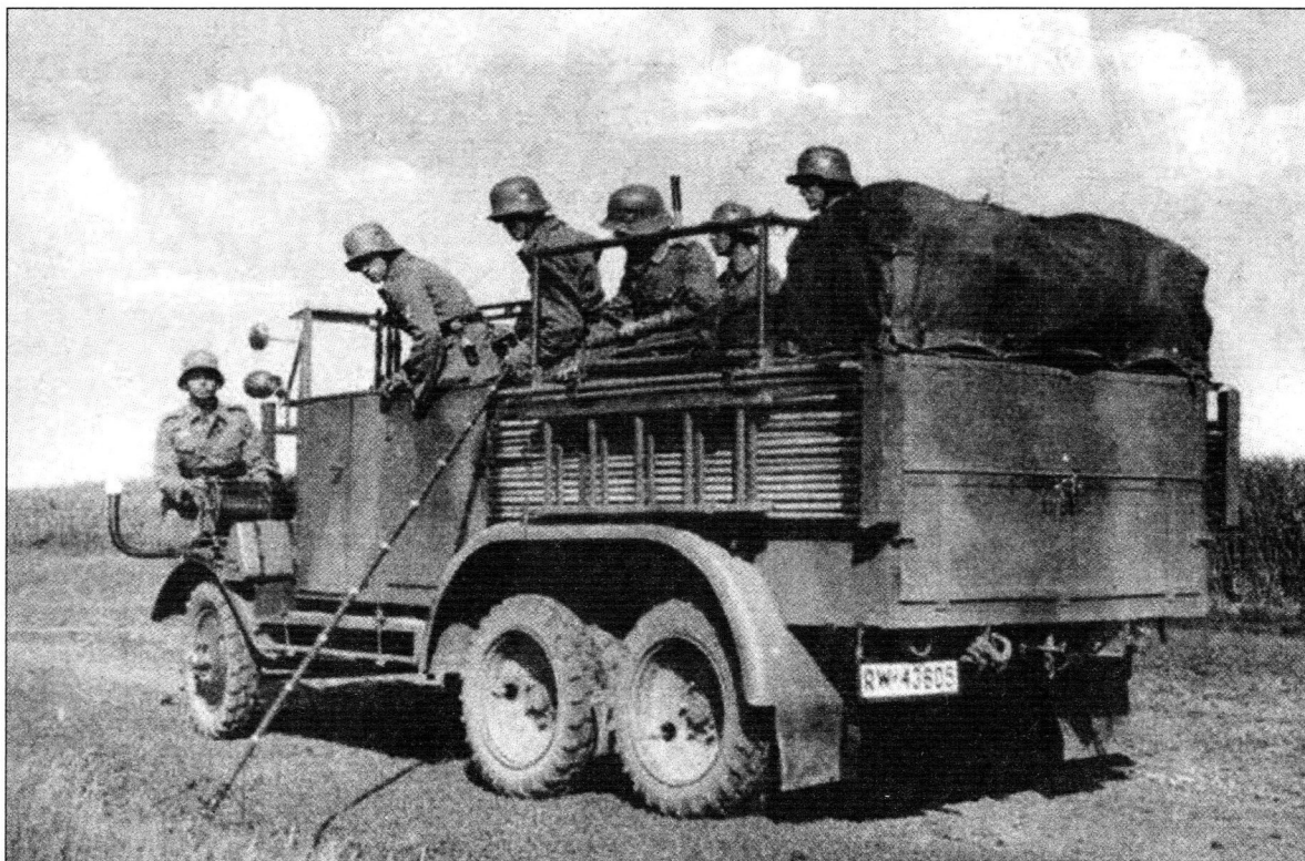
Автомобиль Bussing-NAG G31 (Kfz 77) телефонной связи, оборудованный для прокладки телефонных линий. Прокладка кабеля вдоль дороги. Маневры Рейхсвера, 1934 г.
