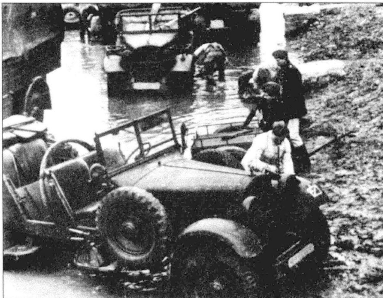
Солдаты из мотоколонны моют свои Kfz 11. У машины на переднем плане сняты двери и сложены позади передних сидений. На левом крыле автомобиля - металлическая рамка для флажка обозначающего машину командира.
