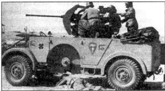
Автомобиль s.gl. Einheits-Pkw (Horch 1a) Kfz 69, вооруженный зениткой Flak 38, 605-й дивизион зенитной артиллерии, Северная Африка, 1942 год.
