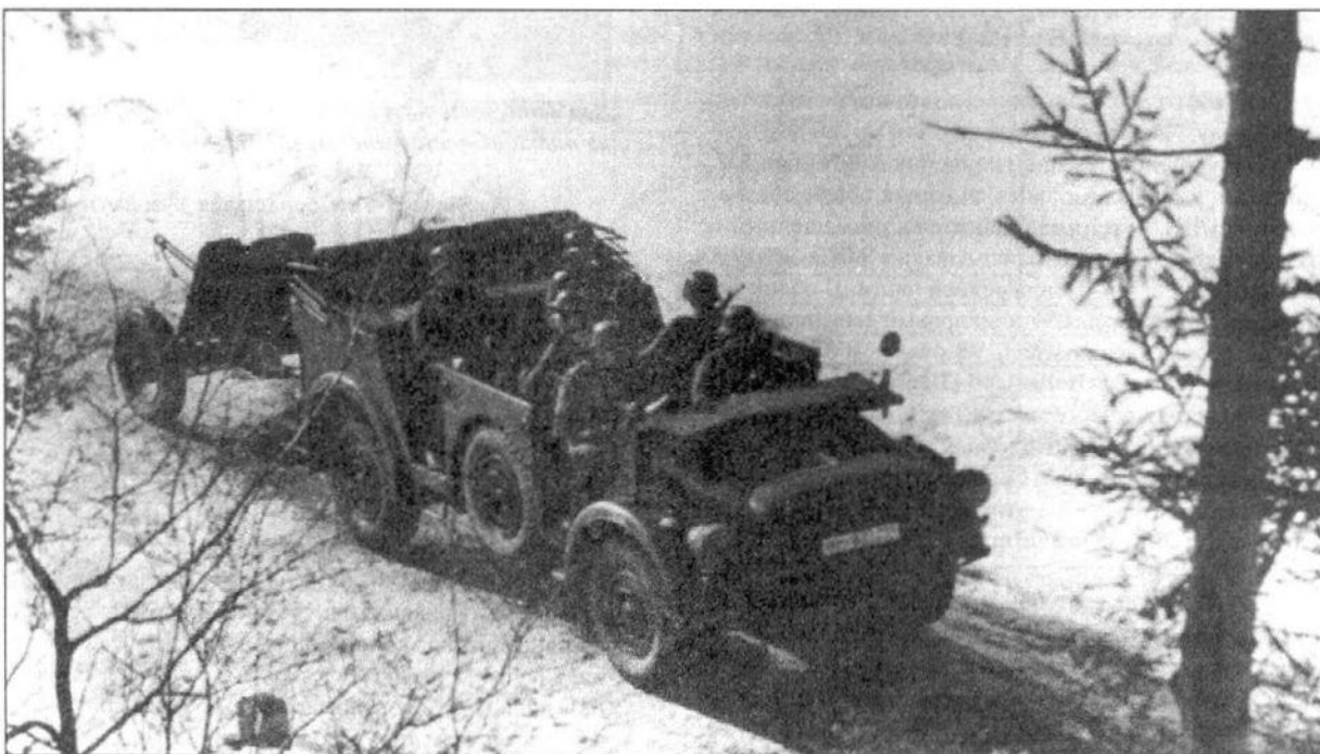
Автомобиль s.gl. Einheits-Pkw (Horch 1a) Kfz 69, буксирует противотанковую пушку Pak 35/36 калибра 37 мм.
