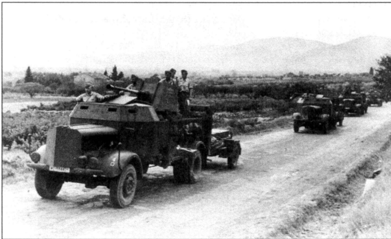
На марше батарея ПВО Люфтваффе. В кузове каждого Mercedes-Benz L4500 установлена пушка 2cm Flak 36.
