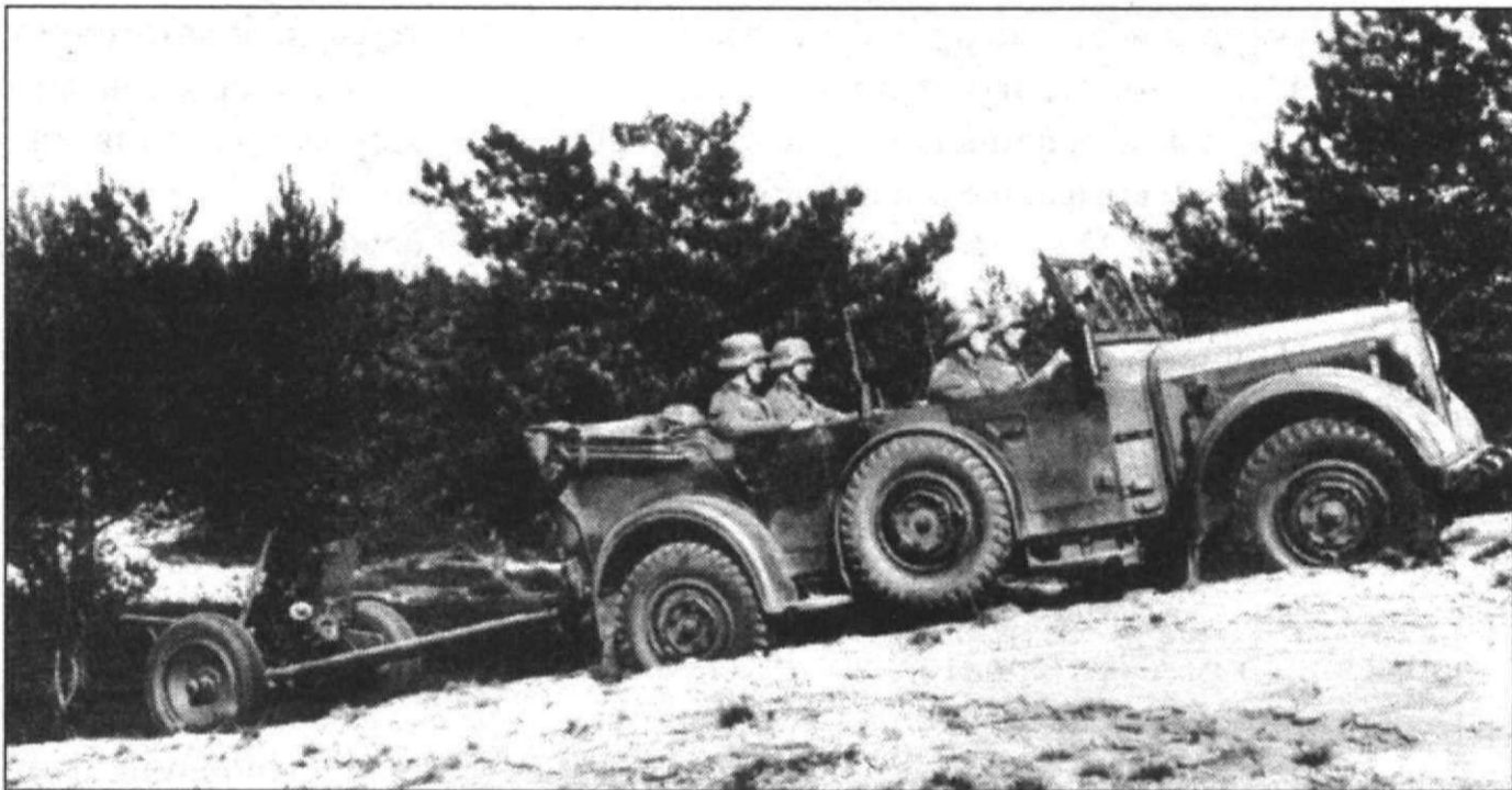
Противотанковое орудие Pak 37 на буксире Kfz.15 (Horch 901)
