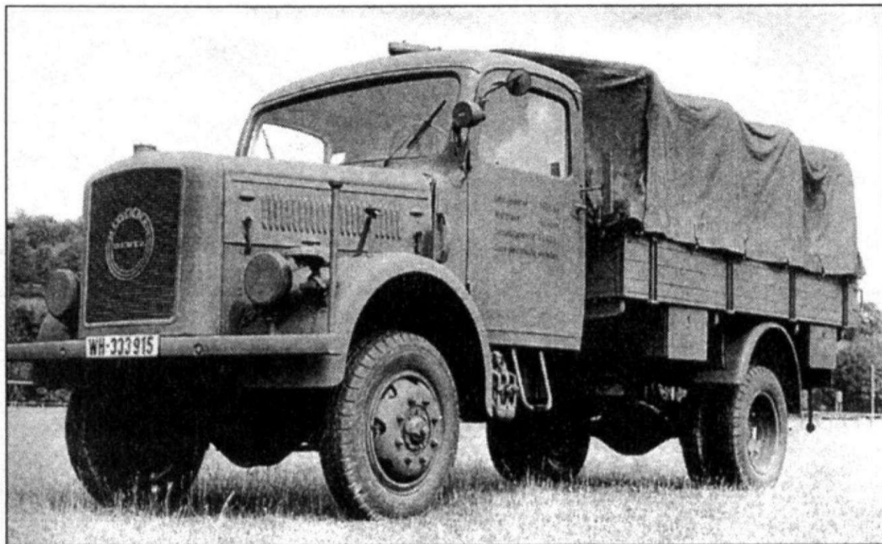
В военные годы модель M206 была заменена на Magirus A330, 4x4, 4-цилиндровый дизель, 70л.с. при 2100об/мин.
