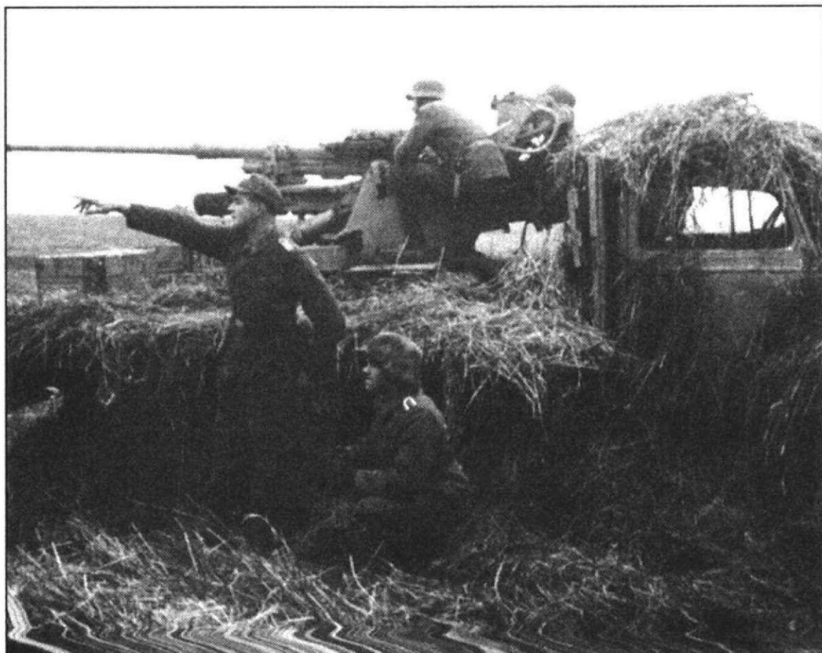
Грузовой автомобиль Ford 3t с пушкой 3.7cm Flak 36 на позиции замаскирован сеном. Орудийный щит снят, вероятно, для уменьшения общего веса орудия. Россия, 1944г.
