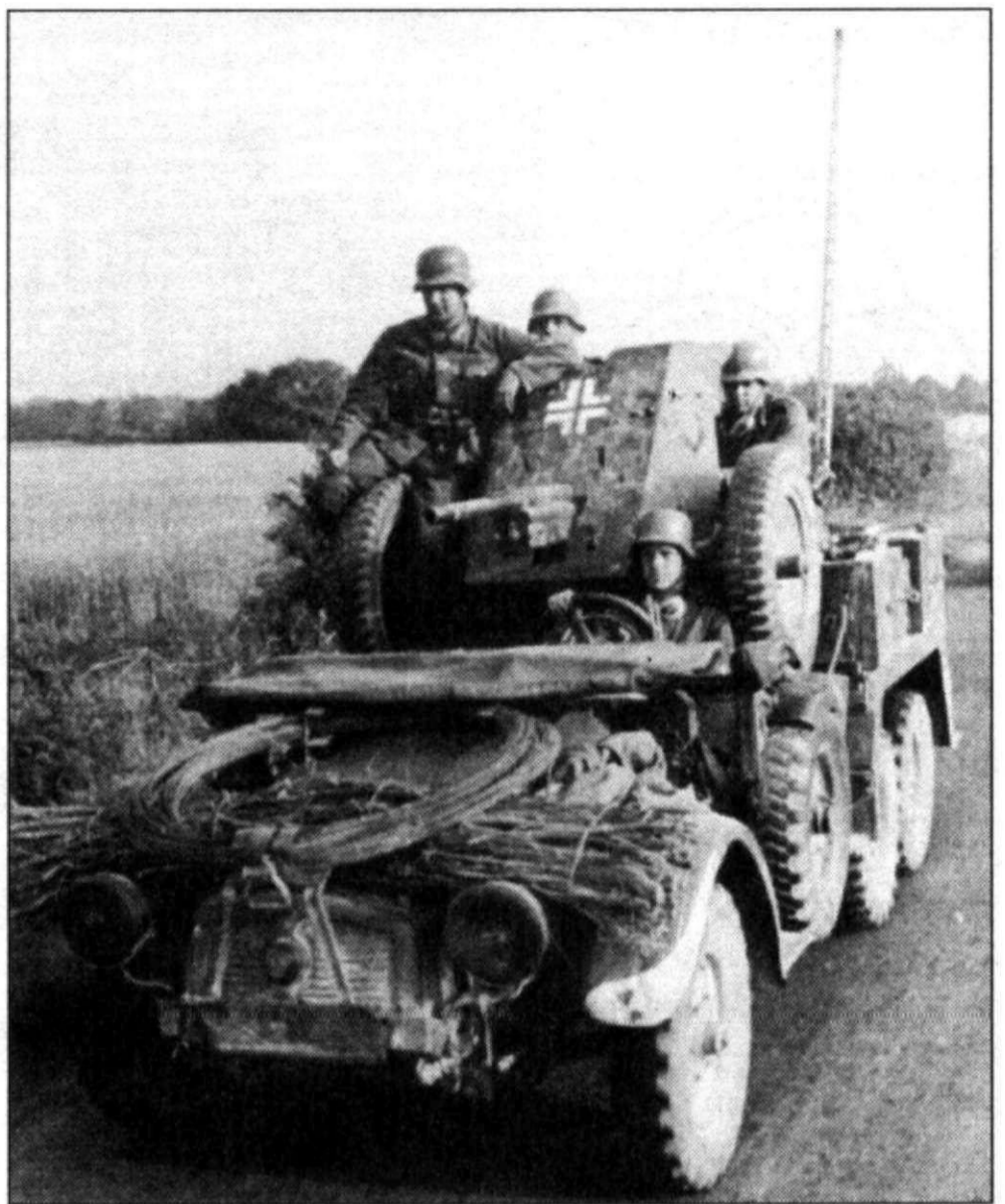
Противотанковая пушка 3.7см PAK 35/36 погруженная на тягач Kfz.69 Krupp L2 H143. На орудийном щите угловой крест необычных пропорций. Фото периода интервенции во Францию.
