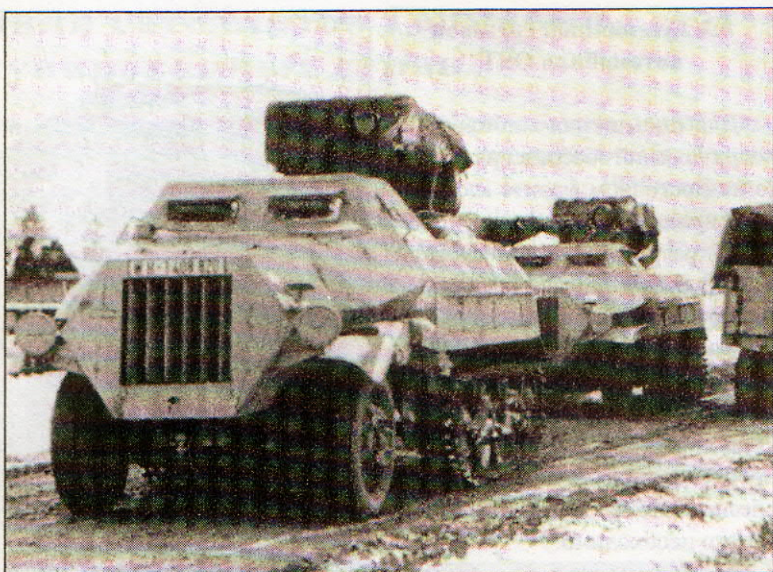
Ракетная установка Nebelwerfer на бронированном шасси «Maultier».
