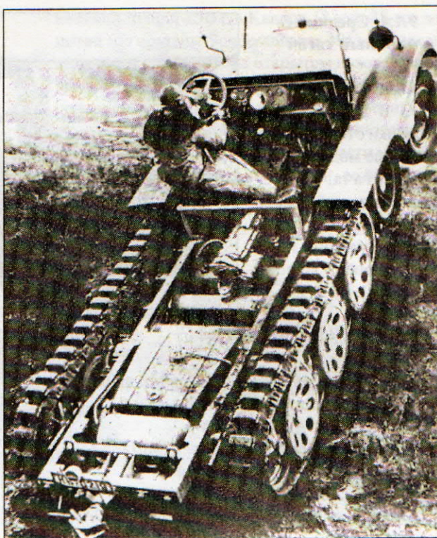
Шасси HL kl 6 проходит испытания.
