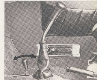
Die Heizung wird mit einem Schwenkgriff betätigt, der vor dem Schalthebel angebracht ist.
