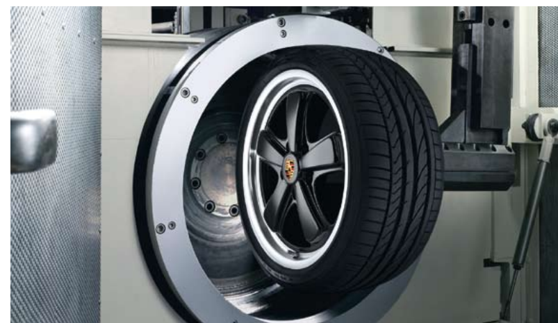
19 inch Sport Classic wiel in ZWARP test (testbank met 2 assen)
