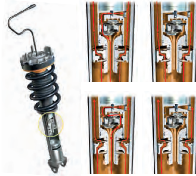
Links: Zugstufe Arbeitskolben und Bypass, sportlich-komfortable Abstimmung
