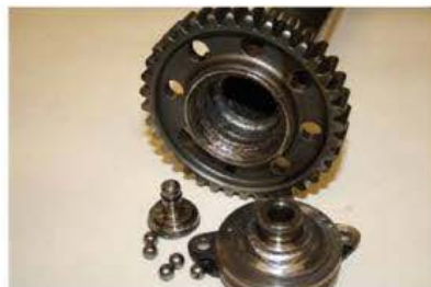
Après : Hartech peut réparer et prévenir la casse de l'IMS en utilisant un axe plus solide et en changeant le roulement
