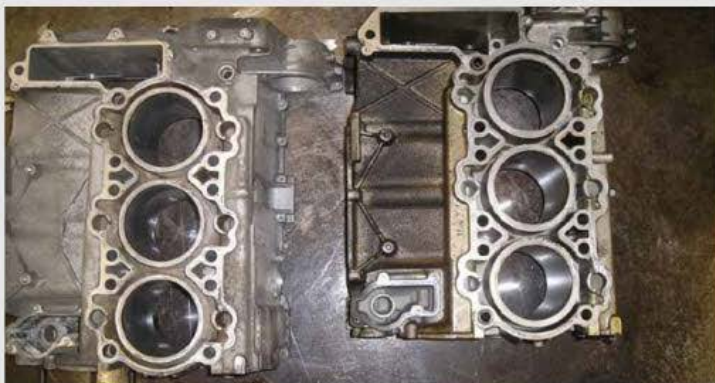
Une dissection de la culasse (photo de gauche) montre les points faibles susceptibles de se fissurer (en haut à gauche). Un problème largement dû à la fabrication, mis en évidence (photo de droite) par le bloc d'une Boxster S sur le côté droit de la photo, tandis que le bloc à gauche de l'image montre un bloc de 996, aux parois de cylindre plus minces et plus faibles.
