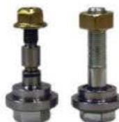
L'arbre IMS d'origine, plus faible, à gauche est remplacé par la version Hartech à droite, qui a supprimé les points de cassure.
