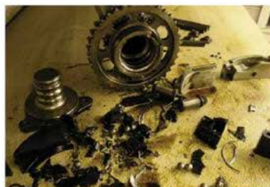
Avant : la casse de l'IMS entraîne la circulation de débris dans le moteur
