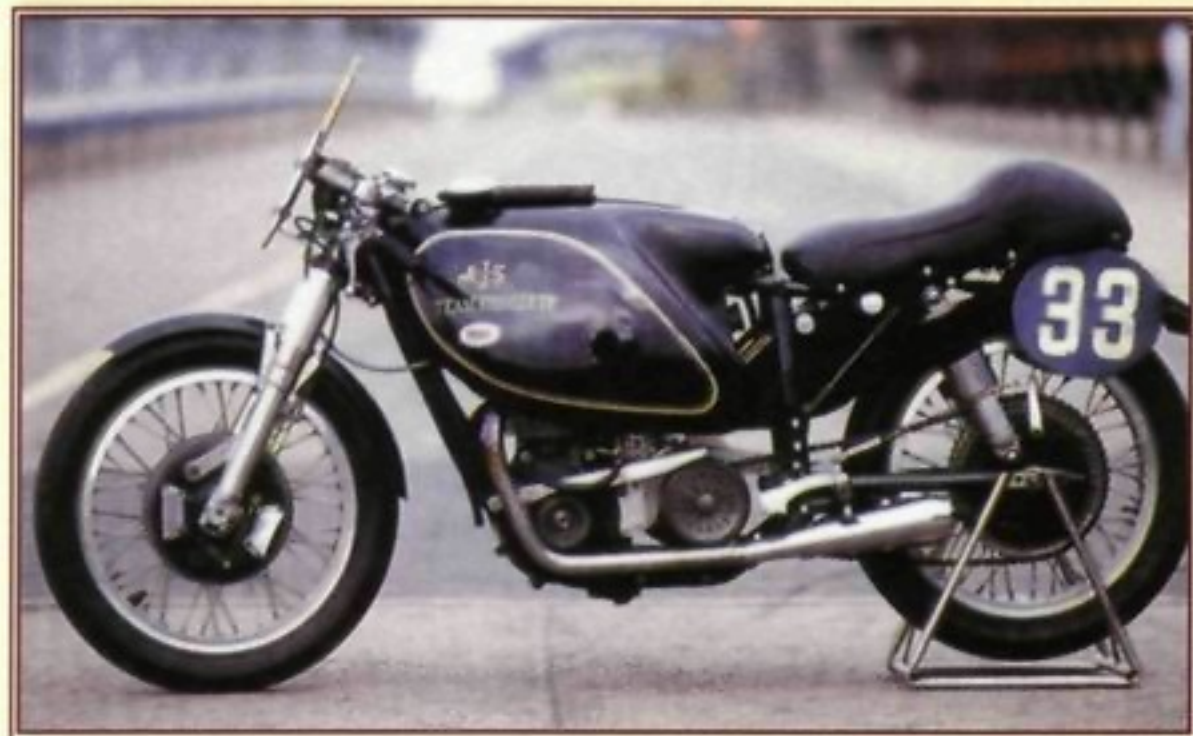
Мотоцикл AJS класса 350 см³ с трехклапанной головкой двигателя.
