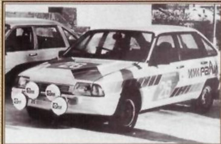
В середине 80-х годов ЦК ДОСААФ СССР сделал заказ Ижмашу на массовый выпуск автомобилей для спорта многоцелевого назначения на базе "Иж-2126". Машина имела форсированный до 138 л.с. уфимский двигатель "412", новый дизайн кузова, усовершенствованные передние и задние подвески, реечный рулевой механизм. К сожалению, денег на заказ не оказалось, была выпущена только опытная партия из четырех автомобилей.
