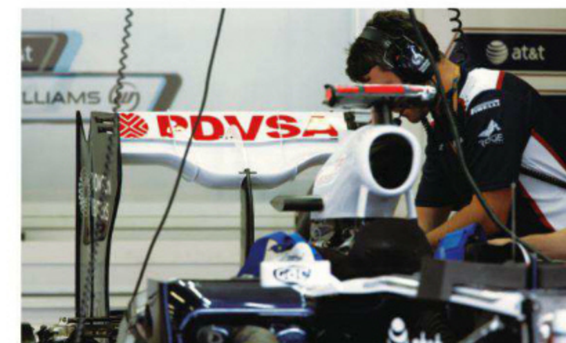
Rd.12 Belgium カナダではお蔵入りに終わった異形タイプのリヤウイングだが、スバに再登場。ここでは、レースでも使われた。規定クリアのために、下がったセンターはアールを揃えず、角張った形状。
