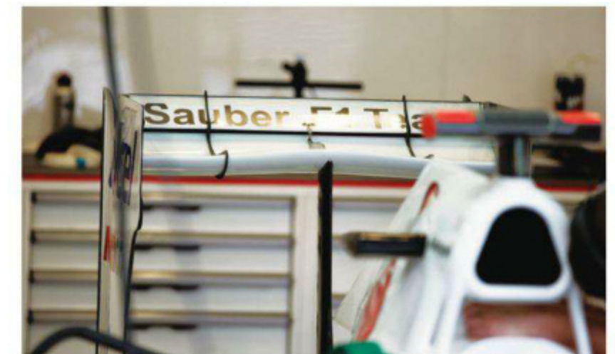
Rd.12 Belgium スパに持ち込まれたレスダウンフォース・スペックのリヤウイングは、翼上スプリッターの位置が開幕当初の仕様の左右2カ所に戻されていた。DRS動作部も少しでも底抗を抑えるよう、背の低いタイプだ。
