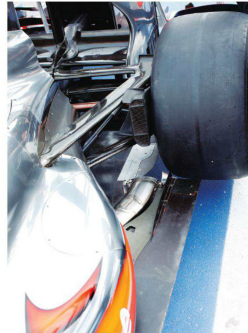
Rd.7 Canada レッドブルやフェラーリのようなカバー装備はなく、エキゾースト処理はテールパイプがむき出し。直後のフロアパネルは挟まれるような形で、リヤタイヤとの間のスペースに排気を吹きつける。
