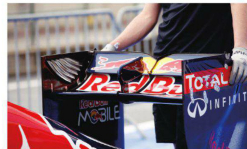
Rd.11 Hungary 標準スペックとも言えるリヤウイング。マキシマムのダウンフォースレベルが要求されるハンガロリンクのコース向けに、全体に最大限の仰角をつける設定なのが、翼端板のネジ穴の位置からわかる。
