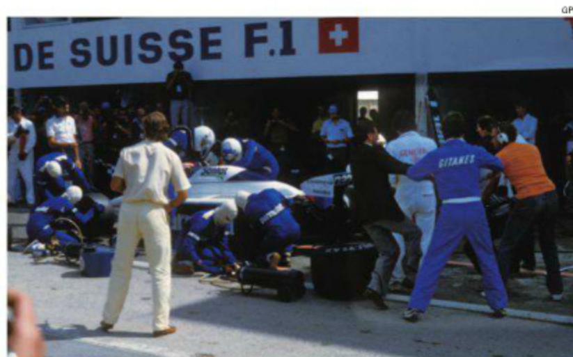
このフランスGPで燃料補給を行なうピットストップ戦略を初導入した。スタート時の燃料搭載量を少なくでき、重量によるラップタイムのロスを小さくする効果があった。(Rd.11 France)
