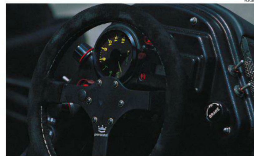
インストルメンタルパネルにはアナログのタコメーターと、デジタルのコンピュータディスプレイのみというシンプルな構成に。右下にはフレキバランスの調整ダイヤルが見える。ステアリングはパーソナル製。
