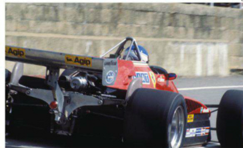
リヤサスペンションはロッカーアーム式。シーズン終了後に突如規定が変更され、126C2は結果的にグラウンドエフェクター最後のチャンピオンマシンとなった。(Rd.10 Great Britain)
