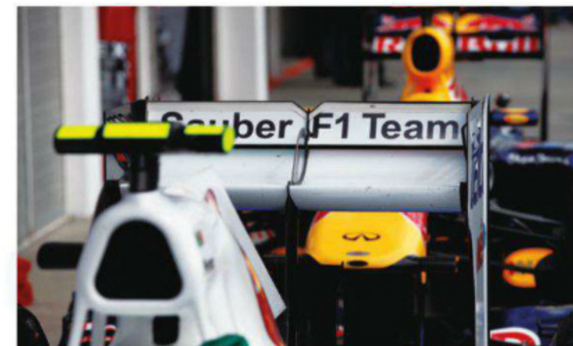
Rd.11 Hungary センターステアはリヤウイングのメインプレーンに食い込むような設計がされ、翼を囲むスプリッターもそこに接続されている。DRSの動作部はこれを避け、向かって左にややオフセット。
