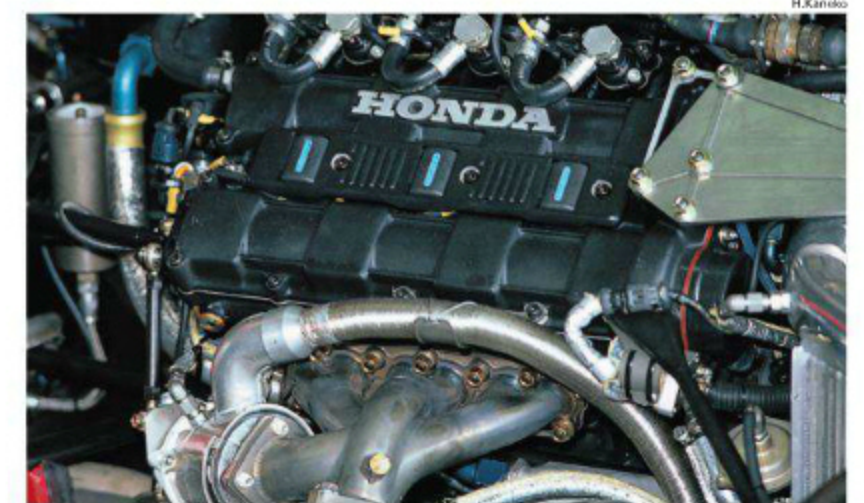
ホンダ最後のターボエンジンとなったRA168Eは、2.5bar規制にもかかわらず、1万2500回転で685馬力以上を発生。圧倒的な強さでターボ時代を締めくくった。
