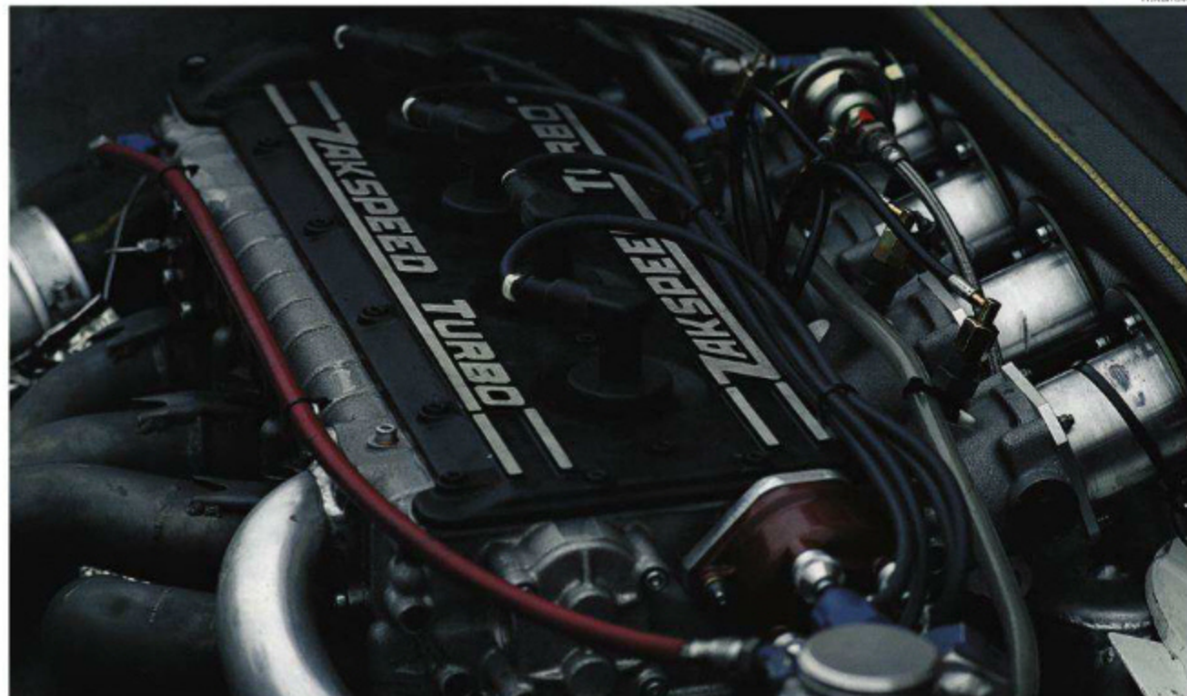
ザクスピード独自の4気筒エンジンは、フォードのツーリングカーレースの経験から作られた。自動車メーカーのような予選用エンジンを持つ余裕はなかった。(Rd.3 San Marino)
