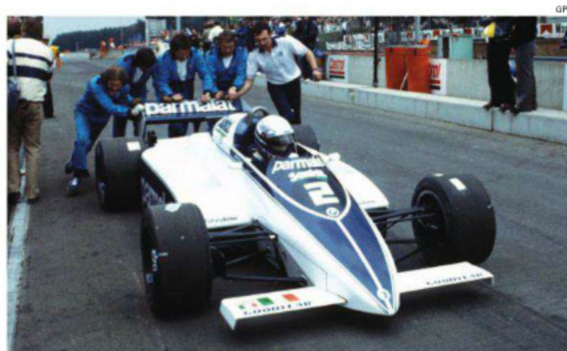
チームカラーに押されてピットレーンを行くノドレーゼのBT50。BT49同様にフロントサスペンションはブルロッド式。フロントウィングは極めて薄く、車体底面への気流を重視したもの。(Rd.5 Belgium)
