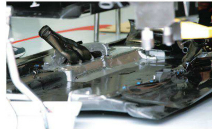
Rd.12 Belgium フロアパネルからエキゾーストのテールパイプが突き出している。フェラーリ・エンジンのマニホールドは前の高い位置に出されており、堅牢性を高めるため、ここまでがフロア側の接続となる。
