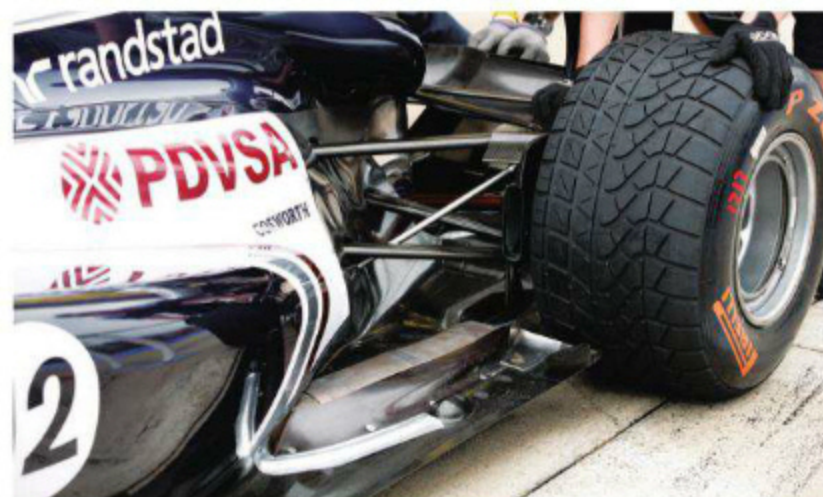
Rd.11 Hungary しかしハンガロリンクには、あらかじめ新仕様のエキゾーストブローシステムを持ち込む。今回はパイプ全体をカバーでは覆わず、外側に気流フェンスを兼ねた処理。出口も真っ直ぐ後方へと向けられた。
