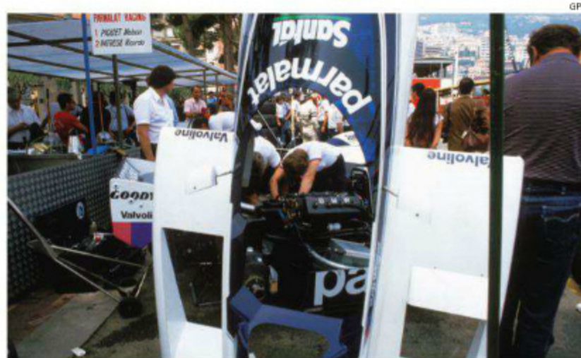
BT50のボディカウルはBT49と同様に、前後2分割である。前側はノーズ先端からコックピットの背後までカバーしている。左右で排熱ダクトの形状が異なるが、左がインタークーラー用。(Rd.6 Monaco)
