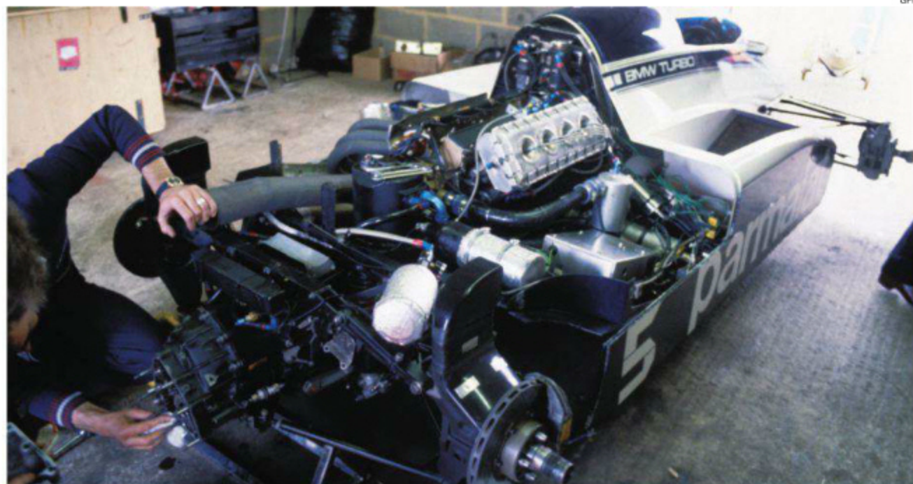
フランスハッチのカレージ内のピケ車。エンジン本体は左に30度傾けた形で設計され、シリンダーヘッドとエアチャンバーがコックピットの後ろに隠れる。(Rd.10 Great Britain)
