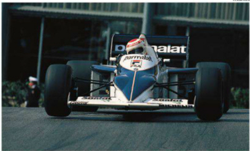
ノーズカウル上部のバルジが目立つBT52。このモノコックではシーズン序盤の欠点だったギヤボックストラブルも出たが、なんとか2位に入った。(Rd.5 Monaco)
