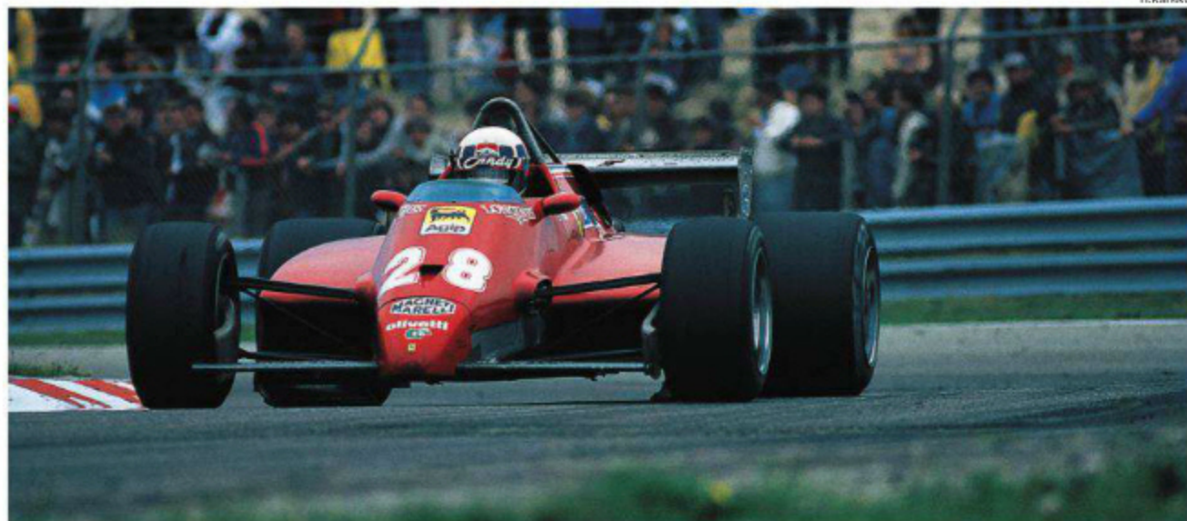
タイヤ摩耗は、グッドイヤーの最新スペックとの相性の悪さが原因。北米ラウンドからブルロッド式フロントサスを投入することで、この問題は解消。(Rd.9 Netherlands)
