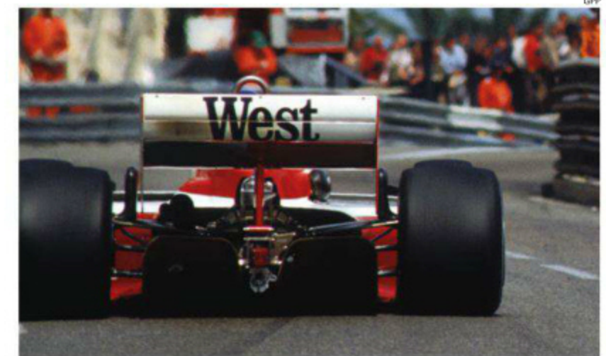
リヤサスペンションもブルロッド式ダブルウィッシュボーン。排気管は左側にあり、車体後端に出す。スリムな直列エンジンのおかげでディフューザーを大きくできた。(Rd.4 Monaco)
