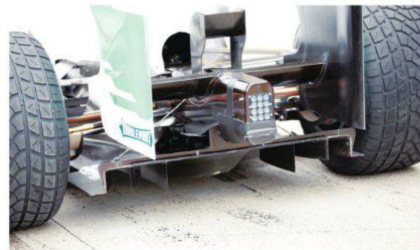
Rd.11 Hungary ディフェンダーのベースとなるデザインは序盤の遠征レース終了後に入れたものからそのままだが、紐かく改良の跡、隔壁の設定が異なり、上部のリップにはスリット処理を追加。
