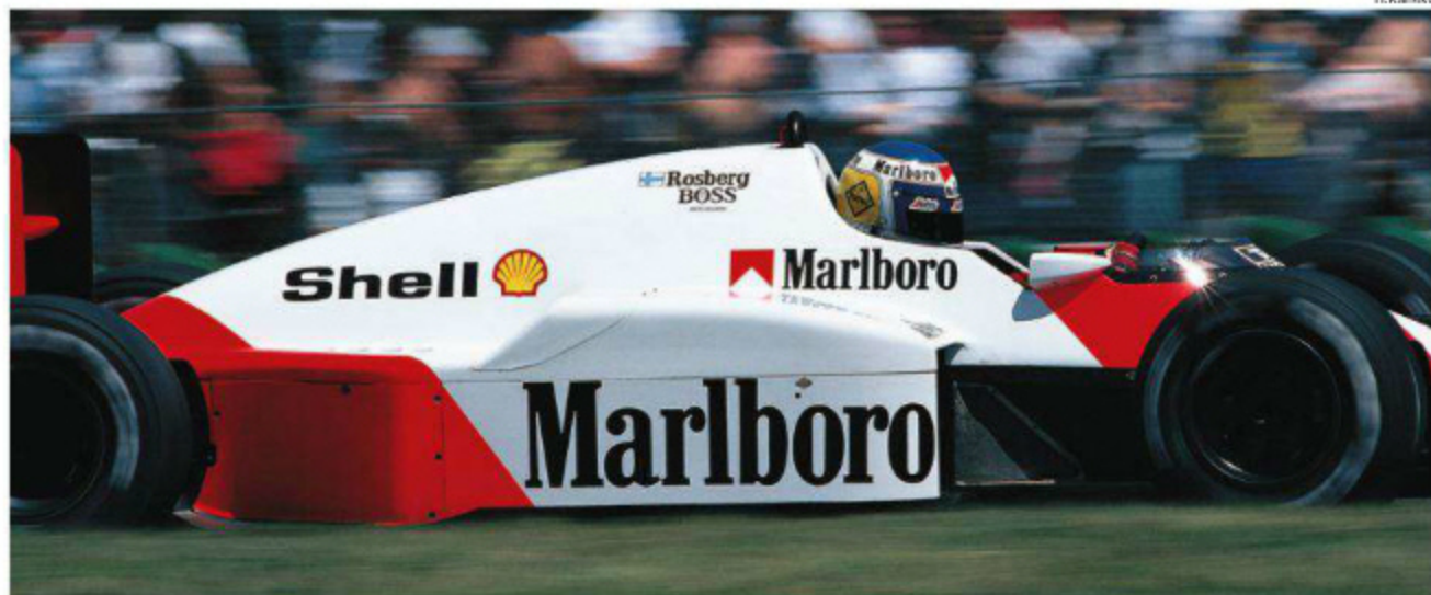
ターボチャージャーのポジション変更により、サイドポッド後部のエアインレットは消滅。ラジエーターエアの排出口部分には、エクステンションカウルが装着される。(Rd.6 Canada)
