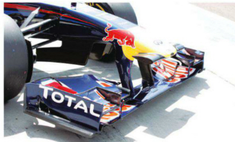
Rd.11 Hungary ハンガロリンク向けのノーズセクションは、フロントウイングの吊り下げステーが以前の前後幅が狭いものに置き換わっている。ノーズ下デバイスも、旧仕様のバジボードタイプとなる。
