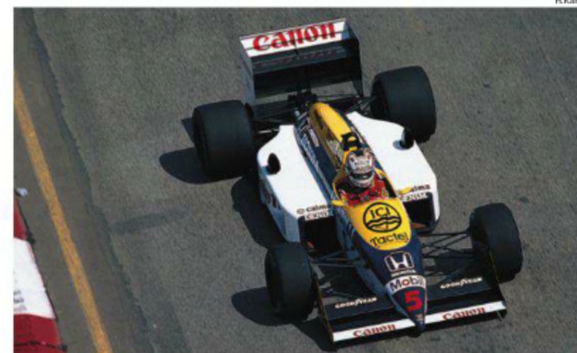
FW11とほとんど見分けのつかないFW11Bだが、ロールバーの位置が変更されたことで、リヤウイングへのエアフローが改善。リヤのアンダーボディも改良されている。(Rd.1 Brazil)
