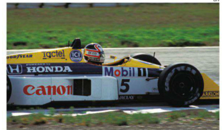
ターボ・インレットへのエア流入経路を見直し、サイドポッドからシュノーケルが消えた後半戦。フロントウイングの大型エンドプレートは、シーズンを通して使われた。(Rd.13 Spain)
