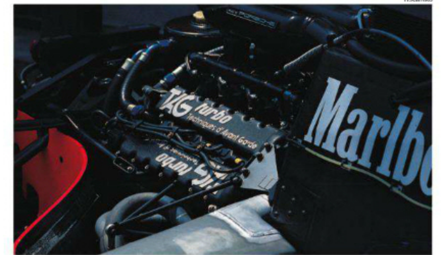
レース用のブースト圧で750馬力を発生するTTE PO1。最大回転数は1万2000回転にまで達した。シーズン中盤には、それまでは排気系の関係で左右対称ではなかったKKK製ターボが、完全にシンメトリカルなタイプになった。
