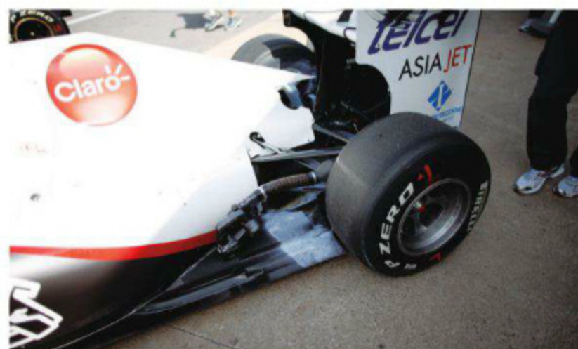
Rd.7 Canada このモントリオール時点のリヤタイヤ直前のフロアには、まだエキゾーストブロー開発の痕跡が残る。テールパイプ収納のためのカバーがあるが、実際のエキゾーストはカウルの開口から出されている。
