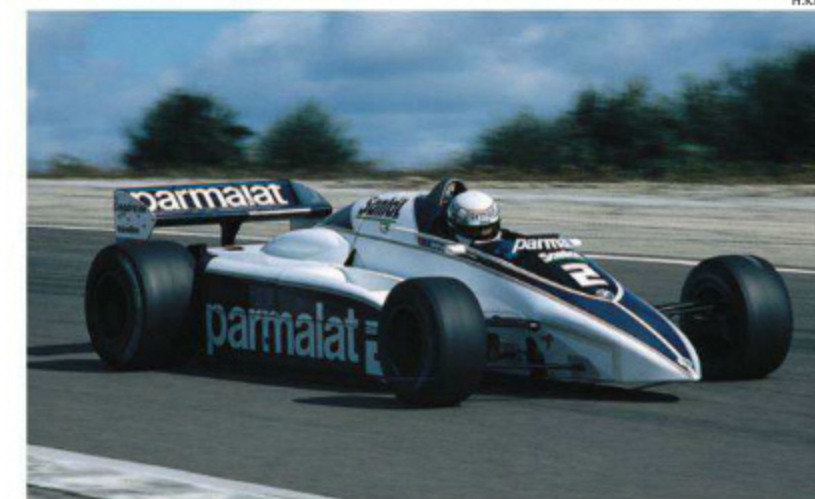
BT50で走るバトレーゼ。撮影日時は不明だが、バトレーゼがBT50に乗るのは開幕戦と第9戦オランダGP以降。BT49と同様に高速コースでは空気抵抗となるフロントウイングを取り去っていた。
