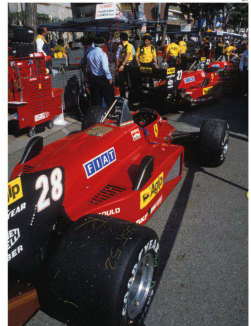
大型のリヤウイングエンドプレートが特徴の156/86は、全部で9台が製作された。このモノコックでは、低圧転対応の小型ターボを使用、リヤサスの取り付け部も下げられた。(Rd.4 Monaco)
