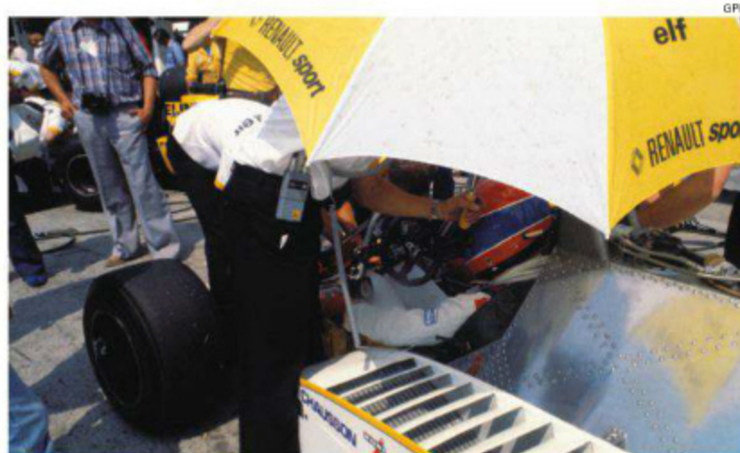
RS10のシャシーは、リジェからきたミシェル・テツによるデザイン。丸頭リベットが多数打たれた工法も、モノコック形状もリジェJS11と似て、いかにもフランスのF1である。(Rd.10 Germany)
