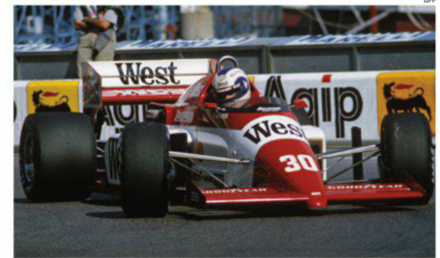
モノコックを走る841とパーマー。フロントタイヤの後方の乱流を飛ばすディフレクターが増設されている。左のバックミラーは下を向いている。ここで841は初完走11位を記録した。(Rd.4 Monaco)
