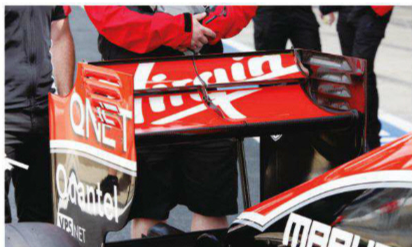
Rd.9 Great Britain リヤウイングのDRS動作は、他の陣営たちが採用する上から引き上げるタイプではなく、下から押し上げる形であることがわかる。装置の露出は少なく、滑むが、戻りの遅いデメリットがある。
