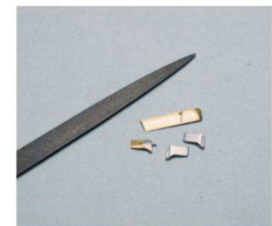
コクピット両脇のフィンが0.4mm厚の真鍮板で置き換え、エッジを削ることでより薄くシャープに見せることができる。接合面には直角方向に切り込みを入れ、0.3mmの洋白線を差し込んで半田で固定した。
