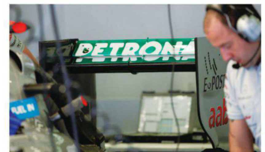
Rd.12 Belgium スパに持ち込んだレスダウンフォース・スペックのリヤウイングは、他車と較べるとフラップのサイズが長めにとられ、メインプレーンの前後長が短い。翼端板のスリット開口が削減している。
