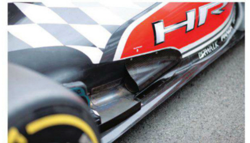
Rd.10 Germany 開幕当初の仕様ではエキゾーストはディフューザー上のセンターに近いところに出されていたが、第7戦時点からこのサイドに改められる。メルセデスGPの前手法に近い方式で、排気は側面に導かれる。
