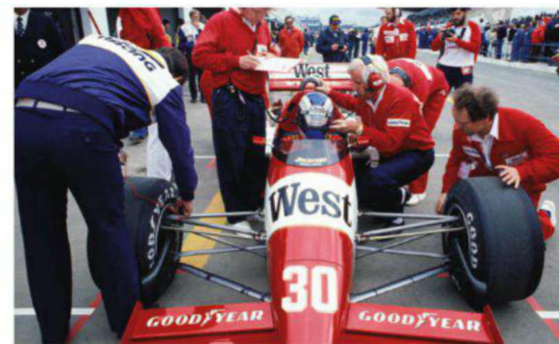
841のフロントサスペンションは、当時の標準的なブルロッド式鋼管製ダブルウィッシュボーン。アッパーアームは丸断面の鋼管だが、ロワーアームは気流に配慮した異断面型である。(Rd.2 Portugal)
