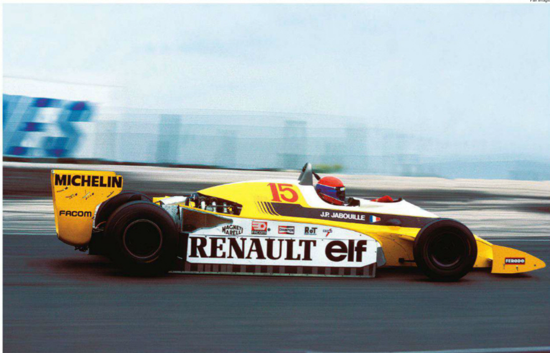
ディジョンでのジャブイユのRS10。スライディングスカートを備えた本格的グラウンドエフェクトカーである。コックピット右側のNACAダクトには、フランス国旗が描かれていた。(Rd.8 France)
