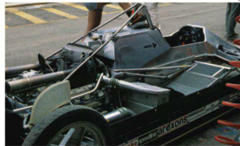
アルミをリベットで組み上げていたフェリギエリ派から一転、ボスルスウェイトは、アルミニウムのカム接着工法でモノコックを製作。マラネロはようやく近代的な手法に。
