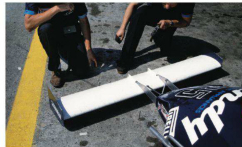
左がTG181の標準的なフロントウイングだが、こちらはフロントウイングを上下と前後を逆にして、路面近くに装着したもの。車体底面へ向かう気流を増やすための習作。(Rd.11 Austria)
