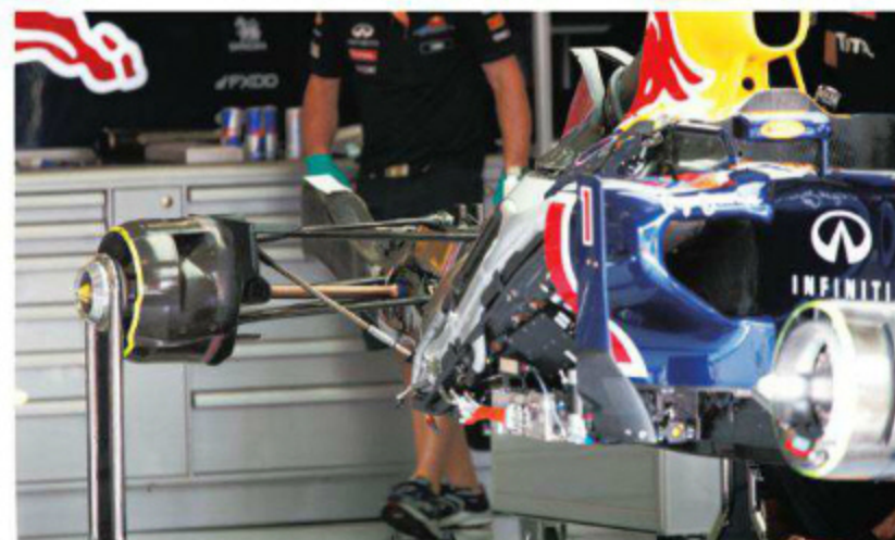
Rd.12 Belgium ビレリ向けの熱対策なのか、ブレーキのダクトカバーには前後とも、今年になって各種異なる形状が見られるようになった。完全な円筒ではなく複雑に折られ、上部には開口が設けられる。
