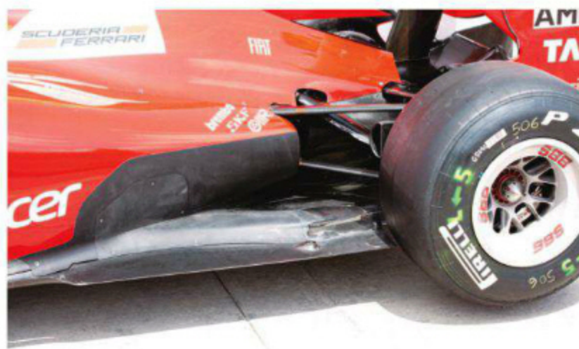
Rd.8 Europe 大規模バージョンアップを施す以前のラストレースとなった、バレンシアでのリヤエンド。サスの前衛アームがギヤボックスに接続を受ける周辺カウルが開閉され、後方に向かってエアを抜いていた。
