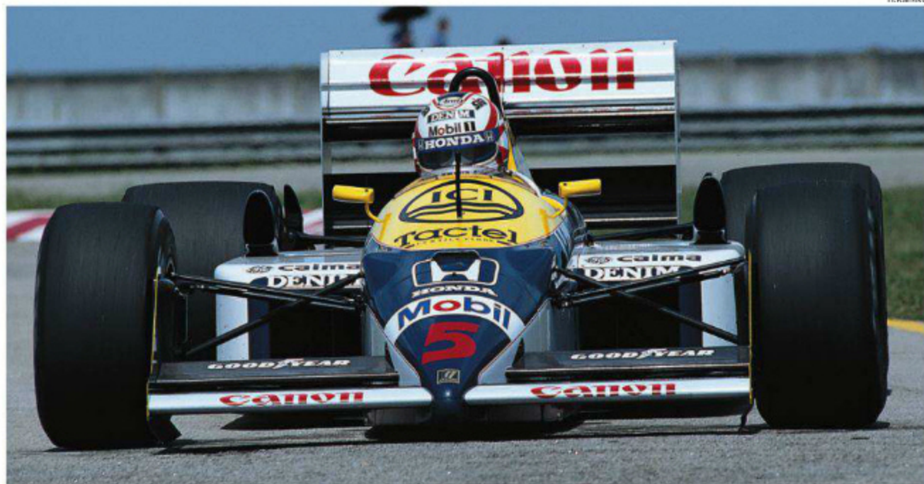
ピケより座高の高かったマンセルは前年まで、より大型のロールバーを使用していたが、モノコック改良で着座位置が低くなり、ピケ同様の小型のものを使用可能に。(Rd.1 Brazil)
