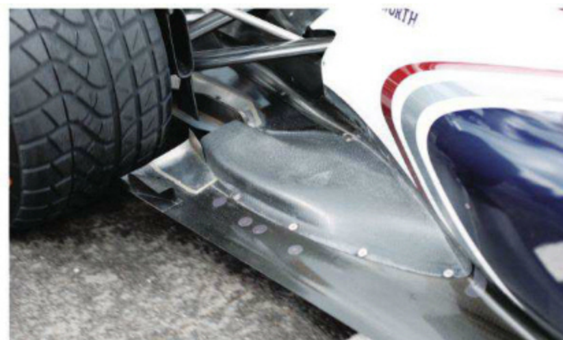
Rd.9 Great Britain ある意味で、エキゾーストブロー運動の発端となったウィリアムズ。最後の審判となったシルバーストンの際にも、開発中のシステムを持ち込んでいた。排気はクルマの中央寄りに向けられる。
