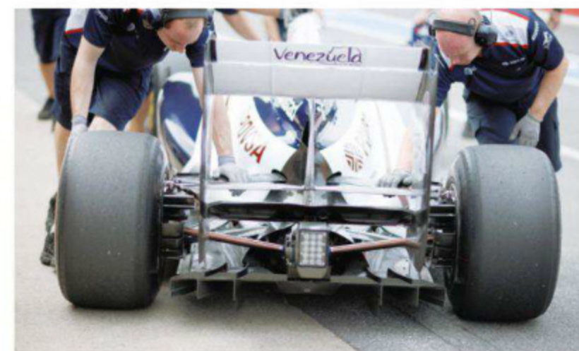
Rd.7 Canada 簡単な脱着処理で、レスダウンフォース方向に振ったとみられるカナダでのディフューザー。上面のリップ折り直しは通常、サイドまで気流経路の左右3カ所ずつにおよぶが、両端2枚が取り外されていた。
