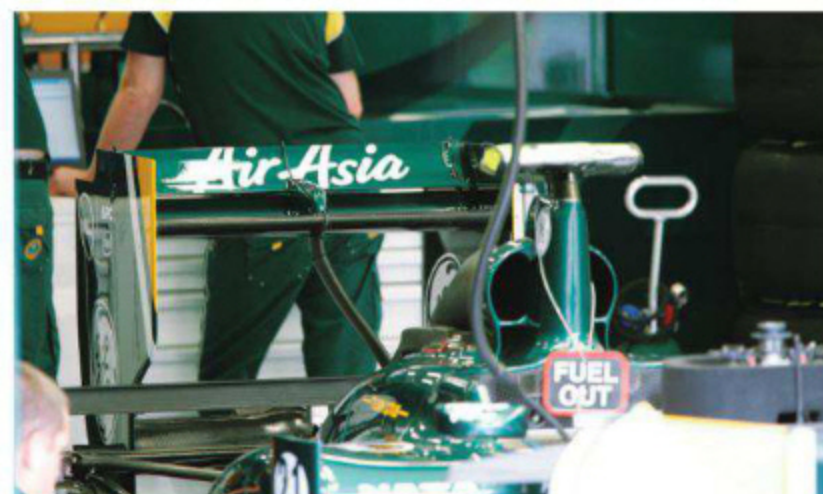
Rd.12 Belgium スパには、スペシャルスペックとも言えるリヤウイングを準備した。フラップは短縮され、メインプレーンも含めて、通常より仰角のためのアールが抑えられている。DRSの動作部も小さい。
