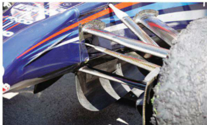
Rd.8 Europe ノーズ下の空力デバイス処理は、以前のフェラーリに似たバジボード状のものから、ザウバー風とも言える前方から見てハの字を描くタイプに変わる。ただし、下で外側に開くアールは浅い。
