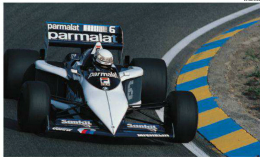
BT52Bになってカウリングも一新。プッシュロッドサスペンションロッドの付け根にあったバルジが消滅。空力的により洗練されたスタイルになった。リヤウイングにはガーニーフラップも装着。(Rd.12 Netherlands)
