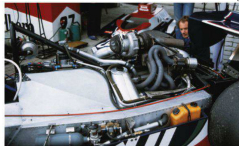
ハート415Tエンジンの左側の排気管とウエストゲートバルブの配置がわかる。前頁のモノコック時と異なり、ターボチャージャーがエンジンの上に配置されている。(Rd.12 Netherland)
