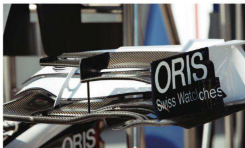
Rd.8 Europe 第6戦時点で導入された、事実上セカンドジェネレーションとなるフロントウイング。ダブルタイプのアッパーエレメント、分割型の翼端板等、主流となるデザイン手法はすべて押さえる形だ。
