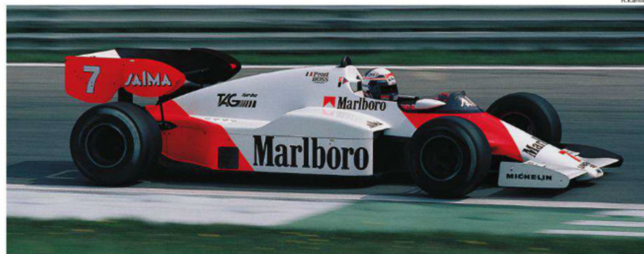
シーズンを通して、ボディワークにはほとんど変更の見られなかったMP4/2だが、第13オランダ以降はサイドポッド後部のターボエアインテークが大型化された。(Rd.13 Netherlands)
