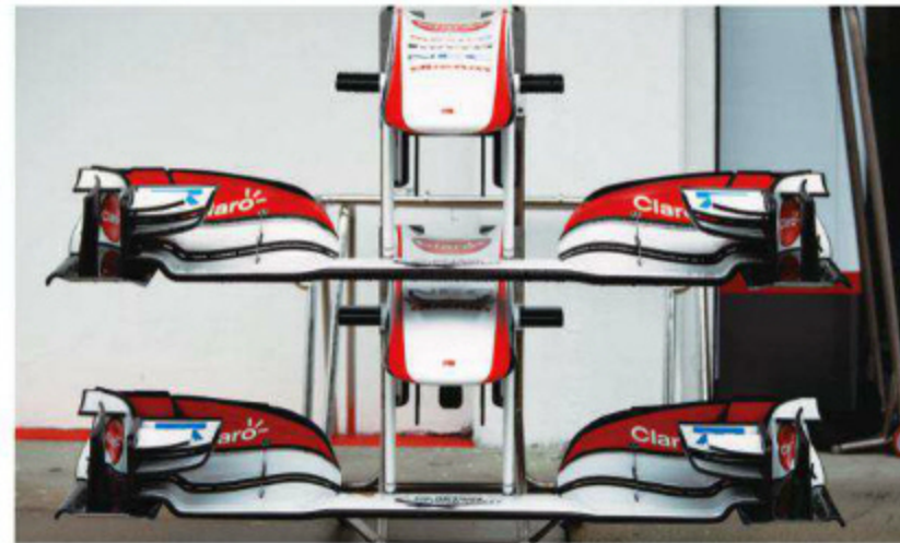
Rd.11 Hungary 第5戦で登場させたフロントウイングからベースの仕様を変えず、セットアップの範囲でさまざまなコース性格に対応。下はカーニーフラップが後端全体を囲んでいるのに対し、上は内が切られている。
