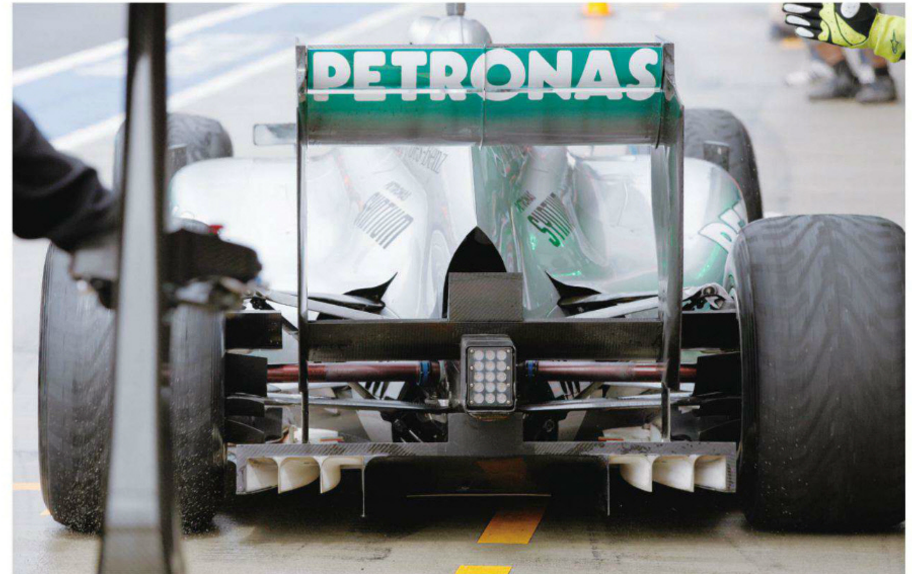
Rd.9 Great Britain エキゾーストシステムの変更で、当たり前だが、エンジン排気のディフューザーに向けて流れる場所も変わってくる。従来仕様では見られなかった、サイドチャンネル内の耐熱材使用が行なわれている。
