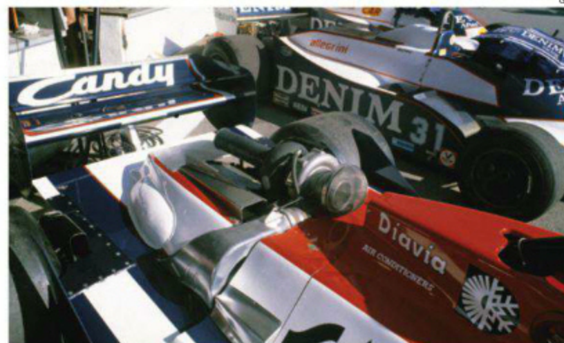
エンジンの上に配置されたターボチャージャーは、吸気部分が前を向く。排気タービンは高温になるため、エンジンとの間には断熱板がある。吸気管の一部はボディから露出している。(Rd.7 Spain)
