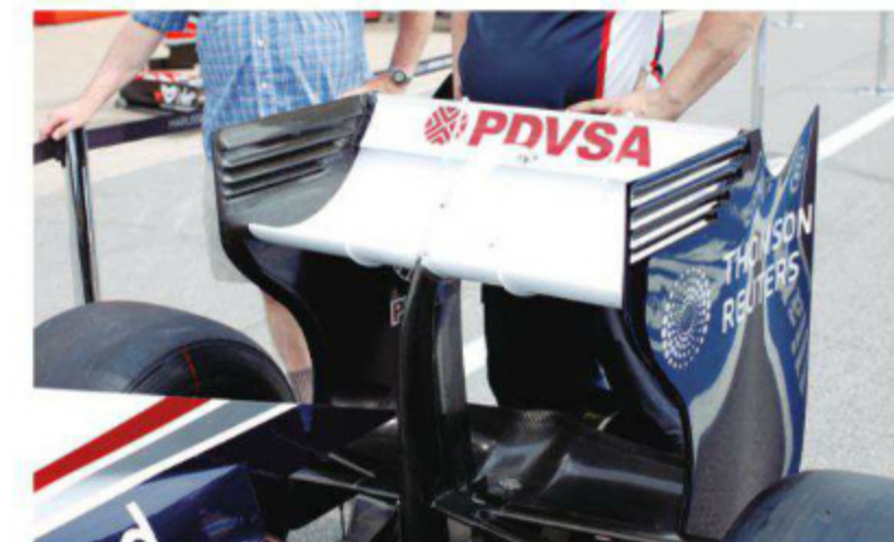
Rd.7 Canada モントリオールで実際に使われたタイプのリヤウイング。これも開幕当初のものと同様とレスダウンフォース寄り。フラップの前後長を短く切ったDRS作動時の動きを重視したタイプだ。
