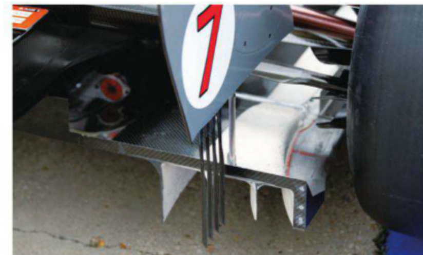
Rd.11 Hungary 新しいエキゾースト処理は、ディフューザーのサイドチャンネルを上下で囲い込むように高温のエンジン排気を流す。前輪ドライブシャフトは、リヤウイング翼端板の吊り下げスリット処理も追加を受けた。
