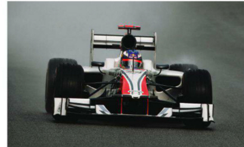
Rd.12 Belgium カーティケヤンに代わる形で、第9戦時点からリチャルドがレースドライバー起用となった。翼端板の背がリアウイングの位置より高いが、これは他を従来仕様のまま、フラップのみ短縮したことからくる。
