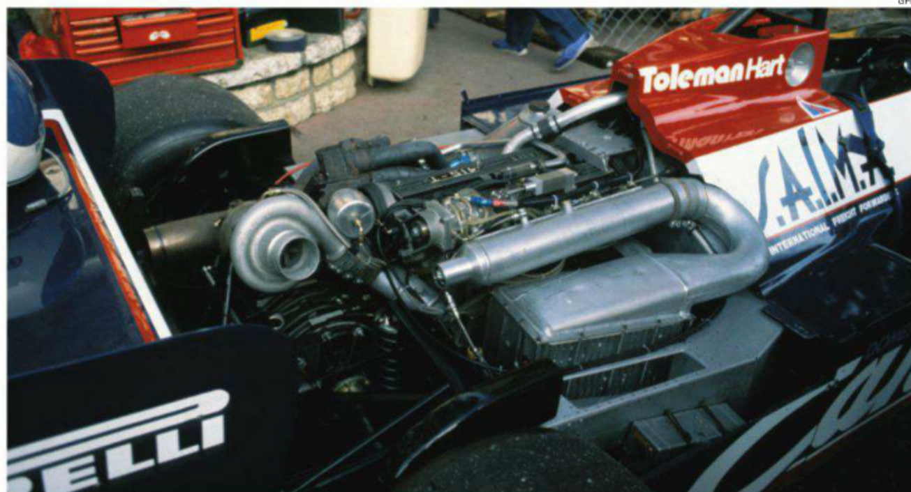
ハート415Tエンジンは車体の左側が排気、右側が吸気。ギャボックス上にターボチャージャー。吸気を冷却するインタークーラーはエンジンの脇に置かれた。(Rd.6 Monaco)
