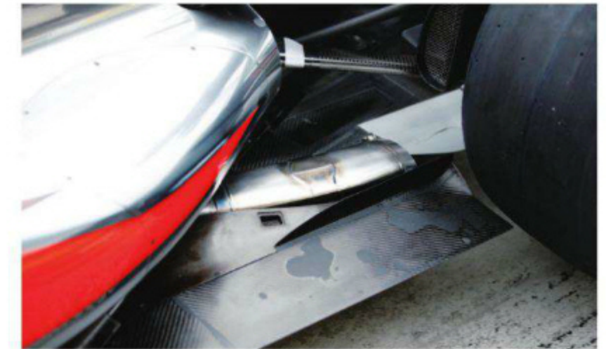
Rd.11 Hungary エキゾーストパイプは後方へ、やや下に向かって抜かれている。外側のフロアにはタイヤとの間を隔てるようなフェンス処理があり、排気が最大限の効果をディフューザーにもたらすよう導く。
