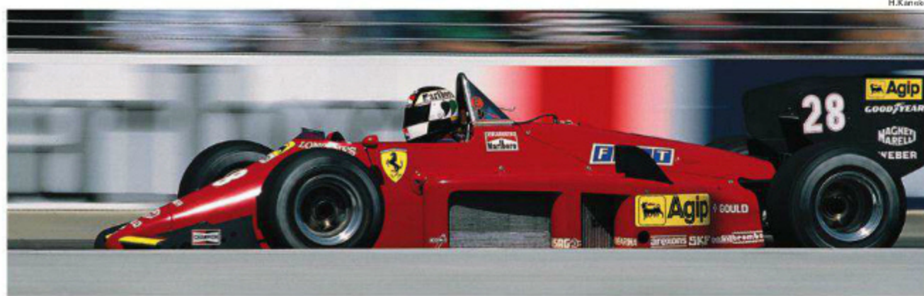
最終戦での156/86。サイドポッド側面にはラジエーターだけでなくインタークーラー用のエアアウトレットも設けられている。(Rd.16 Australia)
