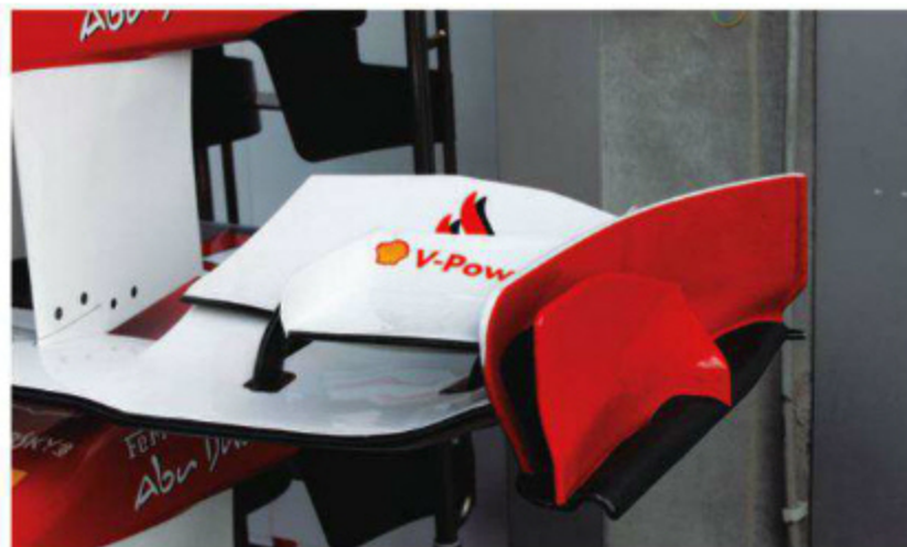
Rd.12 Belgium マッサはアップラーがダブルエレメント化されたフロントウイングの仕様が好きではなく、継続してシングルタイプを使う。ただし従来仕様とは異なり、横幅が内に長く伸ばされている。
