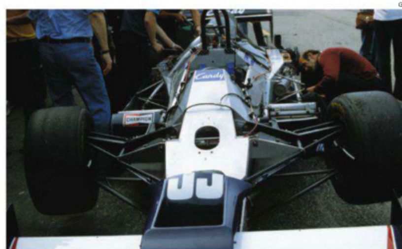
TG181のアルミモノコックは比較的コンベンショナルな設計。コクピット開口部もできる限り小さくして、剛性を高めようとする配慮もうかがえる。ラジエターは左右に配置される。(Rd.13 Italy)
