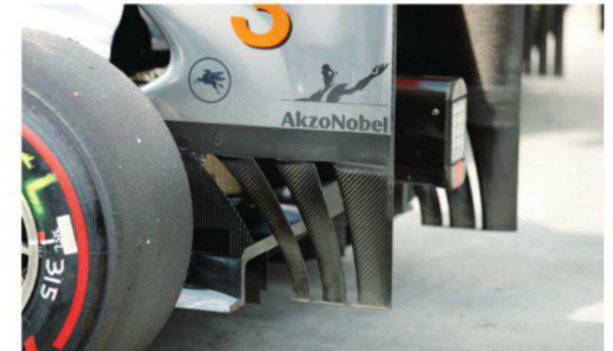
Rd.11 Hungary リヤウイング翼端板下の吊り下げスリット処理は、第9戦段階まで真っ直ぐに下されていた。だがタイヤとの距離を意識するかのような後傾のアルがつづけられ、より効率を高めてきた。
