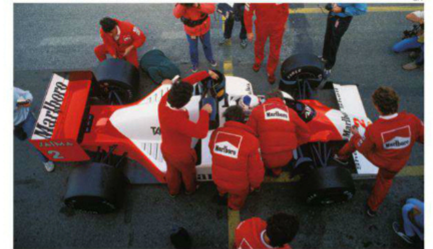
ヨークボルトラインの絞り込みはMP4/2Bになって3~4cmほどタイトなものになった。これは自製の5速ギヤボックスが、よりナローなものになったことに対応したもの。アンダーボディの形状も変更されている。(Rd.11 Netherlands)
