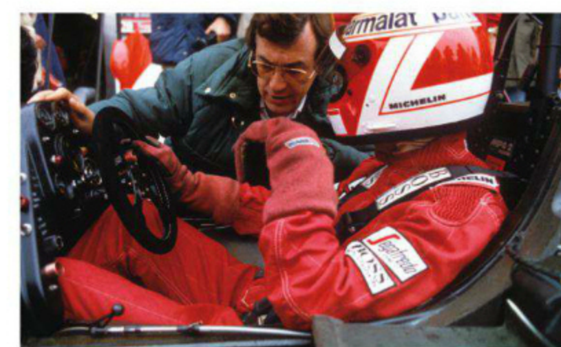
シーズンのクライマックス、第16戦ヨーロッパGPでボルシェのエンジニアと語るラウダ。MP4/2のカーボンモノコックは、塵上あたりまでしか覆わないのが特徴。(Rd.15 Europe)
