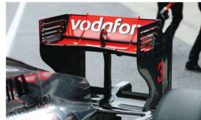
Rd.7 Canada ダウンフォースレベルが高すぎるのではないかとされた、カナダでのリヤウイング。しかし、決勝日を見舞った雨のコンディションにこれがピッタリと当たり、バトン逆転劇の原動力となる。
