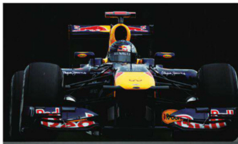
Rd.12 Belgium スパ専用を持ち込まれた、フロントウイングのスペック。メインプレーンのノーズ寄りがフラットになる直前で、上に深く折られている。金曜フリー走行で試されたが、実戦では使われない。
