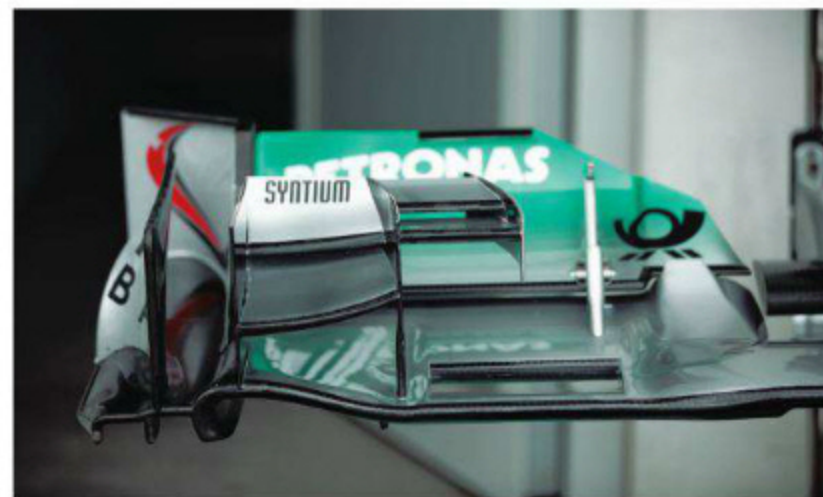
Rd.10 Germany フロントウイングによくやく、流形の処理が採り入れられた。アッパーエレメントがダブル化される。とはいえ外側ウイングレットのデザインはほぼ従来のままで、内エレメントが追加を受ける。
