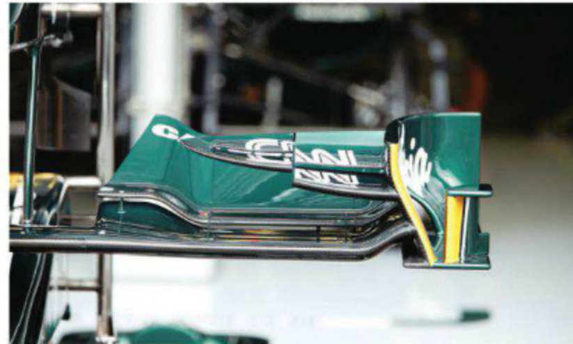
Rd.12 Belgium スパ投入のフロントウイングには、翼端板に通常仕様では見られない開口処理が設定された。また、フラップの形状についても以前のものが内側に完全な設置を持つのに対し、アールで持ち上げられていた。
