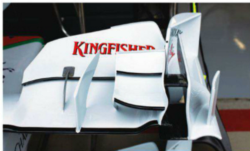
Rd.9 Great Britain フロントウイングのアップパー・エレメントはフラップ処理こそオーソドックスなものだが、外プレートには波打つような3D形状が施されている。また、主翼上のフィンには外向きにエアを流す。
