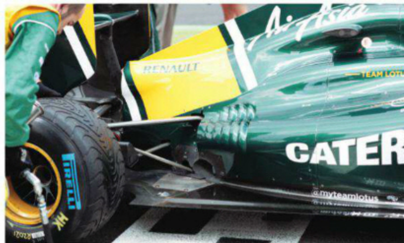
Rd.9 Great Britain エキゾーストブロウ規制の、まさに満中にあつたシルバーストンの仕様。元システムでの完成度は低かったようで、排気をフロアに導かせない以前のスペックを持ち込んできた。
