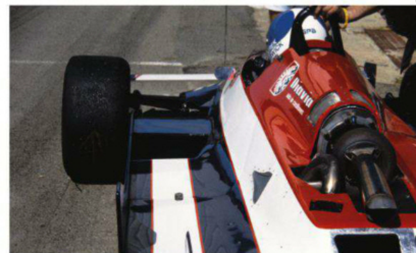
82年開幕戦でのTG181C。ターボチャージャー付近は、前頁のイタリアGP用と同様にかなり整然とした。側面のNACAダクトは排気部分に冷却用の外気を取り込むもの。(Rd.1 South Africa, 1982)
