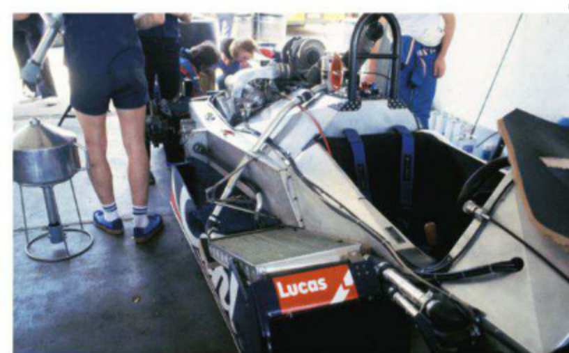
デビューから4戦目の段階でのTG181の車体右側。ラジエターの脇から車体前方へオイルクーラー用の配管が延びる。ラジエターの配管も、取り回しと設計に苦労がうかがえる。(Rd.7 Spain)
