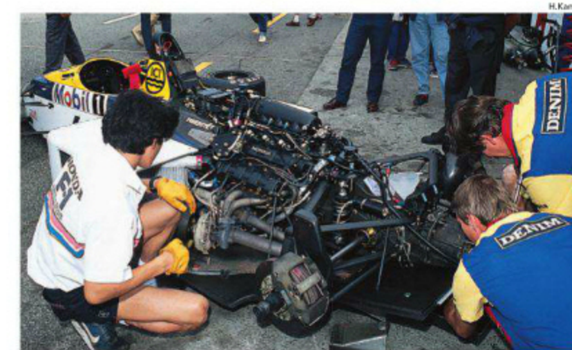
RA166Eは前年型よりわずかに長く、FW11のホイールベースもFW10より61mm長くなった。ブレーキは、主にフランスSEP社製のカーボンディスク&AP製キャリパーを使用。(Rd.13 Italy)
