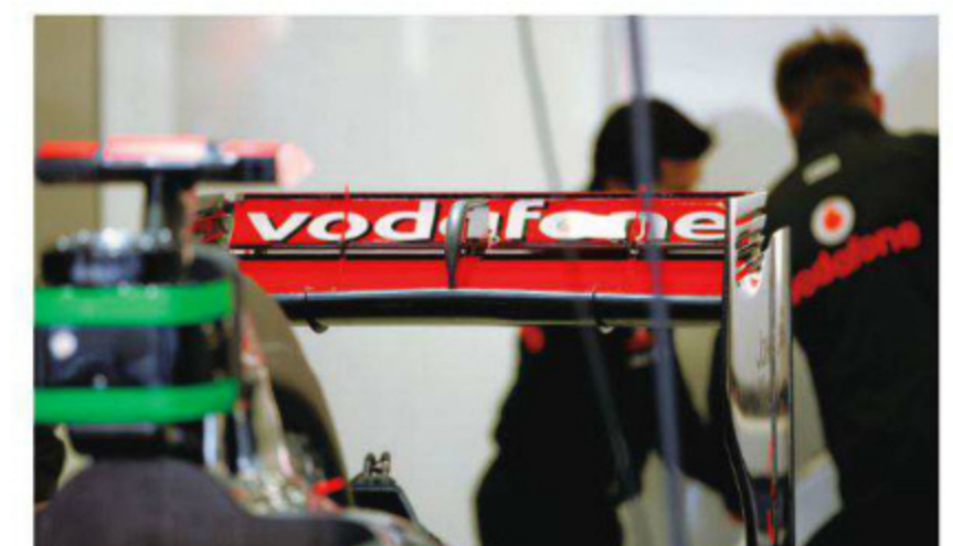
Rd.12 Belgium センターステーが削減し、レッドブル風のDRS作動部となった新型リヤウイングは、ここからようやく実戦投入の日の目を見た。翼端板はテストタイプより短くされ、最高速重視の仕様だ。
