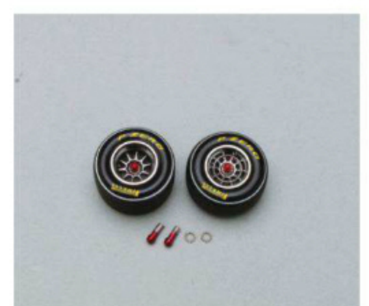
ホイールは下地にウレタンの黒を濡れるように吹き、アルクラッドで塗装。エアバルブは特殊な位置にあるので、追加する場合はよく確認すること。センターロックはキットのままでも十分なディテールを持っている。
