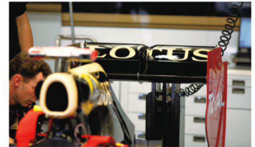
Rd.12 Belgium 同じレスダウンフォース寄りのコースでも、スパにはモントリオールのような異形デザインのリヤウイング投入はなし。通常スペックから翼長や仰角を抑える形で、対応がされた。
