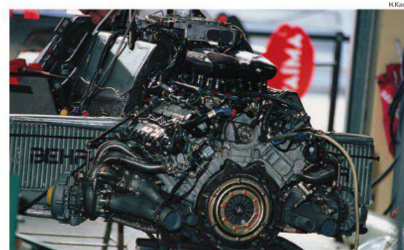
ホンダと同じ80°V6エンジンを採用したボルシェ製TTE P01エンジン。バーナードの要求に従い、徹底した低重心化が図られている。KKK製ターボはモナコから軽量バージョンが投入された。
