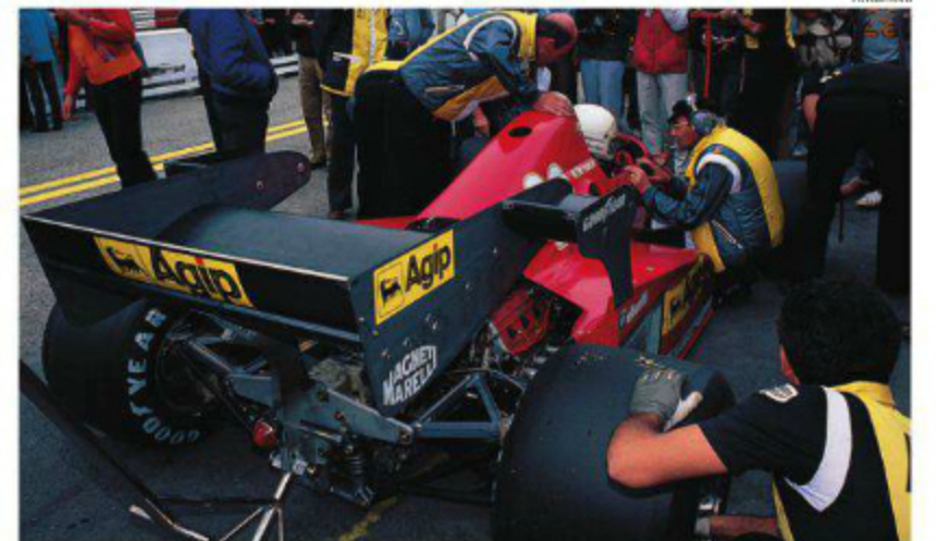
左右にウイングレットを持つ大型ウイングは83年ターボ車の特徴だが、ブラバムルノーなどのミシュラン勢が高速サーキットでウイングレットを外していたのに対し、グッドイヤーの特性からフェラーリは終始この仕様だった。
