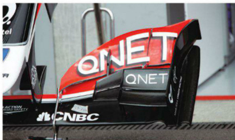
Rd.12 Belgium アッパー・エレメントが装着済みで、これがフロントウイングの本来仕様となる。流行のダブル化は果たされており、内が高いところも現在の技術思想に沿う。翼端板は上部のみが外への湾曲。
