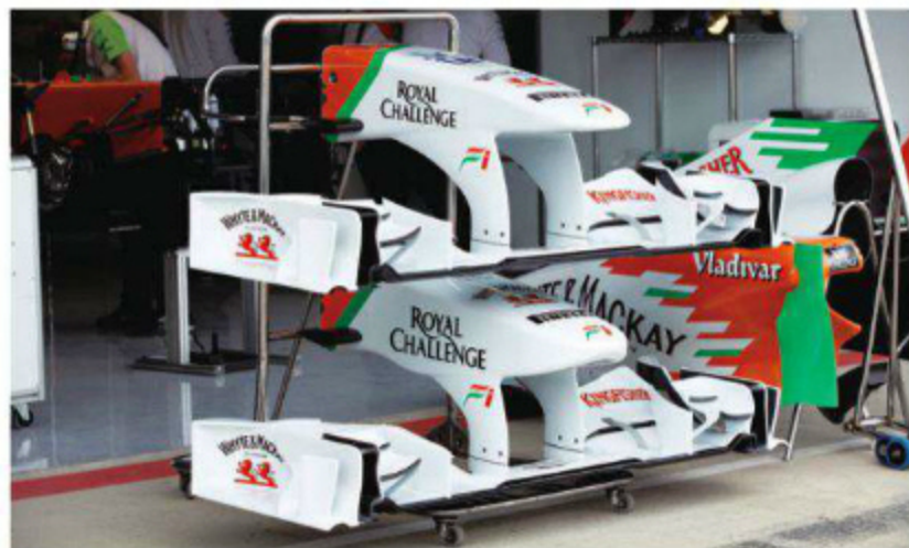
Rd.9 Great Britain ダウンフォースレベルというよりも、ドライバーの好みによることも大きいのだが、2種類のノーズコーンを使い分ける。上は薄い分ウイングステーが長く、幅広の下はかかなり短い。
