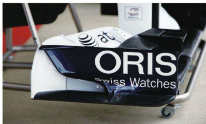
Rd.9 Great Britain 新型フロントウイングは、翼端板デザインも一新。外にあった小さな垂直プレートが消滅し、本体の前エレメントが外に張り出す形となる。ここにも3Dによる折り曲げが多用されている。
