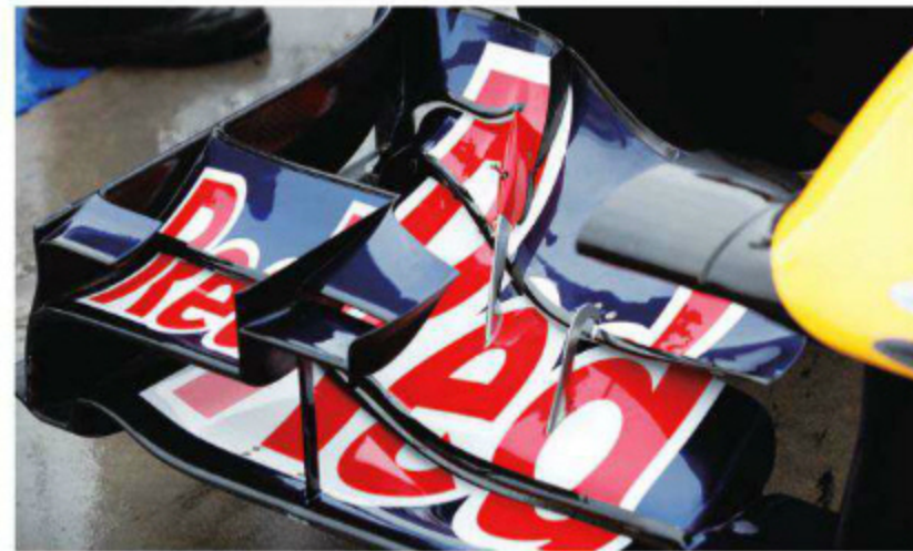
Rd.11 Hungary マキシマムのダウンフォース量を必要とするコースで、フロントウイングのアップパーエレメント処理をさらに変更。内側翼端板全体にアールがつく。フラップはノーズ寄りを挟んだ処理だ。
