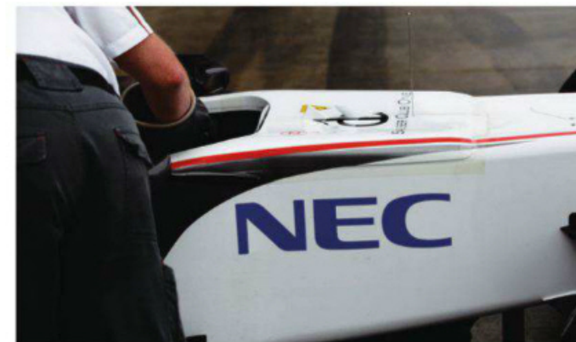
Rd.9 Great Britain 空力面の先行開発のため、フリー走行で可夢偉車のコックピット前ノーズ上面に、膨らみを持たせるようなパーツが後づけで貼られる。当たり前だが、予選以降の本番では取り外されていた。
