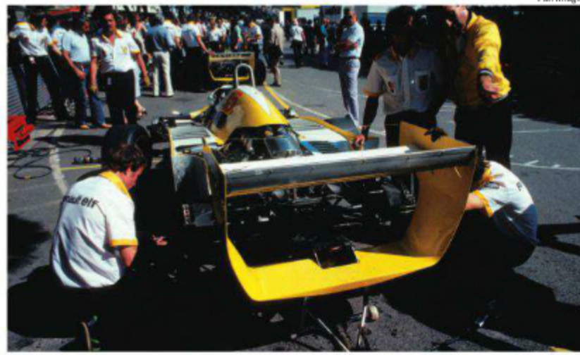
RS10のリヤウイングは、ルノー独特の曲線でできた翼端板兼マウントを持つ。高ダウンフォース用の大型のフラップがついている。このモノコックGPからRS10は2台体制となった。(Rd.7 Monaco)
