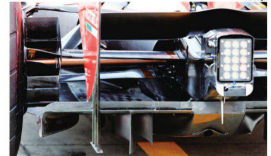
Rd.10 Germany 一連のリヤエンドの空力処理変更には、アップライトも含まれていた。内側にある気流の跳ね上げフィンの数が増加。以前にはなかった内側フェンスがあり、翼に後ろアップラーアームが通される。
