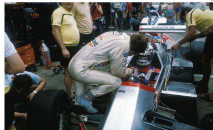
デビュー戦での126C2。ロッカーアーム式のフロントサスが見える。シーズン後半には、モノコックの開口部回りをカーボンで補強した仕様が登場する。(Rd.1 South Africa)
