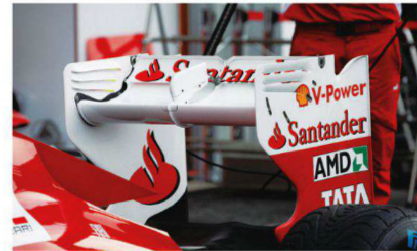
Rd.12 Belgium スパに持ち込まれた、レスダウンフォース・スペックのリヤウイング。翼板スリットの開口の数も通常より少ない設定となる。積雨どちらのコンディションにも対応できるよう、角度調整機構がつく。
