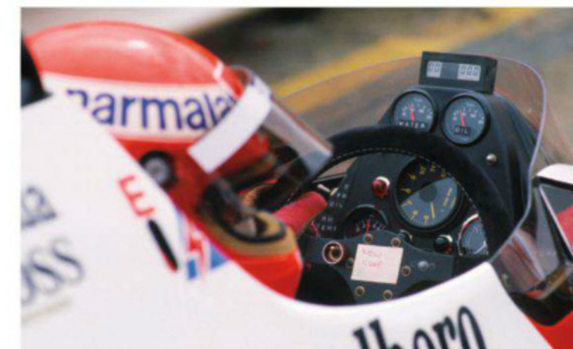
水温計、油圧計、回転計、ブースト計などが装着されたメーターパネル。デジタル化はまだ途上。リアビューミラーはカウルの風防部分に直づけされた。(Rd.2 South Africa)
