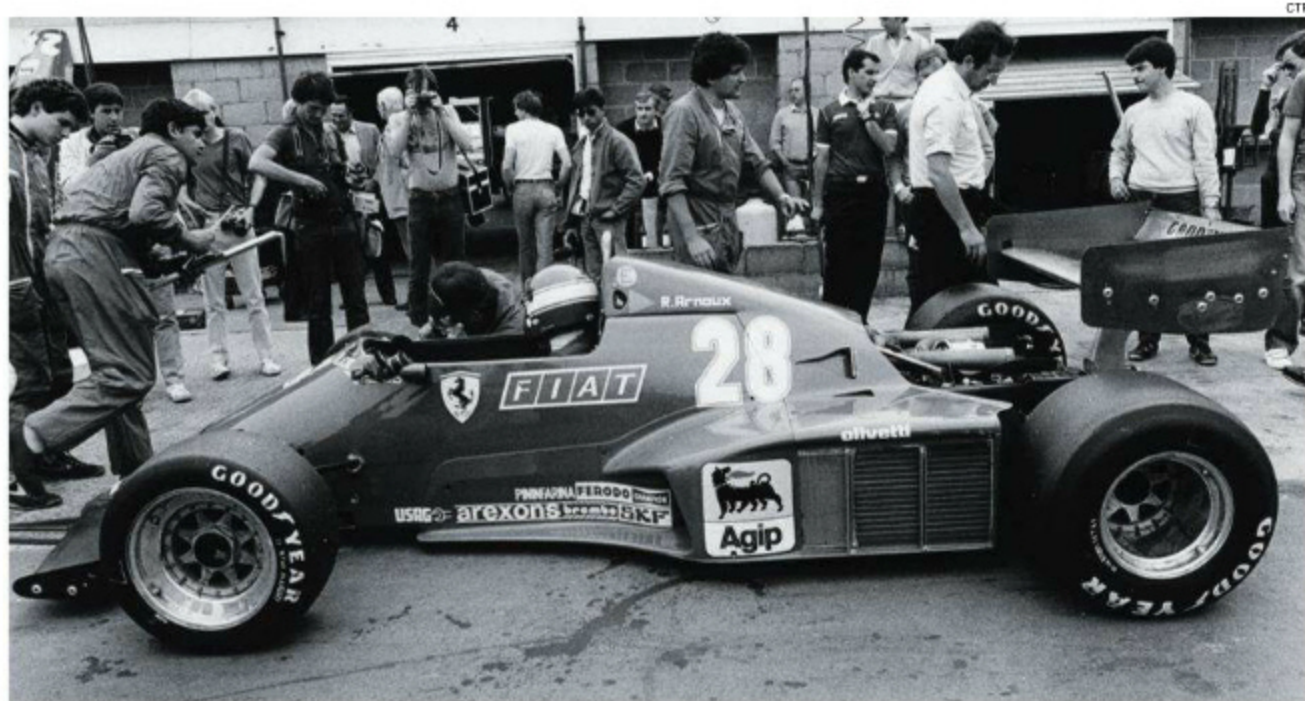
イギリスGPを前にシルバーストンでテストに臨むC3。小型化されたラジエーターを収めるサイトボッドは短くて低いが、オーバーヒート慮伏が出たため、実際ではC2Bタイプに。(Silverstone Testing)
