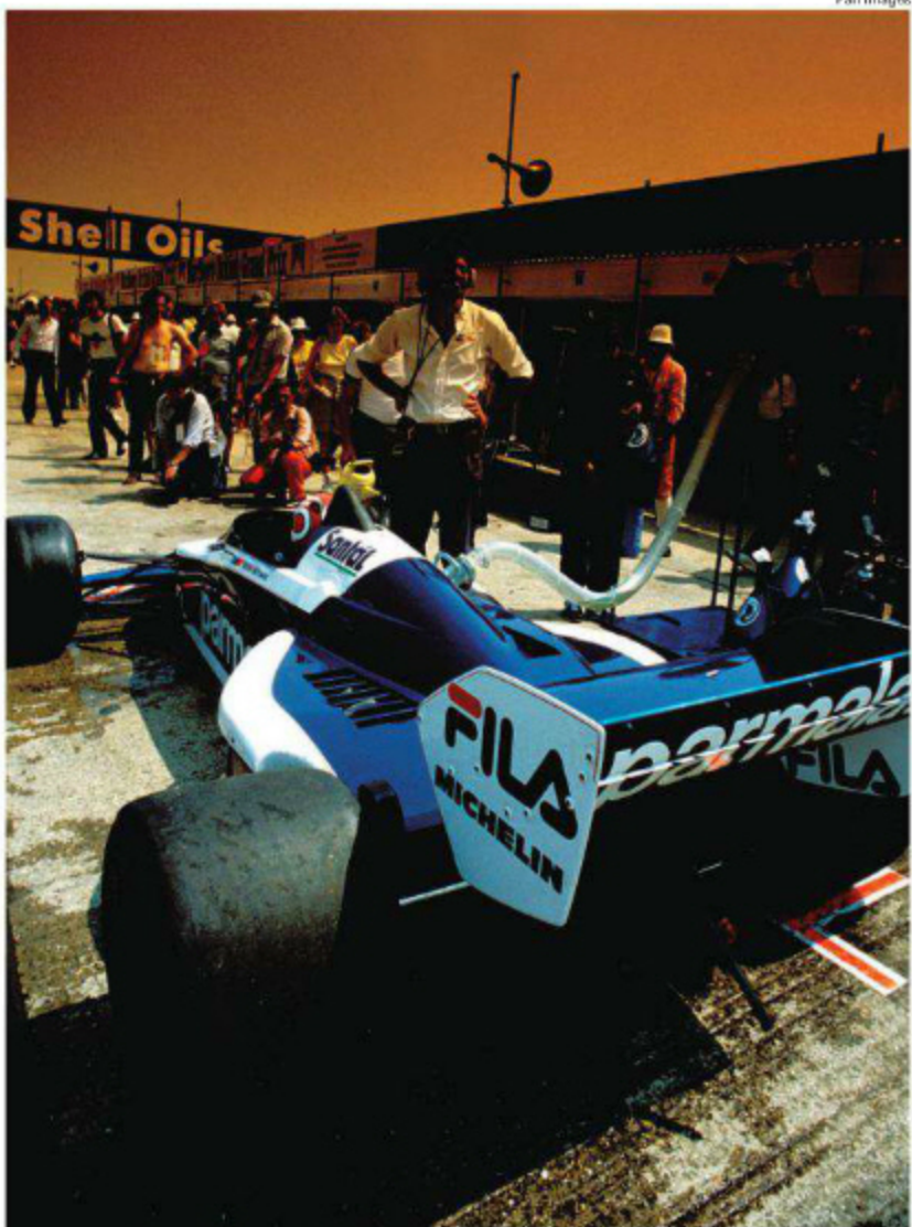
前年、ゴードン・マーレイが先鞭をつけたピットストップ戦略は瞬く間に他チームにも普及。1983年のトレンドに、ガソリンタンク容量は、この年の規定の250Lよりはるかに少ない191L。(Rd.14 Europe)
