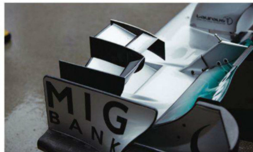
Rd.11 Hungary ウイングの新型アッパーエレメントを、後方上から見る。ふたつのエレメント間は翼端板処理によって仕切られており、内側のほうが高い位置にある。内エレメントのフラップ仰角は控えめだ。
