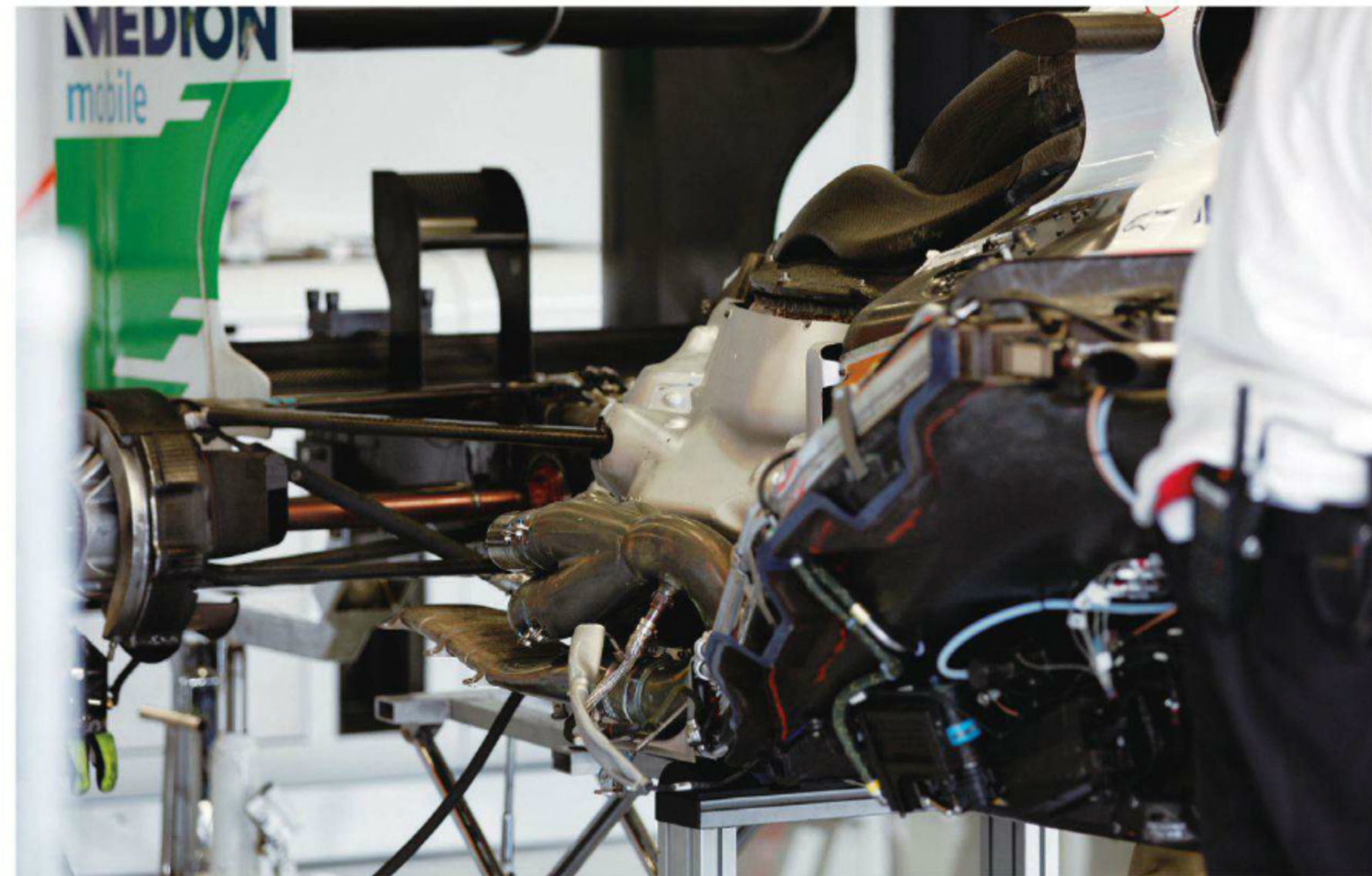
Rd.9 Great Britain 窮乏なサイドポンツーン内のエキパイ処理がわかる。マニホールドからパイプは一度前へと出され、深く折り曲げられてまた後方へと向けられる。その先で潰されたテールパイプに接続される形だ。
