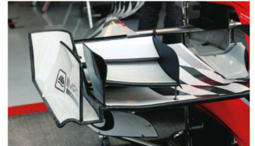
Rd.12 Belgium スパには従来スペックのフロントウイングの他に、異なる仕様のものも持ち込まれていた。アッパーエレメントが通常、内側が持ち上がったウイングレットタイプであるところが、逆に外が高い。
