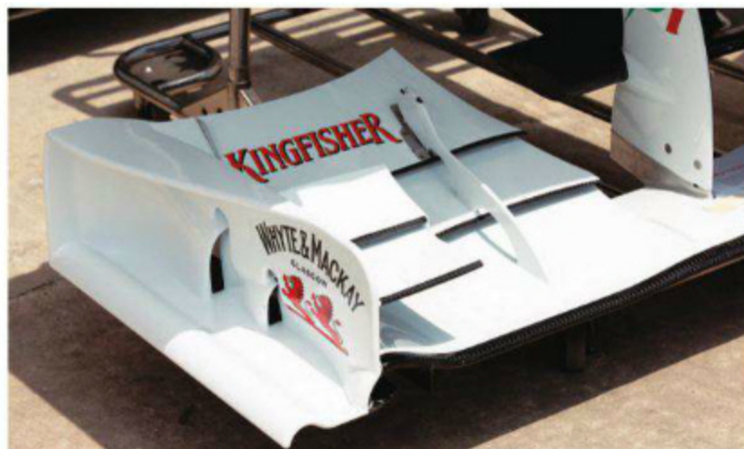
Rd.8 Europe ノーズ下デバイスとともに登場した、ややダウンフォースを削ったタイプのフロントウイング。翼端板は基本の前後分割型とは異なる開口処理で、翼上スプリッターも高さが抑えられたタイプだ。
