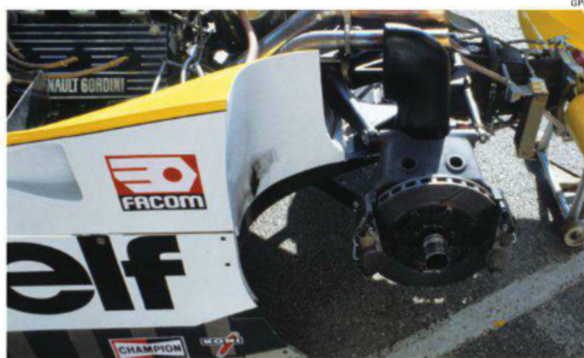
RS10のリヤサスペンションは、ロッカーアーム式のインボードにアウトボード式ブレーキと、当時のグラウンドエフェクトカーの標準仕様。画面左端のNACAダクトはエンジン吸気用。(Rd.7 Monaco)
