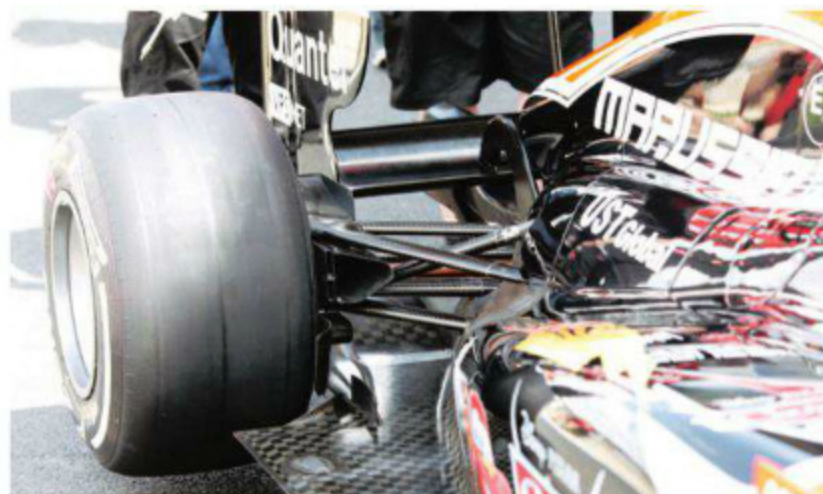
Rd.9 Great Britain 第4戦時点で高じたバージョンアップでフロアに排気を通わせるエキゾースト処理を試みるが、ドライバーからの批評に遭う。開発は凍結され、排出はデフューザー上の中央近くに置かれている。
