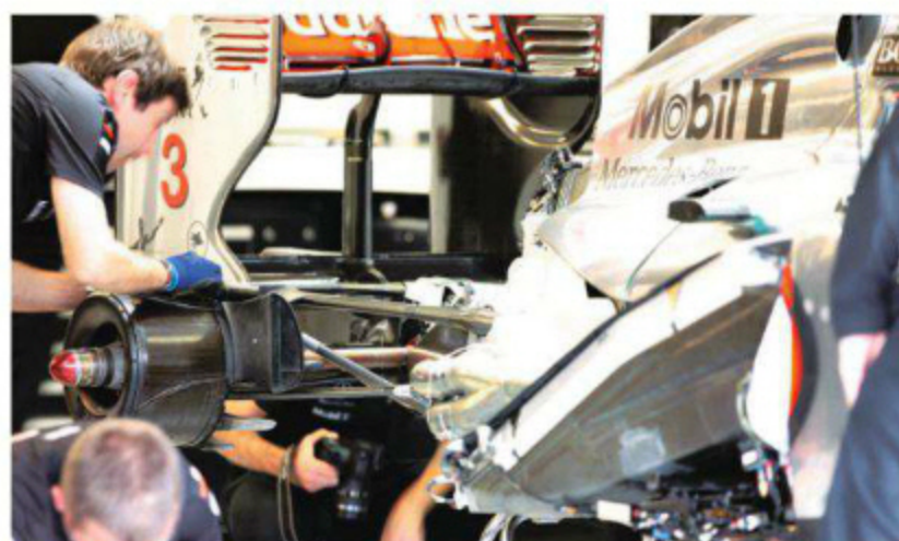
Rd.11 Hungary 円筒型ブレーキダクトカバーの真形処理は、フロントのみに留まらず、リヤにもおよんでいる。ハンガリーに持ち込まれた仕様では、中腹に外に向かって幅が広がるバルジのような加工がされていた。
