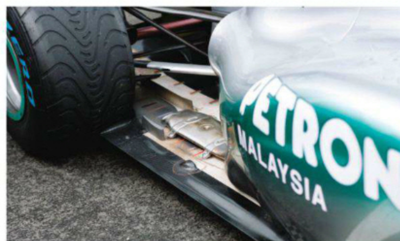
Rd.9 Great Britain 新任のエキゾースト処理を本格化させ、ここシルバーストンからは予選以降の実戦でも使用する。だが、以前データ不足は否めないように、排気が流れる周辺には温度管理シールが貼られる。
