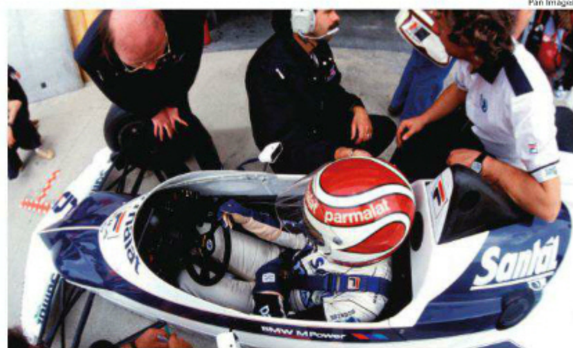
BT52の特徴であるノーズ上のバルジがよくわかる。ステアリングはモモ製を使用。ボディカウル右側にはシフト操作時に手と干渉しないための逃げが設けられている。(Rd.4 San Marino)
