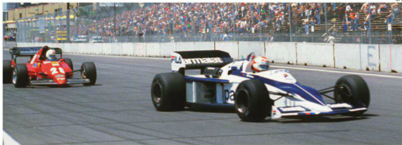
デトロイトでアルヌーと首位を争うピケ。オーバーヒート対策でカウルに穴が開けられ、エアチャンパーがむき出し。ノンストップで走り切る予定が、終盤のバンクで勝利を逃す。(Rd.7 USA)
