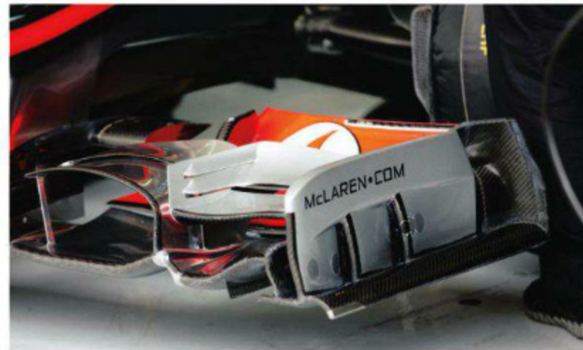
Rd.8 Europe フロントウイングのメジャーアップデートは開幕以来2度目となるが、第6戦時点での変更は翼端板には手が入られず、今回は完全新設計となり、開口が前方で2カ所、カーボン地との継ぎ目にも設定。
