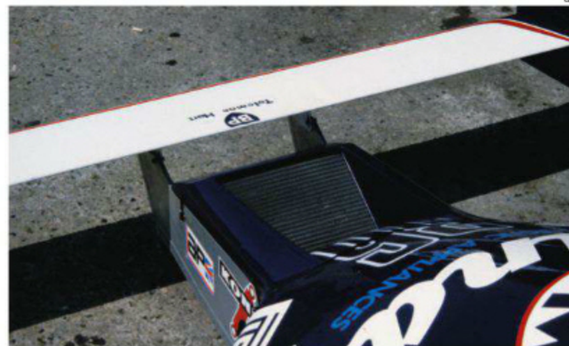
TG181はノーズ先端のフロントウイングステー間にオイルクーラーを置いていた。フロントウイングを高い位置に配置し、車体底面への気流に影響しにくいように配慮していた。(Rd.11 Austria)
