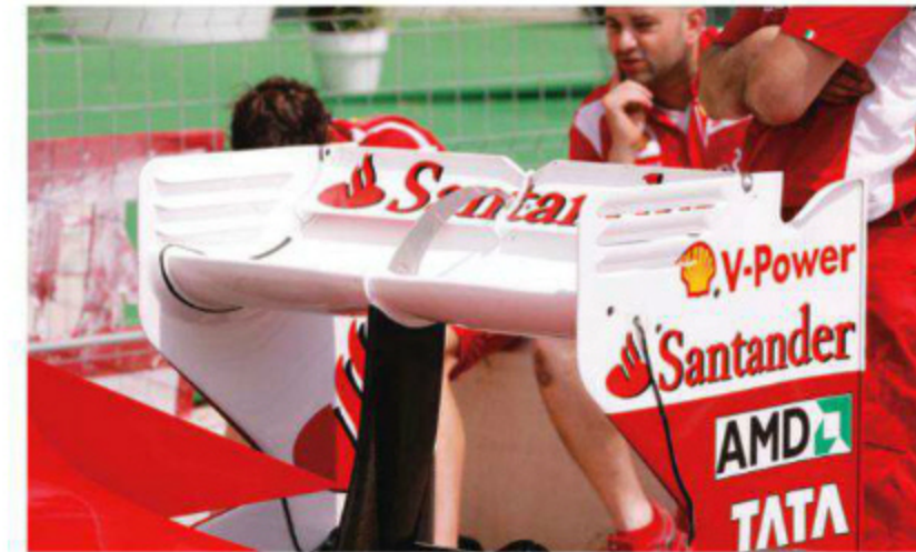
Rd.8 Europe 旧型リヤウイングはセンターステーを持ち、そのなかにDRSの動作部が収納されていた。フラップ上部中央のV字にカットされた部分には、ほぼ前を向く形で厚みのあるカーニーを装備。
