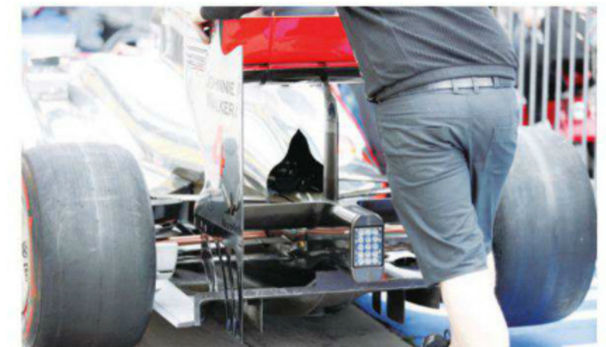
Rd.11 Hungary 今季プロウディフューザーの鍵は装備そのものよりエンジンのマッピングにあるようで、マクラーレンでは大規模なモディファイは行われていない。サイドのパネル上部には耐熱素材が使われている。
