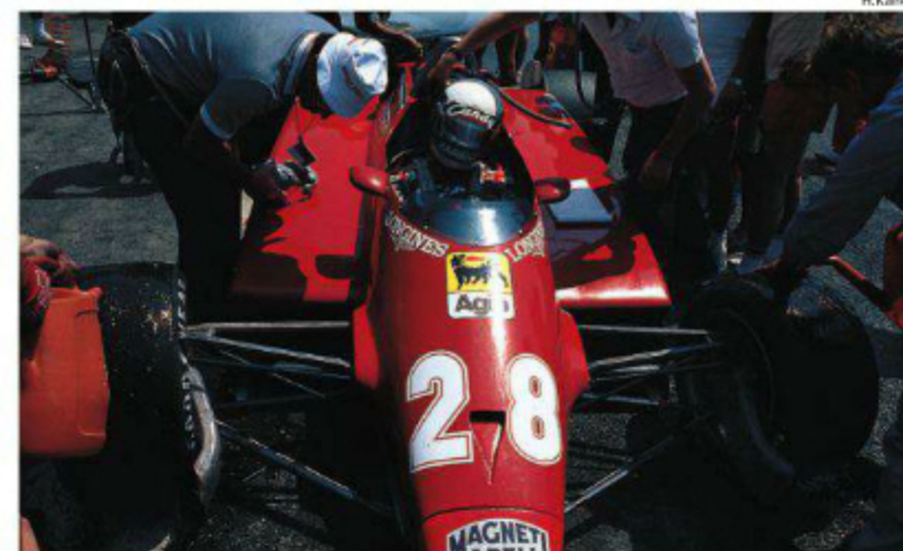
ロードホールディング性の改善を目的に北米ラウンドから投入されたブルロッド式サス。チューブ式のウィッシュボーンは軽量化と空力面での利点があり、セッティングの自由度も上がった。
