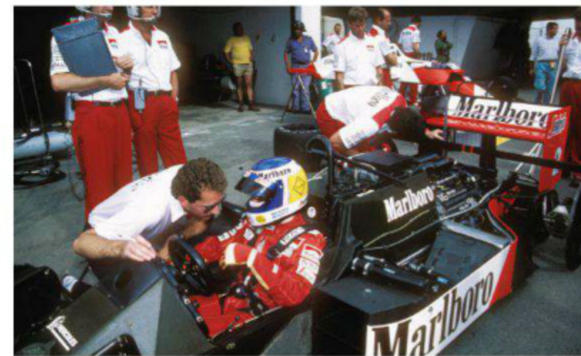
ロスベルグの左手の下、モノコック側面のグレーの部分で新しくなったターボチャージャーへの吸入ダクト。ここからエンジンブロック寄りに位置変更されたターボへとエアが運ばれる。(Rd.11 Hungary)
