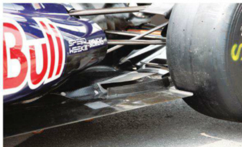
Rd.7 Canada エキゾースト処理も、独特の作風だ。テールパイプを流行の平たいタイプにしているのは間違いないところだが、カバーで完全に覆うのではなくフェンス処理の設置で、排気の一部を上にも逃がす。
