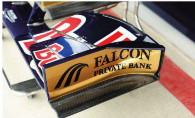
Rd.9 Great Britain シーズン初期仕様とも異なる、翼端板外にフェンス処理のないフロントウイングが持ち込まれていた。アッパーエレメントについても後半既定書のダブルタイプでなく、低ドラッグの仕様だ。
