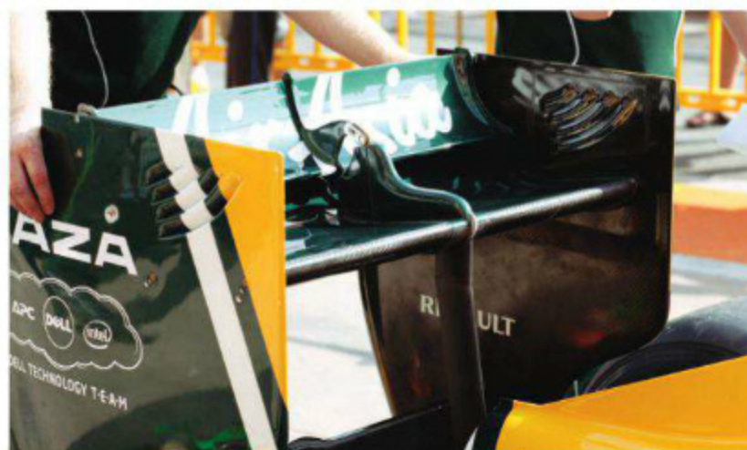
Rd.8 Europe リヤウイングはセンターステーを持ちながら、あらためてDRSの動作部をメインプレーン上に設定。カバーも独自形状をしており、他のチームではまず見られない処理だ。前縁には小さな整流パーツがつく。
