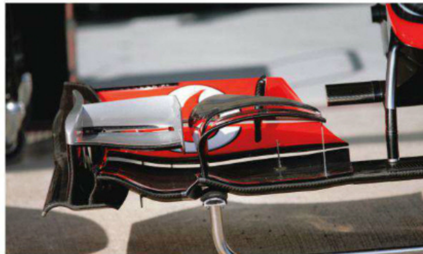
Rd.8 Europe 夏のヨーロッパラウンド開幕で、新型のフロントウイングが入れられた。ノーズ寄りのアッパーエレメント支持が、主翼折り返しより内側に動く。そのことで、外エレメントとの間に距離ができた。
