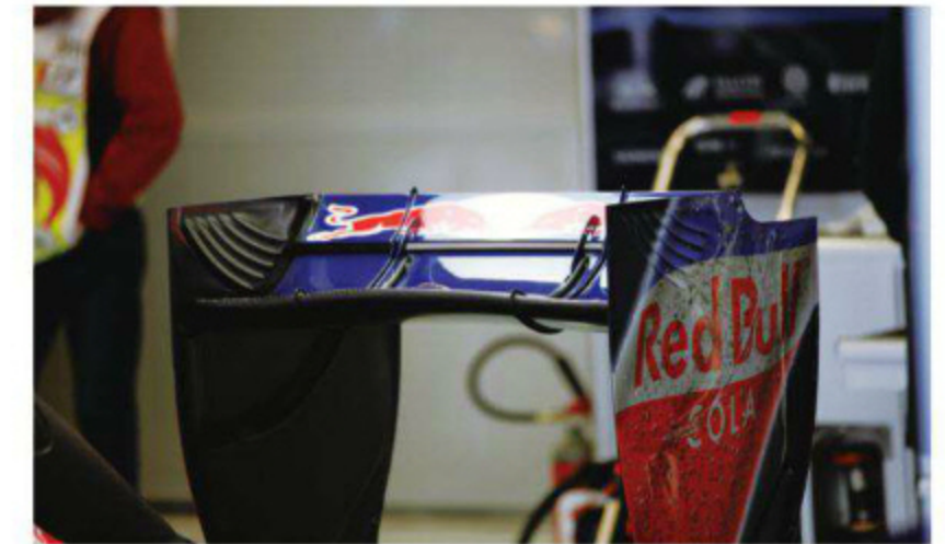
Rd.12 Belgium 同じレスダウンフォース寄りのコース性格でも、スバにはまったく異なるタイプのリヤウイングを持ち込んできた。通常仕様の3Dデザインはほとんど用いず、やや主翼中央が持ち上がる程度だ。
