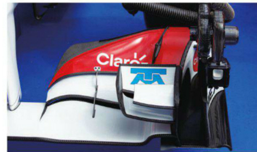
Rd.11 Hungary 結局このハンガリーで使われたのは、ダウンフォース量の高い側のフロントウイングの仕様だ。フラップの後縁を黒い追加材で囲むように面積を増し、翼途中からはさらに垂直のカーニィーが立つ。
