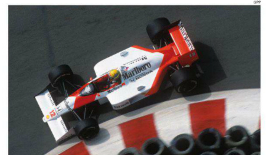
米国ワズマン社が設計協力したコンパクトな3軸ギヤボックスの投入により、伝統の“コックボトル”はさらに絞り込まれ、長くなったノーズと合わせ、MP4/3より長いシルエットに。(Rd.7 USA)
