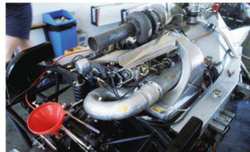
ターボチャージャー→エンジン右側のインタークーラー→吸気チャンバーへという配置を示す。モノコックからリヤサスペンションまでサブフレームが延びる様子もわかる。(Rd.7 Spain)
