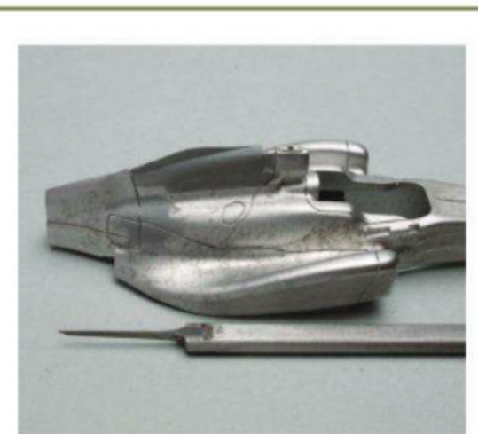
金針な半田はモーターツールで削り落とす。ヤスリとサンドペーパーを併用して元々のラインを復元。ポッド本体をボディに取り付ける際は瞬間接着剤を使用し、微細な隙間にはウレタンサフを塗り込んでおく。
