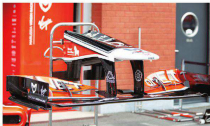
Rd.12 Belgium 通常仕様となるアッパー・エレメントが装着されていない形の、フロントウイング。フラップはレッドブルやルノーで見られるような、上部の内側を持ち上げ、2エレメント間の距離を置く形だ。
