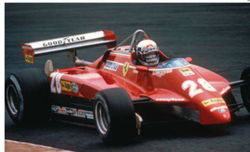
高速のキャラミではフロントウイングスの低ダウンフォース仕様。フロントサスのカバーは、サイドポッドへつながらない独立式。この開幕1戦限りの仕様だ。(Rd.1 South Africa)
