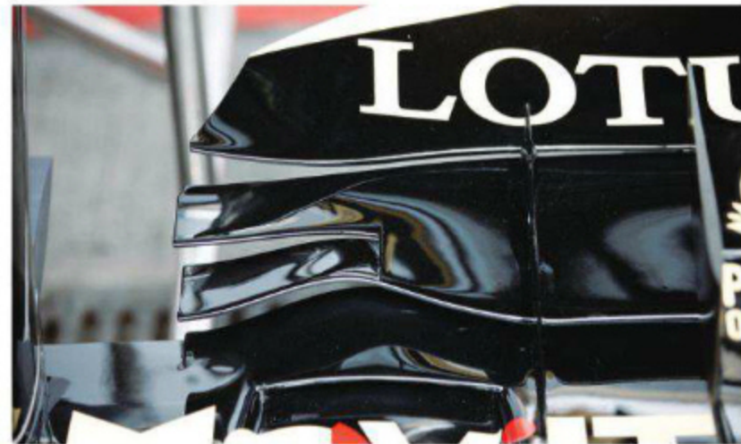
Rd.12 Belgium さすがにスパ向けには、ややレスダウンフォース寄りのフロントウイングを持ち込んだ。開幕仕様とも異なる新型で、ダブルフラップの前側がノーズ寄りで分割成型となって気流を振り分ける。
