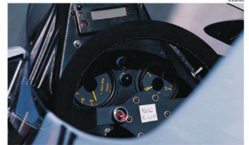
ダッシュボードにマウントされたコンピュータにより、現在のブースト圧のまま走ると、あと何周で燃料が尽きるかを表示することが可能に。この年も、マクラーレンは予選よりもレースで強かった。(Rd.11 Netherlands)
