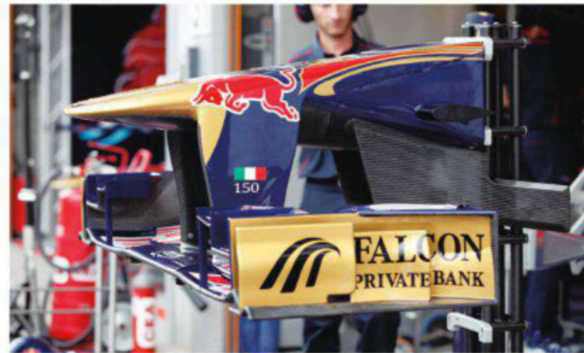
Rd.12 Belgium スバスペシャルというわけではなく、シーズン終盤戦これらを見据えた新型ノーズコーンを持ち込んできた。レッドブルの作風を引きずるこれまでのスラントタイプではなく、上下に薄いつくりだ。
