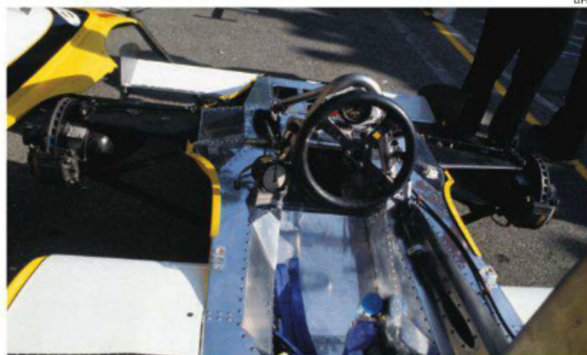
RS10コックピット。左手側にある白いメーターはターボのブースト(過給)圧計。右側にはスロットルワイヤーがある。グラウンドエフェクトカーのRS10は、組身のモノコックである。(Rd.7 Monaco)
