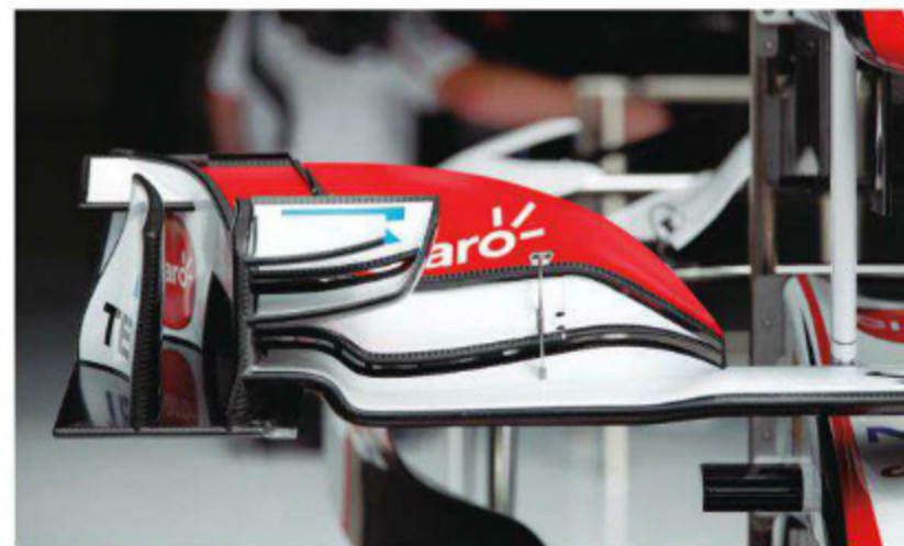
Rd.12 Belgium スパの高速レイアウトにも特別なフロントウイングのスペックは用意されず、従来仕様からドラッグとダウンフォースを削る形だ。翼端板近く以外のフラップ後縁にカーニィー装着がない。
