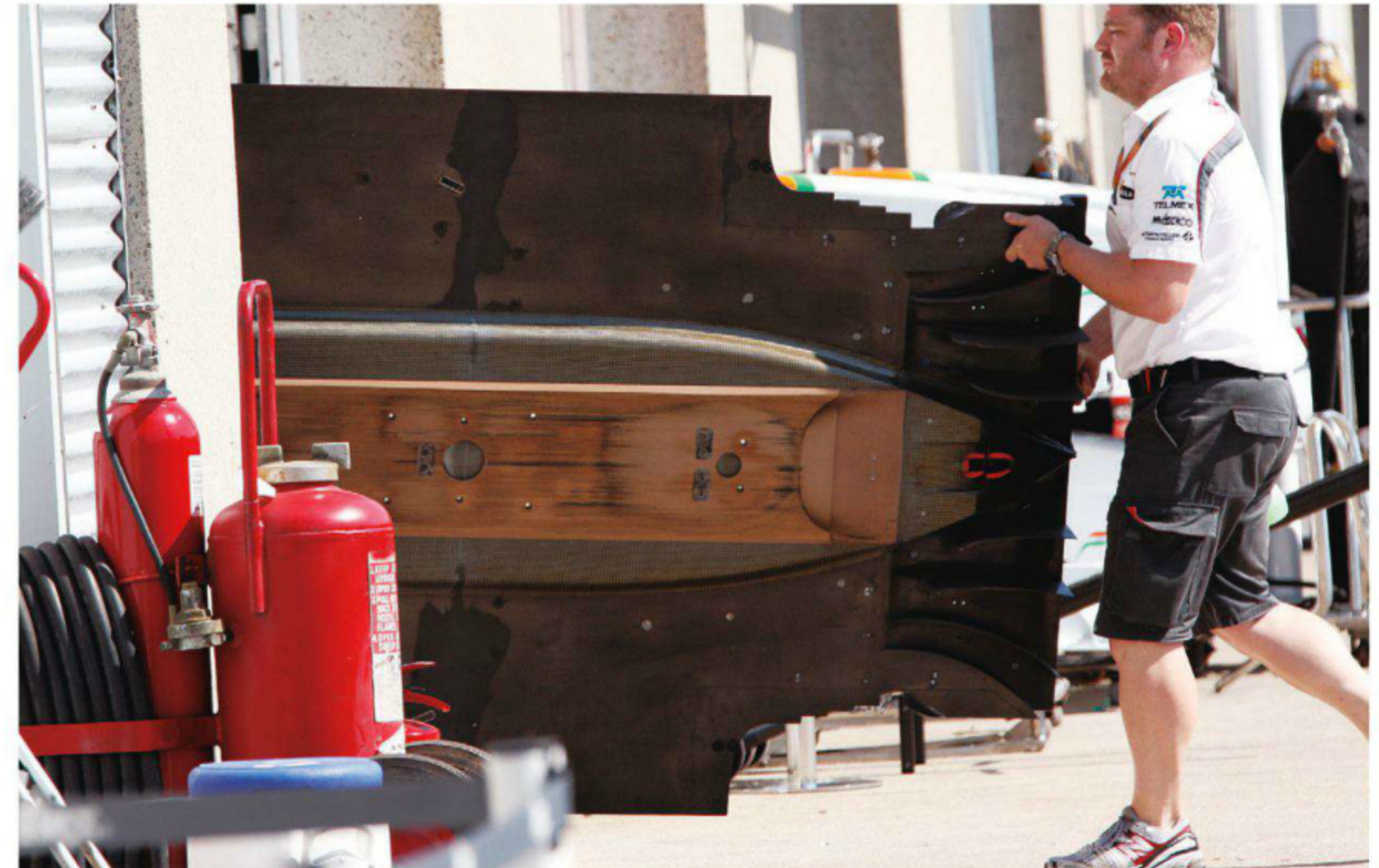
Rd.7 Canada ディフューザー直前のフロアパネルには、両サイドに段差をつけるようなカット加工がされる。その周辺にはフロア本体との継ぎ目が確認され、別体パーツとなっていることで交換による仕様変更が容易となる。
