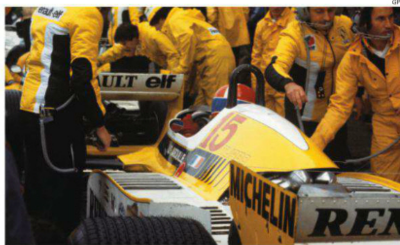
ホッケンハイムのピットに停車するジャブイユ車。バックミラーの下にはコックピットへの空気取り入れ口がある。リヤタイヤからミシュランのウェットタイヤのパターンがわかる。(Rd.10 Germany)
