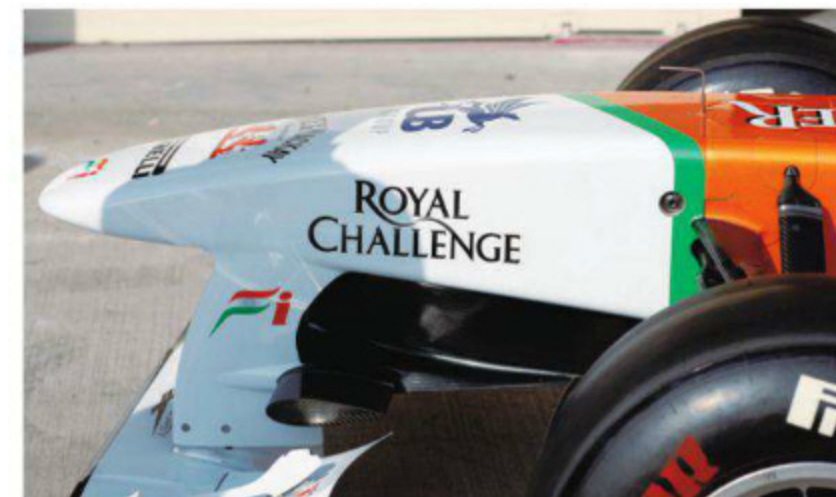
Rd.8 Europe ストレートの長いレスダウフォース寄りのコース向けとして第4戦時点で登場した、ノーズ下の逆T型デバイス、マクラーレンに似た処理だが、結局ドライバーの好みからほぼ日の目を見ず。
