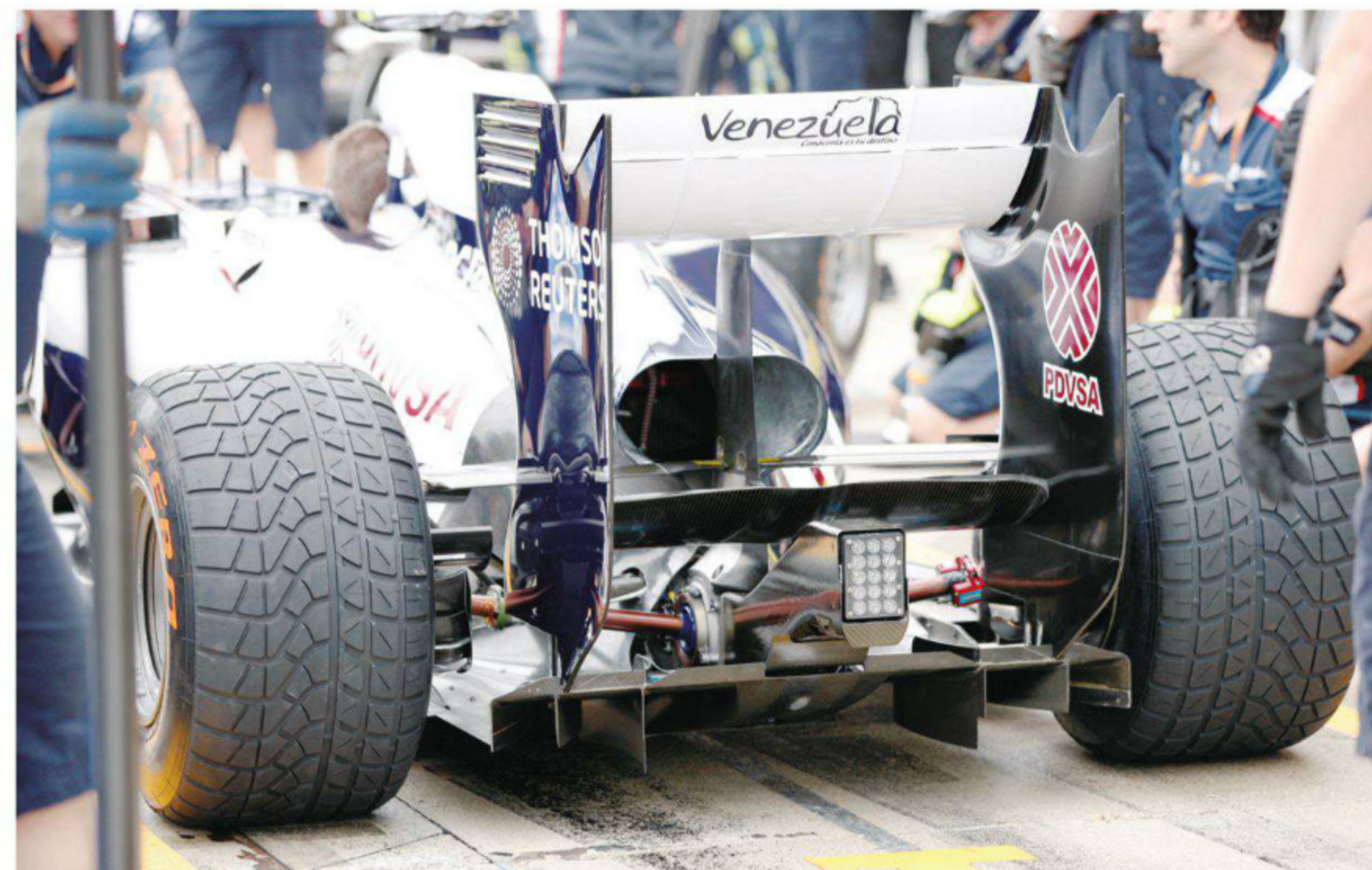
Rd.11 Hungary エキゾーストブローの効果も最大限に引き出すため、リヤエンド全体の処理に大幅な手がいった。ギヤボックス周辺のカルル開口は閉じてスリム化。サイドに径路を設け、代わる形で上部ダクトを大型化する。
