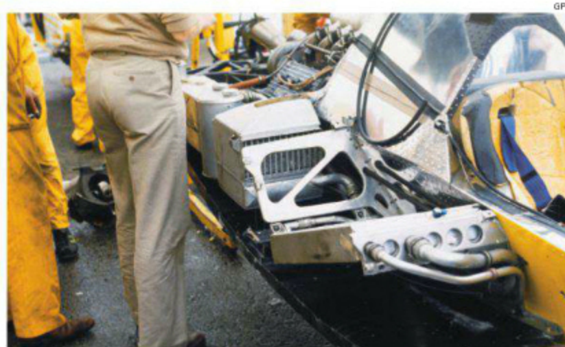
RS10のサイドポンツーン内は、前方にラジエター、後方に吸気用のインタークーラーが配置されていた。サイドポンツーン後面はグラウンドエフェクトを発生させる形状。(Rd.6 Great Britain)
