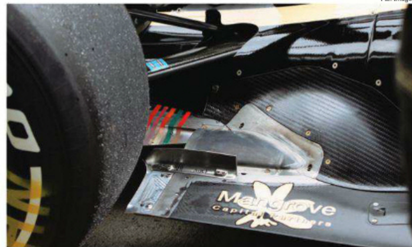
Rd.10 Germany 初めてテストされた後方排気。クルマの基本コンセプトを根柢から覆すような大変更だが、チームは評価を従来の前方排気とはほぼ同等とした。ボディワークにバルジを設けて、マニホールドを収めていた。
