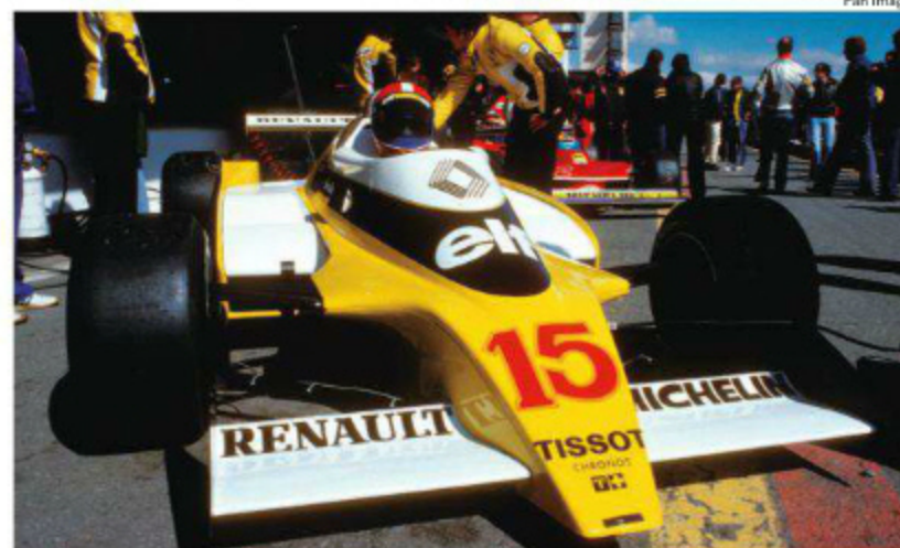
RS10はスペインGP（ハラマ）でジャブイユによって1台だけがデビュー。予選は9番手だったが、決勝は過給機でリタイア。ジャブイユ車はコクピットカウル一体ミラーである。（Rd.5 Spain）
