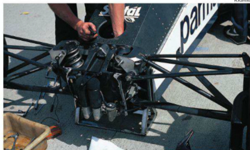
BT49から続いたブルード式のフロントサスではなく、BT52はプッシュロッド式を採用。コニ製のダンパーがアルミブラケットを介して取り付けられた。(Rd.1 Brazil)
