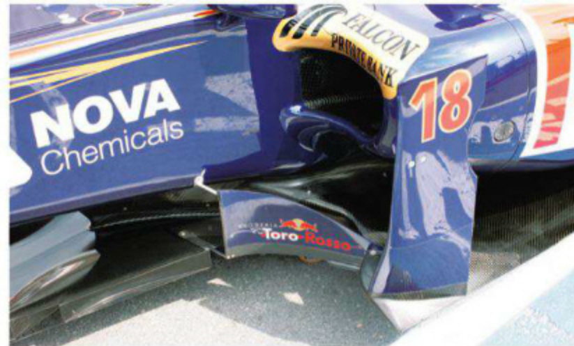
Rd.7 Canada ノーズ下側面からのやや厚みを持たせたフェンス処理が、バジボード裏へ伸びる。接続されるサイドポンツーンダクト下の膨らみにはさらにポリウムが持たせてあり、気流を二層化している。
