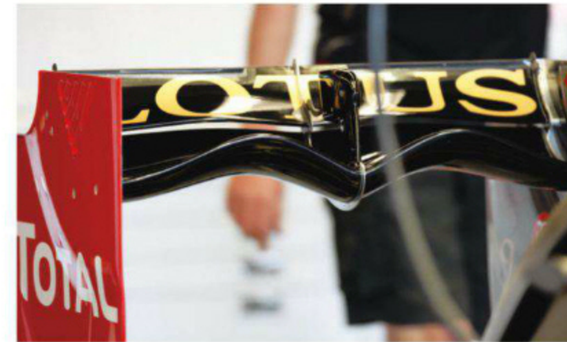
Rd.7 Canada 長いストレート対策として持ち込んだレスダウンフォース・スペックのリヤウイングは、3D加工を駆使した超異形デザインの。だがレース日の雨が確実視されたため、フリー走行で試すのみに終わる。
