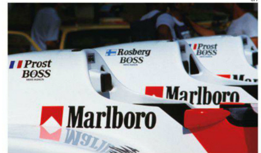
サイドミラーの視認性を向上させるために、この年からカウルには切り欠きが設けられている。プロストは赤いサイドミラーとなり、白を使うロスベルグ車との識別が容易に。(Rd.1 Brazil)
