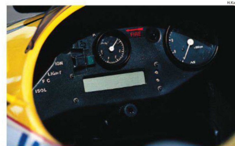
タコメーターとブースト計、コンピュータディスプレイだけのシンプルなインストパネル。ブーストは1が燃費モード、2、3がレースモード、4のオーバーテイクモードは50~60馬力プラス、5は予選モードとなる。
