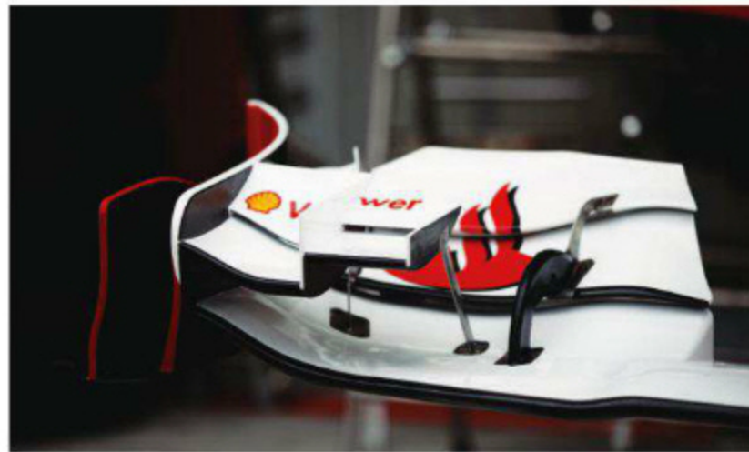
Rd.11 Hungary フロントウイングのアップラー装置をダブルエレメント化。ダウンフォース量アップの措置がとられた。ウイングレットを左右にふたつ並べたような形状で、流行の内側エレメントが高い処理。
