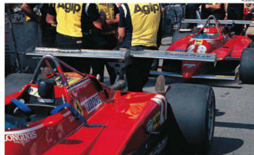
物價を騰し、結局3位入賞したビルヌーブが失格を憂き目を見たダブルウイング。FISA vs FOCAの対立が深刻化していた時代が生んだ政治的デバイスと言える。(Rd.3 USA West)
