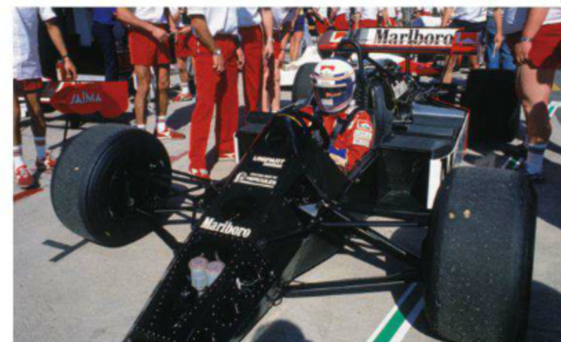
カーボンコンポジットモノコックを持つMP4/2だが、衝撃吸収構造となるノーズ部分はアルミ製。リヤサスペンションはプッシュロッド式。ダンパーユニットはモノコック内に隠蔽に収まった。(Rd.1 Brazil)
