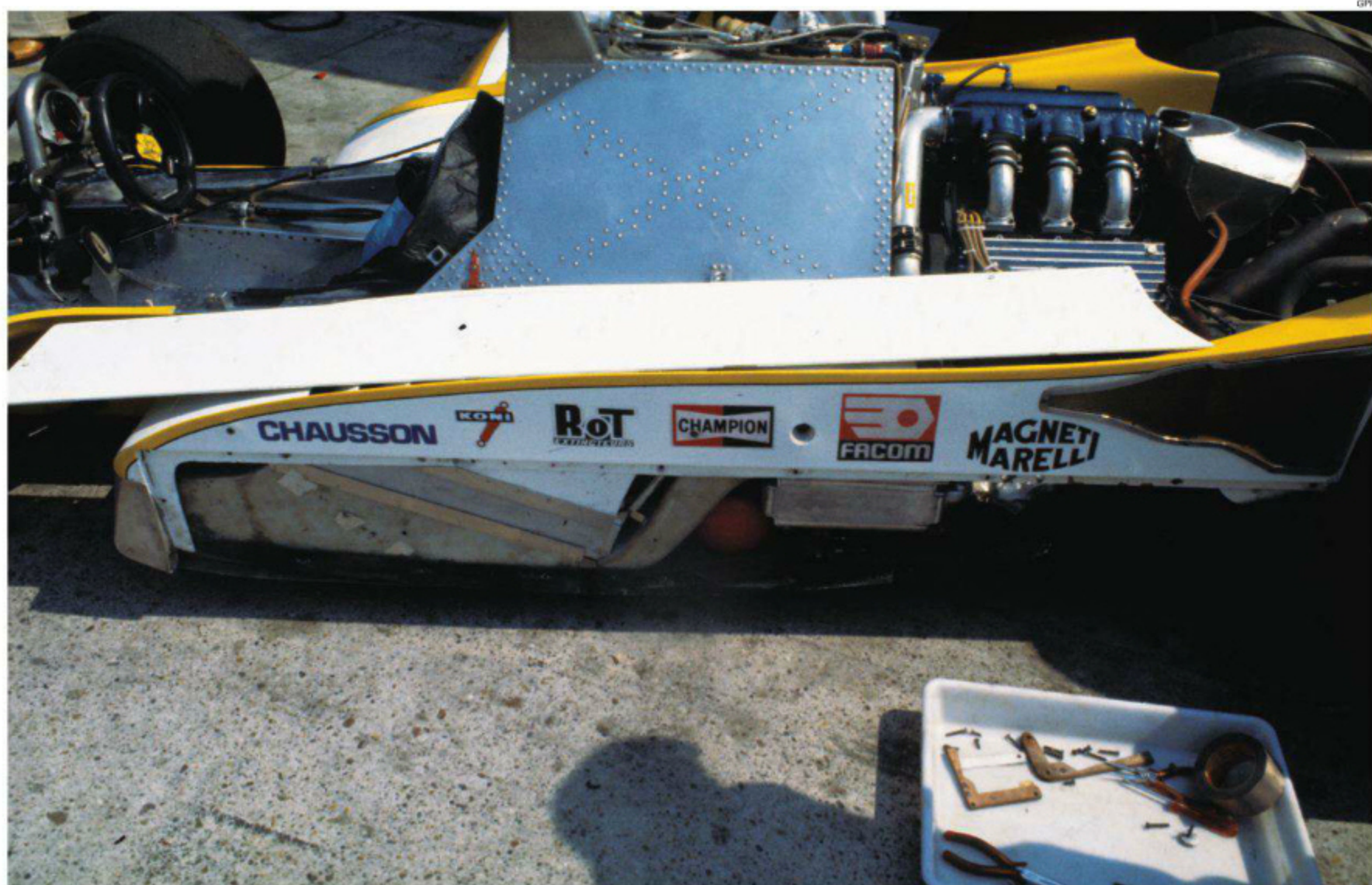
RS10のサイドポンツーン内部。前部から伸びたダクトは、メインラジエターに行くが、下側の一部が分岐され、後方のインタークーラーに向かう。右側のNACAダクトはエンジン吸気用。
