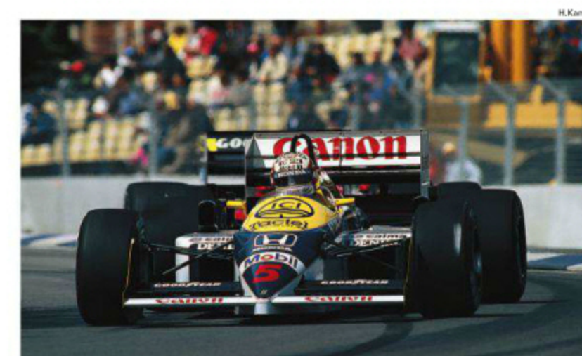
シーズン後半戦には、ターボインテークをサイドポッド上面に突き出したシュノーケル型ダクトに変更。ストリートコースのアデレードでのリヤウイングは目一杯のハイダウンフォース仕様。(Rd.16 Australia)
