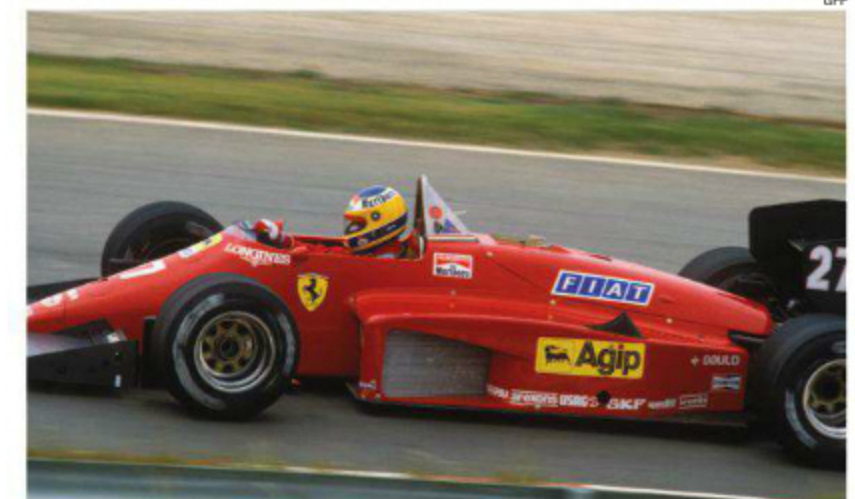
第2戦、ターボインレットダクトは小型仕様。サイドポッド側面のエアアウトレットはラジエーター用のみとなるのがオリジナルの仕様だ。着座位置が異様ほど前なのはこの時代ならではの。(Rd.2 Portugal)
