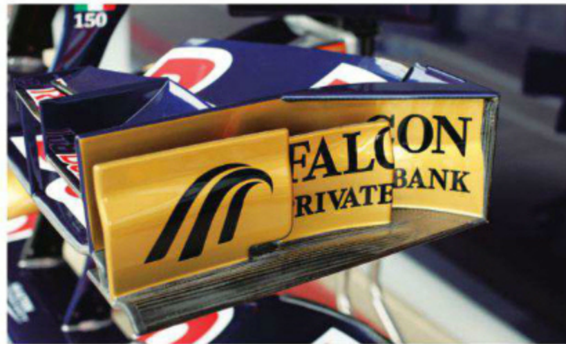
Rd.9 Great Britain 完全にレッドブル本体の思想からは離れ、独自手法が際立ってきた今季トロロッソ。フロントウイング翼端板は本家の開口型に対し、サイズ形状の異なるフェンス処理を外に2枚置く。
