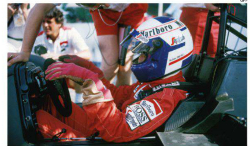
195L燃料制限対応で完全新設計されたモノコックにより、ドライバーの着座位置はより低くなった。その効果で、インストルメンタルパネルが装着されるロールフープの位置も12cm低くなっている。(Rd.3 San Marino)
