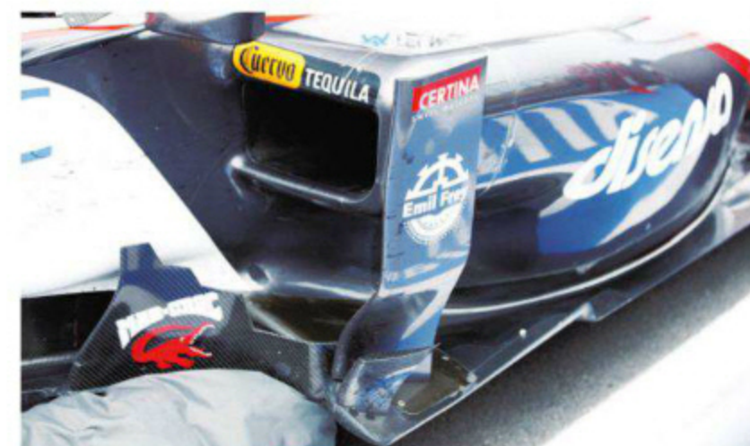
Rd.10 Germany サイドポッドツーンの内テークダクトはほぼスクエアな形状で、その下に大きく気流の経路が確保されている。前方のバードボード上部は複雑なカットで切られ、整流に配慮する形だ。
