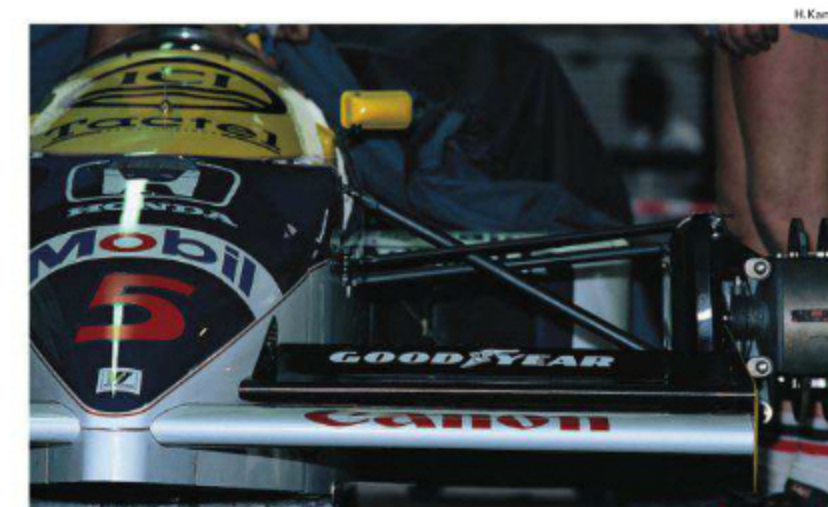
FW10で初採用したプッシュロッド式のフロントサスをFW11でも踏襲。ブレーキシステムにはヒトコ製のツインカーボンディスク&AP製キャリパーという組み合わせもあった。
