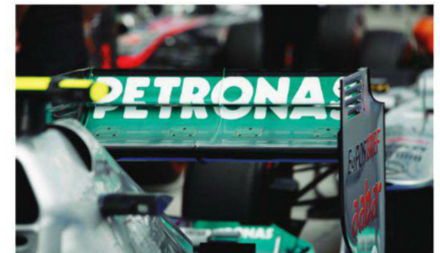
Rd.11 Hungary ストレートスピードがもっとも伸びるとされる今季のクルマで、その一翼を担うリヤウイング。他車のようにDRSの動作を翼のセンターに置くのではなく、翼端板内に収納する独自思想だ。
