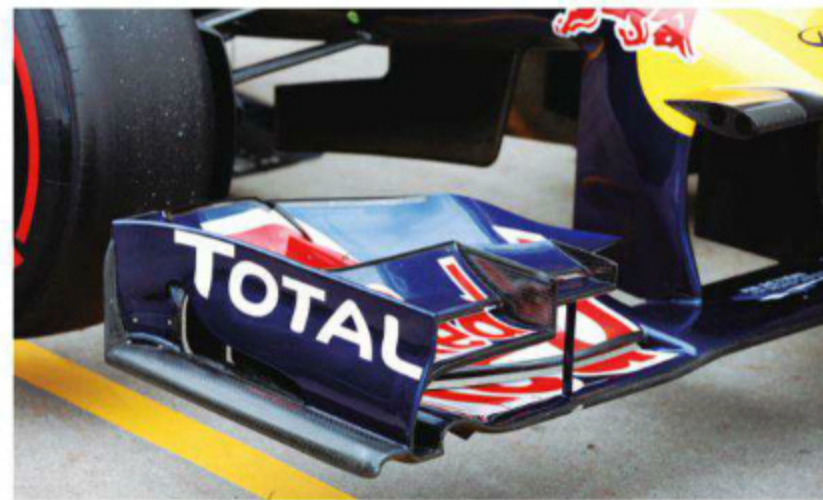
Rd.7 Canada 前戦モナコのフリー走行で試した、フェラーリのような前後に幅の広いフロントウイングステアを本格導入。フロントウイングは2種類持ち込まれたが、雨でダウンフォースレベルの高いタイプを選んだ。
