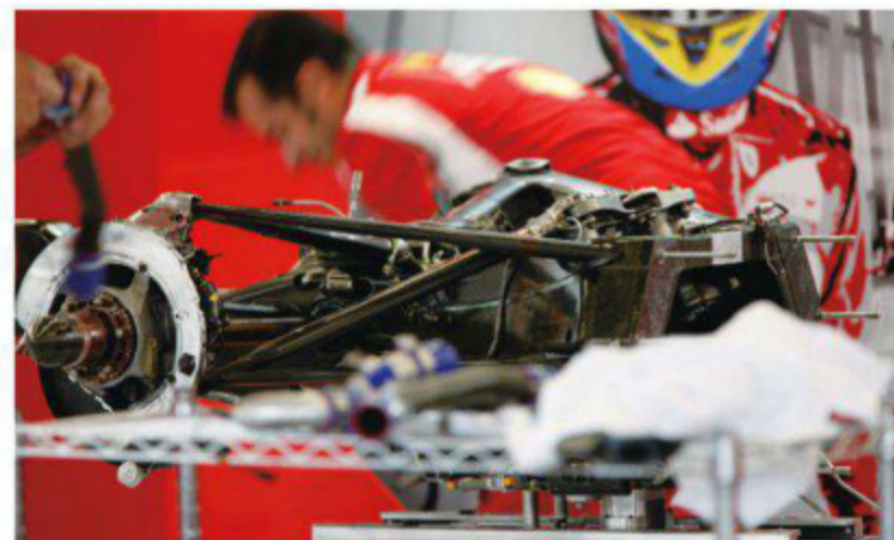
Rd.9 Great Britain リヤサスのアップライト側アップラーアームの支持が、追加の別パーツを使って高い位置にある。今季メルセデスGPに同様の処理が見られ、競馬馬はカナダでのアロンソ車から道連れした。
