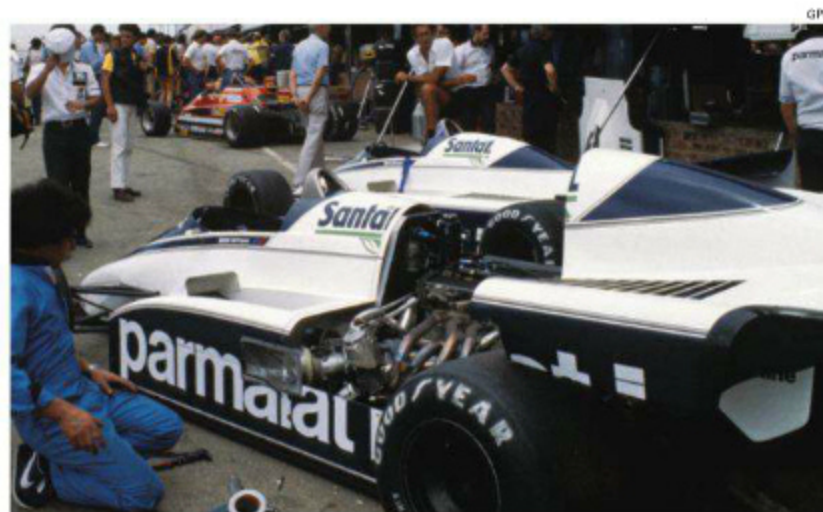
開幕戦のキャラムはターボ向きの高地で高速コースだったため、2台のBT50で実戦に挑んだが、2台ともリタイアだった。サイドポズション前面にエンジンの吸気口がある。(Rd.1 South Africa)
