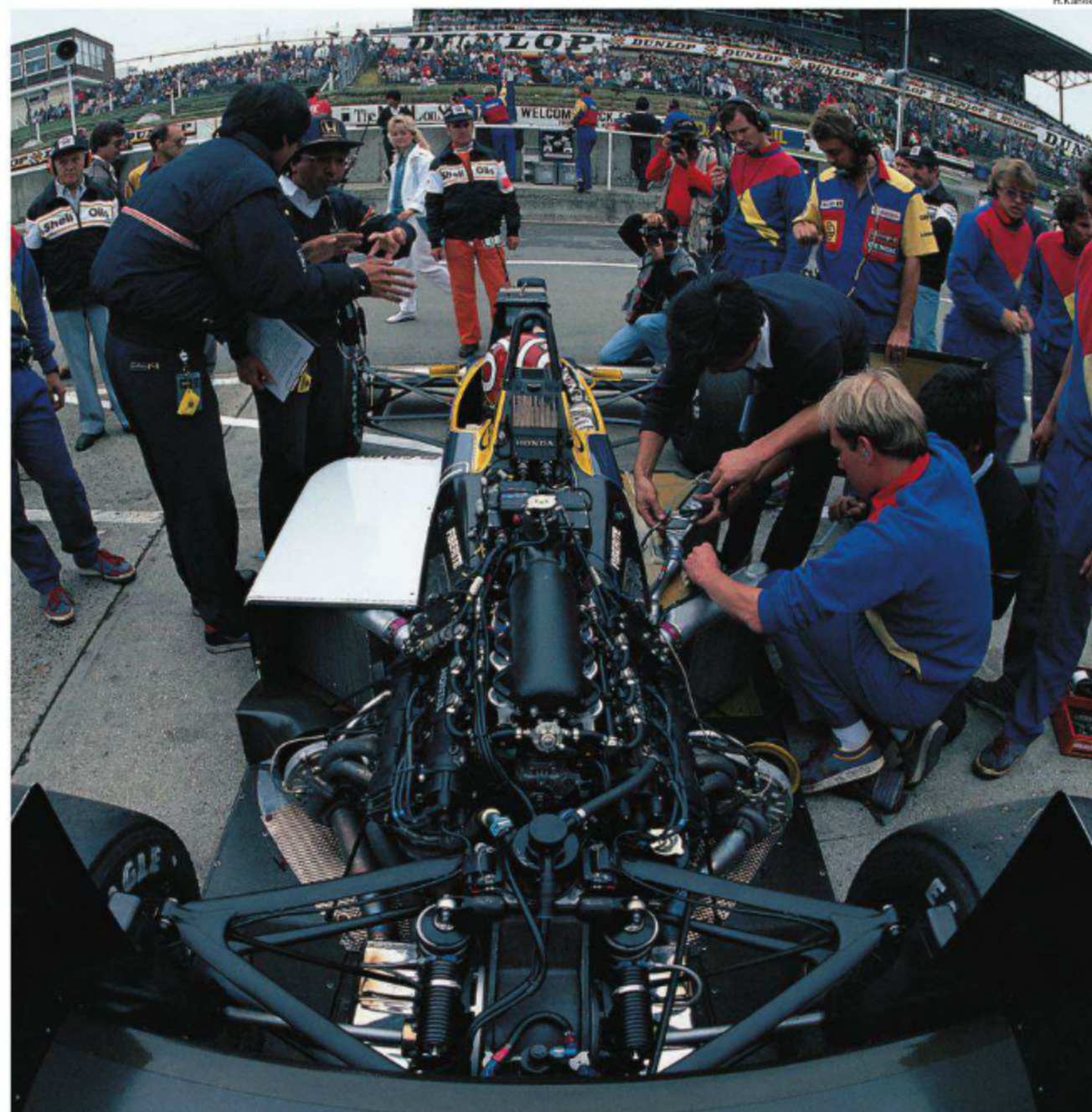
予選5bar過給で1100馬力/1万1800回転を誇ったRA166Eユニット。シーズン前半はサイドポッド側面にターボのエアインレットを設けていた。(Rd.9 Great Britain)
