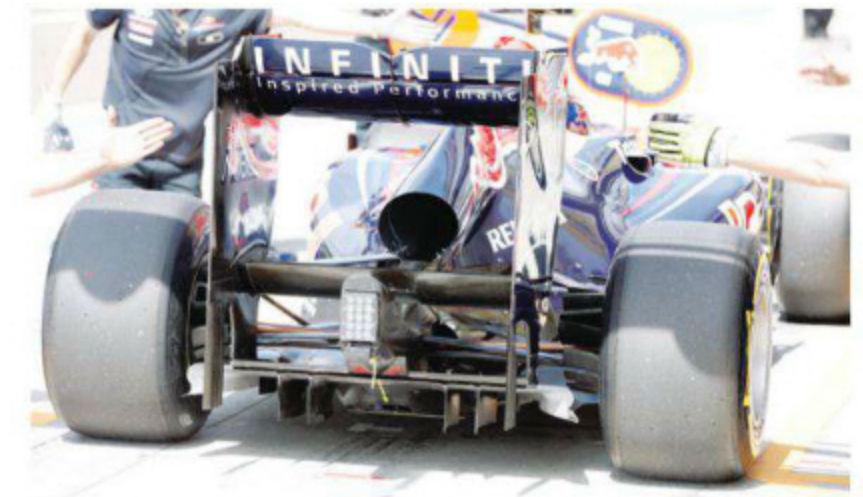
Rd.11 Hungary 前戦からはまたディフューザーの仕様変更がされ、センターチャンネルの隔壁が以前のままで覆ひるタイプに戻った。サイドの形状も異なっており、ドイツより両端が持ち上がっている。
