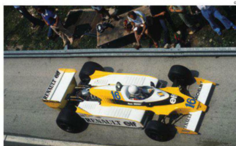
薄く、キャンバーの少ないフロントウイング。大きなサイドポンツーン。RS10になって、ルノーは当時のグラウンドエフェクトカーとしての標準装備を得る。（Rd.8 France）
