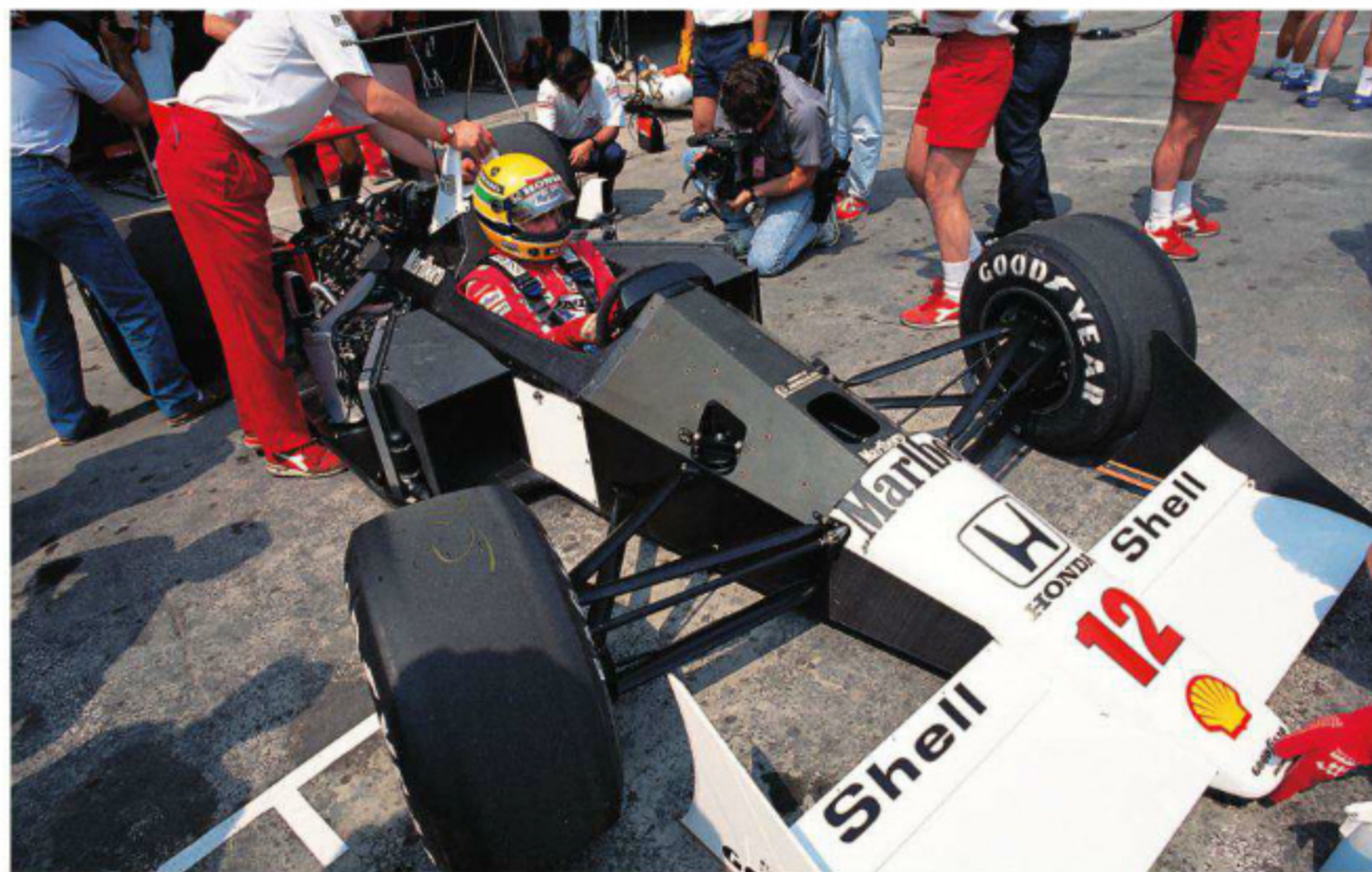
新規定によりフットペダルの位置が20cmも下がり、フロントアクスルの後方へ。ただし、タンク容量が150Lとなり、前作に較べホイールベースは4cm伸びただけ。(Rd.4 Mexico)
