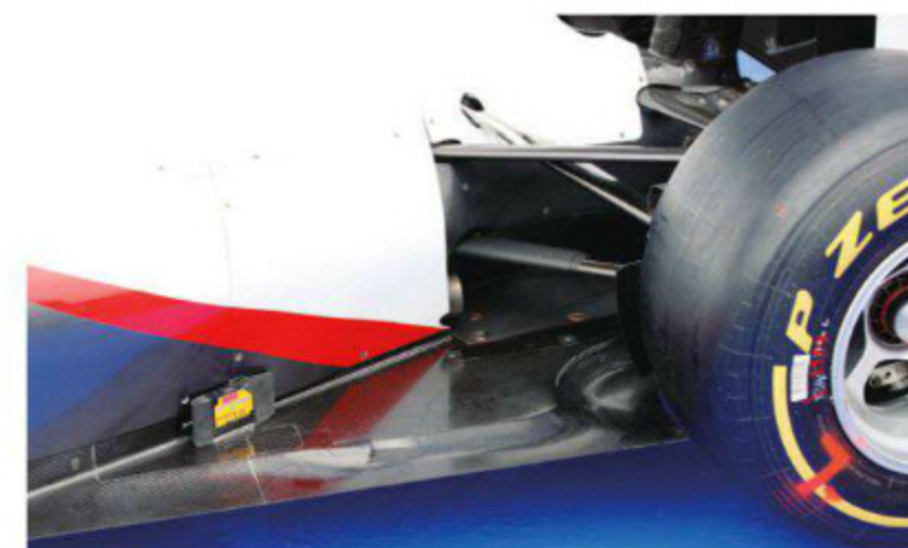
Rd.11 Hungary レッドブル式のエキゾーストブロー処理は完全に放棄し、その部分のフロアにはサイドからの気流の経路を作るような加工がされる。エンジン排気はロワアームの下を抜けるよう出されている。
