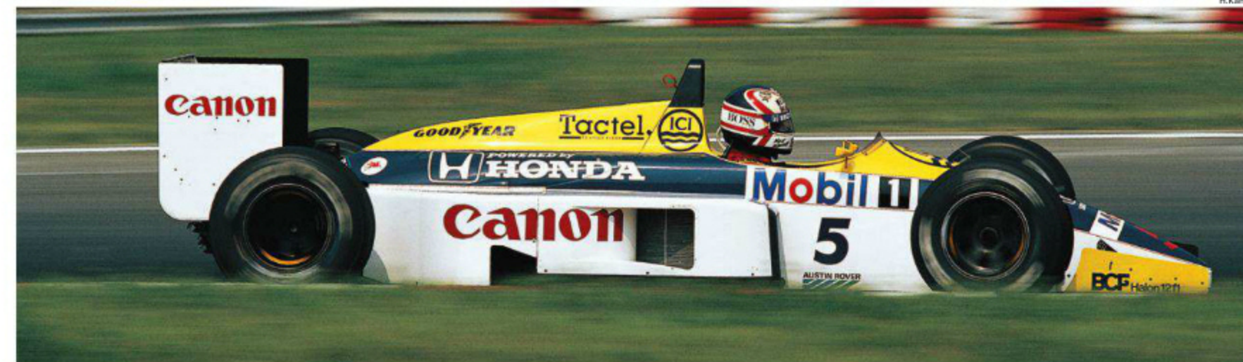
マンセルはシャシーNo.2を中盤戦まで (イギリスGPの決勝のみスペアカーのNo.3)、シャシーNo.6を第11戦ハンガリーより使用。ロールオーバーが高いのがマンセル車の特徴だ。(Rd.9 Great Britain)
