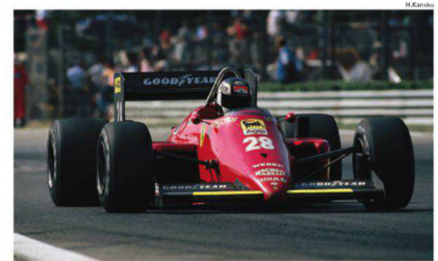
抱元モンファでは、フロントリヤともにサスペンションのピックアップポイントを変更。インタークーラー用エアアウトレットがサイドポッドに設けられるなど、大きな改修を受けたマシンが登場。(Rd.13 Italy)
