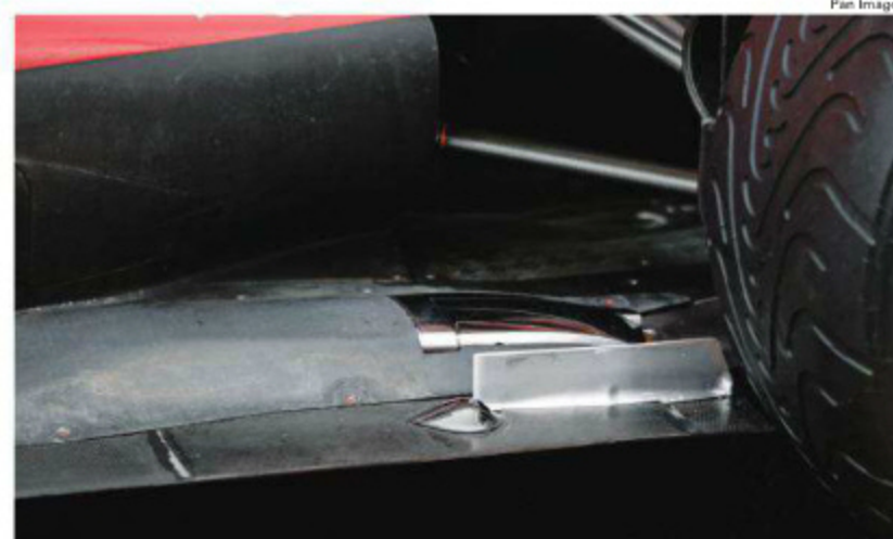
Rd.12 Belgium 想定したような効果が出せないためか、エキゾースト処理はひんぱんにモディファイが行われている。スパではテールパイプの内側に一部突起を設ける、異形デザインが導入された。
