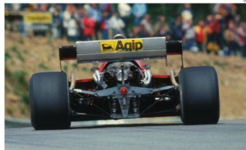
高速コースで低ドラッグのリヤウイングをつけると、グリップ不足になるのがこの年のグッドイヤーの傾向。ロッカーアーム式だったC2Bのリヤサスは第4戦サンマリノからブルロッド式に変更された。(Rd.6 Belgium)
