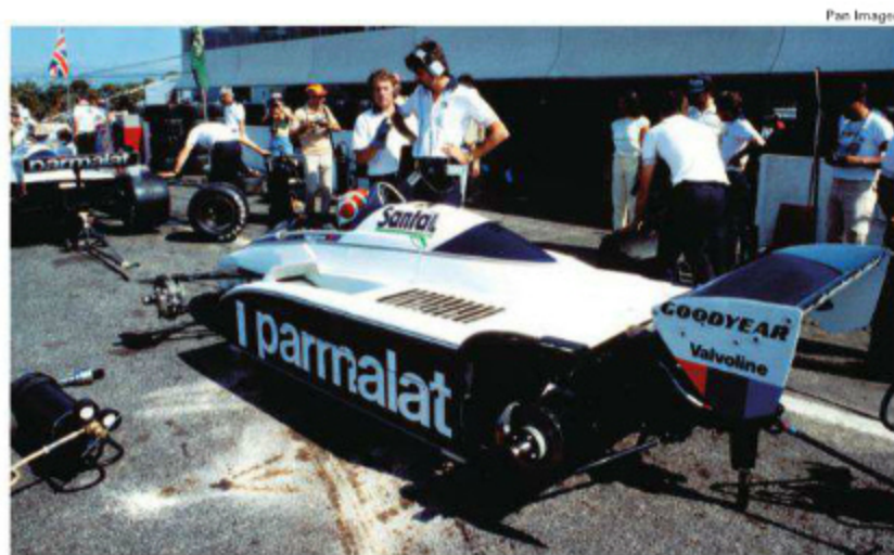
ピットストップをより短時間で実行するために、BT50は車載ジャッキを装着していた。リヤウイングの下に、後ろ側の車載ジャッキが見える。前側はノーズ部分に2本装着されていた。(Rd.11 France)
