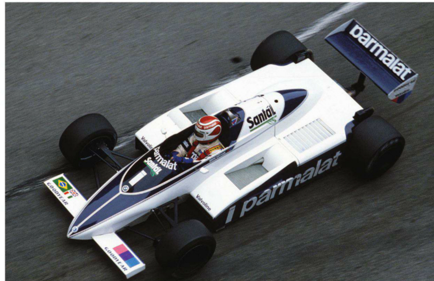
左側のサイドポンツーンの上・外側の角の部分の一部凹んだ形になっているが、ここからエンジンの吸気を取り込んだ。その後ろに排気管から出る熱気排出用ルーバーがある。(Rd.6 Monaco)
