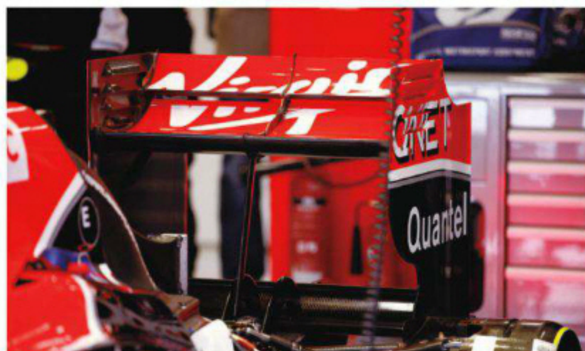
Rd.12 Belgium リヤウイングについてもスパ専用のスペックは入れられず、通常仕様を持ち込んだ。ただし、ストレーンリミットを少しでも伸ばす対策として、フラップ後縁のカーブは取り外されていた。
