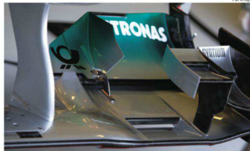
Rd.12 Belgium レスダウンフォース寄りのスパでも、フロントウイングアッパーのダブルエレメント化は継続。しかし新たな処理としてメインのフラップ上に、かなり大型のエアスプリッターが装着された。
