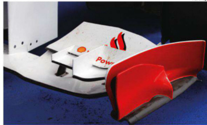
Rd.12 Belgium レスダウンフォース寄りのスパでもフロントウイングアップラーのダブルエレメントは継続され、アロンソが使った。しかしウイングそのものの仕様は通常と大きく異なり、1枚フラップが使われた。
