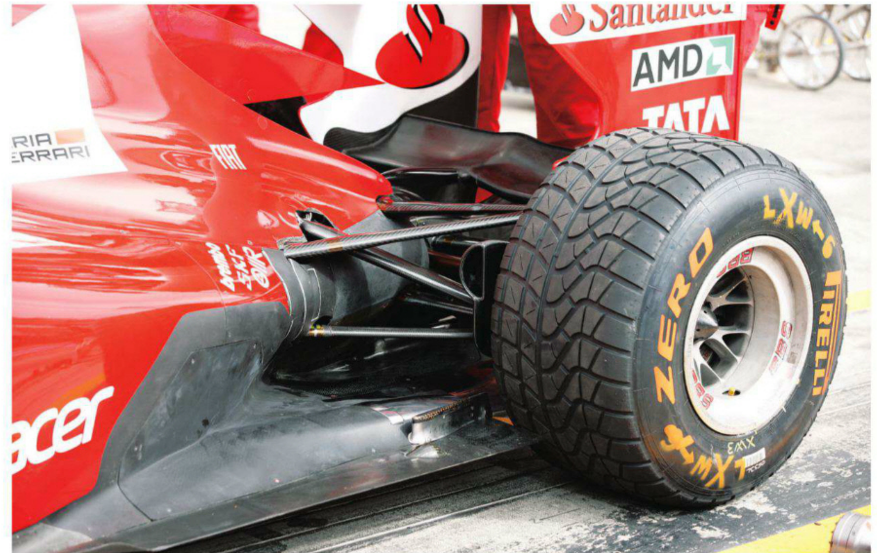
Rd.10 Germany 新仕様ではリヤサスの前衛アームとギヤボックスを接続する位置の周辺カウルが開閉されてスリム化、気流の改善が図られる。カウル後端からロウウイング下に向けてエアを抜く、新たな黒いダクトも設定。
