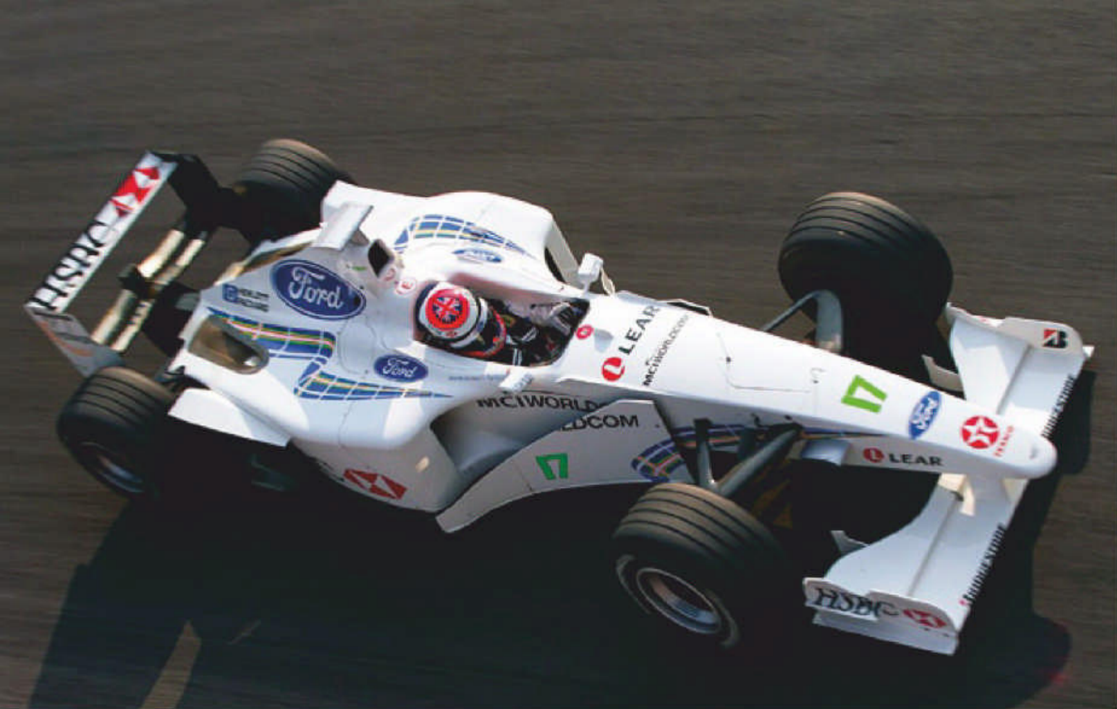
イギリスGPからはサイドポンツーンがオーソドックスな形状に変更され、よりマクラーレン風に。またその翌年のオーストリアGPでは、フェラーリに続いて上方排気を採用（写真はイタリアGP）
