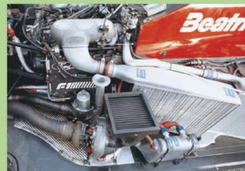
ターボ化が進む80年代、DFVに見切りをつけたフォードは120度V6ツインターボを開発。だがトラブル続き……
