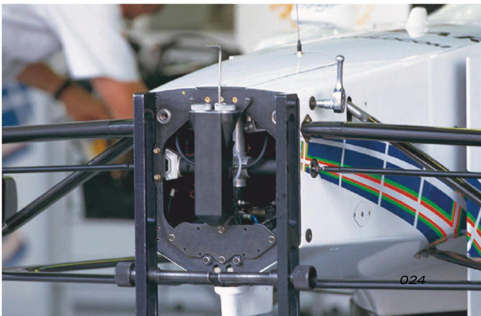
MP4-13と同様に、ステアリングタイロッドの位置がアップアームと同一平面にない構造を採用。トーションバーも、前年の縦に飛び出した構造から地面と水平になるようにレイアウトが変更された
