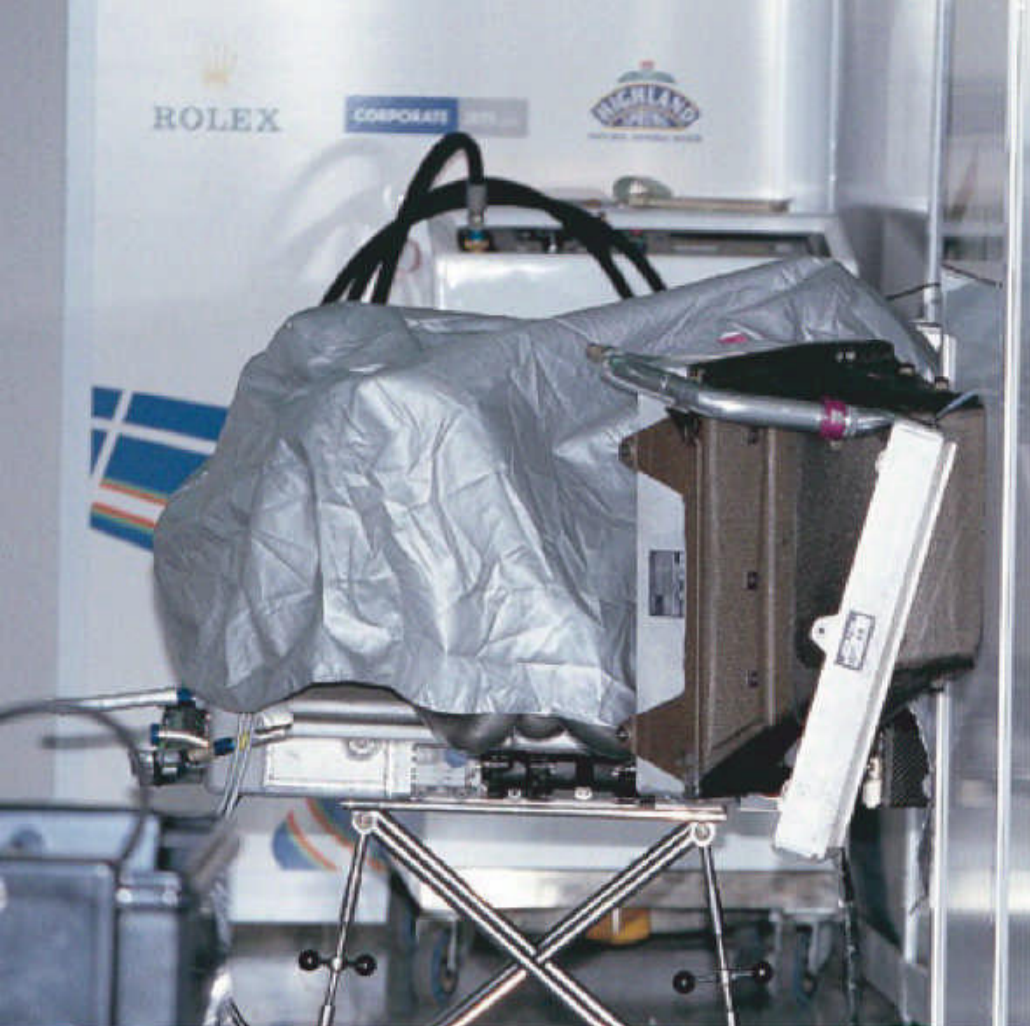
唯一発見できたエンジンの写真も、カバーをかけられた状態。V10最軽量99kgのエンジンには、ベリリウムやカーボンファイバーなど、先進技術が投入されていたという
