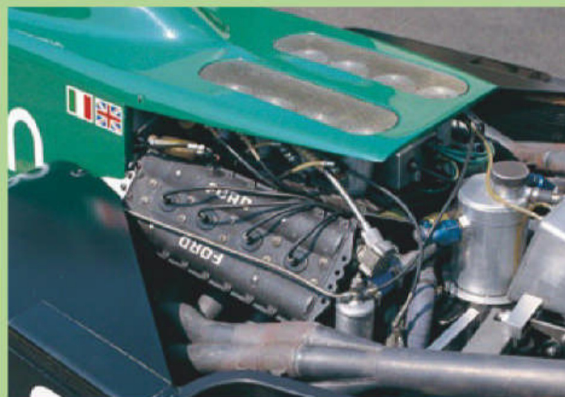
83年投入のDFYは当時コスワースに在籍のマリオ・イリエンらが手掛けた、ショートストローク版DFVの改良型
