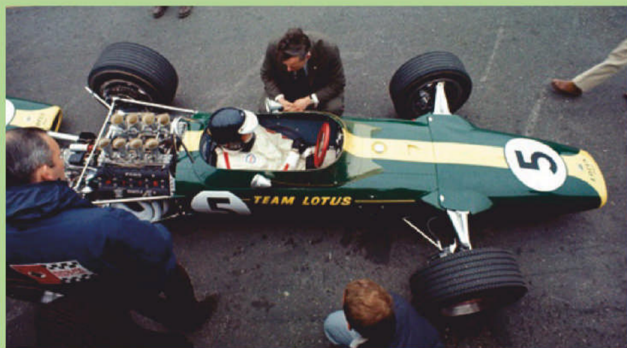
ロータス49に搭載されて67年オランダGPでデビューウインを果たすV8、フォード-コスワースDFV。翌年から市販されるや瞬く間に普及し、F1隆盛の大きな要因となる
