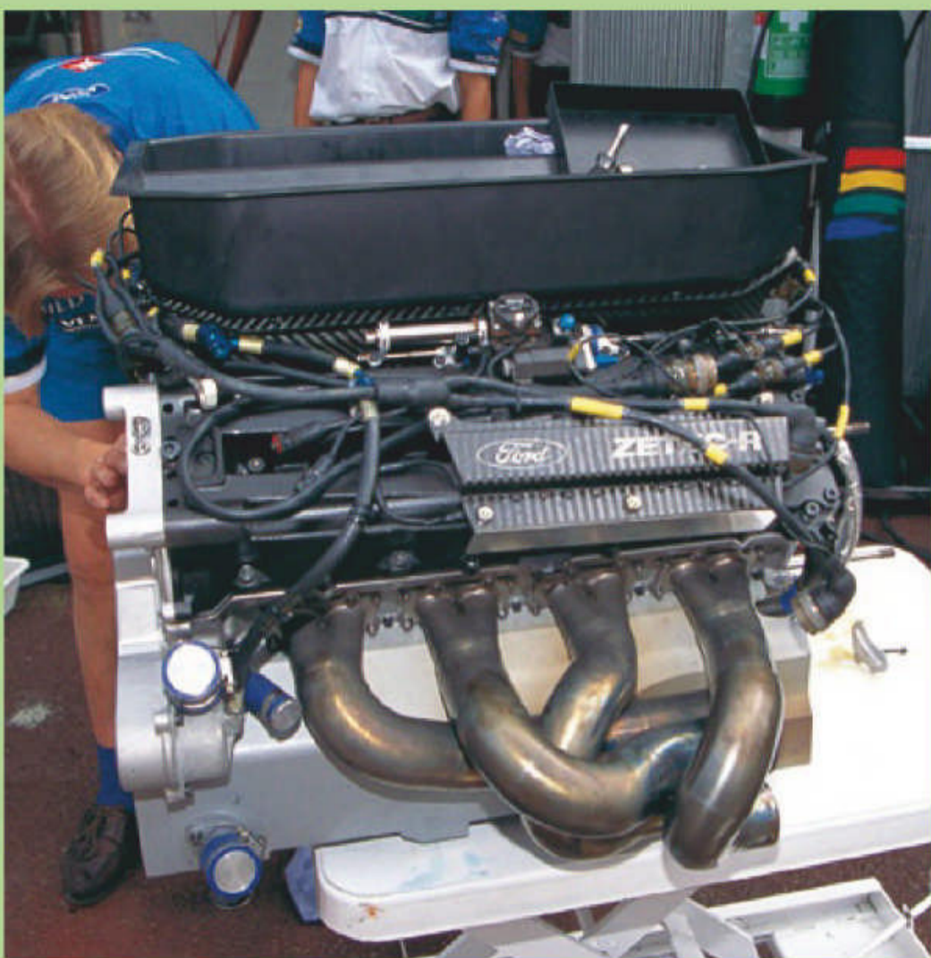
ミハエル初戴冠を強力にアシストした新世代のV8、ZETEC-R。回転数の限界点を高めるため、先代HBよりさらにショートストローク化された
