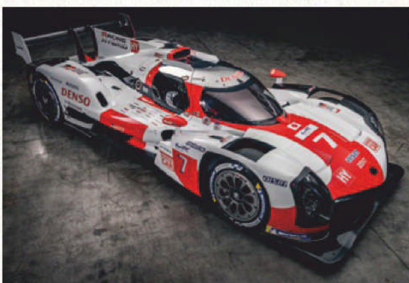
GR010ハイブリッドは全長4900×全幅2000×全高1150mmで3.5ℓのV6ツインターボを搭載。
