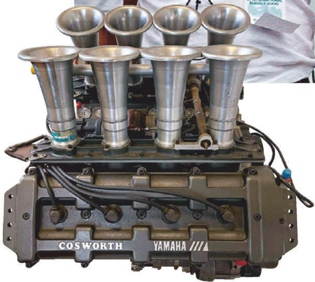
松浦が手がけた、コスワースDFVをベースに5バルブヘッドを採用したヤマハOX77エンジン。
