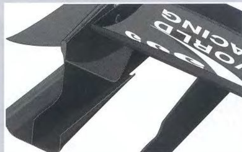
Новые торцевые пластины B.A.R имеют квадратный профиль в нижней части (вверху слева)
