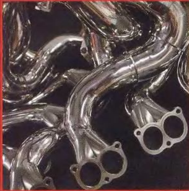
ДЕТАЛЬ ВЫХЛОПНАЯ СИСТЕМА ПРОИЗВОДСТВО FERRARI РЕСУРС 500 КМ
