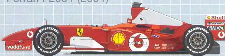
Кузов F2004 «выточен» с немыслимым для 1988 года вниманием к аэродинамике – так Ferrari компенсировала потерю в прижимной силе из-за ужесточения правил; ради лучшей управляемости пришлось отказаться от идеального расположения двигателя и пилота
