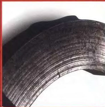
ДЕТАЛЬ ТОРМОЗНАЯ КОЛОДКА ПРОИЗВОДСТВО BREMBO РЕСУРС 320 КМ
