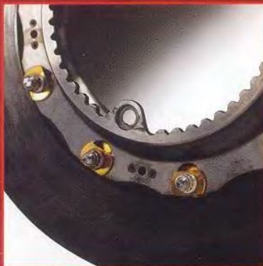
ДЕТАЛЬ ТОРМОЗНОЙ ДИСК ПРОИЗВОДСТВО BREMBO РЕСУРС 320 КМ
