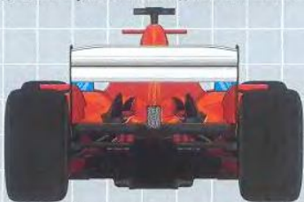
Задний диффузор, благодаря которому машина «присасывается» к дороге, на F2004 гораздо меньше
