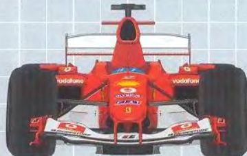
Сложное переднее крыло и торцевые пластины расположены выше, чем в 1988 году; подвеска образца 2004 года имеет меньшее лобовое сопротивление
