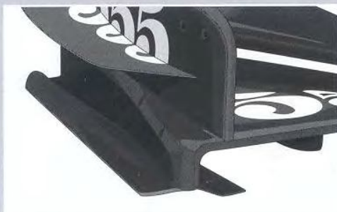
Новые торцевые пластины B.A.R имеют квадратный профиль в нижней части (вверху слева)
