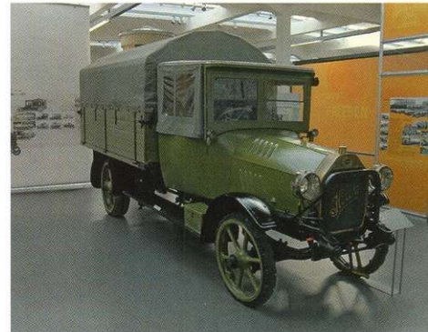
Грузовики Horch 25/42PS LKW, появившиеся в 1916 году, при 42-сильном деформированном двигателе были рассчитаны на 3,5 т полезного груза.
