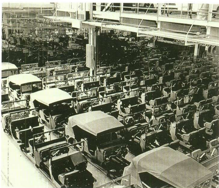
Имя им легион... Так выглядел конвейер Dodge, на котором собирались модели WC-56, 57 и 58.
