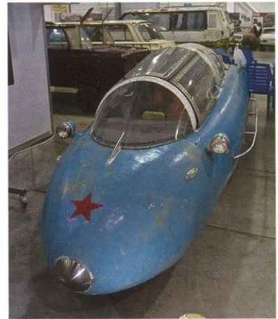
Ракетоподобный корпус из клёпаного алюминия, окрашенный голубой краской, однозначно указывает на место работы создателя этого футуристического автомобиля – советский авиационный завод.
