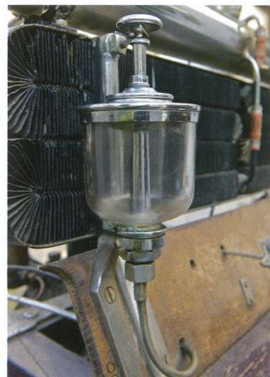
А этот «стеклянный сосуд» – не что иное, как насос системы смазки. Промежутки времени, через которые водитель давил на его шток, зависели от скорости. Что касается запаса масла, то его уровень можно было контролировать визуально.
