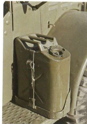
Дополнительные топливные канистры с внешним креплением – особенность американской военной техники. В действующей армии на переднее крыло Dodge зачастую устанавливалось до трёх «джериджэн» в специальных держателях.
