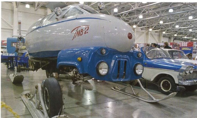
В теплое время года гусенично-лыжный снегоход ГМВ-2 из Оренбурга мог передвигаться и на колесах. Кстати, на доведение конструкции до работоспособного состояния её создателям потребовалось 24 года!
