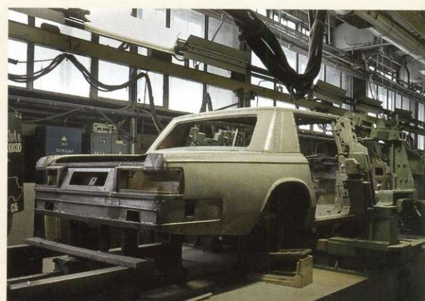
В.А. ШУЛЬМАНОВИЧ: «Кузов ставили в этот кондуктор, а тележка имитировала раму. Все базовые точки. После чего кузов закрепляли и начинали сборку. Ставили окончательно готовые и отрихованные двери, рамку переднего оперения, брызговики, облицовку, капот. Кузов полностью здесь собирался и уходил в окраску».
