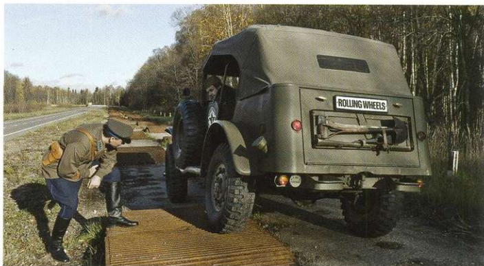
Интересный момент: все четыре колеса Dodge WC стоят на покрытии, но автомобиль не может уверенно сдвинуться с места – при попытке резко тронуться «разгруженные» по диагонали колёса начинают буксовать. А виной тому – «врождённая» нелинейность характеристик рессор.
