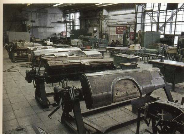
В.А. ШУЛЬМАНОВИЧ: «Штамповку производили на английском прессе. Таких всего три было в Советском Союзе. В прессе есть очень большая ванна. Она разогревается до 800 °С, там сплав... Англичане нам этот сплав поставляли, а секрет состава не раскрывали. Мы его разогреваем до жидкого состояния, опускаем туда деталь и отключаем пресс, и он у нас 12 часов остывает. За сутки можем получить крыло любого автомобиля. Потом защищаем и доводим до ума».
