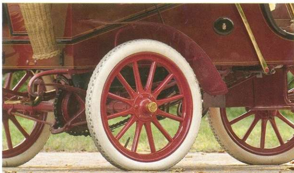
Состояние старых покрышек зависит не только от времени выпуска. Очень важны условия хранения. Поэтому иной раз случается, что более поздние экземпляры находятся в худшем состоянии, чем те, что были выпущены несколькими десятилетиями ранее.
