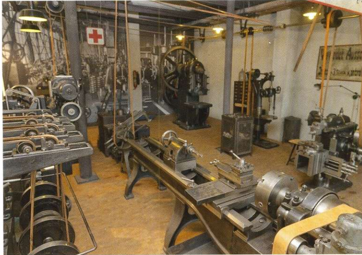
Более сложным и тяжёлым механизмам крутящий момент раздавался централизованно – через приводные ремни от валов расположенных под потолком цеха.
