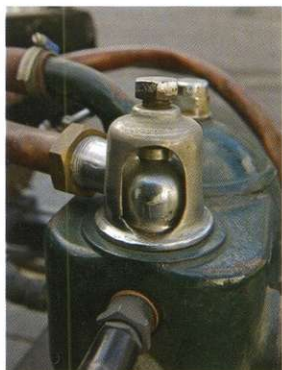
Двигатель имел полностью автоматический (то есть открывающийся самостоятельно от разряжения) впускной клапан.
