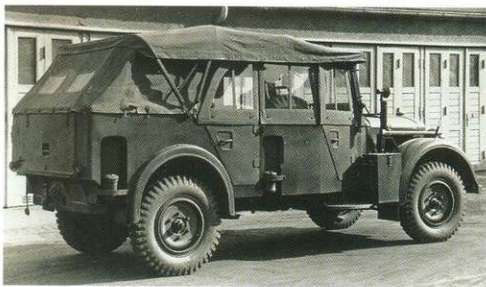
Технически Horch 901 тип Kfz. 15 менее совершенен, чем предшественник, но зато у него более технологичный кузов.
