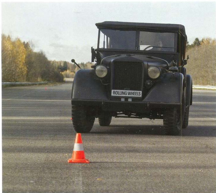
Независимая подвеска всех колёс, чувствительное рулевое управление... В общем, при должном внимании к эргономике результат на «змейке» мог быть более высоким.
