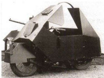
В отличие от аналогичных разработок, FP.3 был полностью защищён с фронтальной проекцией.
