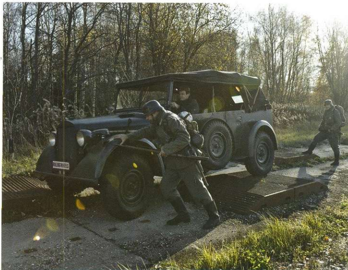
Хорошая иллюстрация короткоходности подвесок Horch – левое переднее и правое заднее колёса уже в воздухе. В общем, ситуация требует участия «личного состава».
