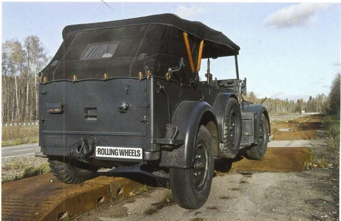
Классическое диагональное вывешивание... Если бы штатная блокировка дифференциала заднего моста дожидалась до наших дней, немецкий автомобиль вёл бы себя немного по-другому.
