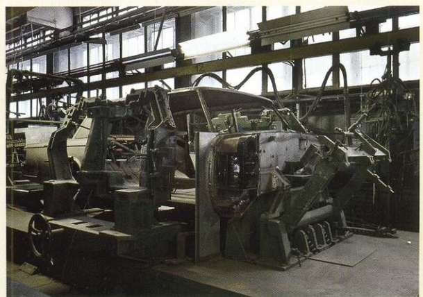
В.А. ШУЛЬМАНОВИЧ: «Кузов собирали на кондукторе. Пол выкладывали, потом пороги ставили. Сваривали тоже здесь, дверные проёмы ставили на место, закладывали центральную стойку, переднюю стойку, щит мотора, каркас. А в самом конце – задние крылья и крышу. Это отдельный рабочий пост, на котором работало четверо слесарей и сварщик. Они должны были собирать два кузова в месяц – очень серьёзная работа».
