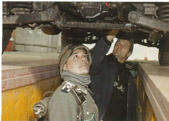
Следствием изучения конструкции Norch 901 (осмотр проводился при участии «германской стороны»), стало возникновение риторического вопроса: насколько дорог был в производстве Norch 901 , если простейшая поперечина в подвеске не просто составная, а имеет сложный профиль с сваренными внутрь штампованным усилителем и косынками. И так буквально в каждой детали...
