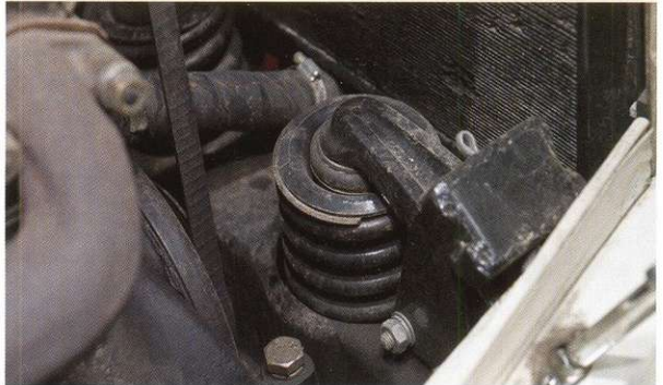
На W142 применена довольно редкая схема комбинированной рессорно-пружинной подвески. Верхний двуплечий рычаг опирается вторым концом на цилиндрическую пружину, установленную там, где у других моделей концерна крепится верхняя рессора. В этом случае нижнюю рессору можно сделать мягкой, что улучшает плавность хода, а направляющий аппарат подвески – жестким, что повышает управляемость.
