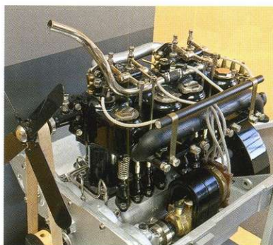
Самый первый четырёхцилиндровый двигатель, сконструированный Августом Хорьхом развивал всего 14 л.с. 1904 год.
