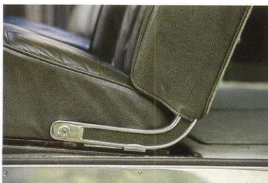
Спинки сидений откидываются, что обеспечивает доступ к багажному отделению или дополнительному «детскому» месту (на данном автомобиле оно изначально отсутствовало).
