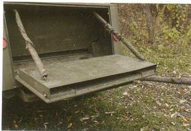
В открытом положении полый откидной борт может служить дополнительной грузовой платформой и посадочным местом, а внутри него хранился внушительный стол для штабных карт.
