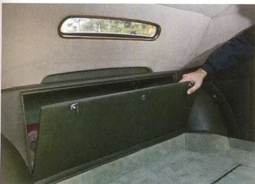
На кабриолете «А» доступ в багажник возможен только из салона – сзади расположены запасные колеса.
