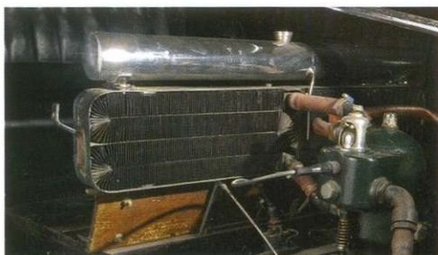
Радиатор термосифонной системы охлаждения обдувался встречным воздухом. Ни водяного насоса, ни вентилятора тогда не устанавливали.
