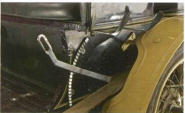
Этим рычагом перемещался натяжной ролик ременного привода. Чтобы тронуться, ремень нужно было натянуть, опустив рычаг вниз.
