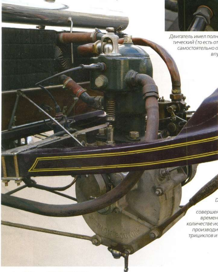
Радиатор термосифонной системы охлаждения обдувался встречным воздухом. Ни водяного насоса, ни вентилятора тогда не устанавливали.
