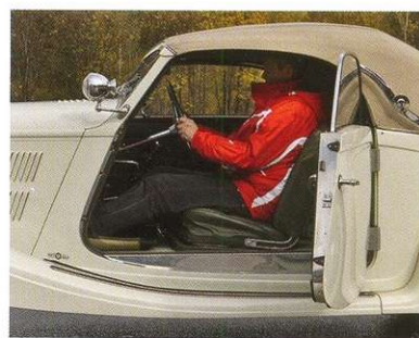
Посадка: пол кузова из-за высоких лонжеронов рамы расположен высоко, а руль придвинут к водителю. При росте 192 см удобно, но у менее рослых водителей руль оказывался непривычно близко к груди. С другой стороны, так его удобнее крутить с хорошим усилием на поворотах. Вспомните хотя бы гонщиков, пилотировавших знаменитые «серебряные стрелы».
