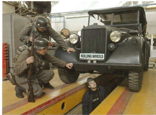
Следствием изучения конструкции Norch 901 (осмотр проводился при участии «германской стороны»), стало возникновение риторического вопроса: насколько дорог был в производстве Norch 901 , если простейшая поперечина в подвеске не просто составная, а имеет сложный профиль с сваренными внутрь штампованным усилителем и косынками. И так буквально в каждой детали...
