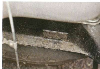
Совпадение номера шасси и рамы – большая редкость для сохранившихся до наших дней довоенных автомобилей. Кстати, «родной» мотор в данном случае обнаружился в нескольких тысячах километров от «агрегаторосителя».
