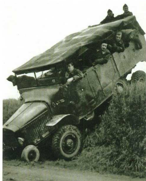
Наглядная демонстрация того, зачем нужны колёса-перекатыши.
