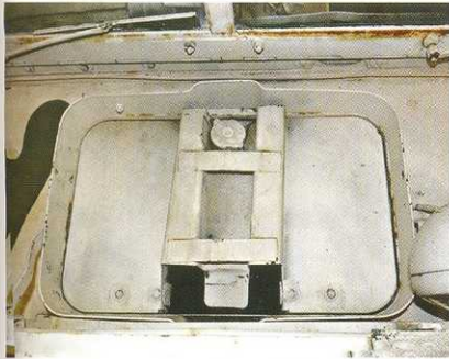
Щиток, закрывавший воздухозаборник радиатора двигателя от прибойных волн, имеет прорези для прохода ремня привода кабестана.
