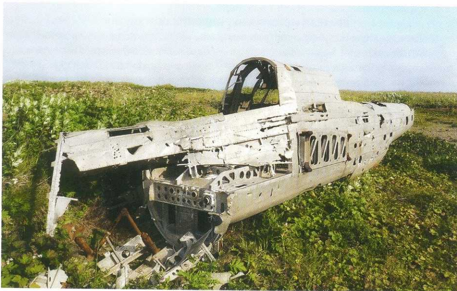
Фюзеляж японского лёгкого бомбардировщика Kawasaki Ki-48. В районе аэродрома Кузьминовский находятся останки пяти самолётов этой модели.
