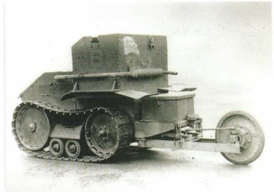
Полугусеничная танкетка Мартеля хоть и оснащалась двигателем, идеологически была тем же «ползающим танком».
