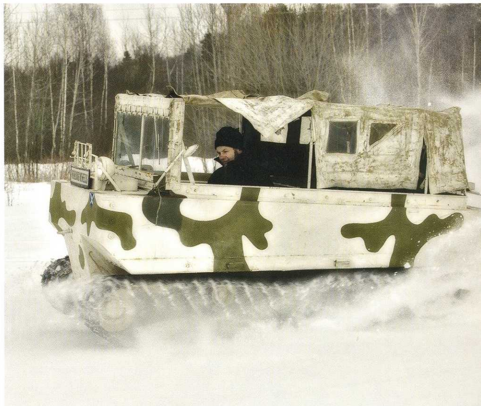
Благодаря дифференциальному механизму поворота Weasel очень легко управляется, затормаживание фрикциона приводит к движению по дуге, а не вращению на месте.
