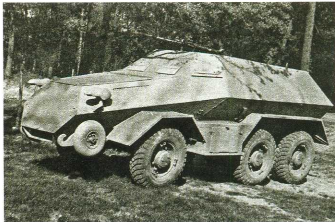
Бронетранспортёр, созданный на шасси mittlerer Radschlepper Laffly W15T (f). Обращает внимание проработанность деталей корпуса и рациональные углы наклона бронелистов.
