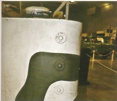
Когда-то этими болтами крепились съёмные понтоны, повышавшие «мореходность».
