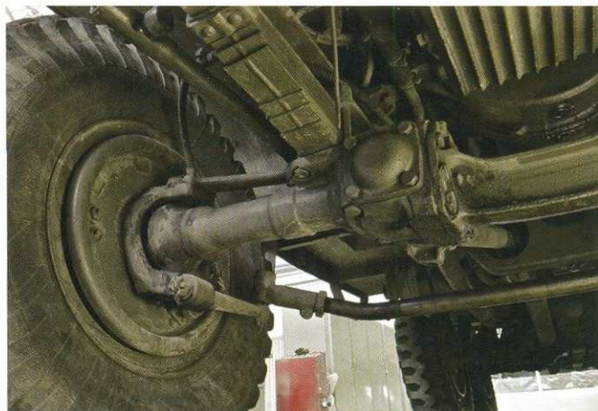
Сравнивая два тягача Laffly, невозможно не обратить внимание на конструктивное различие передних подвесок. У W15 (фото внизу) спереди использованы пружины и телескопические амортизаторы, а у S20 (фото сверху) – рессоры и их... межлистовое трение.
