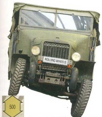
LAFFLY S20TL. Высота подъёма колеса (мм) до наступления диагонального вывешивания (замеры Rolling Wheels)
