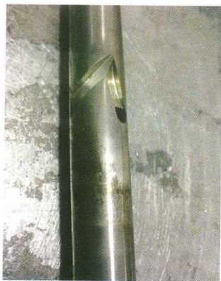
Задир на деталях ТНВД прежде всего возникают в результате использования «сухой» солярки, отличающейся низкими смазывающими свойствами.
