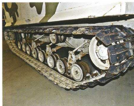
Восемь пар опорных катков по обоим бортам обеспечивали машине равномерное распределение давления на грунт.
