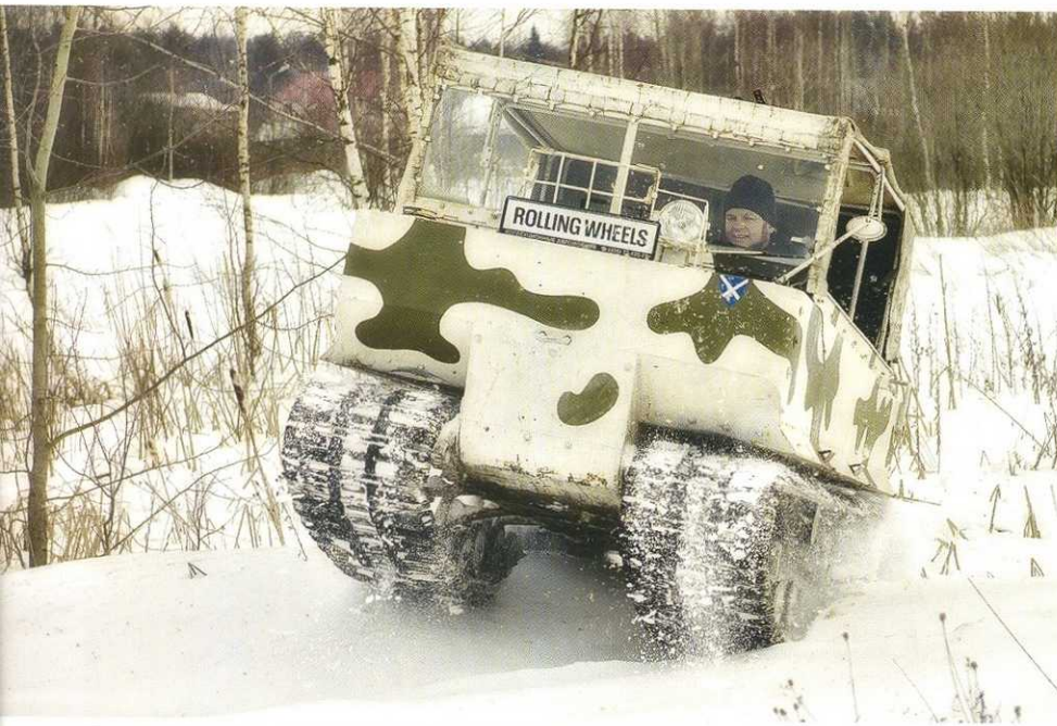
Подвеска Weasel на полуэллиптических рессорах оказалась не только очень энергоёмкой, но и как ни странно весьма комфортной!
