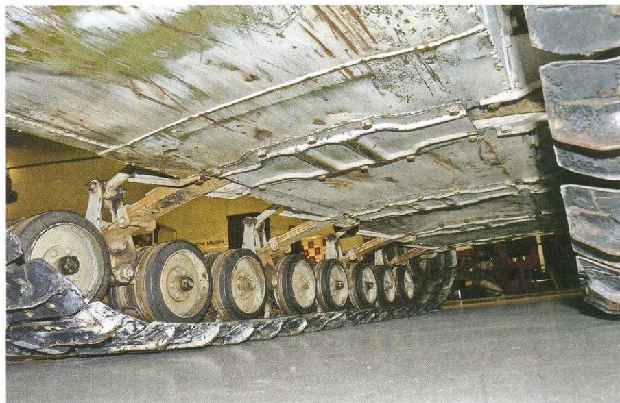
Ровное днище снегохода-амфибии не только повышало проходимость, но и снижало сопротивление на плаву. Обратите внимание на съёмные крышки, закрывающие детали подвески снизу.
