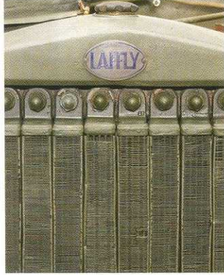
Система охлаждения двигателя по версии Laffly – это достаточно сложное инженерное «сооружение», включающее в себя десять легко отключаемых секций радиатора. Что, в свою очередь, обеспечивает прекрасную выживаемость машины.
