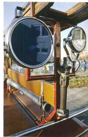
На передней стойке лестницы также закреплены прожектор, синий проблесковый маяк и опора радиоантенны.
