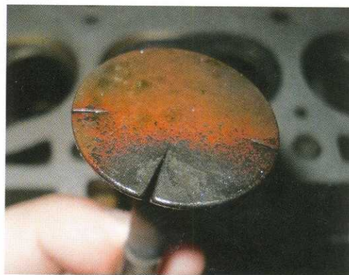
Высокое октановое число используемого бензина в сочетании с неправильной регулировкой зажигания приводит к печальным результатам. Из-за роста температуры в цилиндре могут потрескаться и прогореть как поршни, так и клапаны. Причём не обязательно одновременно. Что произойдет раньше, зависит от их индивидуальной термостойкости.
