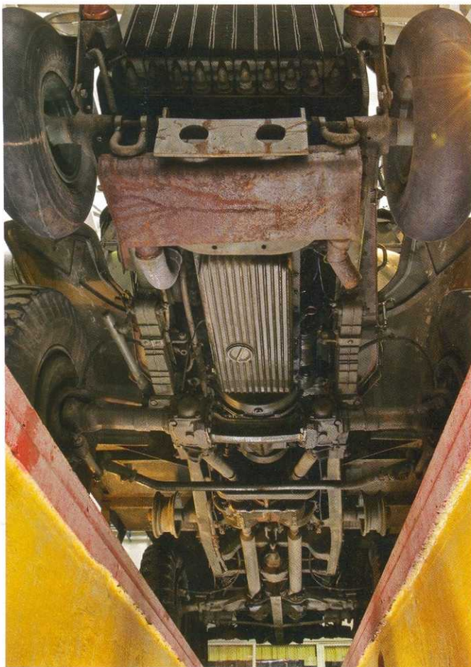
Кажущийся совершенно беззащитным поддон двигателя Hotchkiss 680 на самом деле выполнен из толстой литой стали с мощным двухсторонним оребрением для охлаждения масла.
