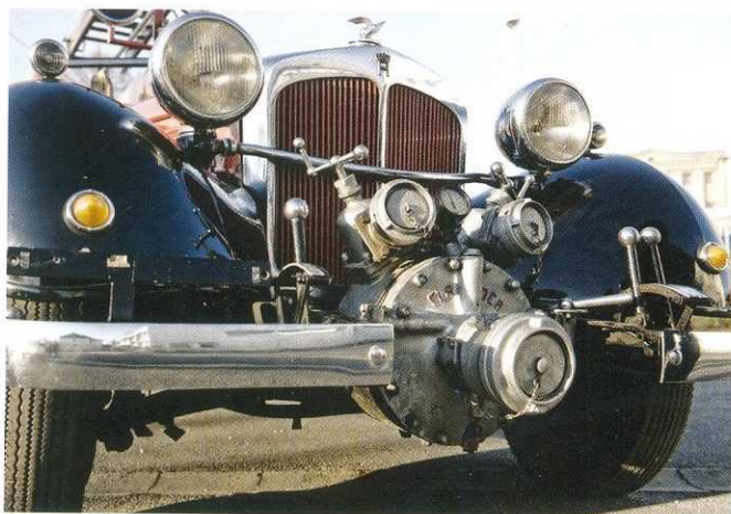
Расположение мощной и тяжелой помпы в переднем свесе вызвано прежде всего компоновочными соображениями. В конце 30-х при конструировании пожарных машин этот громоздкий агрегат уже старались устанавливать в базе.
