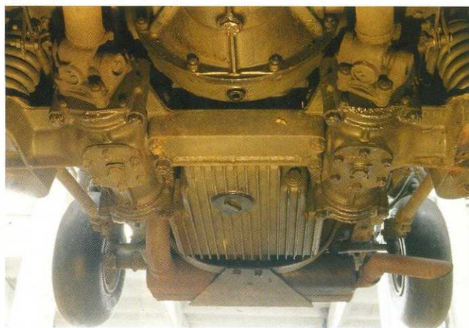
Сравнивая два тягача Laffly, невозможно не обратить внимание на конструктивное различие передних подвесок. У W15 (фото внизу) спереди использованы пружины и телескопические амортизаторы, а у S20 (фото сверху) – рессоры и их... межлистовое трение.
