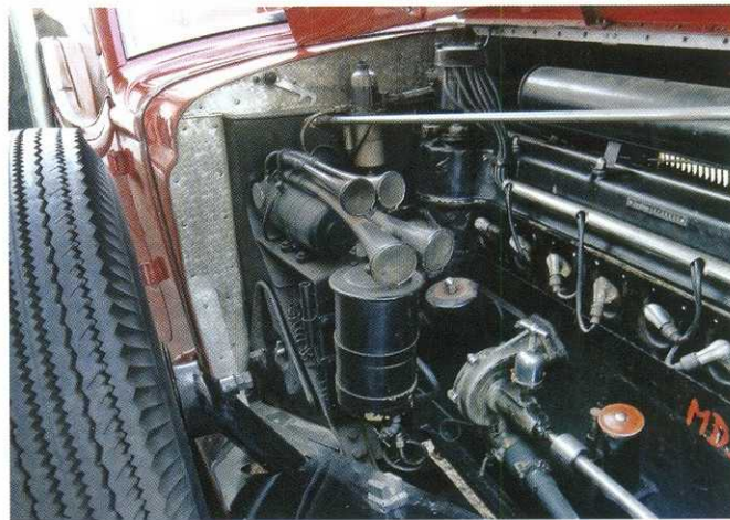
Четыре «дудки» на ресивере в углу моторного отсека – не что иное как пневматическая пожарная сирена с компрессором, приводимым в действие небольшим электромотором, на котором и установлены её раструбы. На стандартных 853-х всего этого оборудования естественно не было.
