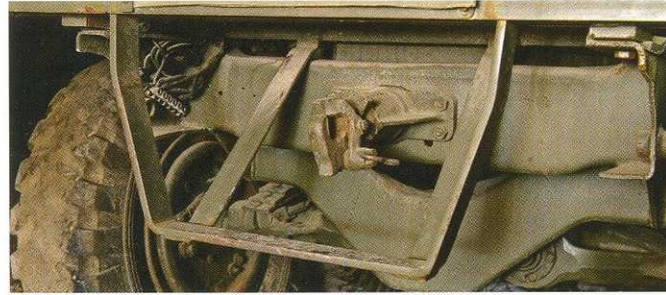
Главным элементом артиллерийского тягача является буксирное приспособление, от удобства пользования которым зависит скорость развёртывания орудия на позиции. А то, что жёсткозакрепленная подножка не мешает сцепному устройству, говорит о продуманности конструкции.
