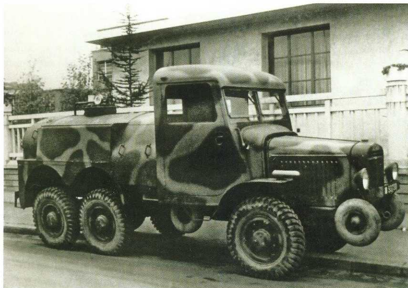
Заправщик топлива на базе Laffly S20TL. Машина была разработана специально для сопровождения подразделений драгунов.
