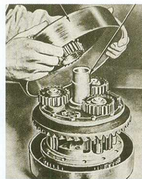
Благодаря дифференциальному механизму поворота Weasel очень легко управляется, затормаживание фрикциона приводит к движению по дуге, а не вращению на месте.
