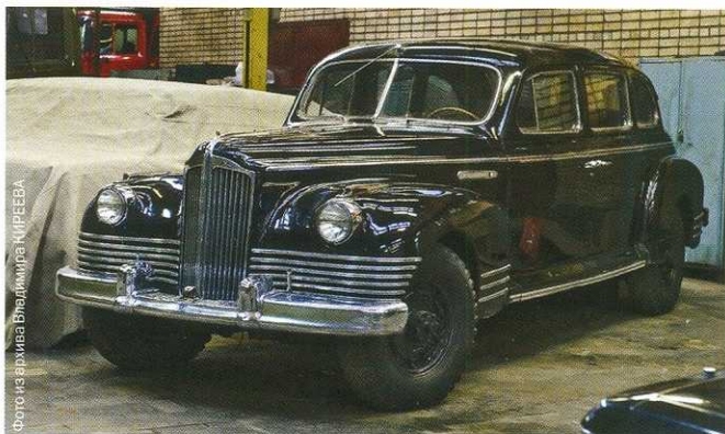
Полноприводный ЗИС-110П (шасси №3) с кузовом лимузин (фото сверху). В настоящее время автомобиль бережно хранится в одном из заводских цехов. Машина не до конца укомплектована, но находится в хорошем техническом состоянии (фото внизу). Насколько мы можем судить, агрегатно она соответствует протестированной нами версии с кузовом фэтон.
