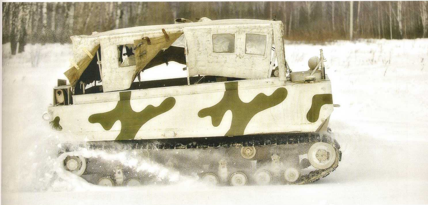
Удельное давление гусениц даже у гружёного Weasel меньше, чем у большинства современных снегоходов – 130 г/см 2 ! Благодаря этому уникальная ретро-амфибия может преодолевать снежный покров любой глубины.
