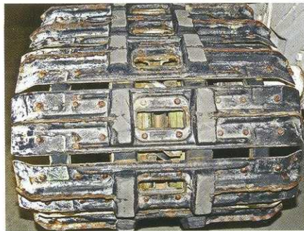
Стальные траки гусениц имеют специальные резиновые башмаки для «бесшумного» движения по дорогам с твёрдым покрытием.
