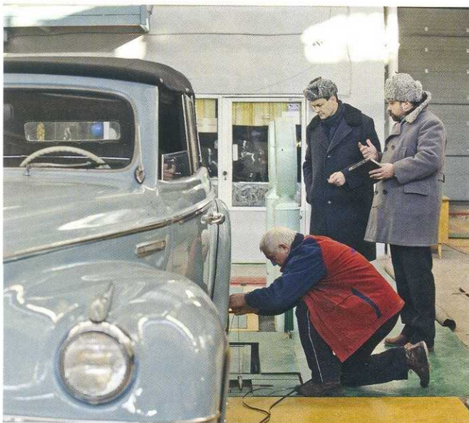
ЗИС-110П. Габаритные размеры и развесовка (замеры Rolling Wheels)
