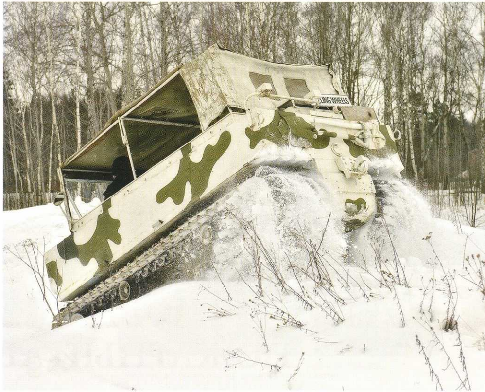
...В ситуациях, когда не хватало сцепления гусениц, выручала мощность двигателя, позволявшая в случае необходимости штурмовать препятствия «ходом».
