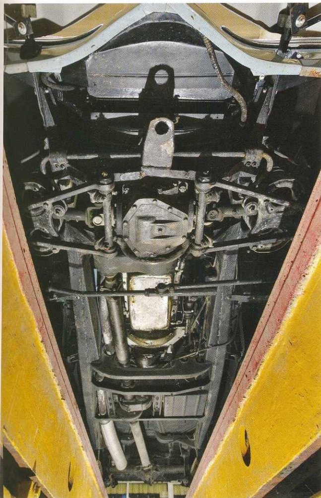
Рама ЗИС-110П весьма существенно отличается от рам ЗИС-110. На «тяжёлом шасси» нет характерных для стандартного «сто десятого» X-образных поперечин с центром в середине базы. А ещё на этом фото видно, что карданные валы находятся в разных плоскостях, что, в свою очередь, требует для обеспечения плавной работы очень сложных расчётов геометрии.
