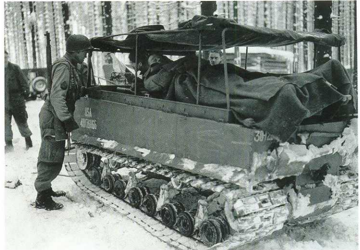
M29 в роли санитарной машины (Арденны, зима 1944 года). Этот компактный вездеход был способен транспортировать до двух раненых, лежащих на носилках.
