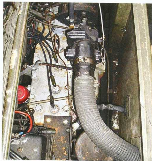
Нижнеклапанный двигатель Studebaker 6-170 Champion был специально модифицирован для установки на Weasel: генератор перенесён вверх, переделан привод вентилятора охлаждения и установлен специальный карбюратор, который больше нигде не применялся (последнее стало настоящей проблемой для сегодняшних владельцев M29C). Важная деталь – за время выпуска машины несколько раз менялась система подачи воздуха в карбюратор, что заметно, если сравнить рисунок двигателя из журнала запчастей и фото внизу.
