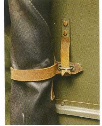
Брезентовые двери скатываются в трубочку и надёжно фиксируются ремешками из сыромятной кожи. В основном так и ездили – на военной машине важна скорость посадки и выгрузки экипажа.
