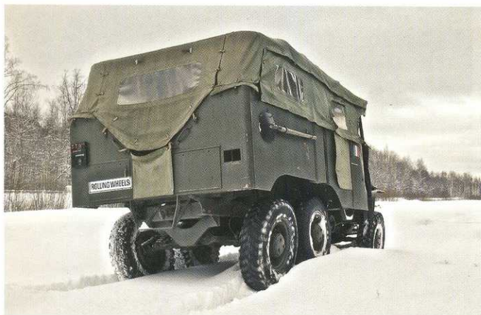
Бортовая схема трансмиссии и способность подвески «обтекать» препятствия буквально «отправили в нокаут» старые добрые чугунные надолбы. Причём как в летнем варианте, так и изрядно присыпанные снегом. Мы же, в свою очередь, были вынуждены признать: на подобном рельефе оба испытуемых были вне конкуренции.
