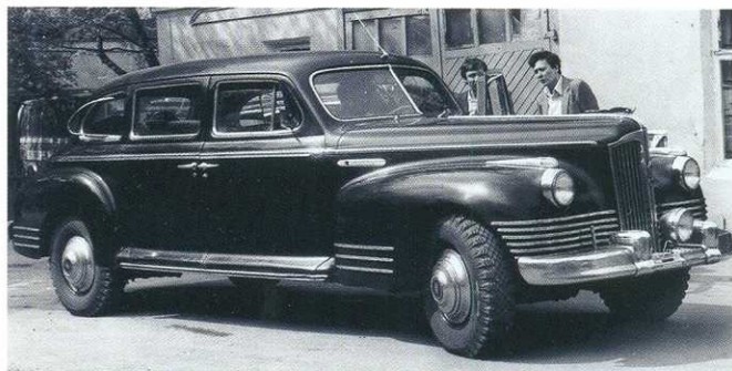
Полноприводный ЗИС-110П (шасси №3) с кузовом лимузин (фото сверху). В настоящее время автомобиль бережно хранится в одном из заводских цехов. Машина не до конца укомплектована, но находится в хорошем техническом состоянии (фото внизу). Насколько мы можем судить, агрегатно она соответствует протестированной нами версии с кузовом фэтон.
