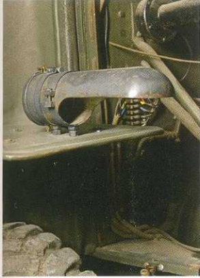
Светомаскировочный огонь направлен чётко под нос машины. Таким образом даже пятно света на дороге скрыто от посторонних глаз. Правда, собственно, и водителю машины оно видно не слишком хорошо...
