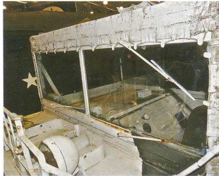
Weasel имел два стеклоочистителя: один с ручным, а другой с электрическим приводом.
