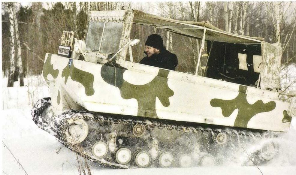
Гусеницы Weasel хорошо очищаются (обратите внимание на «струю» снега, отбрасываемую в бок от заднего ведущей звёздочки). Что, в свою очередь, очень важно для обеспечения высокой проходимости по снегу, поскольку снижает риск забивания им ходовой части.
