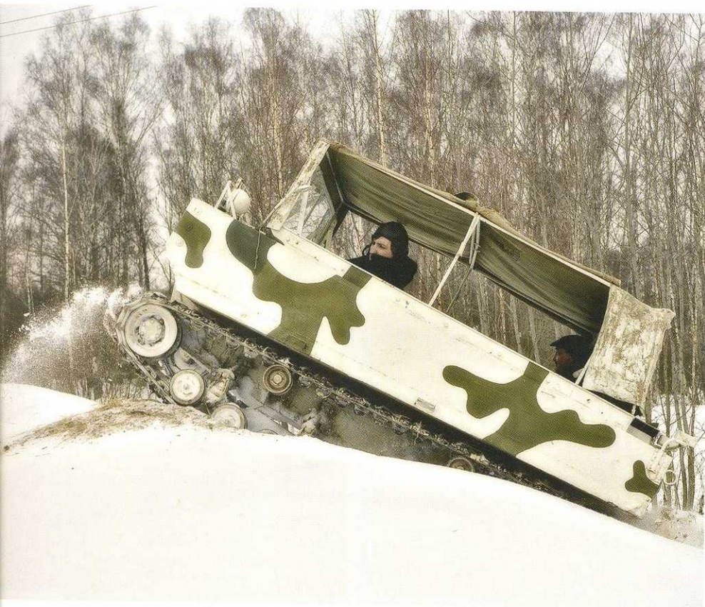
При движении «в натяг» по сложному рельефу сцепления резинометаллических гусениц со снегом и промёрзшим грунтом хватало не всегда. Приходилось менять тактику...
