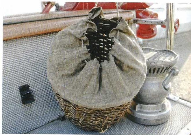
Фильтры для забора воды из открытого водоёма. На переднем плане – грубой очистки, на заднем – тонкой. Один надевается на другой, а оба вместе – на водозаборный рукав.
