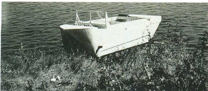
Прототип M29C. После серии испытаний поплавки несколько видоизменили, а впереди появился откидной волноотбойник.
