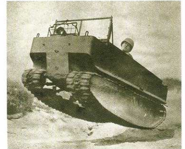
Это фото, сделанное во время летних испытаний в песчаных дюнах Индианы перед высадкой в Северной Африке, косвенно подтверждает динамические характеристики и энергоёмкость подвески Weasel.
