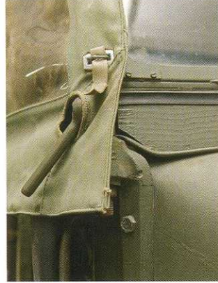
Удивительно, но уровень проработки «мелочей» у Laffly настолько высок, что даже в элементах тента сделаны аккуратные вырезы под все ручки и крючки. На фото: фиксатор рамки лобового стекла.
