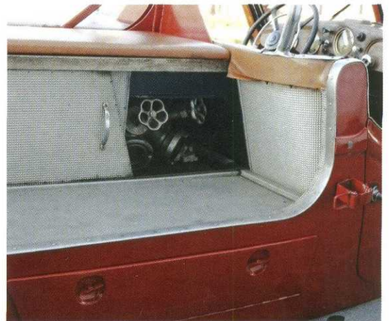
Место под лавкой для расчёта тоже не пустует: здесь живут вентили, разветвители и другие громоздкие приспособления.
