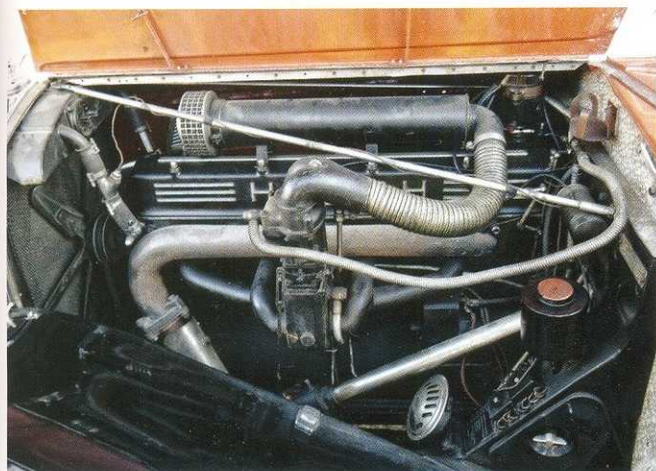
Верхнеклапанная рядная «восьмёрка» объёмом 4911 см 3 и мощностью 100 л.с. при 3400 об/мин для своего времени была по конструкции очень прогрессивным двигателем. Приготовление горячей смеси здесь осуществлялось двухкамерным карбюратором с падающим потоком Solex 35 IFF.
