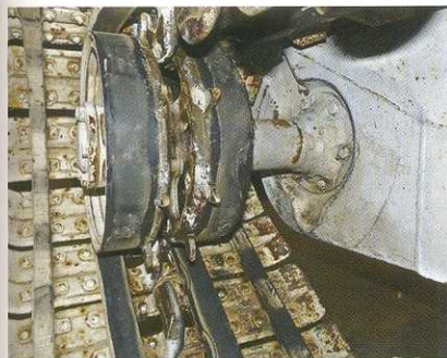
Опорная поверхность ведущего колеса имеет резиновое покрытие, не дающее ему обрести льдом (это может привести к сходу гусениц).
