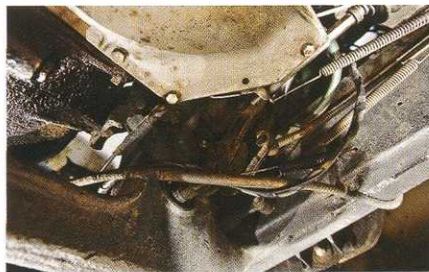
На ЗИС-110 была применена полностью дублированная (уникальное решение для того времени) и достаточно эффективная гидравлическая тормозная система с исполнительными механизмами барабанного типа. Одно плохо: расположение элементов тормозной системы и в частности главного тормозного цилиндра никак не соответствует «внедорожному» позиционированию автомобиля.
