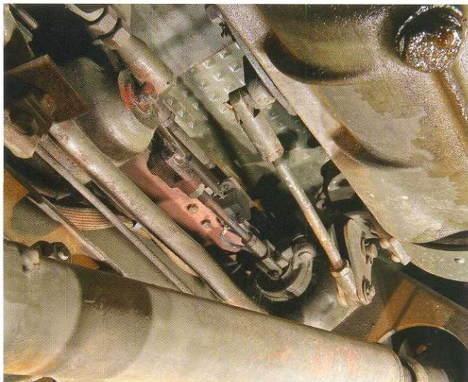
Барabanные тормоза с механическим приводом (на фотографии хорошо видны его коромысла-уравнители) обеспечивали большому Laffly тормозную динамику в полном соответствии с разгонной...
