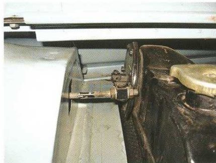
Для ускорения процесса прогрева двигателя и предотвращения выхолаживания системы охлаждения в верхнем баке радиатора располагается дополнительный термостат. Он автоматически управляет вертикальными элементами радиаторной решётки, играющими роль жалюзи.
