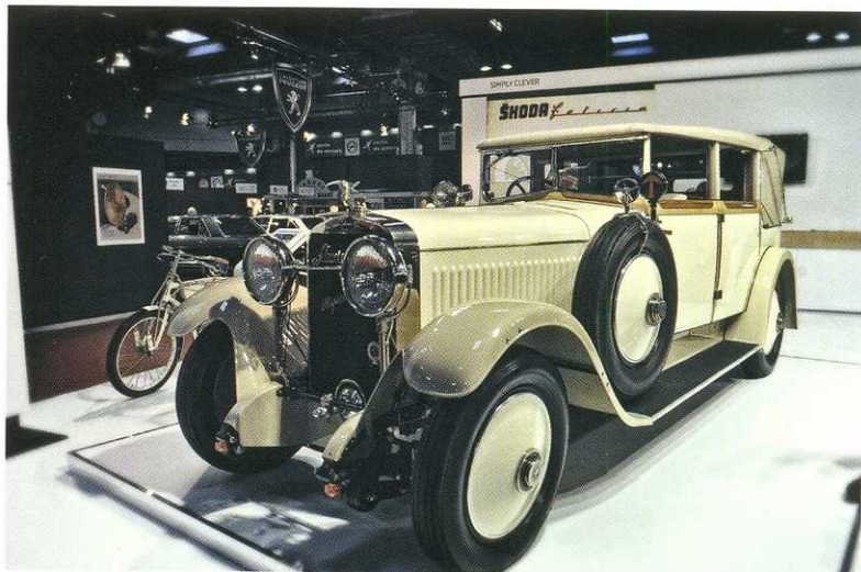
Выпущенная в 1928 году Skoda Hispano Suiza оснащалась рядной «шестёркой» объёмом 6654 см 3 и мощностью 100 л.с. История модели такова: в 1924 году Skoda приобретает лицензию на производство седанов премиум-класса у испанской Hispano-Suiza, а первый автомобиль, сошедший с конвейера в 1926 году, был передан президенту Чехословакии Томашу Масарику. Всего до 1929 года было произведено 100 таких автомобилей.
