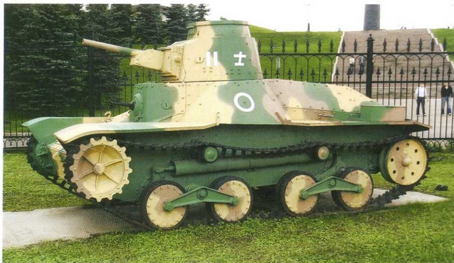
Лёгкий танк «Ха-го», который, собственно, и был доставлен с Шумшу в начале 90-х годов в ходе экспедиции Сергея Цветкова. Характерная деталь – оригинальные гусеницы пришлось оставить на острове, и вместо них реставраторы использовали похожие элементы от советского тягача.
