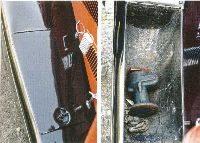
Одной из двух запасок пожертвовали, чтобы разместить в левом переднем крыле дополнительную нишу для оборудования. Открыв её, мы нашли оригинальный винтовой домкрат этого автомобиля.
