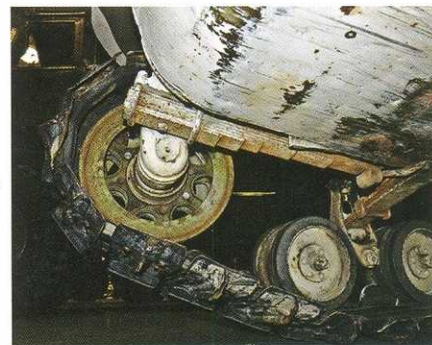
Требуемое натяжение гусеничной ленты конструктивно обеспечивается четвертьэллиптической рессорой.
