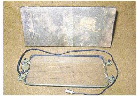
Чтобы лобовое стекло не обмерзло, в комплекте имелось второе накладное. Причём оно было укомплектовано уплотнителем по периметру и электроподогревом.
