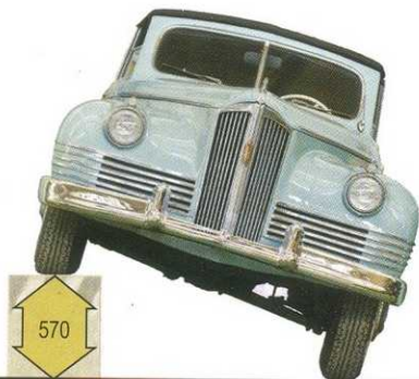
ЗИС-110П. Высота подъёма колеса (мм) до наступления диагонального вывешивания (замеры Rolling Wheels)
