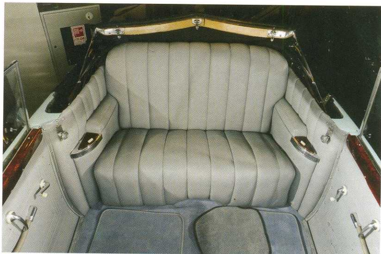
Задний диван на ЗИСах изготавливался по технологиям дорогой мягкой мебели. Полная изоляция пружин, прочный каркас, несколько слоёв обивки и самое главное – гагажий пух, набитый под давлением для получения характерной мягкой упругости.
