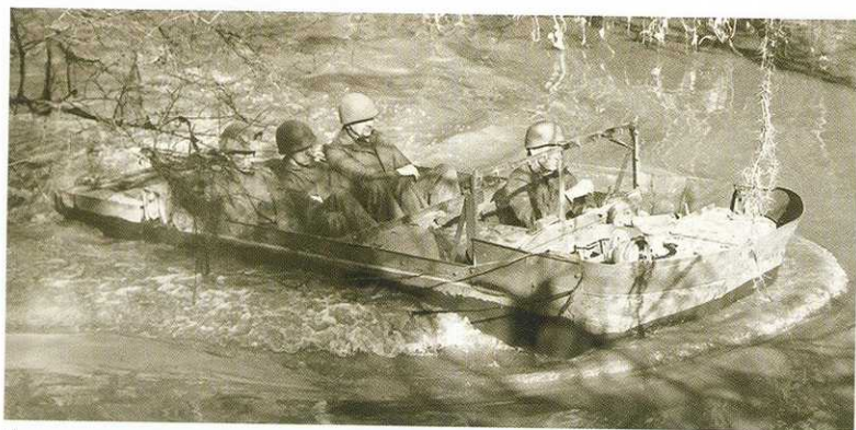
Для улучшения мореходности Weasel получил съёмные понтоны: передний с имевшим ременный привод от двигателя кабестаном и задний с двумя подъёмными рулями, заметно изменившие его внешний вид. Также машина была оборудована гидродинамическими щитками на гусеницах с отверстиями-соплами в передней части, что позволило поднять скорость на плаву с 3 до 6 км/ч.
