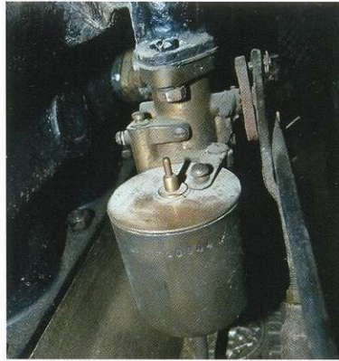
Немногие автомобильные фирмы производили карбюраторы самостоятельно. На К 12/20 установлен изготовленный на Русско-Балтийском заводе весьма современный (по меркам начала века, разумеется) лувльеризационный карбюратор с поднимающимся потоком конструкции Жюльена Поттера. Стержень в верхней части цилиндрической поплавковой камеры предназначался для обогащения смеси перед запуском двигателя.
