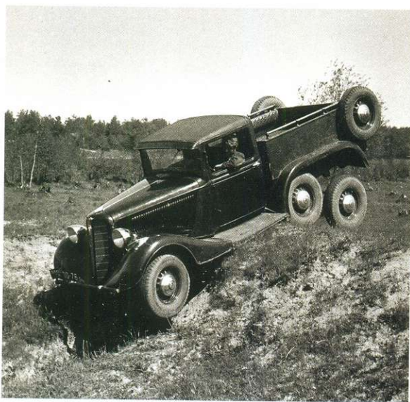
Наглядная демонстрация ходовых возможностей трёхосной неполноприводной модели ГАЗ-21. За рулем машины её создатель Виталий Грачёв.
