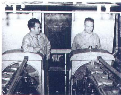
Клайд Гриффин и Ричард Бёрд в машинном отделении «Большой Берты». Благодаря не слишком плотной компоновке «моторного отсека» обслуживать оба двигателя было удобно.
