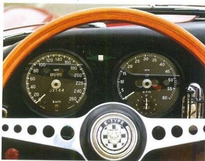
Приборная панель Jaguar E-Туре выполнена в авиационном стиле. Претензий на особую элегантность нет, но показания прекрасно читаются.
