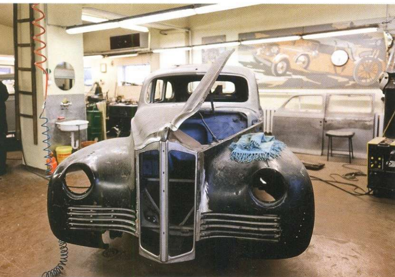
Вообще-то мастерская редко берёт заказы на машины, в кузовах которых нет деревянных элементов (высококвалифицированный столяр не должен оставаться без работы). Этот цельнометаллический ЗИС-110 – редкое исключение.
