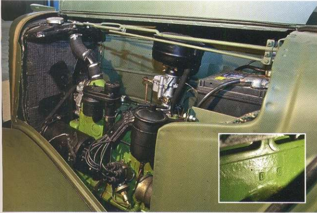
Взятый в своё время за основу мотора ГАЗ-11 рядный шестицилиндровый двигатель Dodge D-5 ведёт свою историю с конца 20-х годов. Довольно быстро этот агрегат заслужил славу тяговитого, экономичного и надёжного, а потому был использован в невероятном количестве моделей. В нашем случае всё говорит о том, что на тестируемый ГАЗ-61 он был установлен прямо на заводе.
