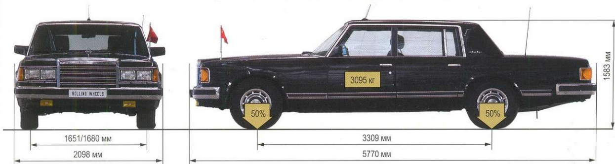
ЗИЛ 41041. Габаритные размеры и развесовка (замеры Rolling Wheels)
