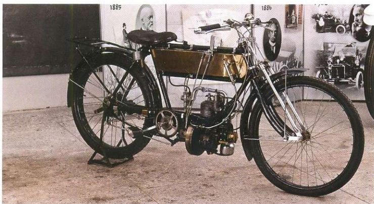
Бельгийский FN 1910 года. Модель считалась спортивной и была оборудована одноцилиндровым двигателем объёмом 178 см 3 (3,5 л.с.), двухступенчатой коробкой передач и карданным валом. Масса 58 кг, скорость 45 км/ч.
