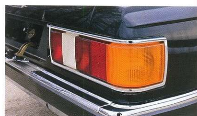
Казалось бы, ничем не примечательные задние фонари на самом деле настоящий медницкий шедевр. Их корпуса спаяны из мелких заготовок, отрифтованы и покрыты хромом.
