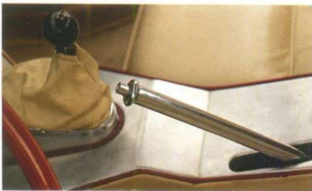
В 1963 году компактная и конструктивно простая коробка передач Moss Vaux 4-Speed ещё не имела синхронизатора первой передачи (он появился позже, на E-Туре 4.2). Но вместе с тем агрегат обладал потрясающей надёжностью и оптимальным подбором передаточных чисел.
