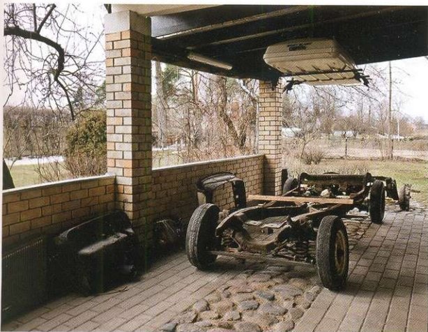
В этой раме, стоящей на подвесках от «Волги» и «Победы», пока ещё сложно узнать будущий Нorch 930. Но работа идёт полным ходом: машина разобрана, и отдефектована. Началась стадия комплектации.
