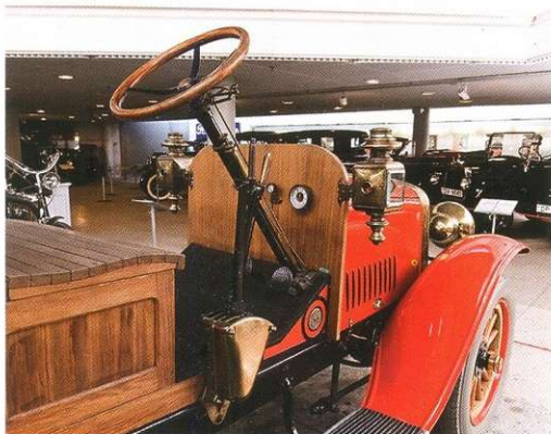
«Руссо-Балт» 24/40 Серии Д выпущен в 1912 году. Это единственный сохранившийся грузовой марки. Пожарный автомобиль был построен на самом лёгком из грузовых шасси с 40-сильным двигателем объёмом 4,5 литра. В последующих номерах журнала мы расскажем об этом уникальном автомобиле поподробнее.
