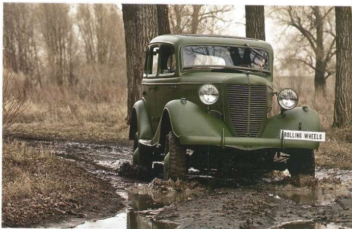
За счёт шин, более приспособленных к движению по мокрой глине, чем по снегу, на оттаявших просёлках ГАЗ-61 управлялся точнее и увереннее, чем на зимней дороге. Хотя здесь тоже было скользко. Особенно на заднем приводе.
