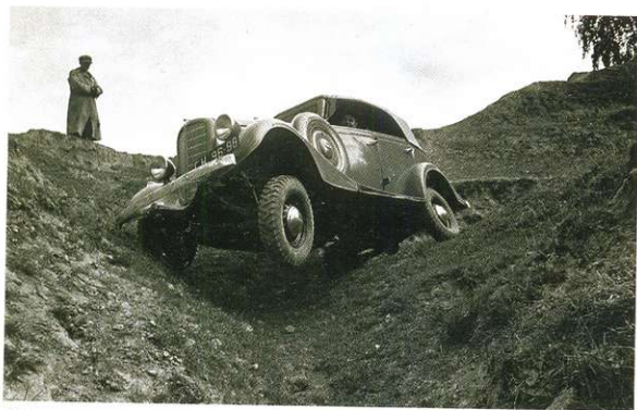
Классическое диагональное вывешивание. На снимке: модель ГАЗ-61 преодолевает один из оврагов. Ходы рессорной подвески, работающей в паре с неразрезными мостами, внушают уважение.
