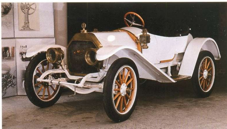
Austin 40 hp 1911 года – самый старый автомобиль в рижском музее. Особо интересны детали. Такие, как, например, указатель температуры, представляющий собой обыкновенный жидкостный градусник, вмонтированный в пробку радиатора, или привод спидометра, осуществляемый от шестерён на переднем колесе.
