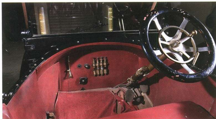
Управлять «Руссо-Балтом» было непросто. Кроме неэффективных тормозов и тяжёлого рулевого управления надо было следить за смазкой двигателя по каплям в стекляшках маслоуказателей и подстраивать при изменении режима движения, подкачивая воздух в бензобак. Также требовалось постоянно регулировать опережение зажигания рычагом на рулевой колонке.
