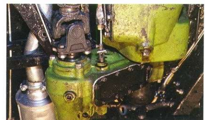
Эта же одноступенчатая раздаточная коробка собственной разработки с включением переднего привода скользящей муфтой была использована на ГАЗ-64, ГАЗ-67 и броневом автомобиле БА-64.
