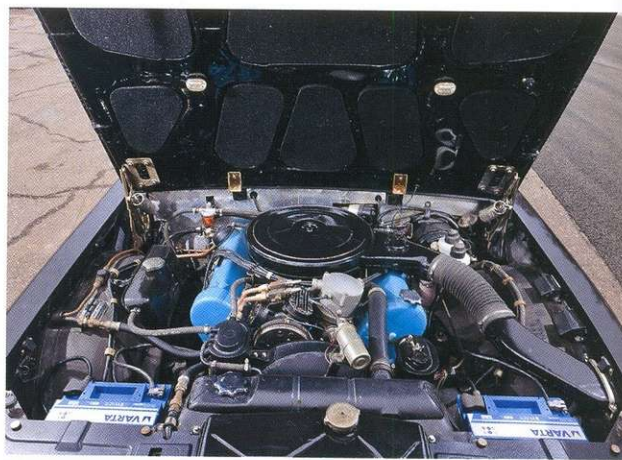
Под капотом ЗИЛ 41041 – могучий агрегат объёмом без малого 8 литров. Каждый экземпляр этого двигателя «гоняли» на стенде в разных режимах 32 часа, а затем снимали нагрузочную характеристику.
