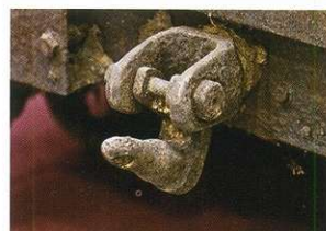
Судя по конструкции сцепного устройства, этот советский гусеничный тягач Т-20 «Комсомолец» эксплуатировался немецкими войсками (в финской армии эти машины использовались вплоть до середины 50-х годов).
