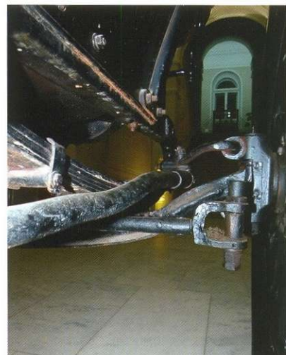
Кинематикой рулевого привода в те годы серьезно не занимались. При ходе подвески передние колёса доворачивались, затрудняя управление.
