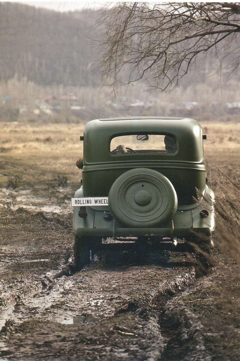
Весна – это либо раскисшие скользкие колеи, либо тяжёлые, пропитанные водой сугробы. Как стало понятно в ходе нашего «двухсезонного» теста, машина уверенно справлялась и с тем и с другим. Этому способствовало удачное сочетание правильной развесовки, подходящей трансмиссии, тяговитого двигателя, большого просвета под днищем и цепкой резины.
