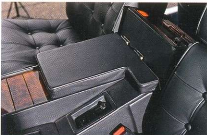
В этот бокс между передними сиденьями устанавливали оборудование спецсвязи.
