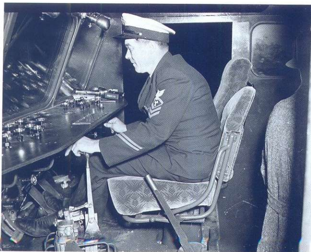
Ричард Бёрд в кресле механика-водителя. Обратите внимание: вместо традиционного для колёсных машин рулевого колеса Snow Cruiser по аналогии с гусеничной техникой оборудован двумя рычагами управления.
