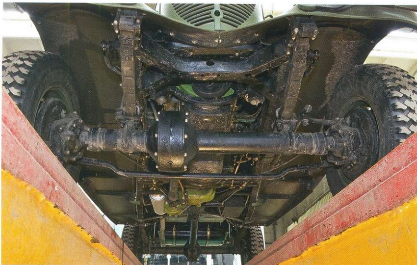
Массивный поворотный кулак на ГАЗ-61 мог скрывать как шарнир «Рцеппа», так и более привычный «Бендикс-Вейс» (на снимке).
