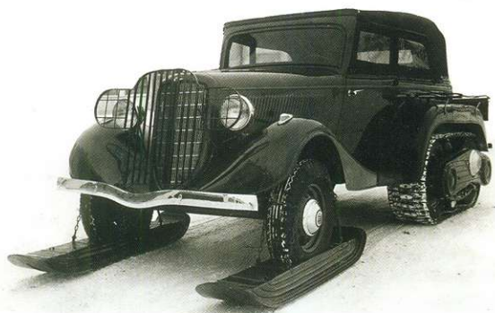
Вездеход НАТИ-ВМ, подготовленный для движения по снежной целине. Характерная деталь: устанавливаемые на передние колёса лыжи – решение традиционное для «полугусеничников» разработки НАТИ.
