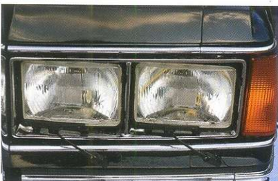
Головной свет не соответствует действующим нормативам. При четырёхфарной системе освещения ближний свет должны обеспечивать две наружные фары, а дальний – две внутренние. Здесь в обоих режимах задействованы все четыре. Таково было требование Генерального заказчика.
