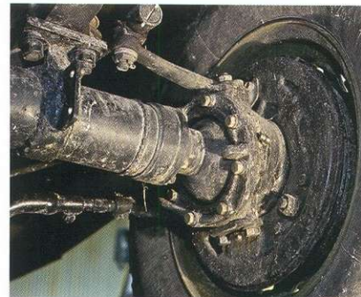
Массивный поворотный кулак на ГАЗ-61 мог скрывать как шарнир «Рцеппа», так и более привычный «Бендикс-Вейс» (на снимке).
