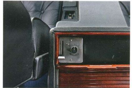
Температуру в задней части салона можно регулировать отдельно – для 70-х это верх климатического комфорта.
