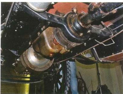
Основным считался этот трансмиссионный тормоз с внешними колодками, приводимый в действие педалью.
