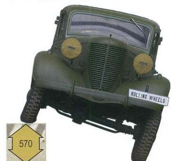
Листовые рессоры этого автомобиля допускают невероятный для этого типа упругих элементов ход подвески. Но при этом ни о каком стабилизаторе поперечной устойчивости нет и речи.
