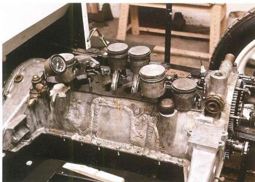
Судя по швам на блоке и общему состоянию, этому двигателю Fiat 503 пришлось повидать многое. Кстати, когда его разобрали, то первым делом увидели... поршни от «Москвича-408».
