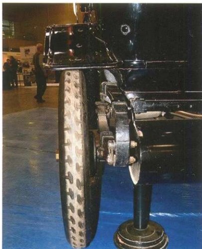
Кузов крепился к заднему мосту через мягкие 3/4-эллиптические рессоры. Такая конструкция подвески обеспечивала отличную плавность хода, но слабо фиксировала мост в боковом направлении, ухудшая поведение в поворотах. Впрочем, в те годы это было не столь важно.
