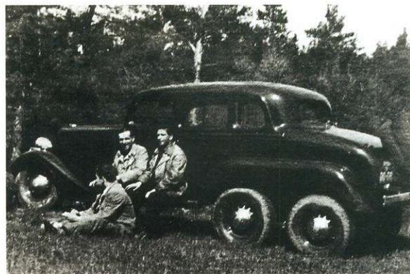
Единственная известная фотография ГАЗ-25. На снимке хорошо виден массивный багажник, внутри которого скрывались два дополнительных сиденья.
