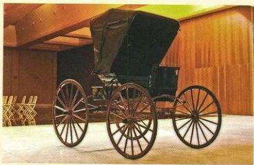
Типичный американский экипаж buggy. Обратите внимание на поперечные рессоры и большие колеса.
