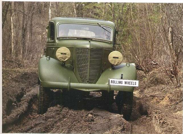
На сухом неровном грунте машина требует постоянного подруливания. Управляемые колёса живут своей жизнью. Отчасти это результат износа деталей рулевого механизма, отчасти недостаточной жёсткости рулевого привода.
