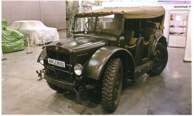
Уникальный полноприводный, полноуправляемый тягач Fiat-SPA TL 37 (1942 год) предназначался для транспортировки лёгких гаубиц. На его базе выпускалась специализированная машина AS-37 Sahariana, а небольшое число автомобилей было переоборудовано в самоходные артиллерийские установки Autocannone da 75/27.
