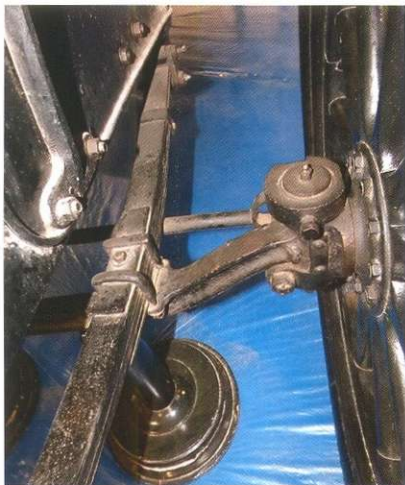
Передняя зависимая подвеска на полуэллиптических рессорах отличалась потрясающей надежностью. Обратите внимание на кованную из легированной стали балку.
