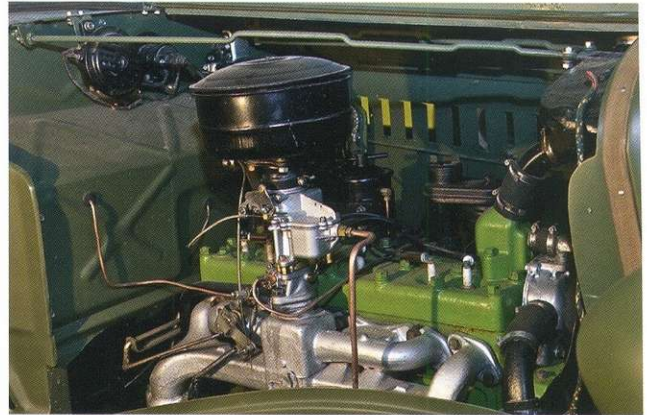
Взятый в своё время за основу мотора ГАЗ-11 рядный шестицилиндровый двигатель Dodge D-5 ведёт свою историю с конца 20-х годов. Довольно быстро этот агрегат заслужил славу тяговитого, экономичного и надёжного, а потому был использован в невероятном количестве моделей. В нашем случае всё говорит о том, что на тестируемый ГАЗ-61 он был установлен прямо на заводе.
