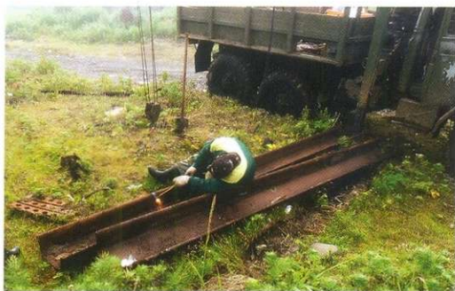
Собственно, из этих массивных стальных тавров и были изготовлены полозья для транспортной волокуши.
