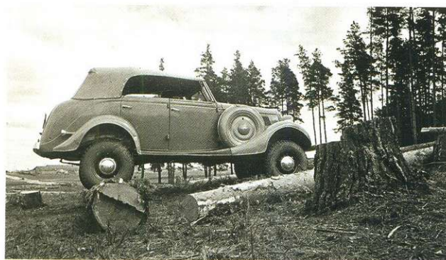
Наглядная демонстрация недюжных «триальных» способностей детища Грачёва. Для справки: Ford-Marmion-Herrington LD2 к «снаряду» просто не допустили – слишком велик был риск повредить днище о брёвна.
