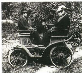
«Dos-à-dos» и «vis-à-vis» – кузова, прямоком доставшиеся первым «самобеглым коляскам» от гужевых экипажей. В переводе с французского название первого звучит как «спина к спине», а второго – «лицом к лицу». В Англии первый кузов называли dog-cart, поскольку под сиденьями часто устанавливался специальный ящик для охотничьих собак.
