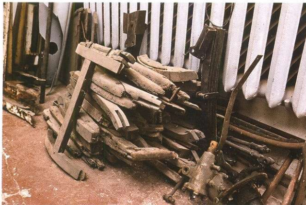
Эта аккуратно сложенная груда дровяшек отнюдь не дрова. Перед нами всё, что осталось от силовой структуры довоенного кузова. Использовать их по прямому назначению, конечно, уже нельзя, но образцами столжару они ещё послужат.
