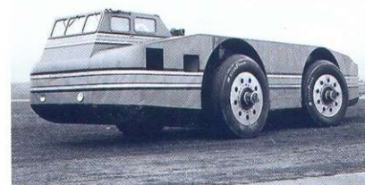
Для улучшения маневренности управляемыми были сделаны четыре колеса Snow Cruiser.
