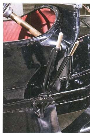
За правым «глухим» бортом находятся рычаги переключения передач и тормоза.
