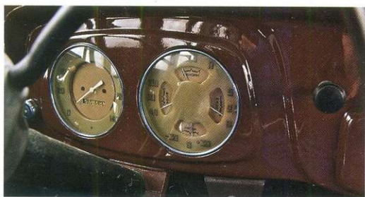
Главное отличие приборной панели внедорожного ГАЗ-61-73 от стандартного М1 – появившийся указатель давления масла.
