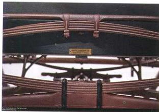
Американский «багги» типа piano box каретника Noyes, 1910 год. Особенностью этой модели являются поперечные рессоры.
