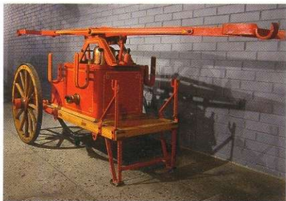
Помпа-прицеп приводилась в действие силами двух пожарных. В 20-е годы этот агрегат по производительности ещё вполне мог тягаться с помпами на основе бензиновых моторов.
