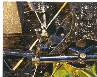
Массивный поворотный кулак на ГАЗ-61 мог скрывать как шарнир «Рцеппа», так и более привычный «Бендикс-Вейс» (на снимке).
