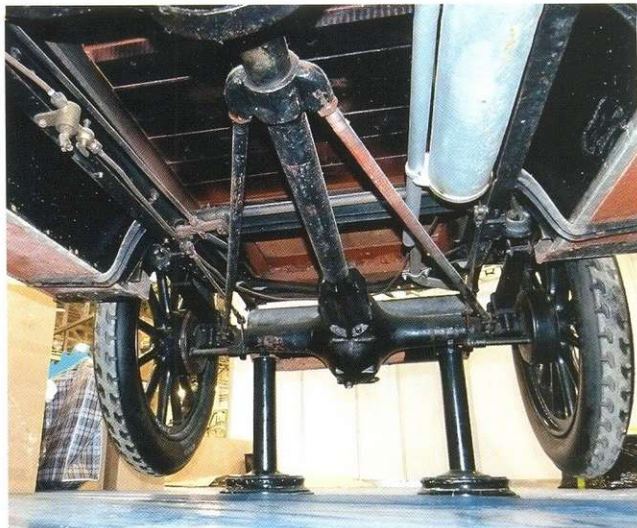
Крутящий момент на задний мост передавался валом, проходящим в трубе. Жёсткость конструкции придавали растяжки, образующие треугольник.
