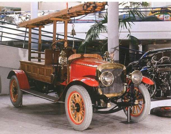
«Руссо-Балт» 24/40 Серии Д выпущен в 1912 году. Это единственный сохранившийся грузовой марки. Пожарный автомобиль был построен на самом лёгком из грузовых шасси с 40-сильным двигателем объёмом 4,5 литра. В последующих номерах журнала мы расскажем об этом уникальном автомобиле поподробнее.
