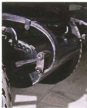
Две части рессоры задней подвески соединялись серьгой, что увеличивало долговечность коренных листов.
