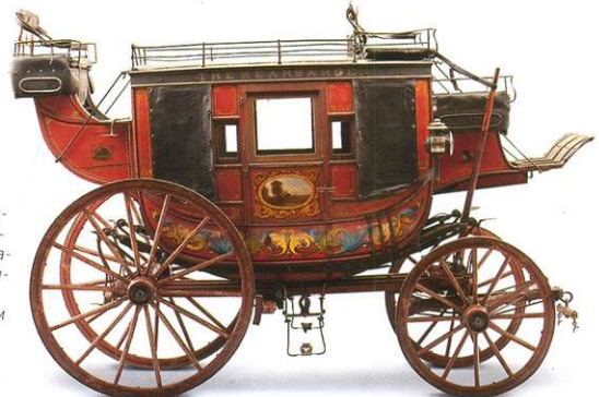
Поворотный круг передней оси – узел характерный для конных экипажей. Впрочем, аналогичная конструкция до сих пор используется в автомобильных прицепах.
