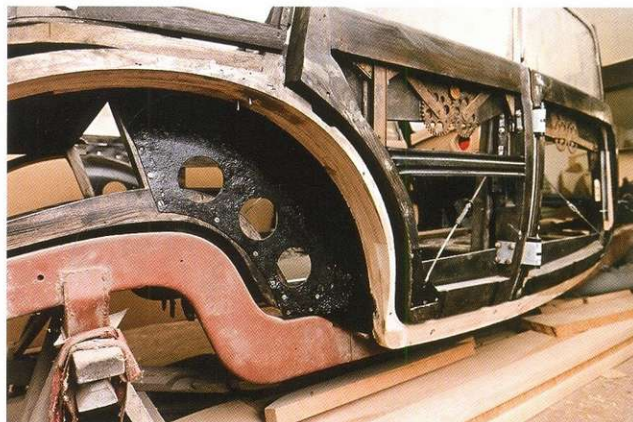
А так эта же структура выглядит в уже собранном из новых деталей виде. Все конструктивные элементы тщательно сохранены, но изготовлены заново.
