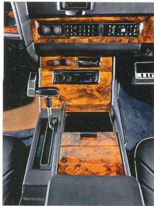
Консоль панели приборов отделана шпоном из капа ореха. Поворотные жалюзи кондиционера распределяют воздух по передней части салона, а сзади кондиционер свой. Последнее особенно актуально на «длинной» машине с перегородкой.
