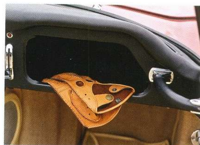
Перчаточный ящик в спортивном автомобиле – вещь нужная (других «ёмкостей» в салоне нет). Но в Jaguar подошли к вопросу по-спартански. Даже крышку ставить не стали.
