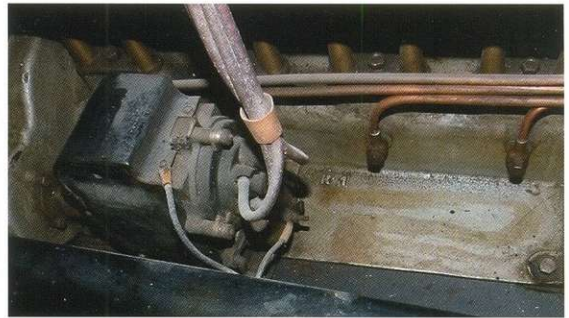
Немногие автомобильные фирмы производили карбюраторы самостоятельно. На К 12/20 установлен изготовленный на Русско-Балтийском заводе весьма современный (по меркам начала века, разумеется) лувльеризационный карбюратор с поднимающимся потоком конструкции Жюльена Поттера. Стержень в верхней части цилиндрической поплавковой камеры предназначался для обогащения смеси перед запуском двигателя.
