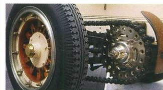
Специализировавшаяся на пожарных автомобилях American La France в 1915 году выпустила гоночный Speedster Racer. Главная особенность модели – ведущий мост смещён относительно задней оси, а передача крутящего момента на колёса происходит при помощи цепей.
