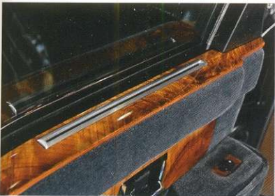
Система обдува боковых стекол теплым воздухом, проходящим через воздуховоды дверей. Кстати говоря, атермальные стекла на эти машины стали ставить ещё в семидесятые годы.
