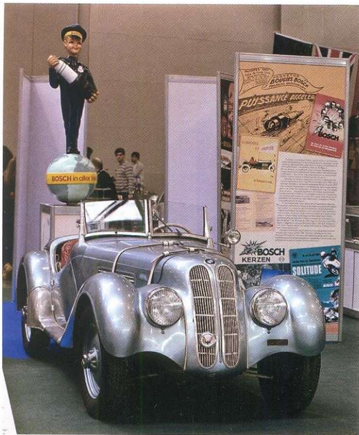
Под перехваченным ремнями капотом BMW-328 (1939 год - выпуска) спрятан шестцилиндровый мотор рабочим объемом 1971 см 3 и мощностью 80 л.с. Премьера этой модели состоялась на международной Берлинской выставке 1936 года.
