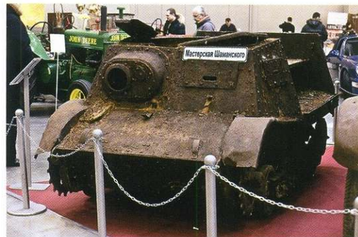
Судя по конструкции сцепного устройства, этот советский гусеничный тягач Т-20 «Комсомолец» эксплуатировался немецкими войсками (в финской армии эти машины использовались вплоть до середины 50-х годов).
