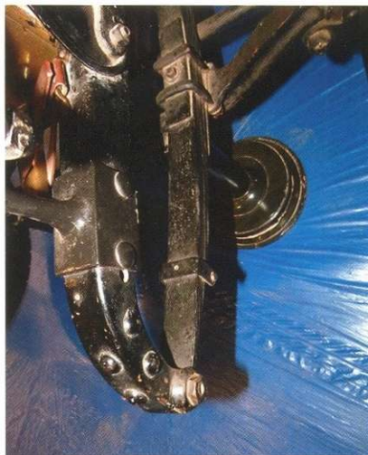
Передний конец рессоры крепился к загнутому вниз концу рамы, дополнительно проклепанному с усилителем для прочности.
