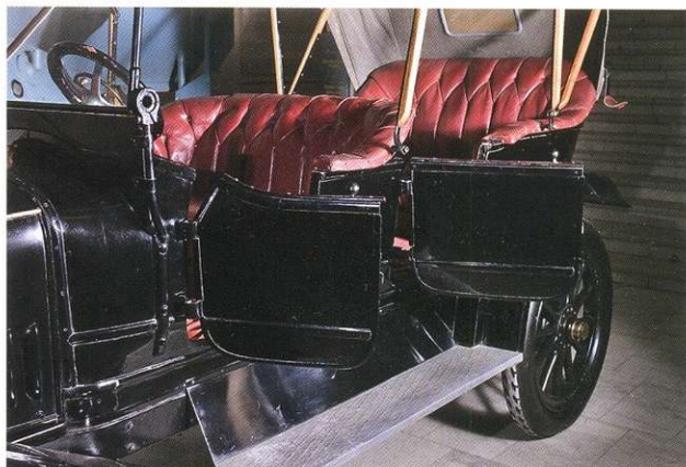
Водителю приходилось выходить слева – правый борт, за которым находились рычаги переключения передач и тормоза, был неоткрывающимся. А вот в распоряжении пассажиров заднего сиденья было две полноценные двери.
