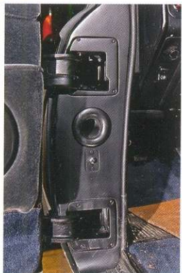
Система обдува боковых стекол теплым воздухом, проходящим через воздуховоды дверей. Кстати говоря, атермальные стекла на эти машины стали ставить ещё в семидесятые годы.
