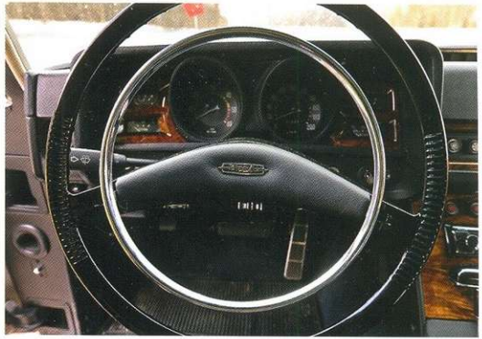
Приборы на ЗИЛе закрывались специальными безбликовыми стеклами особой формы (ночью они не отражаются в боковых стеклах, а днем не бликуют на солнце).
