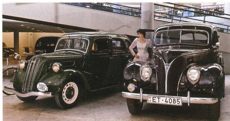
В предвоенные годы Латвия попыталась наладить автомобильную промышленность. В 1937–1940 годах завод Vairogs собирал легковые и грузовые Ford из машинокомплектов. В музее представлены модель малого класса 10 Junior de Luxe и представительский V8 de Luxe.
