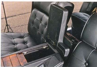
В этот бокс между передними сиденьями устанавливали оборудование спецсвязи.
