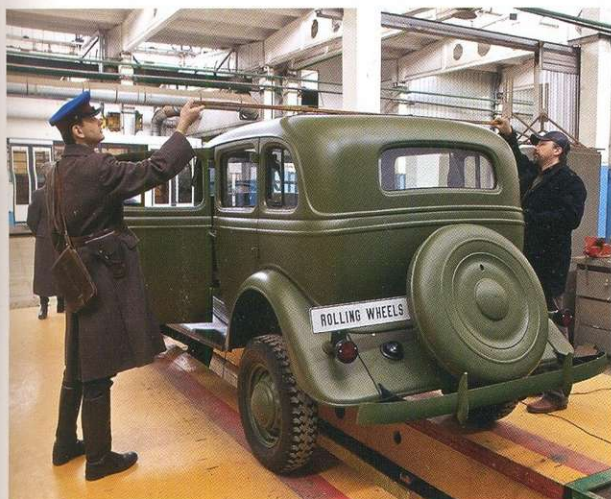
Высота кузова относительно ГАЗ-11-73 выросла ровно на 150 мм, что чётко соответствует разнице переноса мостов под рессоры из положения под ним.
