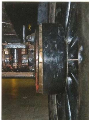
Барабанные тормоза устанавливались только на задние колёса и приводились в действие ручным рычагом. Эффективность их по современным меркам очень низкая. Кстати, обязательная установка тормозов на все колёса в Европе законодательно оформится почти через два десятилетия.
