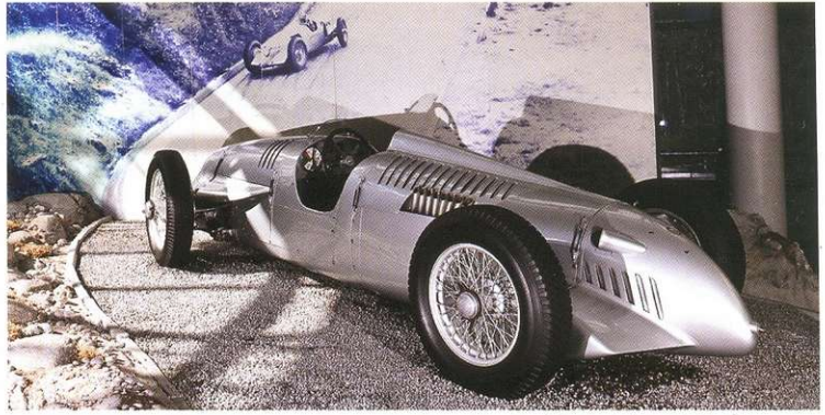
Гоночный Auto Union V16 Typ C/D 1938 года с 16-цилиндровым верхнеклапанным компрессорным двигателем конструкции Фердинанда Порше был создан для соревнований на горных трассах. При рабочем объёме 6 л силовой агрегат развивал 520 л.с., а масса машины составляла 800 кг.
