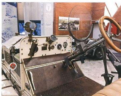
Специализировавшаяся на пожарных автомобилях American La France в 1915 году выпустила гоночный Speedster Racer. Главная особенность модели – ведущий мост смещён относительно задней оси, а передача крутящего момента на колёса происходит при помощи цепей.
