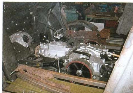
Реставрация началась ещё до того, как был решён кузовной вопрос. Это фото, сделанное в процессе восстановления, даёт редкий шанс увидеть трансмиссионный агрегат сверху.
