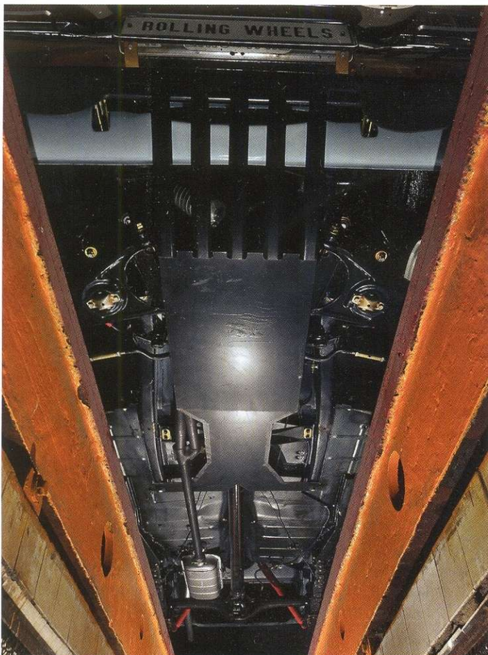
Задние лонжероны в зоне крепления рессор усилены. Обратите внимание: поддомкратники укреплены и защищены от повреждений специальными коробчатыми усилителями.
