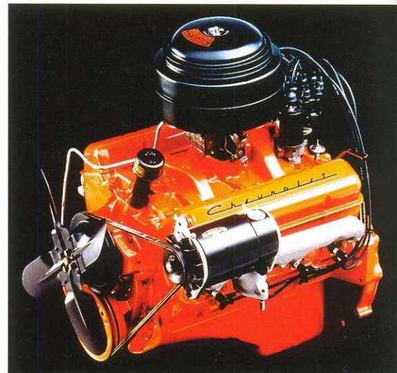
Этот двигатель – не просто банальный V8. На фото самый первый 265 Chevrolet Small Block конструкции Захария Дунтова (см. «Человек, который учил ездить Corvette», стр. 126). И именно с этого мотора началась целая эпоха, продолжающаяся по сей день.
