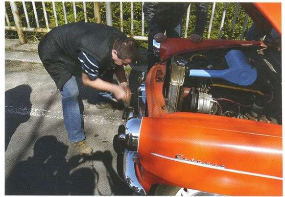
Категорический отказ одного из участвовавших в пробеге автомобилей заводиться дала мне возможность... изучить 1,1-литровый двигатель Octavia. Выпускаясь в двух вариантах (обычный 43 л.с. или Super – 1,2 л 47 л.с.), он обеспечивал 990-килограммовую машину сносной для своего времени динамикой и достаточной тяговитостью (73,5 или 85 Нм при 3000 об/мин).
