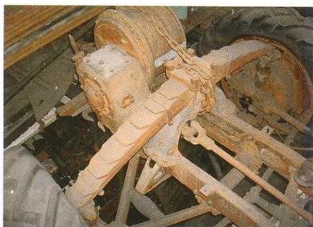
Шасси автомобиля сохранилось практически полностью. На фото: независимая задняя подвеска на поперечной рессоре. Обратите также внимание и на наличие понтонной механической лебедки.
