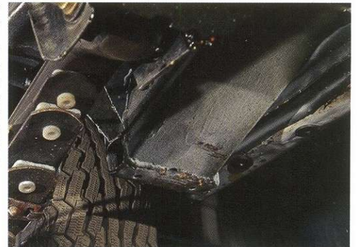
Задние лонжероны в зоне крепления рессор усилены. Обратите внимание: поддомкратники укреплены и защищены от повреждений специальными коробчатыми усилителями.
