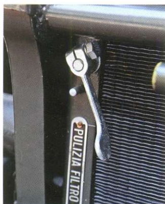
Ручка на рамке радиатора (фото вверху) связана тягами с масляным фильтром (фото внизу). Согласно инструкции, её надо поворачивать для очистки фильтрующего элемента перед каждым запуском двигателя.
