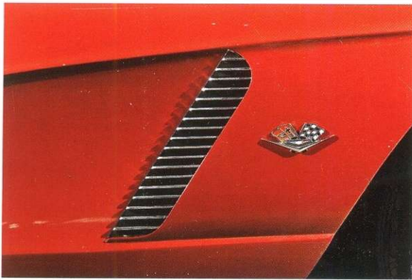
Признаком спортивных автомобилей традиционно были воздухозаборники и щели для выхода горячего воздуха. Но в нашем случае это чистая бутафория, обусловленная соответствующим стилем.
