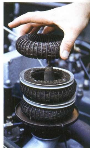
Фильтрующие элементы воздухоочистителя сделаны из конского волоса. Грязеемкость такого фильтра невелика, но зато его можно многократно промывать.
