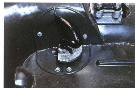
Трёхпозиционный переключатель лебёдки на полу возле водительского сиденья достаточно удобен, при этом он полностью исключает случайное включение агрегата.
