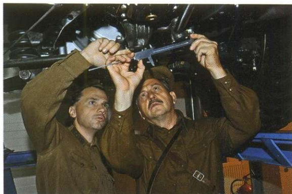
Замеры передних и задних рычагов рулевой системы показали, что различия в длине их плеч в конечном счёте взаимокompенсируются. А это значит, что колёса обеих осей всегда повёрнуты на одинаковый угол.
