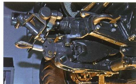
Изначально в задачу этой лебёдки входило затаскивание сцепки понтона непосредственно на буксирное устройство.
