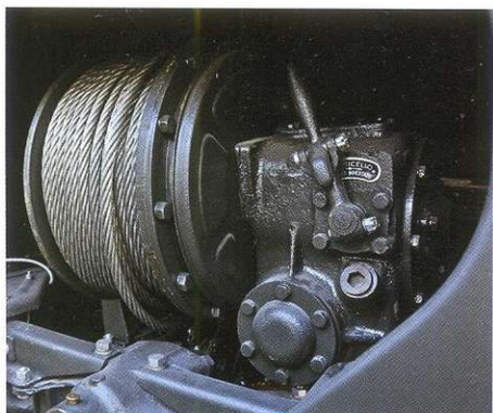
Тяга на крюке этого агрегата по паспорту достигает 3,5 тонны, а замеренная нами скорость смотки составляет 6 м/мин.
