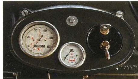
Приборная панель вполне функциональна: спидометр с указанием на шкале максимальной скорости для каждой передачи и встроенным одометром, масляный манометр, ключ зажигания и переключатель света. А вот указатель температуры охлаждающей жидкости отсутствует.
