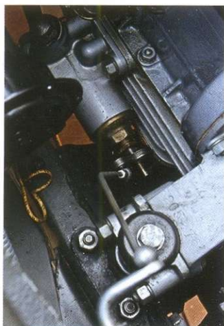
Ручка на рамке радиатора (фото вверху) связана тягами с масляным фильтром (фото внизу). Согласно инструкции, её надо поворачивать для очистки фильтрующего элемента перед каждым запуском двигателя.
