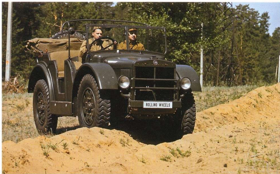
На SPA TL 37, предназначенные для войны в Северной Африке, устанавливались специальные шины увеличенной ширины и диаметра. Но для песков средней полосы России, как, впрочем, и для Апеннинского полуострова, вполне хватало стандартных колёс.
