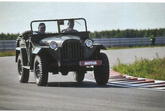
ГАЗ-67Б, привезённый энтузиастами из Санкт-Петербурга, отличается от аналогичных машин деревянным рулевым колесом, брезентовой обивкой сидений и покрывками с рисунком протектора граунд-грипп. Во время войны часть машин выходила с завода именно в такой комплектации.
