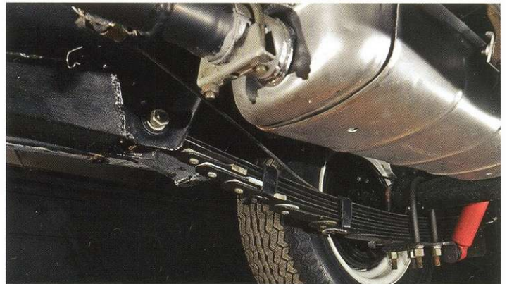
Задние лонжероны в зоне крепления рессор усилены. Обратите внимание: поддомкратники укреплены и защищены от повреждений специальными коробчатыми усилителями.
