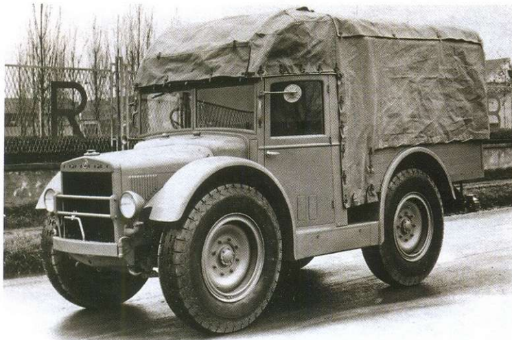
Autocarro Sahariano 37 в базовом исполнении. На машине установлены шины Pirelli Libia с одним из вариантов протектора.
