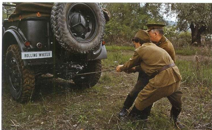
Сложный, но эффективный «тросоукладчик» превращает свободную размотку лебёдочного троса в тяжёлое физическое упражнение...
