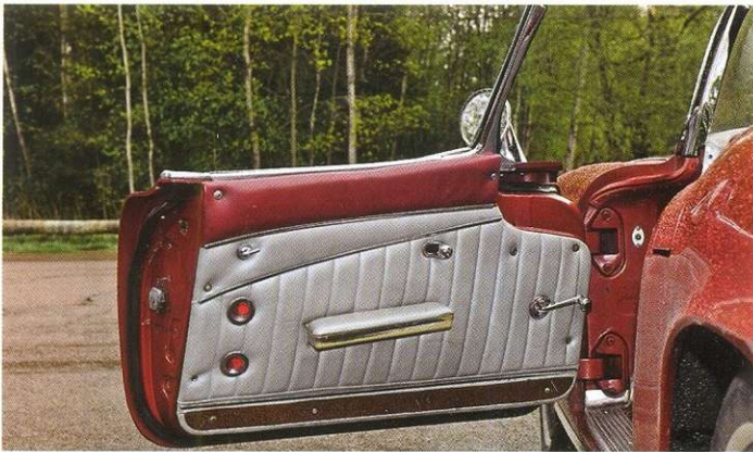
Вы удивитесь, но на самом первом Corvette стёкла вообще не опускались. А вот на модели 1962 года с этим был полный порядок. Два красных отражателя – это индикаторы открытой двери. В США они стали обязательными одновременно со сдвоенными фарами.
