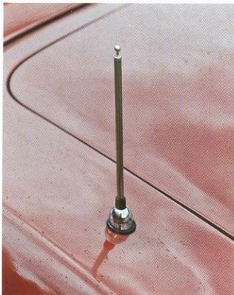
Эта антенна не вполне исторически верная деталь, но справедливости ради нужно отметить – радиоприёмник входил в стандартное оборудование всех Corvette. Выбор был разве что между «обычной» и «всеволновой» версиями.
