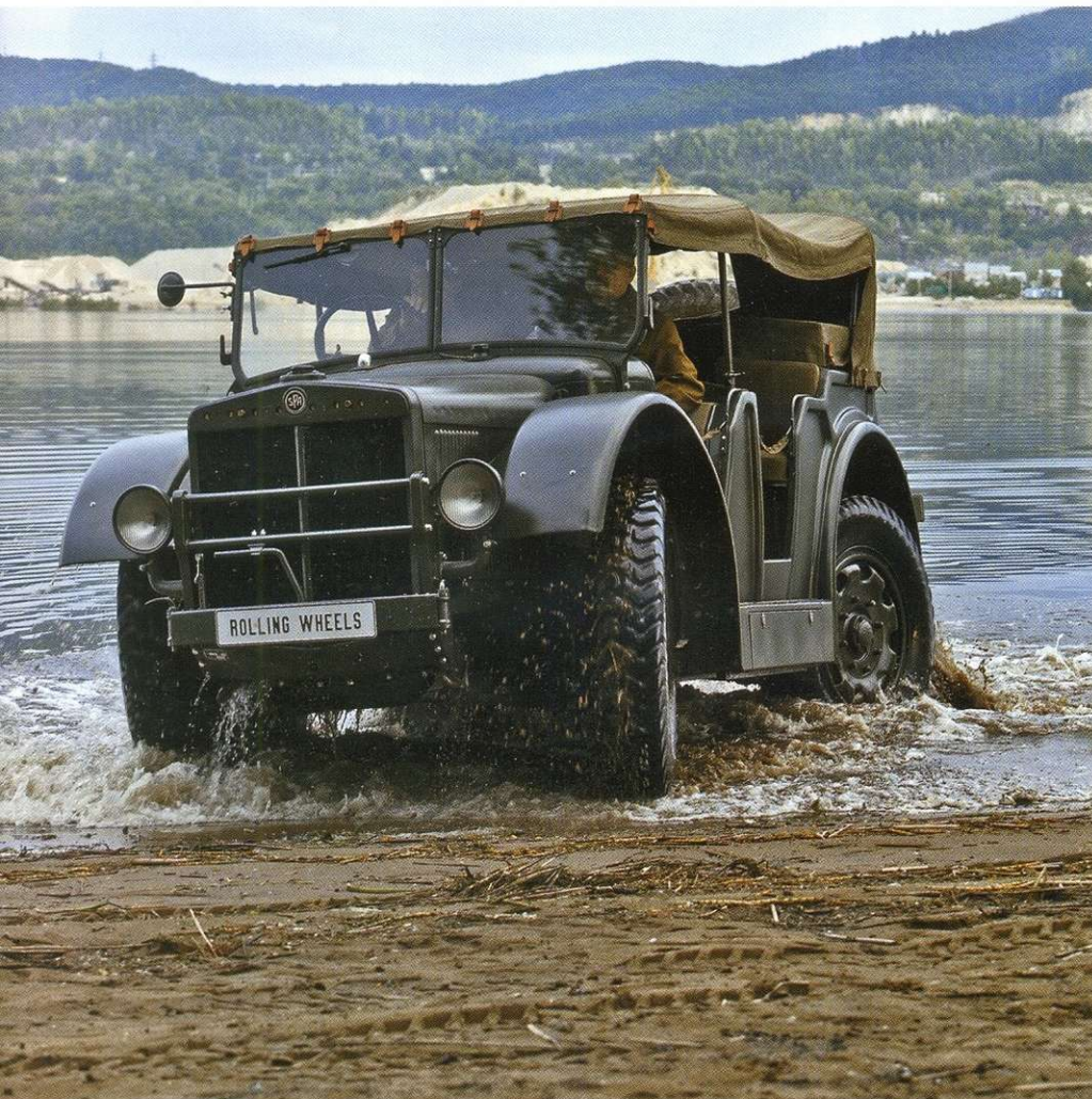
Несмотря на то что данная версия TL 37 предназначалась для обслуживания понтонных переправ, никаких специальных приспособлений для преодоления водных преград в нём нет. Впрочем, и без того, согласно паспортным данным, глубина преодолеваемого брода равна 70 сантиметрам.
