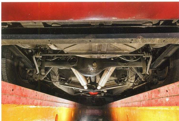
Поскольку кузов Corvette был выполнен из стеклопластика, требования к жёсткости его рамы многократно выросли. Отсюда и масса. Это во-первых. А во-вторых, на машину было установлено большое количество декоративных элементов из металла, весящих столько же, сколько кузов, если не больше.
