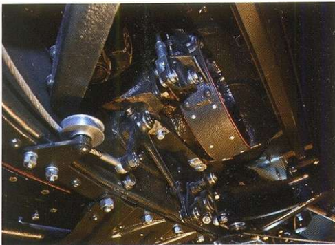
Распределение тормозных сил по осям и отдельно по колёсам обеспечивалось рычажным уравновешивающим механизмом, коромысла которого хорошо видны на фотографии. Но тем не менее механическая система тормозов требует трудоёмкой регулировки.
