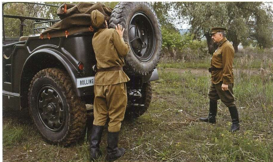
Чтобы снять запасное колесо, надо просто выдернуть фиксатор – и оно упадёт само. Причём вместе с кронштейном...
