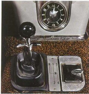
Аскетичный рычаг четырёхступенчатой КПП Borg Warner – признак более позднего вмешательства в конструкцию. Схема включения передач не соответствует «оригиналу» на табличке.
