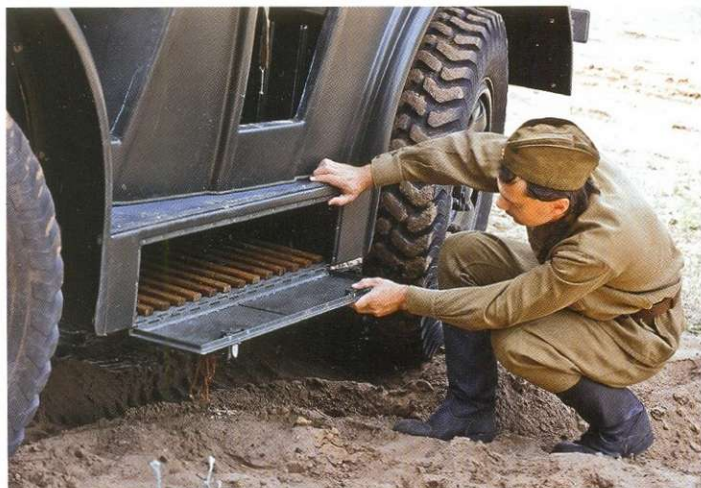
Эти скрытые в порогах ящики существенно ограничивают геометрическую проходимость автомобиля.
