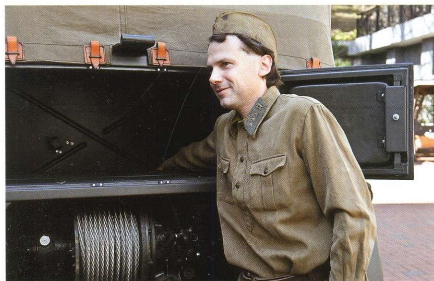
В задний багажник можно попасть, только когда запаска лежит на земле. Там довольно большая ниша, углубляющаяся в задней части. Но справедливости ради стоит заметить, что в артиллерийской версии этот «шкаф» примерно в два раза больше (лебёдка там меньшего размера) и служит для укладки боекомплекта.
