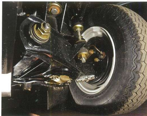
На этой фотографии хорошо виден дополнительный усилитель, соединяющий внутренние концы нижнего рычага и дополнительные швы, усиливающие балку передней подвески и крепление стабилизатора поперечной устойчивости. Так же было усилено крепление шаровой опоры.
