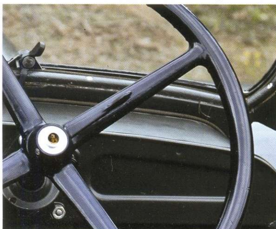
Хотя аккумулятора здесь нет в принципе, фары и звуковой сигнал «питаются» напрямую от 6-вольтового генератора. Система зажигания – от магнето. Рычажок на руле связан с ним системой тяг и позволяет принудительно корректировать угол опережения зажигания по ходу движения.
