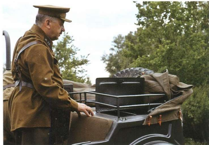
В кормовой части кузова TL 37 имеется ограниченная поручнями грузовая поверхность, а под ней «прячутся»... багажные ниши.
