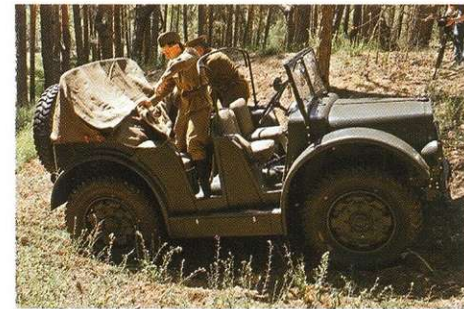
Технология снятия тента проста: отстёгиваем ремешки на рамке ветрового стекла, снимаем петли со специальных выступов средней стойки, аккуратно скатываем брезент и, отпустив фиксаторы, складываем заднюю стойку вместе с оставшимся на ней тентом. Установка: те же действия в обратном порядке.
