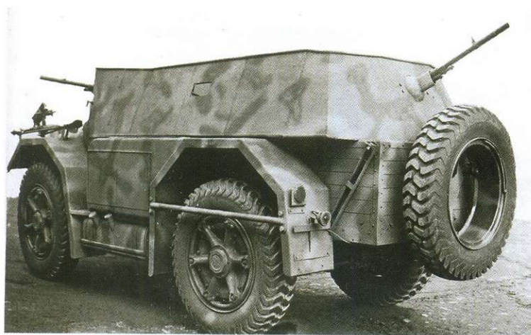
Бронетранспортёр, изготовленный на базе AS 43, для частей RSI. Бронирована только верхняя часть корпуса.
