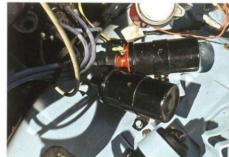
По той же причине под капотом можно увидеть и две катушки зажигания. Их низковольтную часть так же можно было переключить тумблером.
