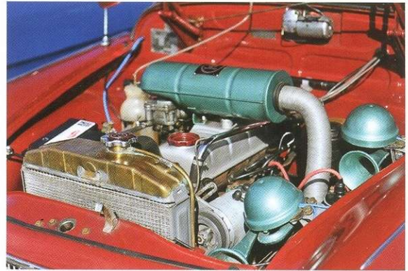
Категорический отказ одного из участвовавших в пробеге автомобилей заводиться дала мне возможность... изучить 1,1-литровый двигатель Octavia. Выпускаясь в двух вариантах (обычный 43 л.с. или Super – 1,2 л 47 л.с.), он обеспечивал 990-килограммовую машину сносной для своего времени динамикой и достаточной тяговитостью (73,5 или 85 Нм при 3000 об/мин).
