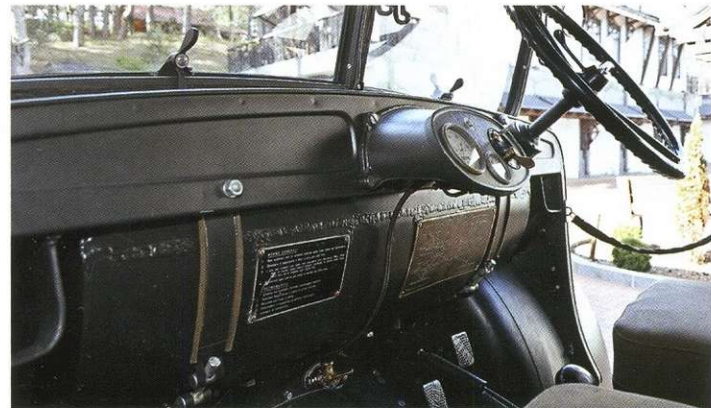
Передняя панель более чем лаконична, причём нижнюю её часть образует бензобак, внизу которого виден топливный кран, обслуживающий основную часть его объёма.
