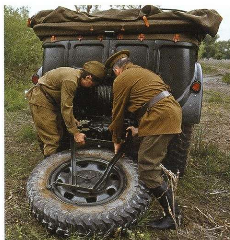
... А вот чтобы вернуть его на место, надо сначала приладить кронштейн на открытые петли, а затем закинуть (желательно вдвоём) его вместе с запаской вверх.
