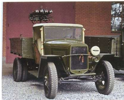
Отсутствие зенитных самоходных установок специальной постройки заставляло импровизировать. Такие четверённые установки пулемётов «Максим» на шасси ГАЗ ММ (1942 год) были частым явлением в первые годы войны.
