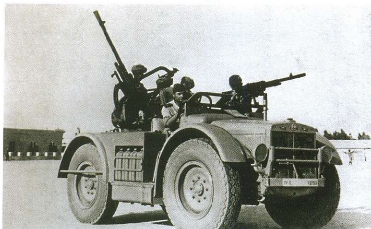
AS 37 modificado со штатным набором вооружения. Вместо зенитной пушки в кузове иногда устанавливали 47-мм противотанковую пушку.
