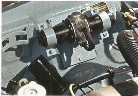
На спортивной машине дополнительно был установлен электробензонасос Bosch. Но на реплике он пока что не подключен к системе.
