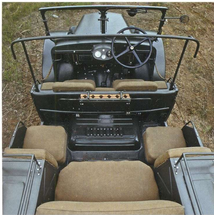
Компоновка салона кажется странной, но она вполне разумна с учётом перевозки шести человек с оружием и амуницией. Перед сидящими посередине сиди — стойка для личного оружия всего экипажа. Что же до правого расположения руля, то оно было характерно для всей итальянской военной техники тех времён. Считалось, что важнее видеть край пропасти, чем встречную машину.
