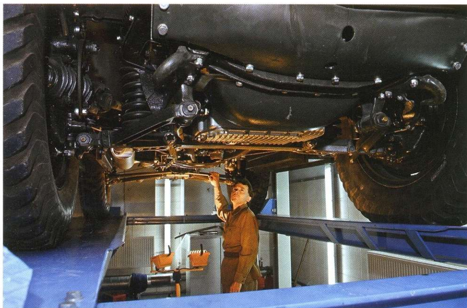
Передняя подвеска на двойных поперечных рычагах – конструкция скорее характерная для гоночных формул. И вот ещё неожиданная деталь – вместо амортизаторов подвеска итальянского тягача оборудована телескопическими ограничителями хода, установленными внутри пружин.
