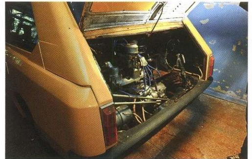
Конструкторы намеренно отказались от классической компоновки и расположили двигатель сзади, что давало возможность сделать пол салона абсолютно плоским.
