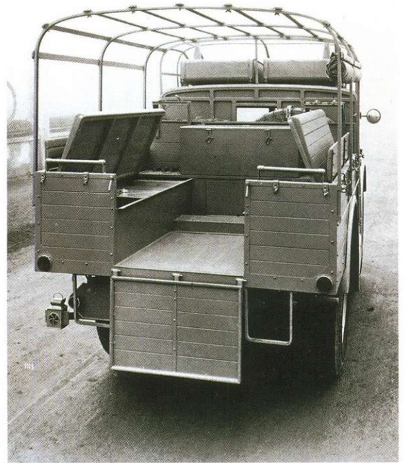
AS 37 в варианте артиллерийского тягача (1942 год). Чтобы освободить место для укладок, топливные баки были перенесены из кузова на крышу кабины.
