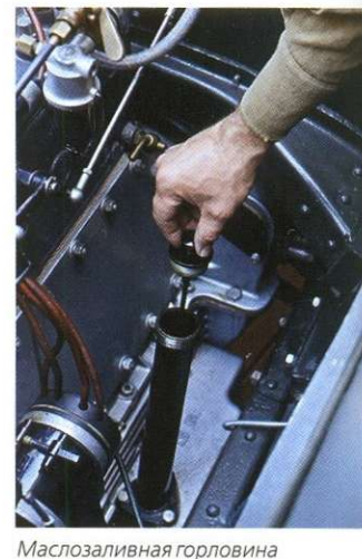
Маслозаливная горловина герметична. Она завинчивается крышкой, а под ней – притёртая пробка с масляным щупом.
