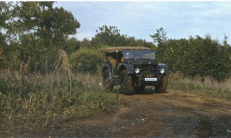
В движении по дуге независимо от покрытия под колёсами создаётся обманчивое ощущение заноса. Так с непривычки воспринимается поворот колёс задней оси.
