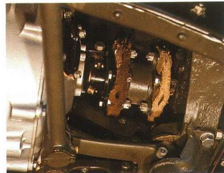
Двигатель со сцеплением и коробка передач связаны между собой коротким валом с двумя упругими резиноканевыми шарнирами. Что допускает некоторую степень несоосности их расположения, возникающую при монтаже, а также компенсирует небольшое продольное смещение агрегатов, неизбежное при движении.
