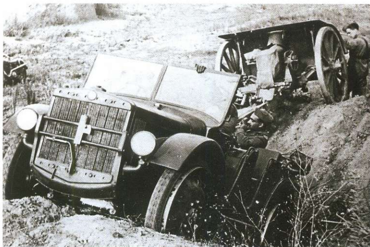
Испытания SPA TLa (1937 год). Обратите внимание: при движении по сильно пересечённой местности машина буксирует 100-мм полевую гаубицу образца 1914 года.
