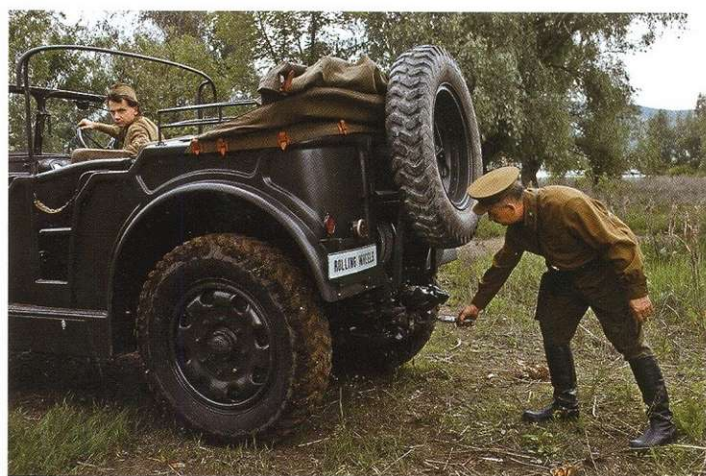
...Поэтому эффективнее и быстрее делать это вдвоём, но в принудительном режиме. Водитель включает размотку из салона, а второй участник процесса просто вытягивает подаваемый трос.
