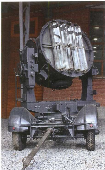
Эта немецкая прицепная прожекторная установка 150 см SWF37 1939 года позволяла зенитчикам обеспечивать противовоздушную оборону в ночное время. Аналогичные прожекторы использовались и для контроля за охраняемыми объектами и наблюдения за акваториями.
