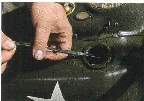
Отдельный маслбак для двигателя – это так удобно. Проверить уровень – дело 10 секунд и даже не нужно «нырять в недра мотора».
