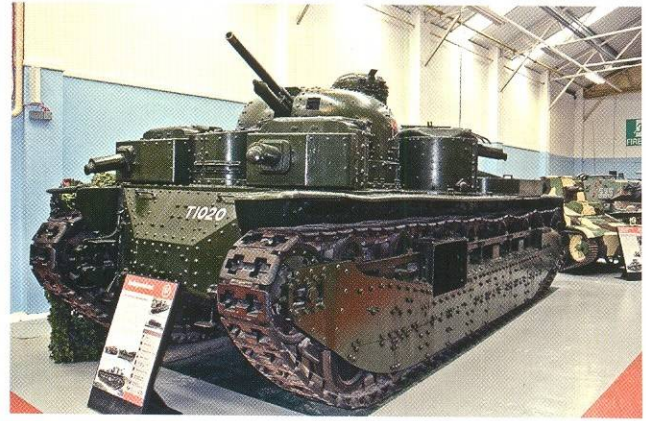
Vickers A1E1 Independent 1926 года – первый в мире многобашенный танк. Правда, в серию эта машина не пошла, но при этом она стала отправной точкой для создания советского Т-35.
