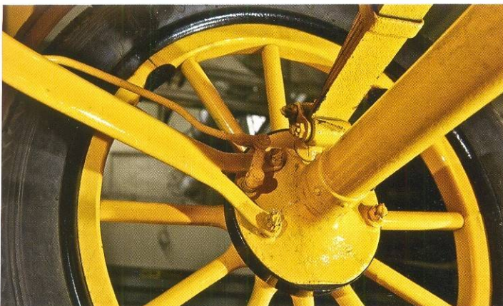
Для увеличения жесткости направляющего аппарата подвески трубчатая реактивная тяга задней оси на конце расплющена, раздвоена и закреплена на фланце моста в двух точках. А между ними изящно встроен привод колодок барабанного стояночного тормоза.
