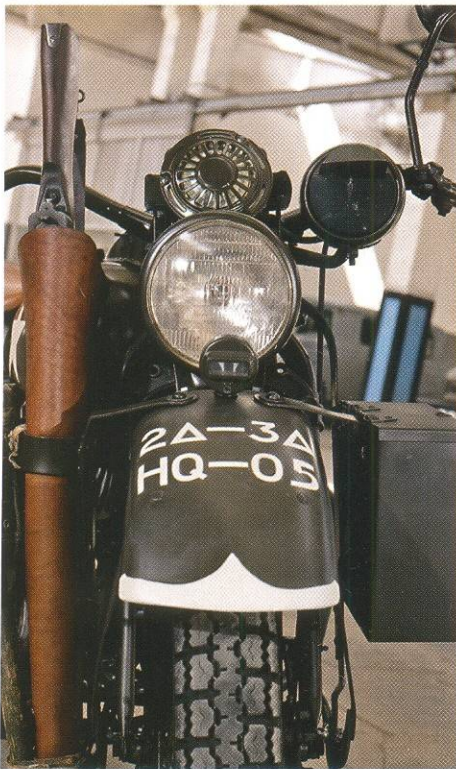
Габаритные и маскировочные огни на данном экземпляре выполнены по американскому стандарту – щелевая рассеивающая фара и «маркер» с очень слабой лампочкой. На канадско-европейские версии (их чаще маркировали WLC) шла оптика «британского» стандарта и выглядела она совсем по-другому.
