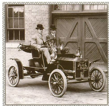
За рулём этого Ford Model N сидит конструктор Йозеф Галемб (1881–1955 гг.), рядом с ним Генри Форд (1863–1947 гг.). Обратите внимание: рулевая колонка находится справа. Но у Model T она будет стоять уже слева, и благодаря своей массовости эта машина внесёт единообразие и в вопрос расположения руля.
