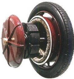
Это была сенсация Всемирной выставки в Париже 1900 года и изобретение, «кормившее» Фердинанда Порше всю его жизнь, – электромотор, встроенный в ступицу колеса.
