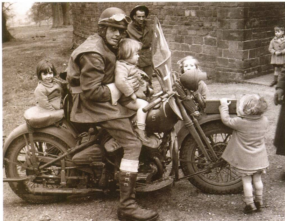
Harley-Davidson WLC. Второе седло, козырёк на фаре, бугель-подставка для переднего колеса и рычаг сцепления справа на руле – налицо все признаки канадской версии.
