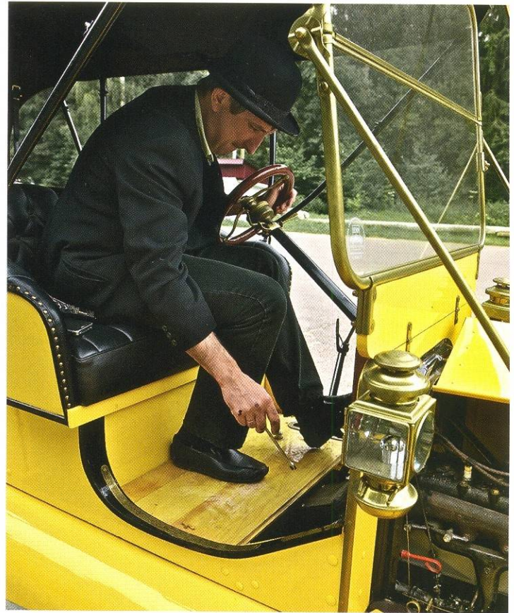
Тормозные ленты и фрикционы, управляющие планетарным механизмом переключения передач подвержены износу в процессе эксплуатации, а потому требуют периодической регулировки. Именно с этого и начался наш полигонный тест автомобиля, выпущенного в 1910 году.
