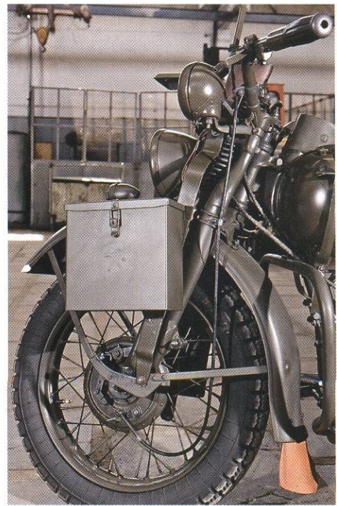
Обратите внимание на конструкцию рычажной подвески переднего колеса. Впрочем, несмотря на сложность, подобное техническое решение показало себя как вполне надёжное.
