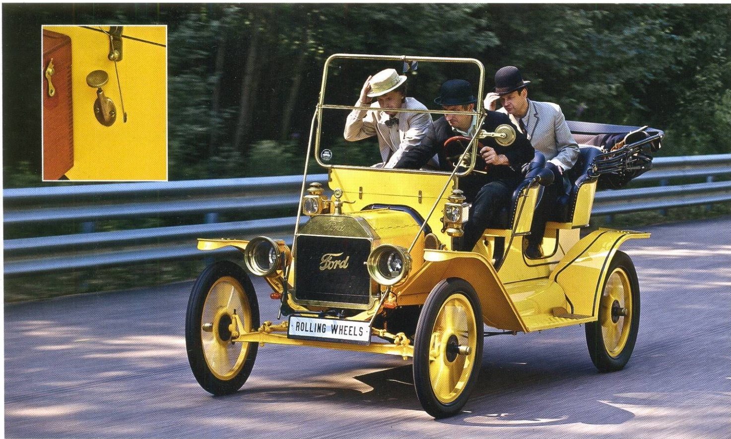
Развить максимальную скорость на Ford Model T непросто. Последние «километры в час» набираются очень медленно, а для продолжения разгона необходимо точно дозировать качество рабочей смеси. Что делается прямо из салона поворотом латунной ручки на правой части моторного щита.
