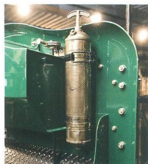
Этот привлекательный золотистый баллон на самом деле... штатный бортовой огнетушитель.
