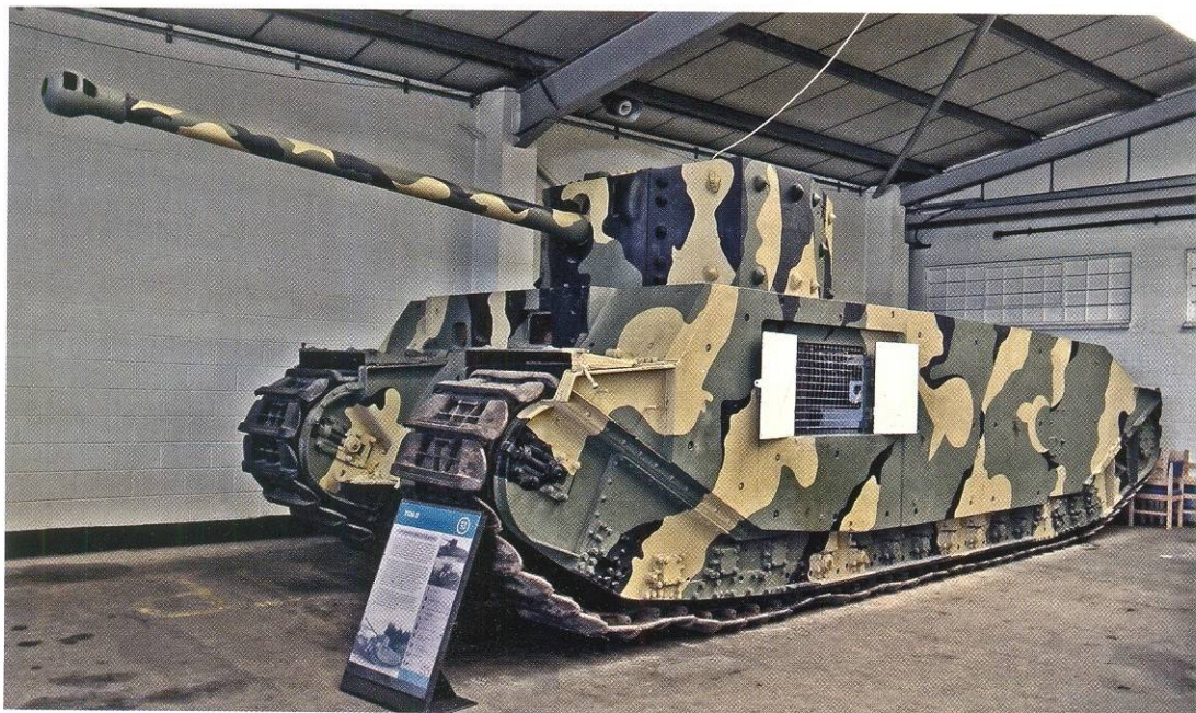
TOG II – самый большой и неудачный английский танк Второй мировой войны. 80-тонная машина обладала относительно тонкой для своего класса броней и разгонялась до... 13 км/ч.
