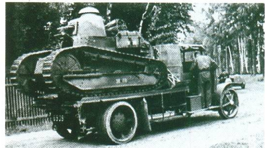
Грузовик изначально был создан для перевозки танков Renault FT-17, с которыми был унифицирован по двигателю и коробке передач. Но вскоре у грузовика нашлось множество вариантов гражданского применения с различными кузовами...
