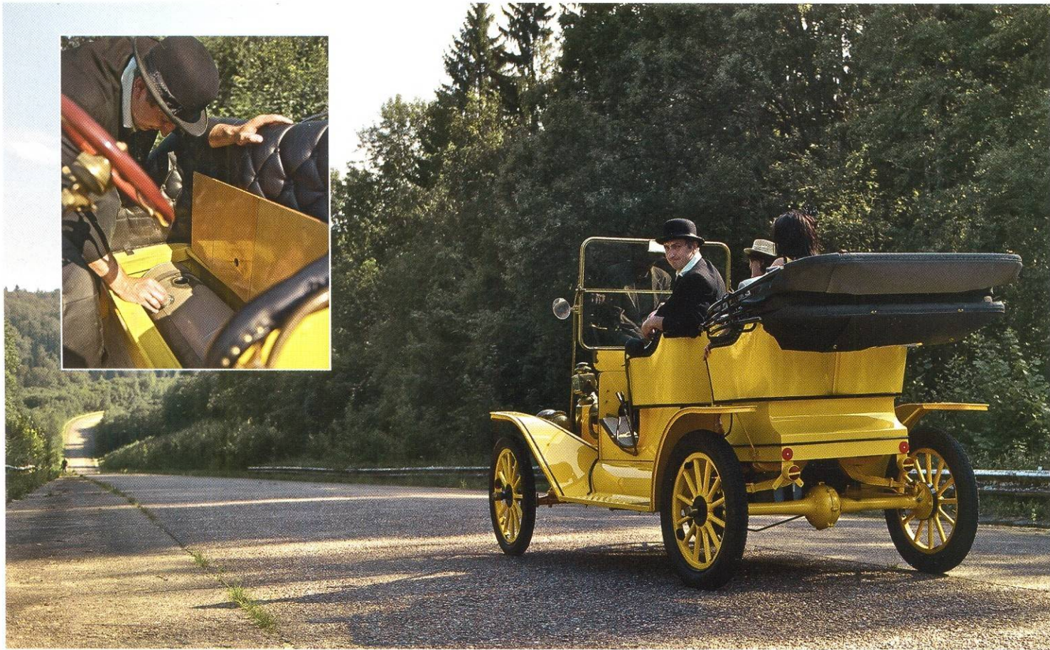
Топливо подходит к концу? Значит, в гору... задним ходом! Из-за низко расположенного бака (фото в верхнем углу) и подачи бензина самотёком способность преодолевать подъёмы традиционным образом в этом случае существенно ограничена.
