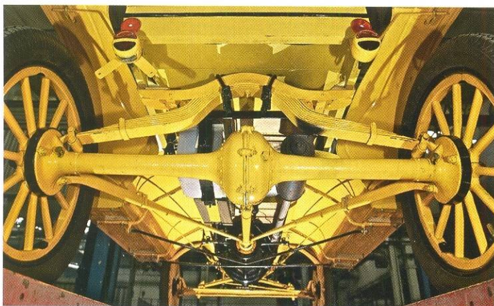
Как видите, подвеска очень проста. Как спереди, так и сзади в качестве упругого элемента мостов использованы перевернутые полуэллиптические рессоры. При этом более сложный изгиб рессоры заднего моста (фото вверху) нужен, чтобы обеспечить пространство для картера дифференциала при ходе сжатия. Противостоять повороту и боковому смещению мостам помогают реактивные тяги, образующие два (передний и задний) жестких треугольника. Причём передний шарнирно закреплён на картере двигателя, а задний – на карданном шарнире трансмиссионного вала. Таким образом силовой агрегат одновременно является силовым... элементом несущей системы!
