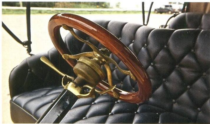
Планетарный механизм в ступице рулевого колеса, собственно, и есть весь рулевой редуктор. Не верите? На нижнем снимке видно, что на другом конце вала нет ничего, кроме сошки.
