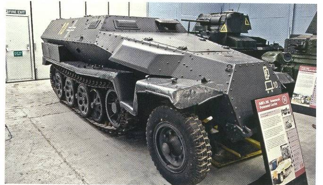
Полугусеничный БТР Sd.kfz. 251/1 Ausf.C 1941 года. Машина имеет клéпанный корпус, а это указывает на то, что она выпущена в Австрии.
