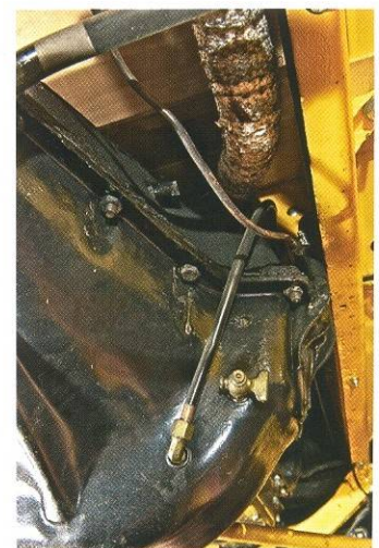
Для контроля уровня масла в картере маховика было предусмотрено два краника: при их открытии из нижнего должно было течь, а из верхнего нет. Щуп появился позднее.
