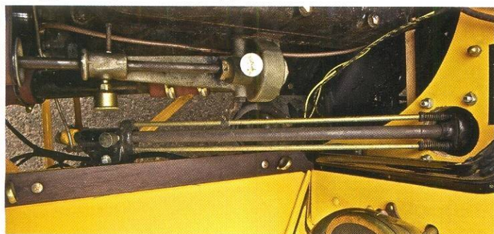
Планетарный механизм в ступице рулевого колеса, собственно, и есть весь рулевой редуктор. Не верите? На нижнем снимке видно, что на другом конце вала нет ничего, кроме сошки.
