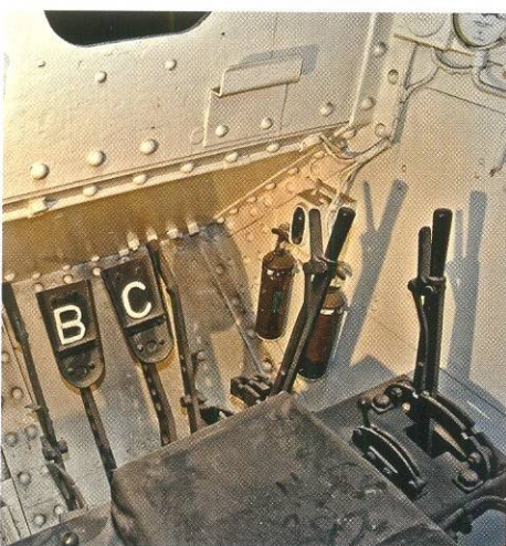
Место механика-водителя английского танка Mark V 1918 года. Кстати, для управления танком в корме находились ещё два помощника, каждый из которых управлял своим бортовым фрикционом.
