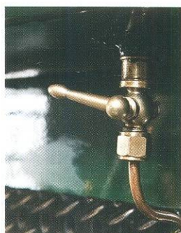
Кран подачи топлива. Из бака, размещённого на моторном щите, оно поступает самотёком.
