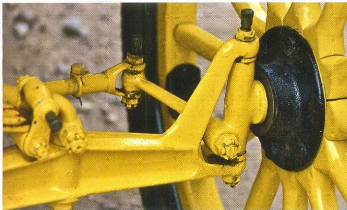
Поворотный узел передней оси с цельным шкворнем устроен элементарно. Обратите внимание на то, что все шарниры открытые. Несмотря на то что они снабжены тавотницами, даже оригинальная инструкция утверждает, что изнашивание и люфт в этих местах неизбежны.
