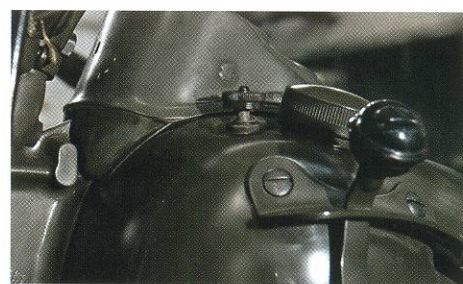
Слева на баке расположен топливный кран с положением резерва топлива. При переключении уровня забора на минимум он «выпрыгивает» из гнезда и начинает «мозолить глаза». В общем, про дозаправку не забудешь.
