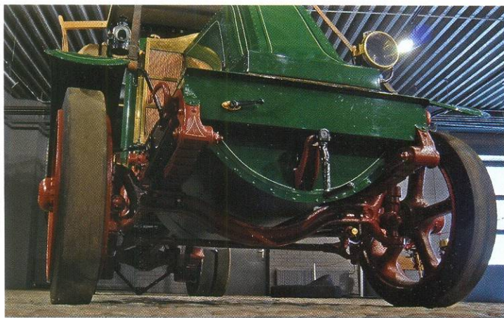
Двигатель запускается только вручную. (У танка, кстати, тоже.) Единственная электрическая система – это зажигание от высоковольтного магнето с возможностью ручной регулировки опережения во время движения.
