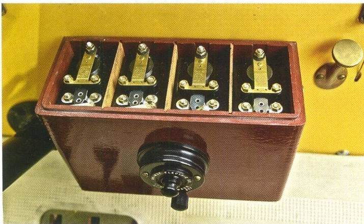
В этом деревянном ящике на моторном щите со стороны солона находятся катушки зажигания. По одной на каждую из четырёх свеч.
