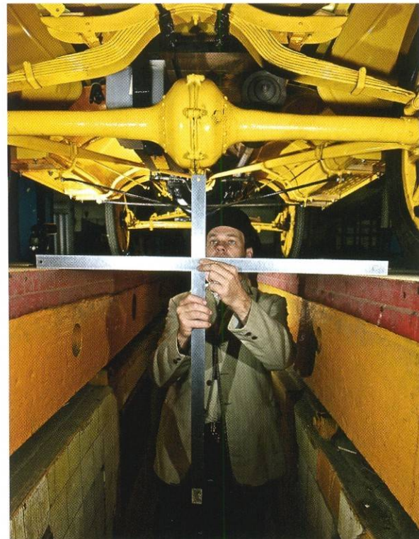
...И знаете, это абсолютно справедливо. Измеренный нами дорожный просвет оказался куда больше, чем у многих современных внедорожников – 262 мм под редуктором заднего моста!
