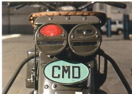
Задние габаритные огни достались HD WLA от грузовиков (между прочим, вместе с самими фонарями). На правом плафоне можно увидеть «зубчики» индикатора сближения в колонне.
