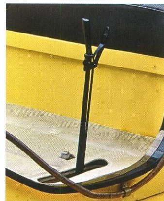
Этот рычаг отвечает за включение прямой передачи (если его перевести вперёд) и за стояночный тормоз (если его оттянуть назад). Кстати, на машинах выпуска 1908 и начала 1909 года рычагов было два – второй отвечал за включение задней передачи, но затем реверс перенесли в педальный узел.
