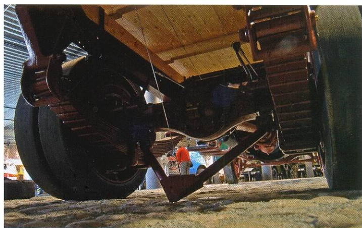
Горный противооткатный упор связан тросом с ручкой, расположенной под ногами водителя, позволяющей быстро опустить его в случае необходимости.
