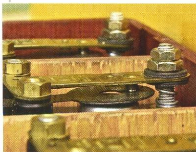
Каждая катушка снабжена своим прерывателем, представляющим собой контактную пластину, попеременно размыкающую и замыкающую первичную обмотку.
