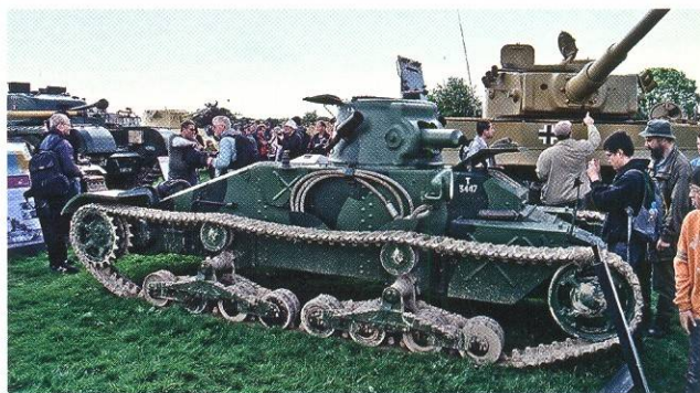
Английский пехотный танк Infantry Tank Mk. I 1939 года часто ошибочно называют Matilda I. Мощная броня этого танка сочетается с несуразным для такого класса защитой вооружением, состоящего из одного пулемёта.
