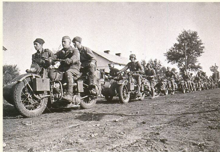
Мотоциклетный полк на марше: бойцы Красной армии на мотоциклах Harley-Davidson WLA с колясками М-72. На колясках часто ставили ручные пулемёты на специальной опоре. Лето 1944 года.
