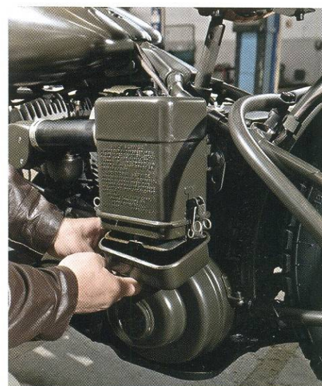
Проверить уровень масла в воздушном фильтре достаточно просто. Надо отнять две защёлки и... не опрокинуть на себя прямоугольный поддон (на ранних версиях WLA он был овальный).
