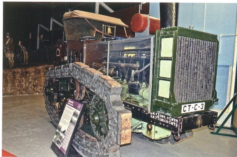
Гусеничный трактор Hornsby 1909 года. Собственно, подобные машины и стали прообразами ходовой части первых танков.
