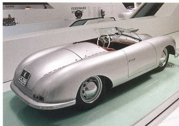
Первым автомобилем марки Porsche по праву считается родстер Typ 356. Выпущен 8 июня 1948 года. Мотор от Volkswagen форсирован до 35 л.с. и установлен в базе.
