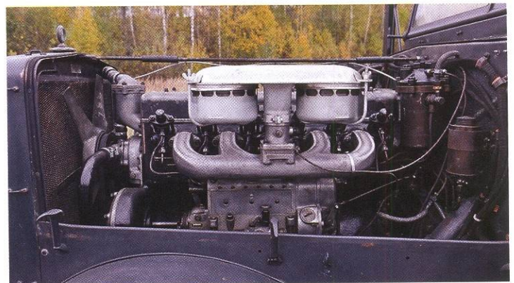
Всё, что требует частого доступа для обслуживания и регулировок, расположено слева, что очень удобно (помните про капот?). Здесь вся топливная аппаратура, все фильтры, расширительный бачок тормозной гидравлики и т.д.
