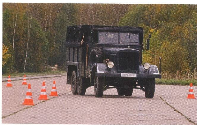
Боковые силы, действующие на автомобиль, видны только по «подламывающемуся» переднему колесу. Крен кузова – максимальный, какого мы добились при скоростном прохождении «переставки».
