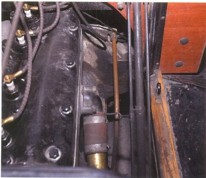
Медная трубка (в центре кадра) устанавливалась дополнительно для улучшения циркуляции масла в картере двигателя на подъёмах.
