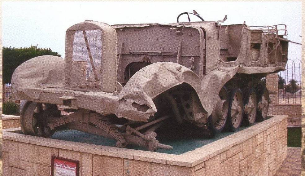
Немецкий 8-тонный полугусеничный тягач Sd.Kfz. 7. Подобные машины были штатными тягачами 88-мм зенитных пушек Flak 18.
