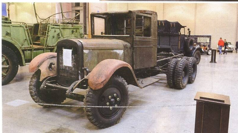
Грузовой автомобиль ЗИС-6 (СССР). В начале 30-х годов в НАТИ был разработан трехосный вариант грузовика АМО-3, получивший индекс АМО-3-НАТИ. Переработанная версия машины в 1934 году пошла в серийное производство под индексом ЗИС-6.
