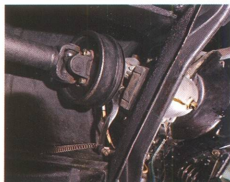
3-ступенчатая КПП имеет привод включения на двух внешних рычагах (на верхнем фото), а сразу за хвостовиком КПП прямо на ее корпусе находится барабан ручного тормоза.
