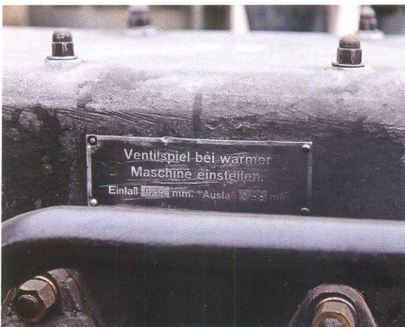
...Табличка с другой стороны напоминает величину зазоров в клапанах и то, что проверять их надо на прогревом двигателе.
