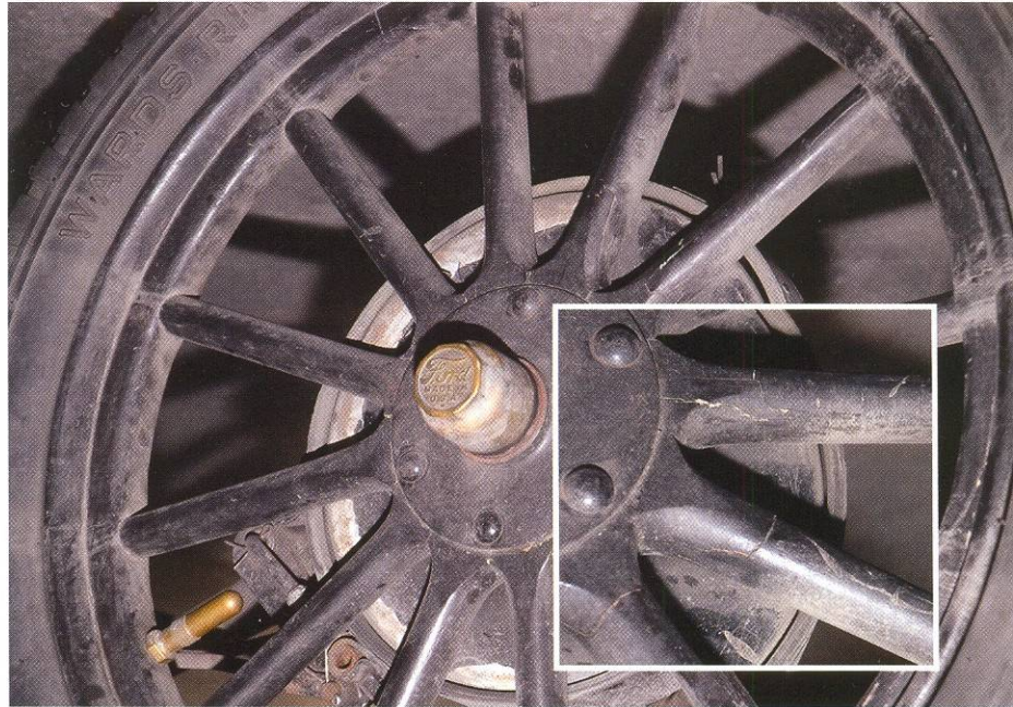
Адская смесь жары и чудовищных дорог начала разрушать деревянные колёсные спицы.
