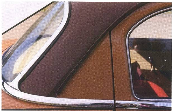
Оконный хром на различных выпусках «Волги» отличался порой кардинально. Здесь временно установлен «экспортный хром» от ГАЗ-21УС.
