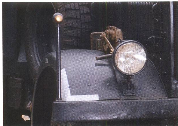
Передние габаритные огни подняты на штангах не ради красоты. Их корпуса помогают водителю видеть внешние углы автомобиля при маневрировании.
