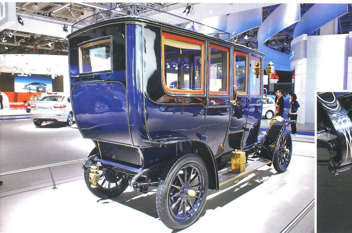
На элегантном кузове Renault type XV от компании Belvalette отсутствовали стоп-сигналы, однако керосиновые фонари, в том числе и задний, фирмы Auteroche, обозначали габариты.
