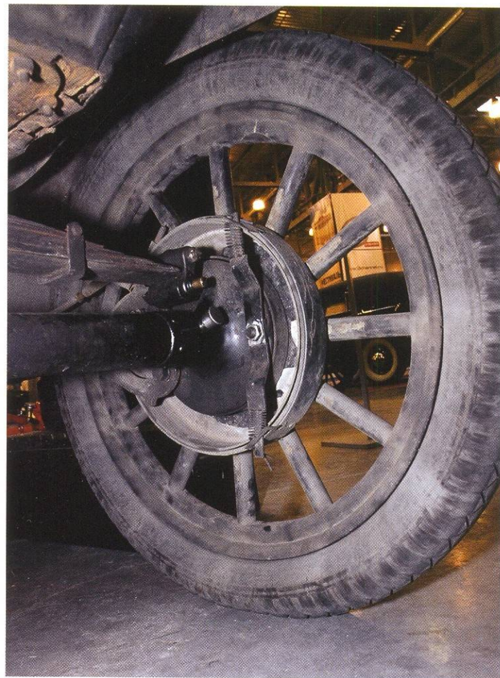
Дополнительные ленточные тормоза на задних колёсах я бы порекомендовал всем владельцам Model T.
