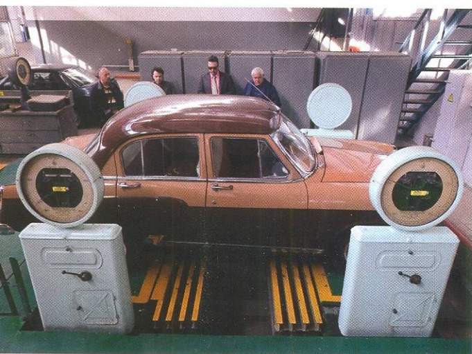
Взвешивание в метрологической лаборатории дало интересные результаты. Во-первых, данный экземпляр обладает практически паспортной массой (что после реставрации случается нечасто), а во-вторых, развесовка «Волги» имеет ровно 10% дифферента на переднюю ось.
