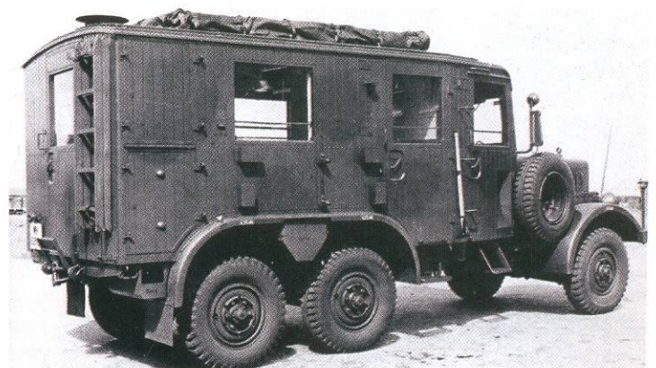
Кузов модификации Kfz.61 Funkkraftwagen, предназначенной для установки радиостанции, был выполнен из дерева.
