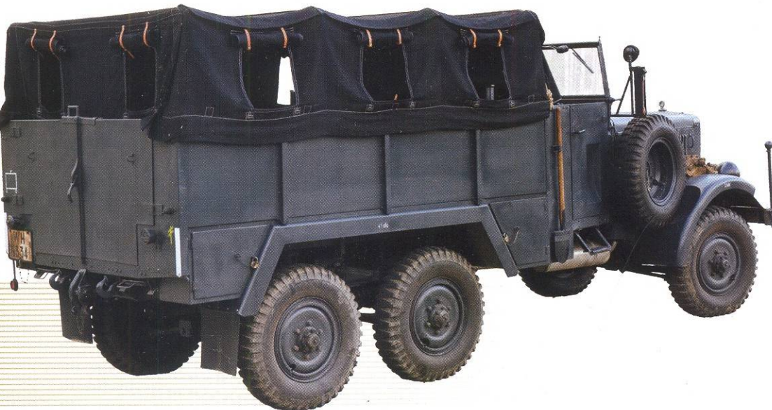
Металлический кузов с тентом — наиболее частая универсальная модификация «единого дизеля». Доступ внутрь — через распашные дверцы заднего борта, оснащённые довольно сложным и хитрым замком. При этом чтобы облегчить и ускорить посадку личного состава, с каждого края из-под пола можно выдвинуть и опустить скобу-ступеньку. Все рундуки для снаряжения в нижних углах кузова запираются (кроме заднего левого). Штатные места для канистры и шанцевого инструмента по бокам кабины очень удачны. Запасное колесо удобно менять, но оно усложняет доступ в моторный отсек и снижает технологичность производства правой двери.
