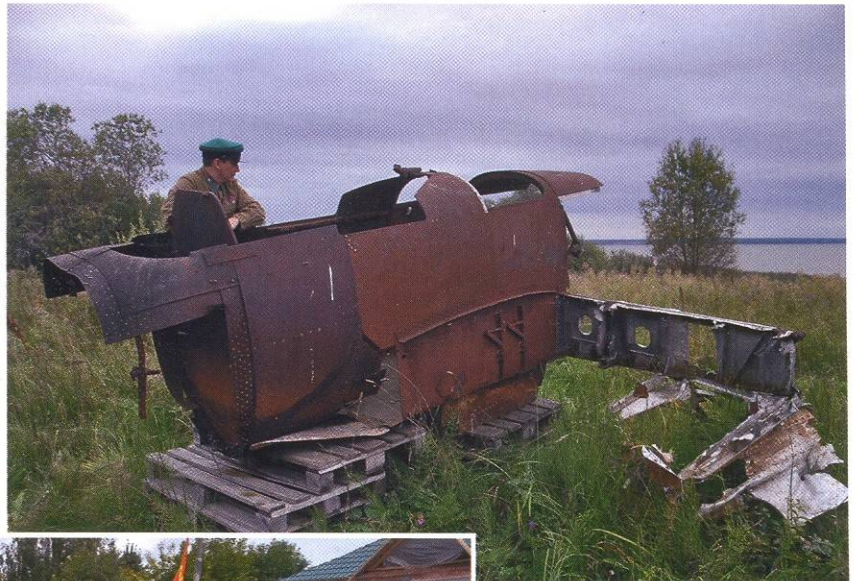
Бронированная кабина одноместного штурмовика Ил-2, совершившего вынужденную посадку 70 лет назад.
