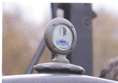
Термометр в пробке радиатора – открытый архаизм. К тому времени уже стали получать распространение электрические датчики температуры.
