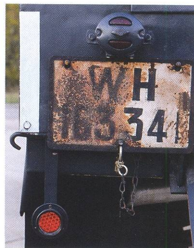
Типовой задний фонарь для немецких военных автомобилей объединяет стоп-сигнал (сверху) и габаритный свет (снизу). Крутилка посередине переключает в светомаскировочный режим, при котором стекло изнутри загораживает шторка с маленьким отверстием.
