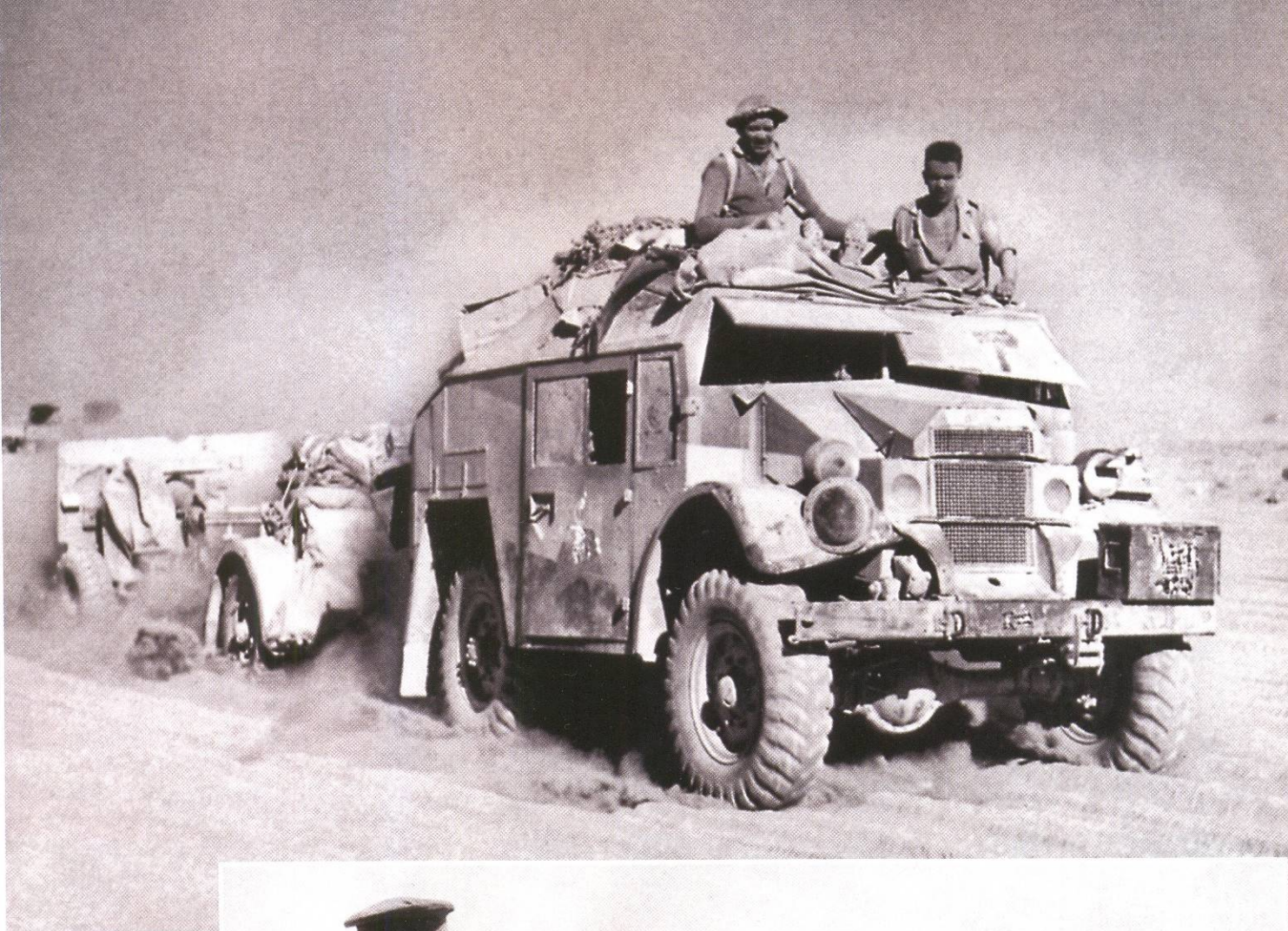
С конца 1941 года в английской армии стали массово применяться военные грузовики канадского производства. Например, представленный на фотографии Chevrolet CGT Cab 12, штатный тягач 25-фунтовой (88-мм) пушки-гаубицы.
