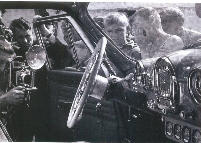
Приборная панель прототипа «Волги» отличалась богатством хромированных «инструментов», но ещё не обзавелась знаменитой прозрачной полусферой спидометра.
