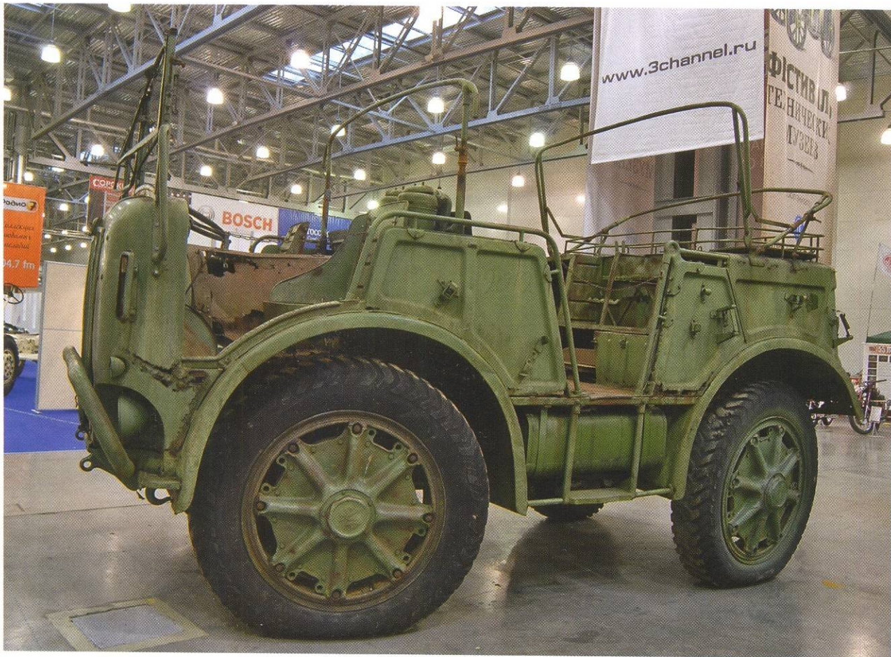
Артиллерийский тягач FIAT-SPA TM40 (Италия). Его основной задачей была буксировка 149-мм гаубиц и 75-мм зенитных пушек. Первые TM40 поступили в войска в 1942 году. Всего до конца 1944 года было построено 398 тягачей этого типа, из них 153 для немецких подразделений в Италии.
