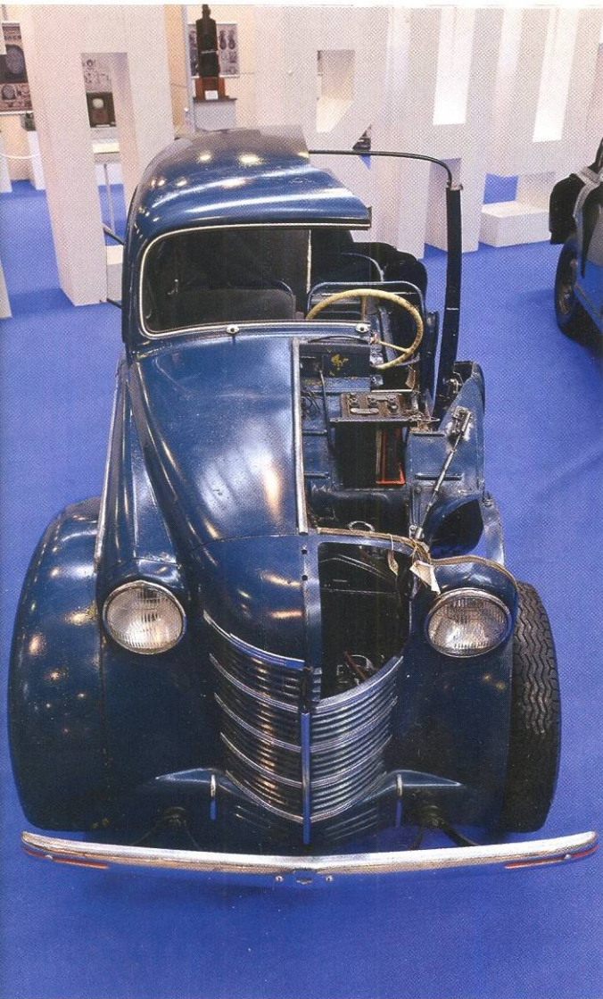
Демонстрационная модель «Москвич-401» (1954–1955). В 1946 году была изготовлена первая партия «Москвич-400-420», а в 1954-м была разработана более мощная модель двигателя – 401, что привело к изменению обозначения автомобиля.
