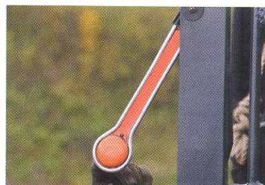
Механические указатели поворота с электроприводом – стандартное оснащение немецких автомобилей 30-х годов XX века.
