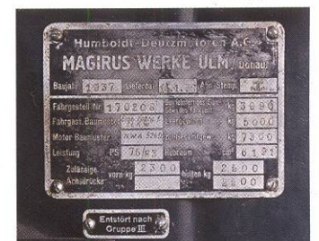
Происхождение каждого отдельного экземпляра Einheitsdiesel можно определить только по номеру шасси на раме и табличкам в кабине.
