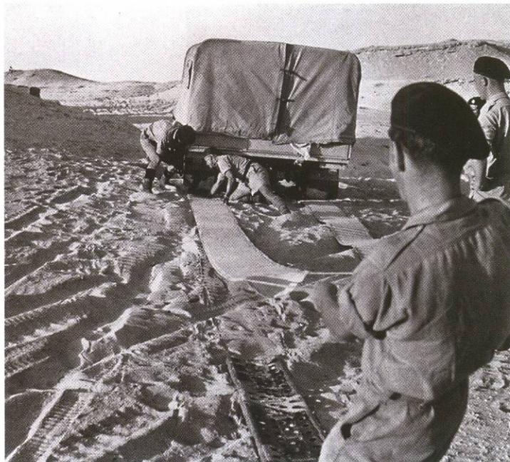
Попытка выволить из зыбучего песка грузовик 7-й бронетанковой дивизии: солдаты с успехом используют текстильные сэндтраки, предусмотренные на этот случай. Но потребовался и железный трап, который виден на первом плане.
