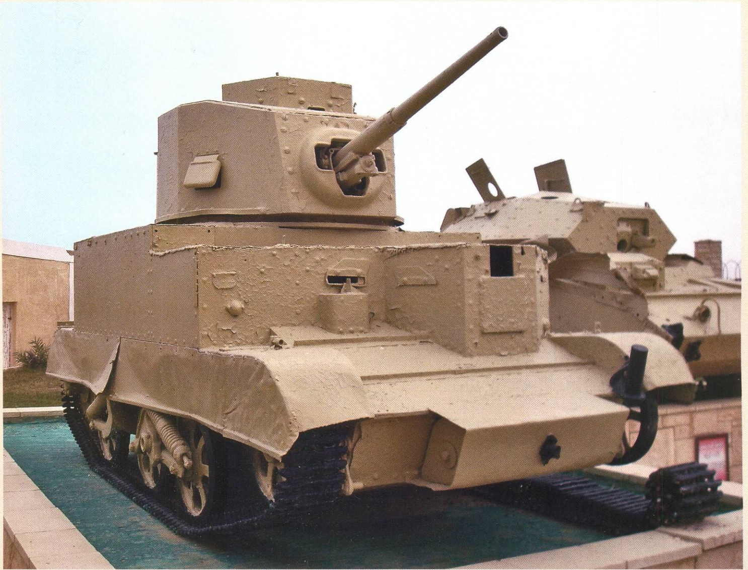
Один из результатов местной реставрации. Этот «гибрид» представляет собой английский бронетранспортёр Universal Carrier Mk. I, на который установили башню и подбашенный лист с американского лёгкого танка Stuart I.
