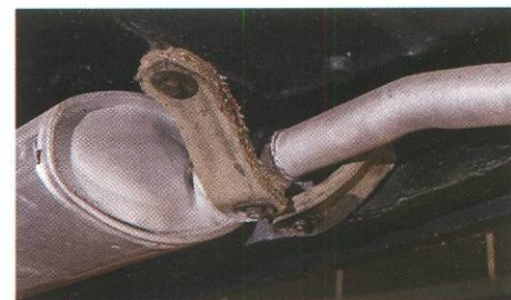
Крепление выхлопной трубы на резиновых кольцах – это дело будущего. Здесь всё несколько проще, но такой тканевый подвес тоже неплохо справляется с задачей защиты кузова от вибраций.
