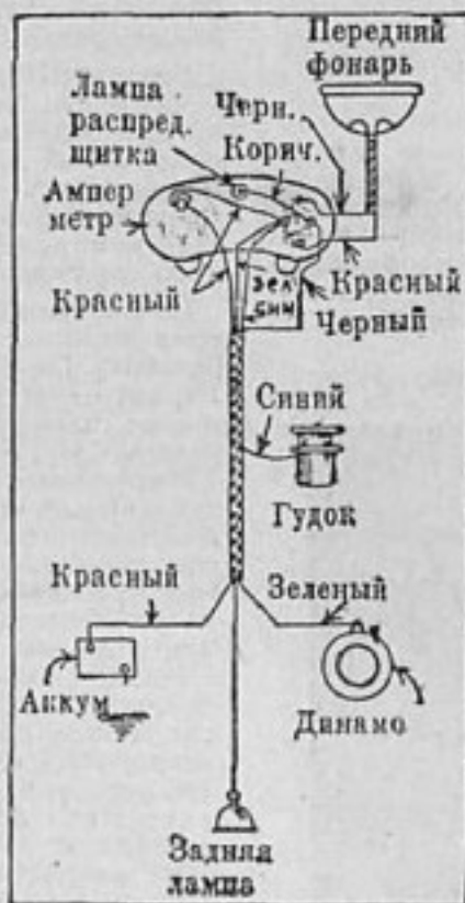
Фиг. 6. Схема электрооборудования „Стентдорф“, применяющаяся на мотоциклах „Индиян“
