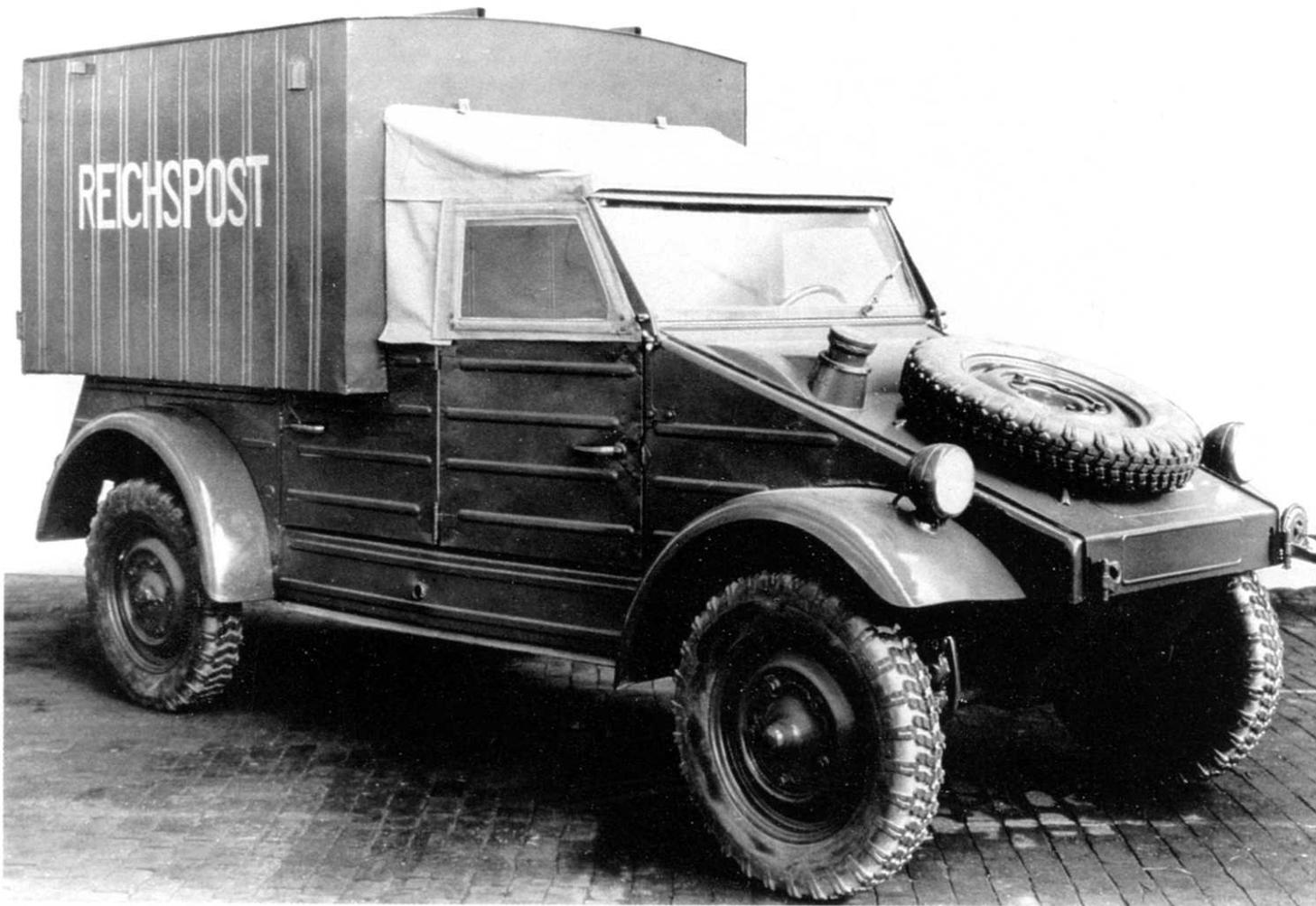
*Ein Kübelwagen mit Kastenaufbau für die Reichspost. Die ersten ausgelieferten Fahrzeuge wurden noch rot (Reichspostfarbe), spätere schon gelb lackiert. Insgesamt wurden von Sommer 1945 bis Jahresende nur 275 derartige Kübelwagen gebaut (VW Typ 28).*
