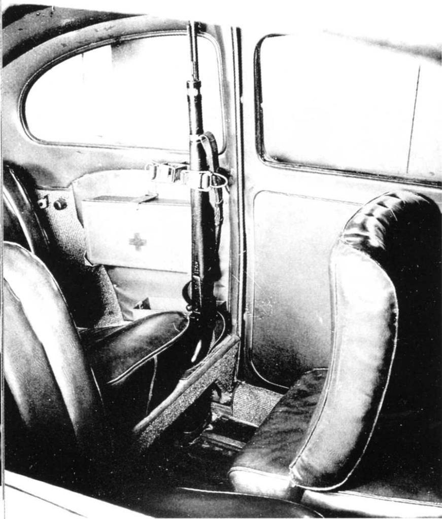
*Geländekäfer Typ 92 SS: Zwei Gewehrhalterungen im hinteren Seitenteil. Darunter der Verbandskasten.*
