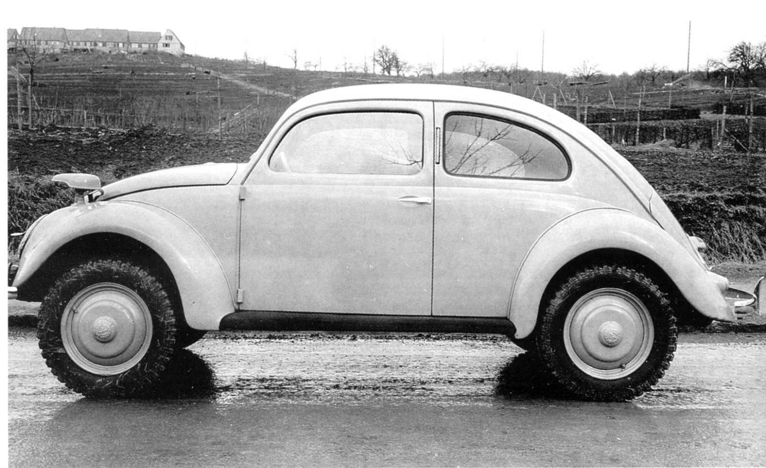
*Für das Kolonialpolitische Amt im Reichsaußenministerium wurden 1941 zwei Gelände-Käfer auf Kübelwagenfahrgestell gebaut (deutlich sichtbar an der hochbeinigen Bauart). Die Wagen haben Glanzlack, verchromte Stoßstangen, an der Seite ein Klaxonhorn und fuhren im Konvoi mit anderen Fahrzeugen nach Afghanistan.*
