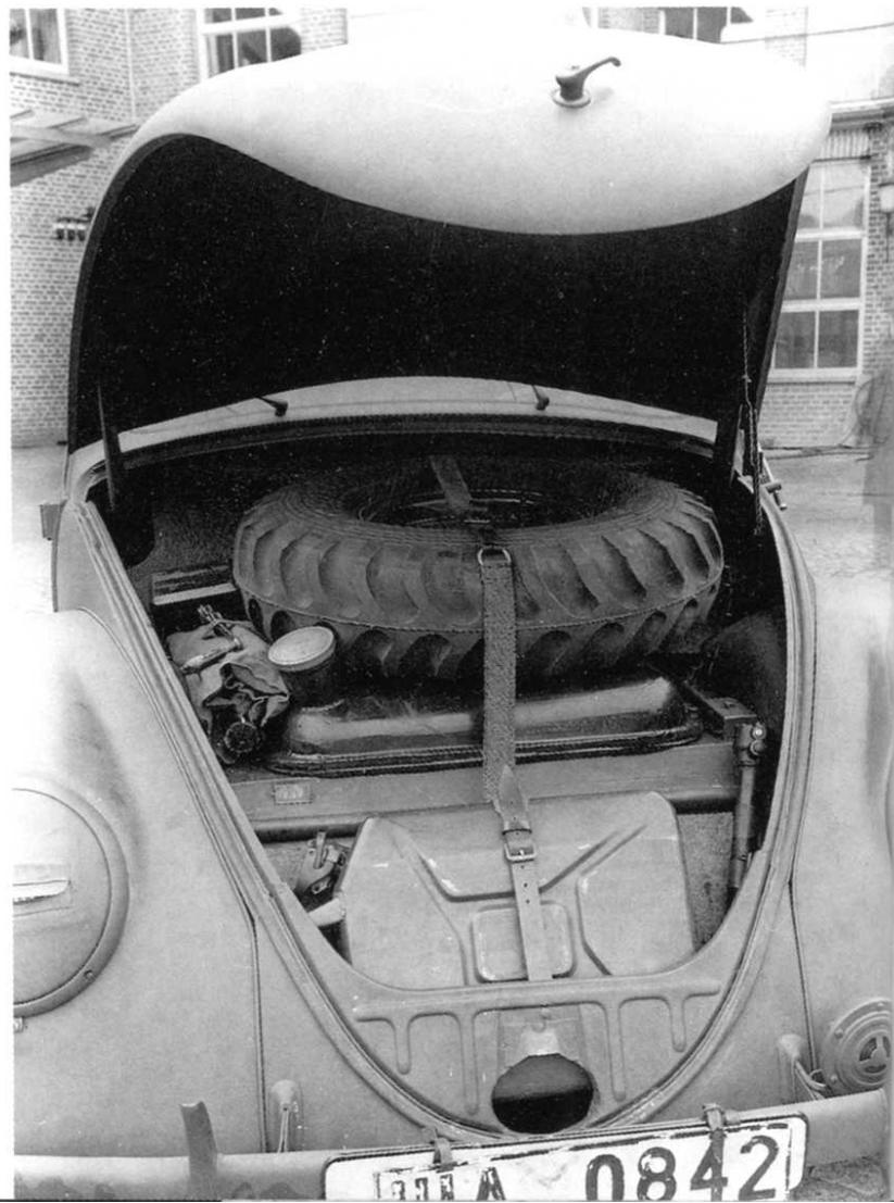
*Ein Blick unter die vordere Haube beim Typ 98: Das breite Reserverad paßt nicht in die dafür vorgesehene Mulde. Deshalb wird hier der Benzinkanister deponiert. Das Ersatzrad wandert nach oben in den Kofferraum.*
