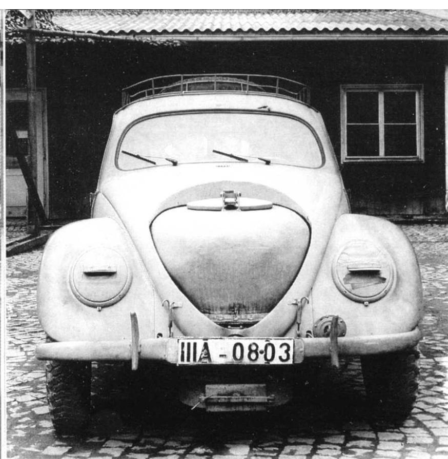
*Frontansicht einer Geländelimousine mit Holzvergaser (Porsche Typ 230), Baujahr 1944. Die Haube wird mit Spannfedern gehalten und ist weit aufgeschnitten, um für den voluminösen Generator Platz zu schaffen. Bei geöffneter Haube sieht man hinter dem Generator den Vorreiniger. Wie man sieht, ragt der Generator weit unter den Wagenboden; wahrscheinlich wurde deshalb der Gelände-VW mit hohem Fahrgestell bevorzugt.*
