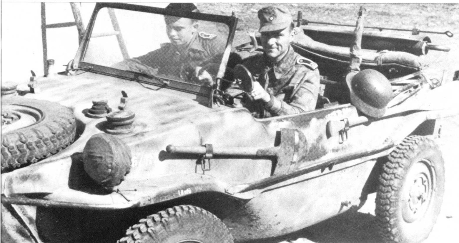
*Bei diesem Schwimmfahrzeug in Rußland wurde die ursprünglich graue Lackierung einfach mit gelben Flecken überspritzt. Ein Kuriosum an diesem Volkswagen ist die Auspuffanlage quer über dem Heck außerhalb der Karosserie. An der Seite sind Spaten und Paddel befestigt. Die Scheinwerfer haben die üblichen Abdeckungen mit Schlitzen. Das Fahrzeug hat normale VW-Felgen.*
