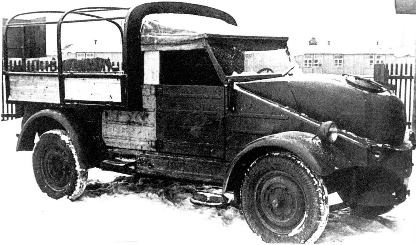
*Ein ausrangierter Kübelwagen mit Holzgasgenerator. Das Fahrzeug stammt wahrscheinlich aus Beständen der Reichspost und hatte früher einen Kastenaufbau (VW Typ 28).*
