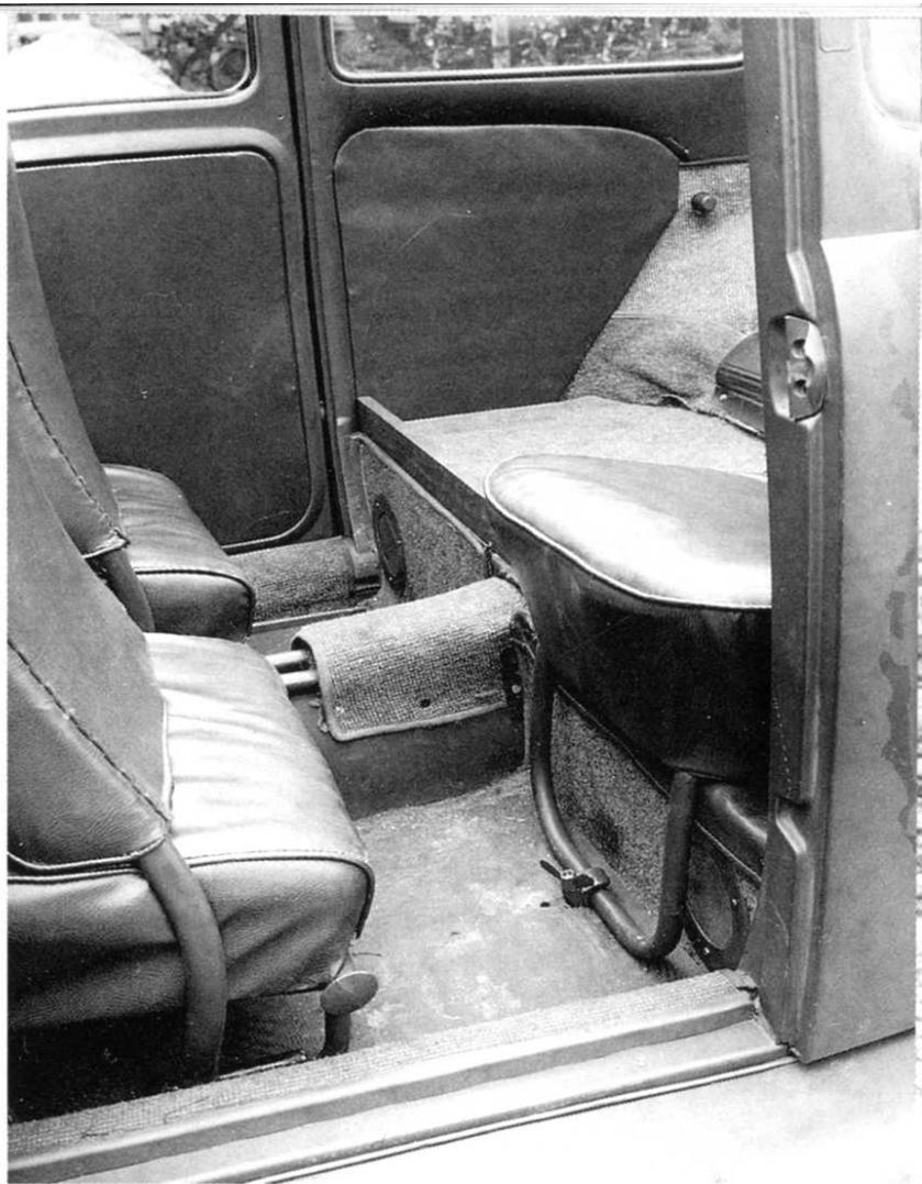
*Rücksitzbank mit geöffnetem Batteriekasten.*
