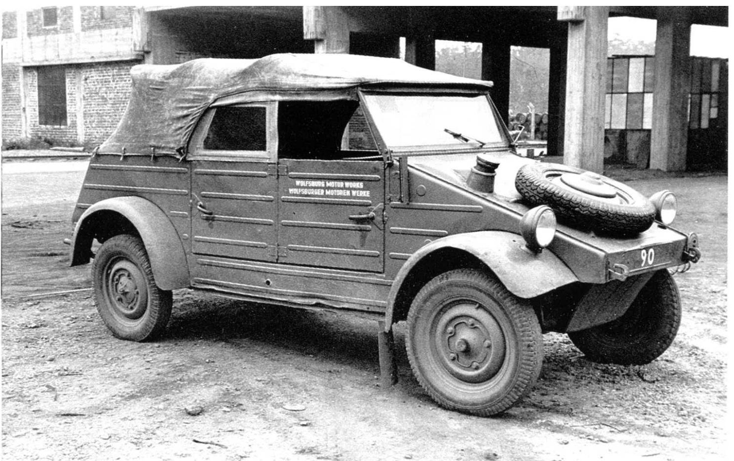
*Ein Kubelwagen aus der Nachkriegsproduktion, wahrscheinlich Sommer oder Herbst 1945. Aufschrift an der Tür: »Wolfsburg Motor Works« / \ »Wolfsburger Motoren Werke«. Die Radkappen und der rechte Scheibenwischer wurden wegen Materialknappheit noch eingespart.*
