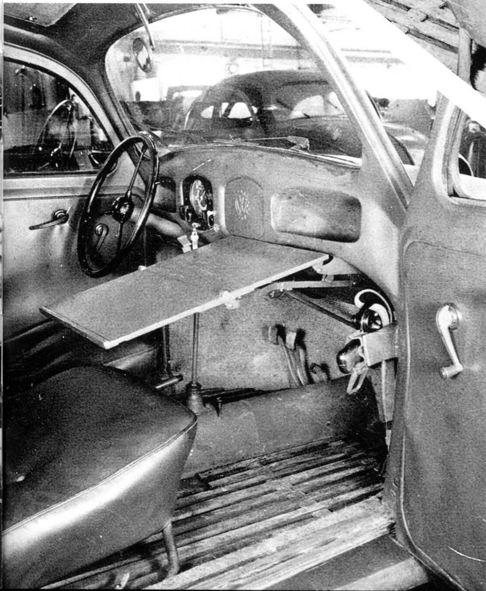
*Armaturenbrett mit ausziehbarer Schreibunterlage, seitlich rechts die Maschinenpistole, Holzroste auf dem Fußboden. Befestigung der Sitze mit Flügelschrauben.*
