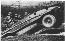
Unten: In rasanter Fahrt nimmt ein 128er der Pioniere eine Steigung im Gelände. Form und Bodenfreiheit der Wanne sind hier gut erkennbar.
