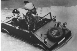
Oben: Schon frühzeitig stellt Porsche Versuche zur Schwimmfähigkeit des Kübelwagens an. Hier ein solch abgedichtetes Fahrzeug, das im Feuersee der Stuttgarter Firma einem Test unterzogen wird.
