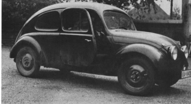
Der Prototyp V 3 (1936) des bis heute gebauten legendären VW-Käfers. Die Grundform der Karosserie ist hier bereits ausgeprägt, auch wenn später viele Details (im Kotflügel eingebaute Scheinwerfer, vorn angeschlagene Türen) noch geändert wurden.
