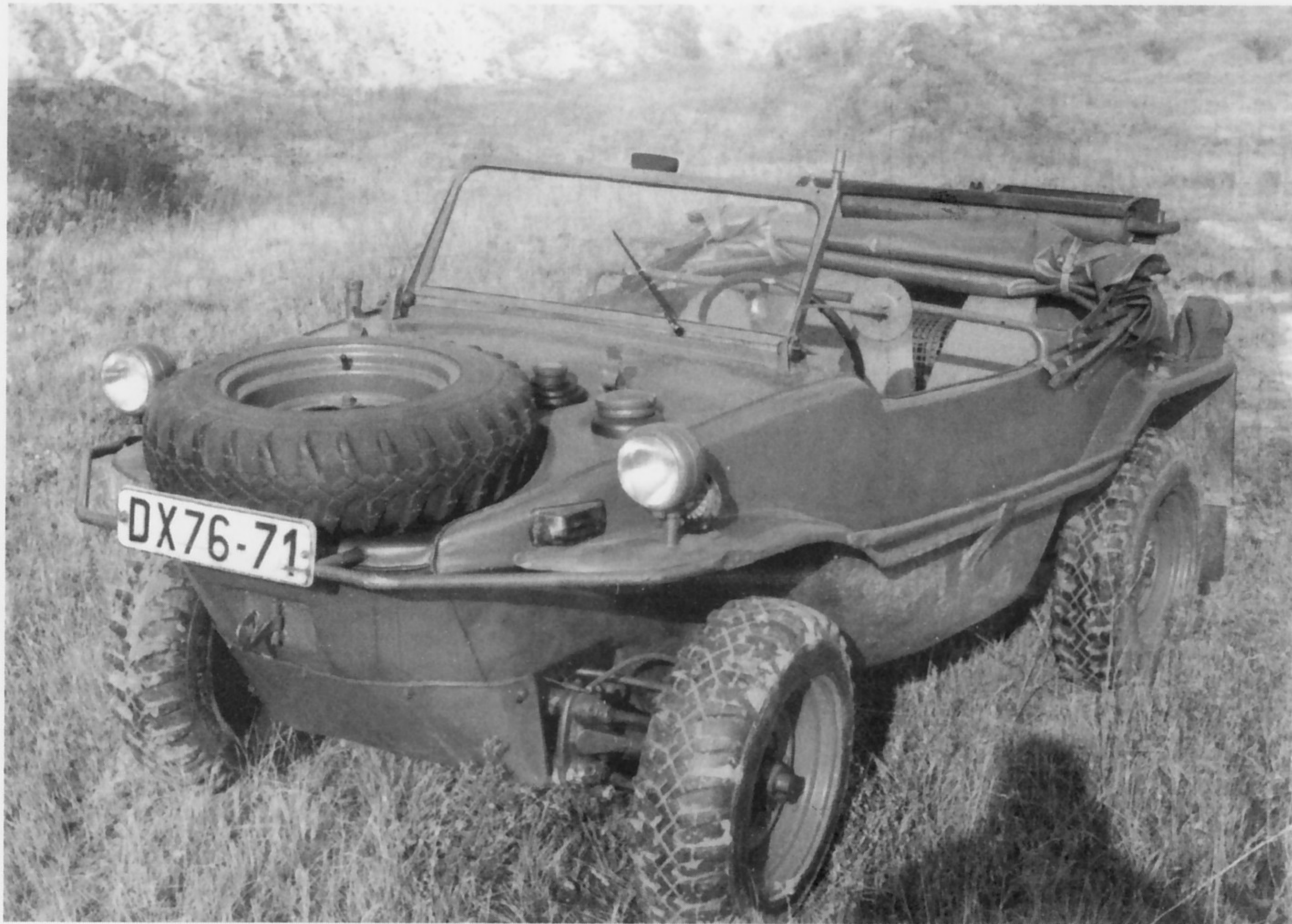
Zwischen den hinteren Sitzen ist ein Teil des Luftaustritts der Kühlung gut zu erkennen. Vorn deutlich zu sehen einer der beiden Tankeinfüllstutzen.
