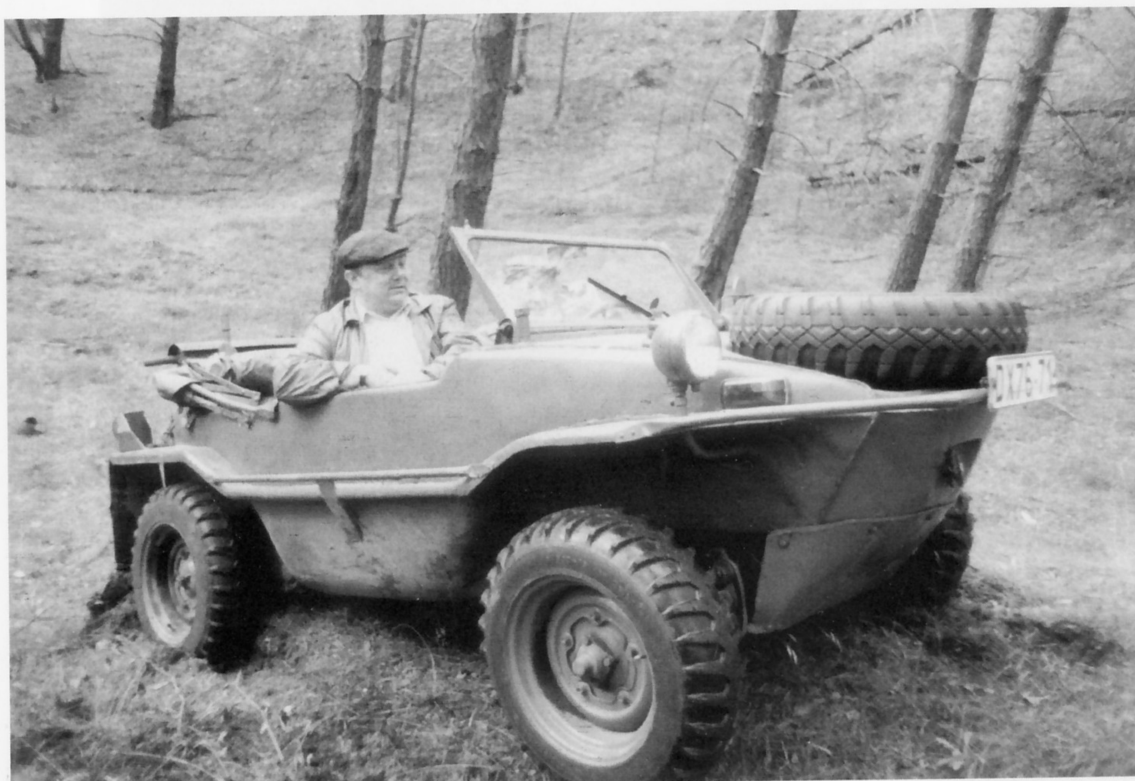
Gut zu sehen die tief heruntergezogenen Schutzbleche hinten als Spritzschutz für die Fahrt im überfluteten Gelände.
