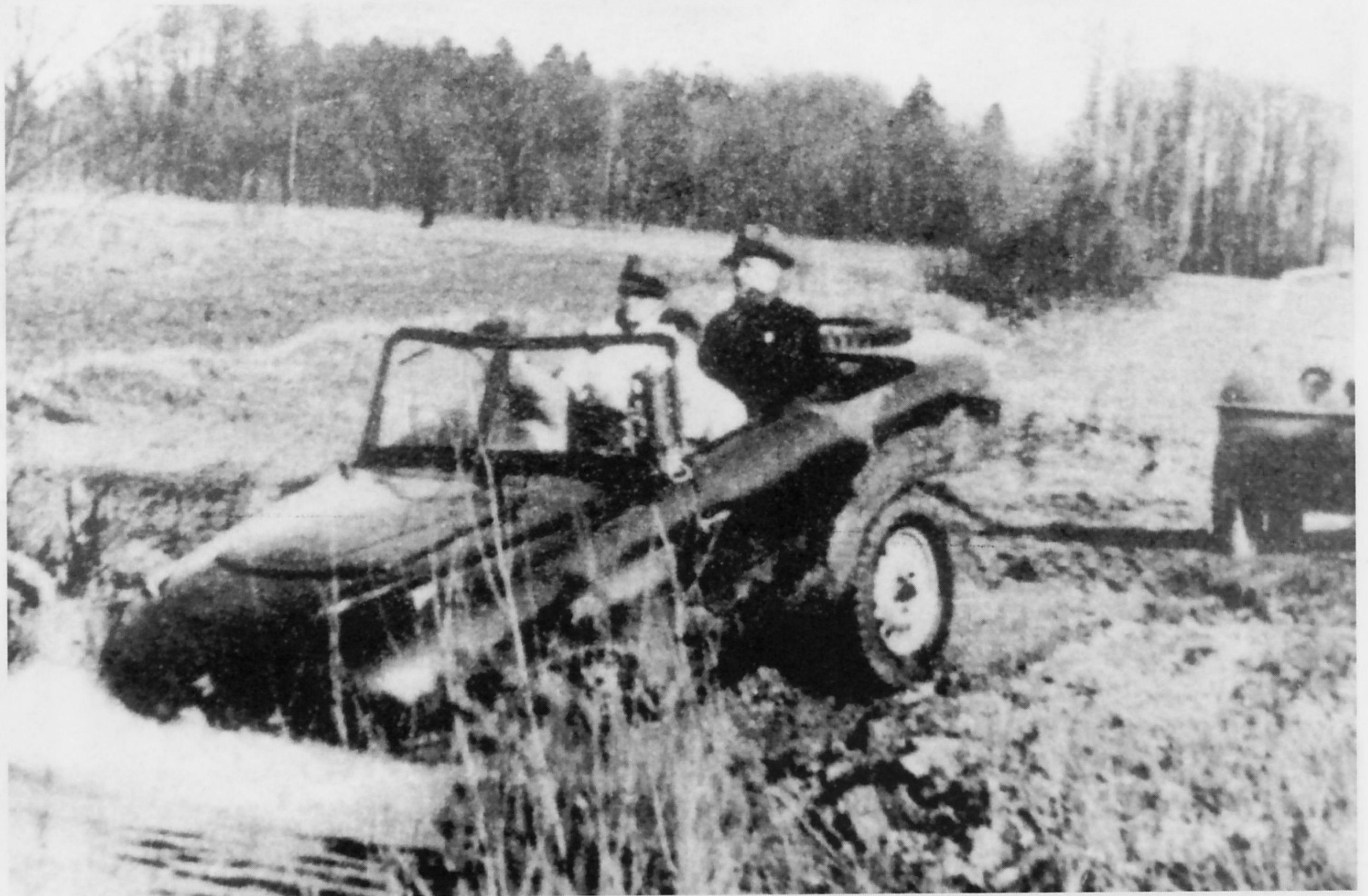
Der schwimmfähige gelände- gängige PKW Typ SG 6 des deutschen Ingenieurs Trippel war ein Vorbild für die Kon- struktion des VW-Schwimm- kübels. Die Schwimmfähigkeit war recht gut, allerdings erwies sich sein hohes Gewicht als nachteilig.
