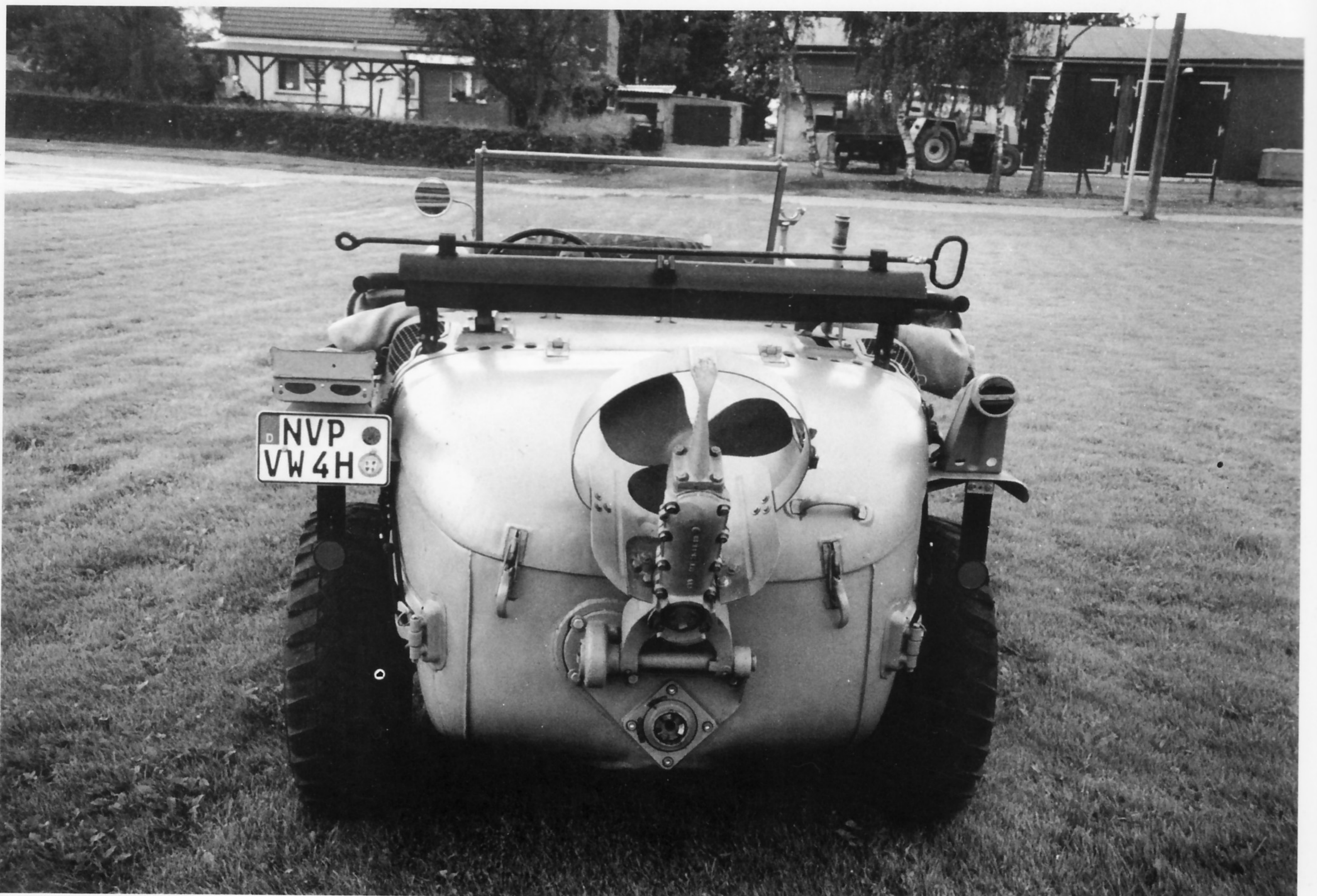
Front- und Heckansicht des VW-Schwimmkübels. Hier sind das vorn befestigte Ersatzrad und die dreiflüglige Schiffsschraube am Heck gut zu erkennen. Hinter den Sitzen ist die Stange zum Herablassen der Schiffsschraube bei Wasserfahrt angebracht. Das gut restaurierte Fahrzeug ist im Besitz eines Mecklenburger Sammlers.
