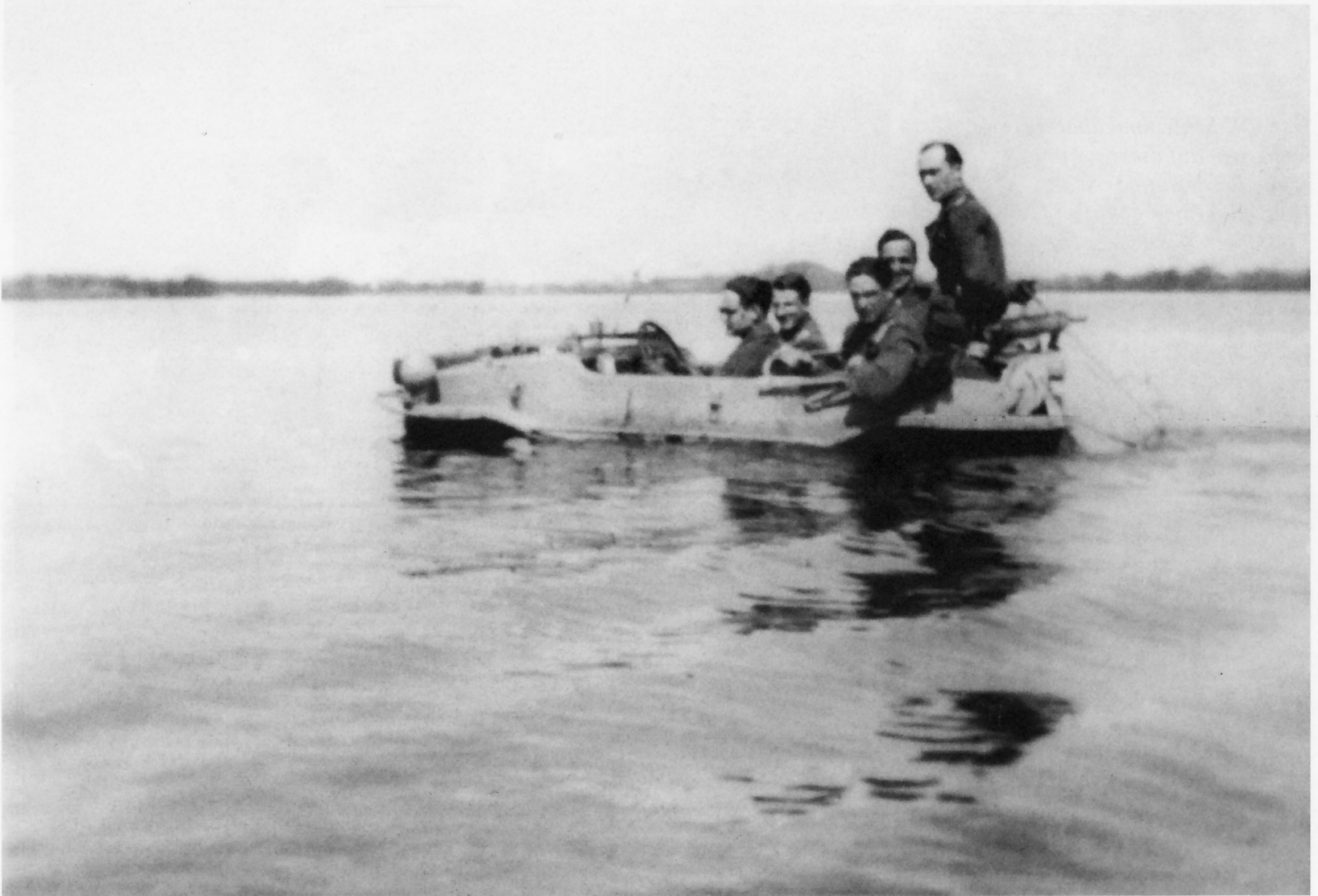
Auch bei maximaler Auslastung bewies der leichte PKW Typ K2s (4x4) Volkswagen Typ 166 gute Fahreigenschaften im Wasser.
