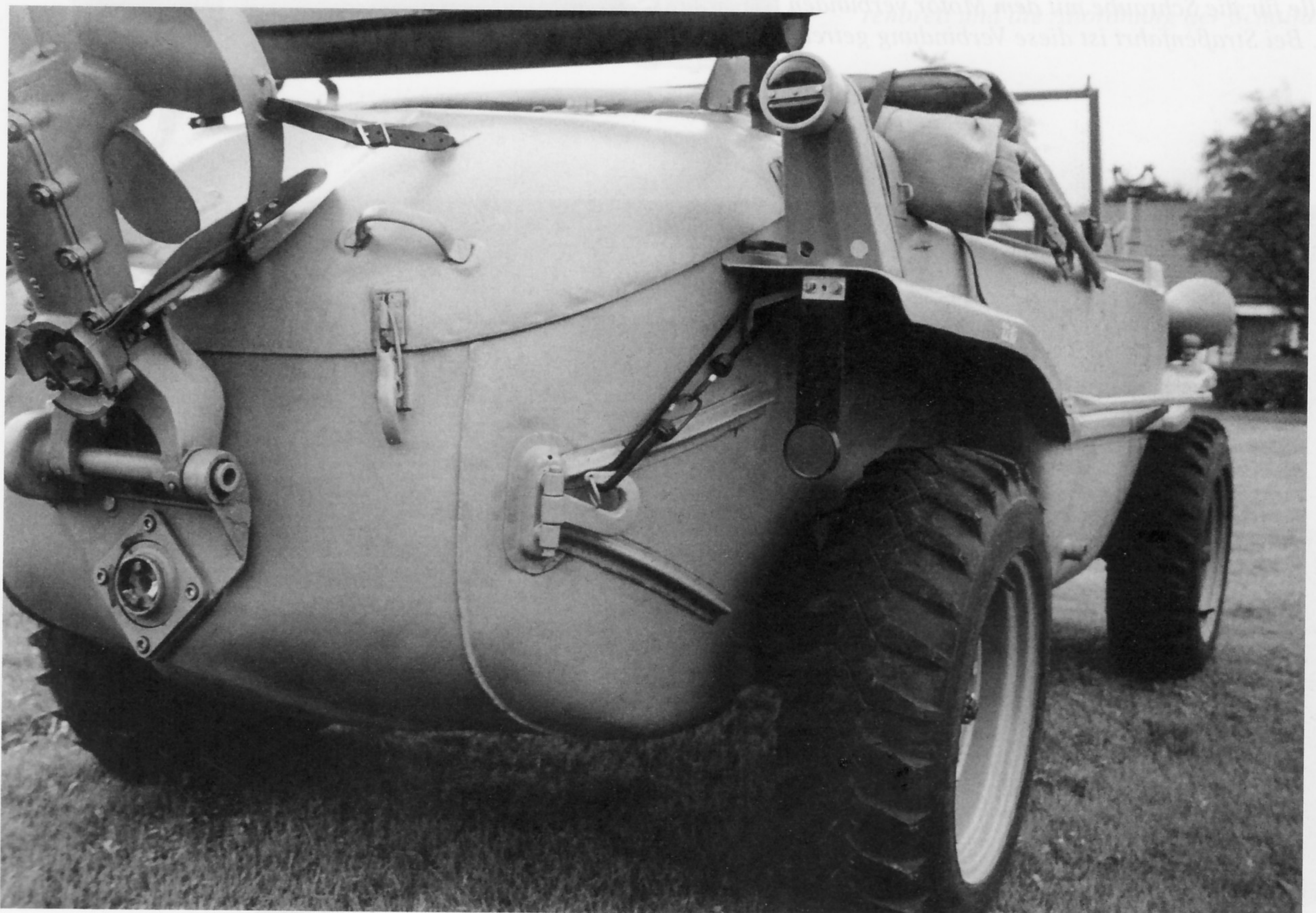
Rückansicht. Beachte die Arretierung der Schraube für Straßenfahrt. Rechts der Abschlepphaken, der mit einem Gummiband befestigt wurde.
