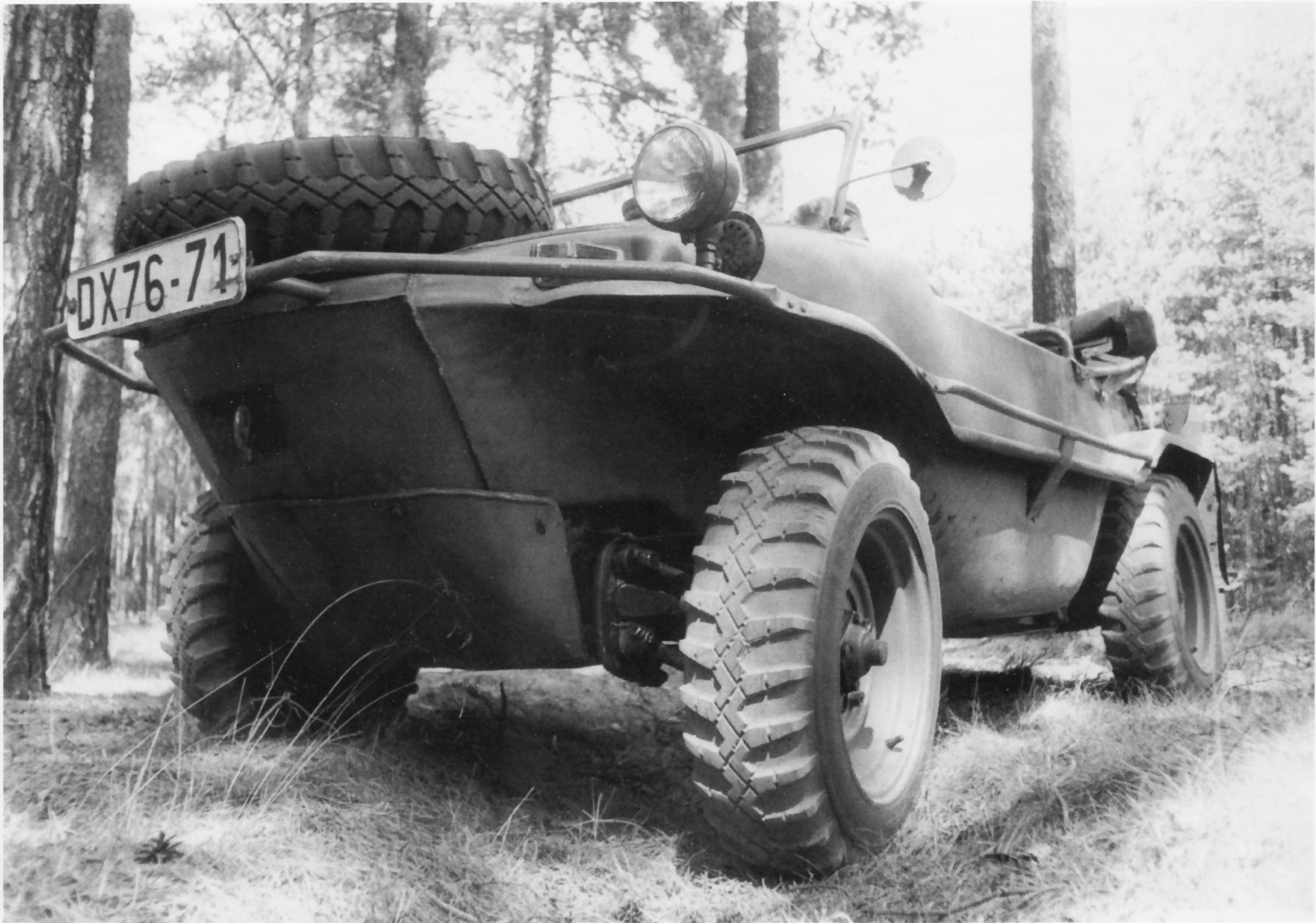
Die hohe Wertschätzung, die der VW-Schwimmkübel bei der Truppe genoss, beruhte auf seiner Geländegängigkeit. Dieser Blick auf die hohe Bodenfreiheit offenbart einen der Gründe dafür.
