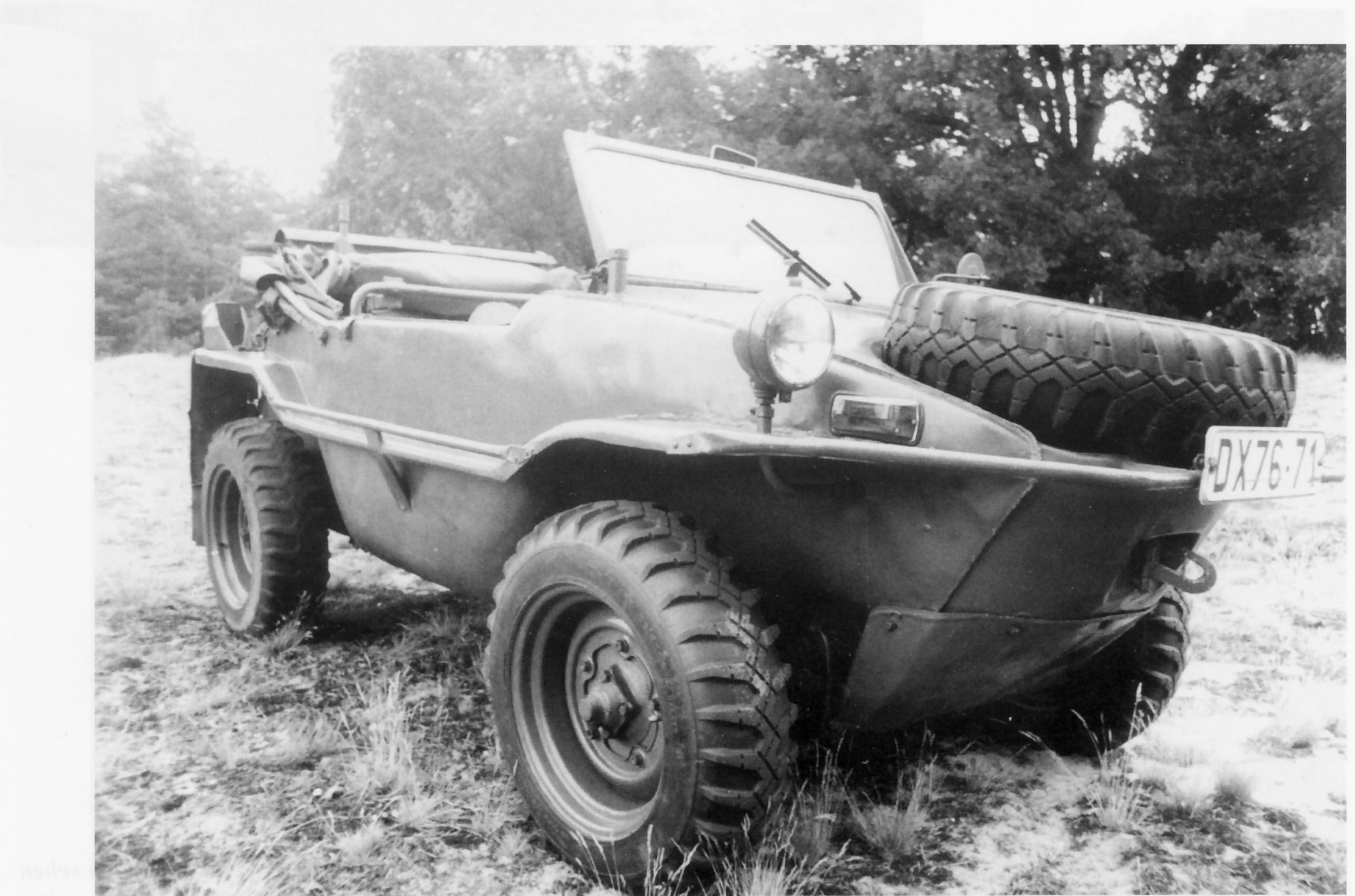
Hier ist die Befestigung der Stoßstange und der seitlichen Trittschance gut zu erkennen.
