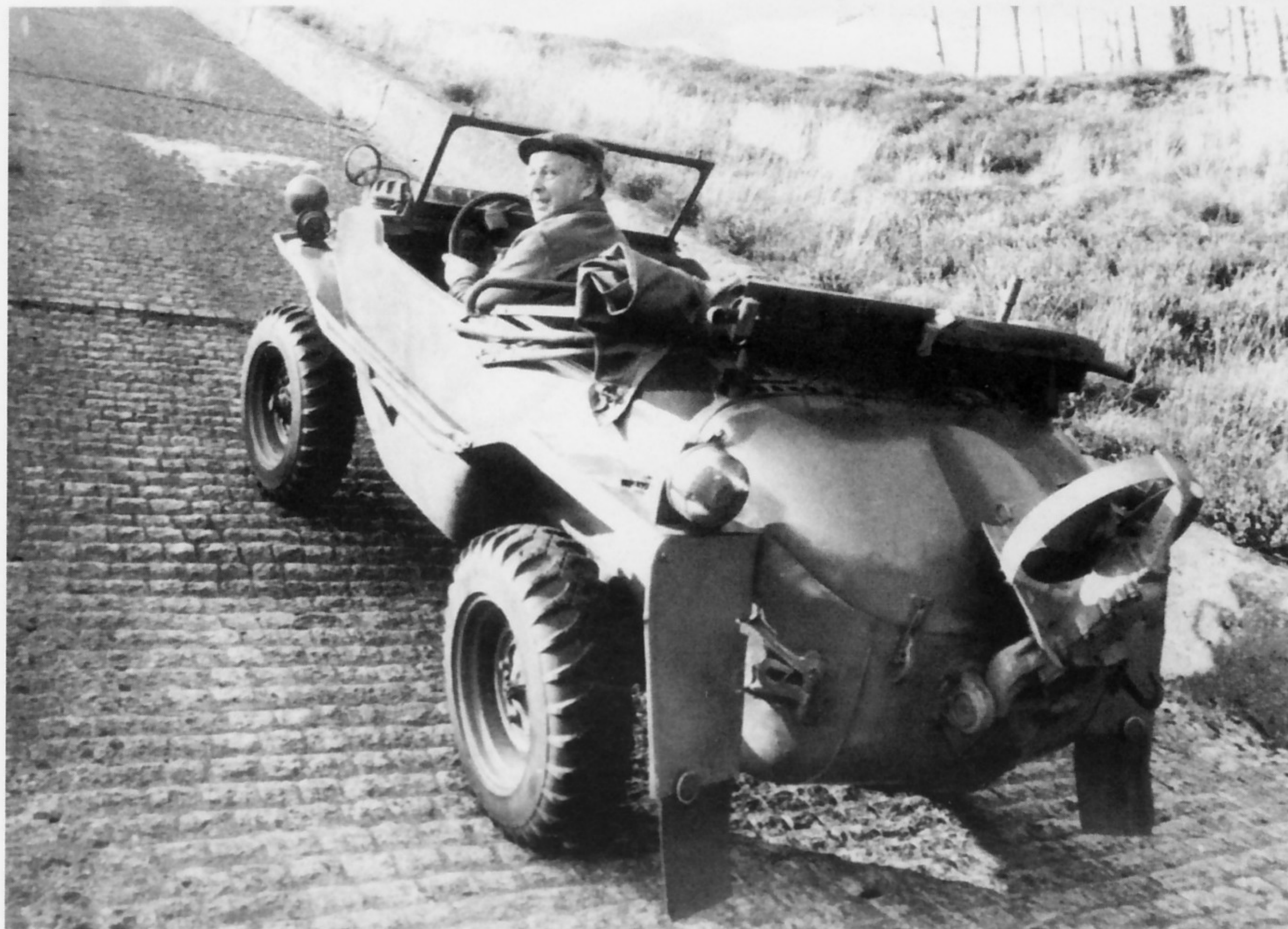
Der VW-Schwimmkübel bewies hervorragende Geländegängigkeit, hier demonstriert auf der Steigungs- bahn der ehemaligen Heeresver- suchsanstalt Kummersdorf (oben). Unten ein Schnittbild durch das Gesamtriebwerk des Fahrzeugs.
