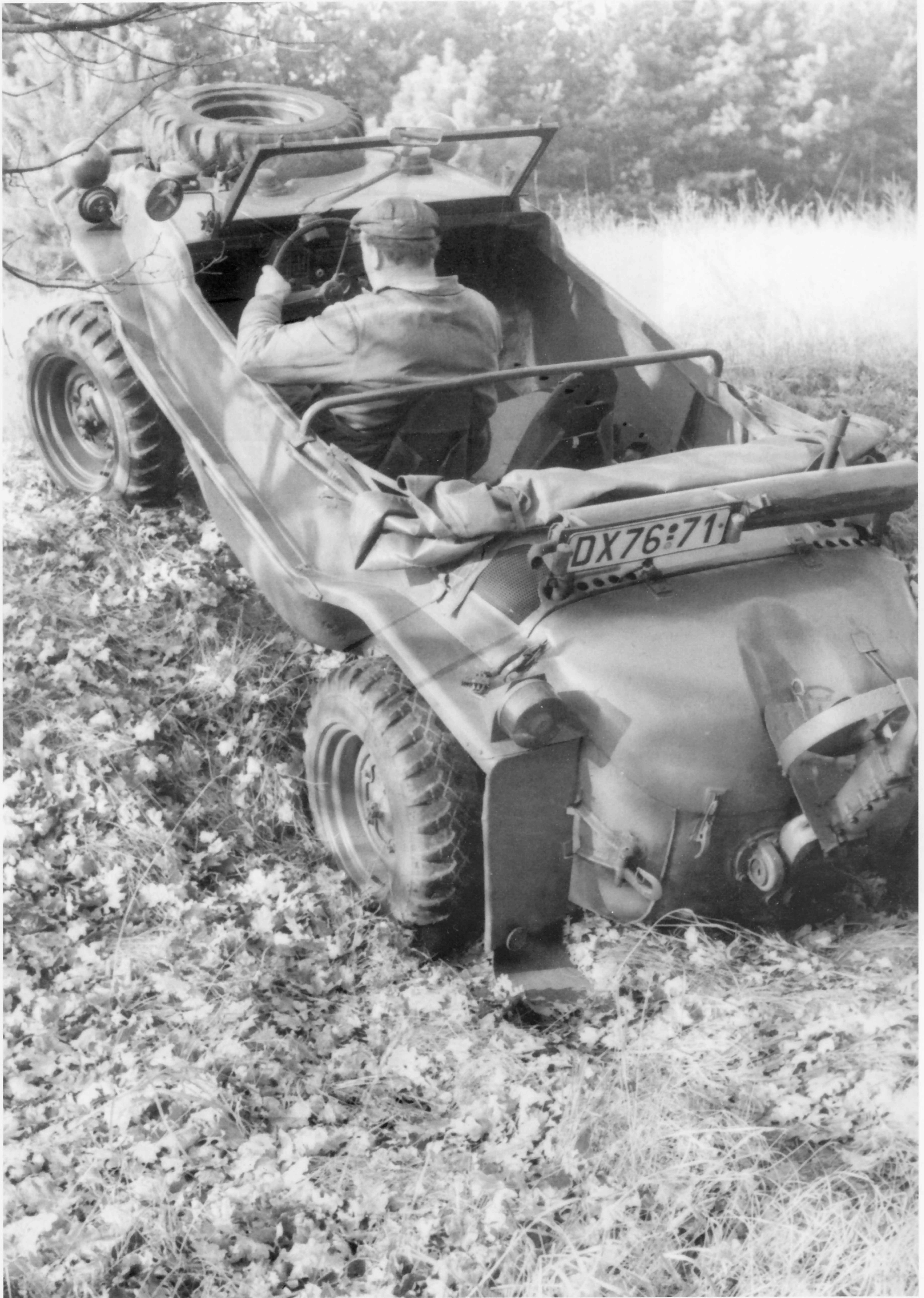
Unterwegs in Brandenburger Wäldern. Dieses Foto zeigt deutlich, dass solches Gelände nur mit hochzogener Schiffschraube zu bewältigen ist.
