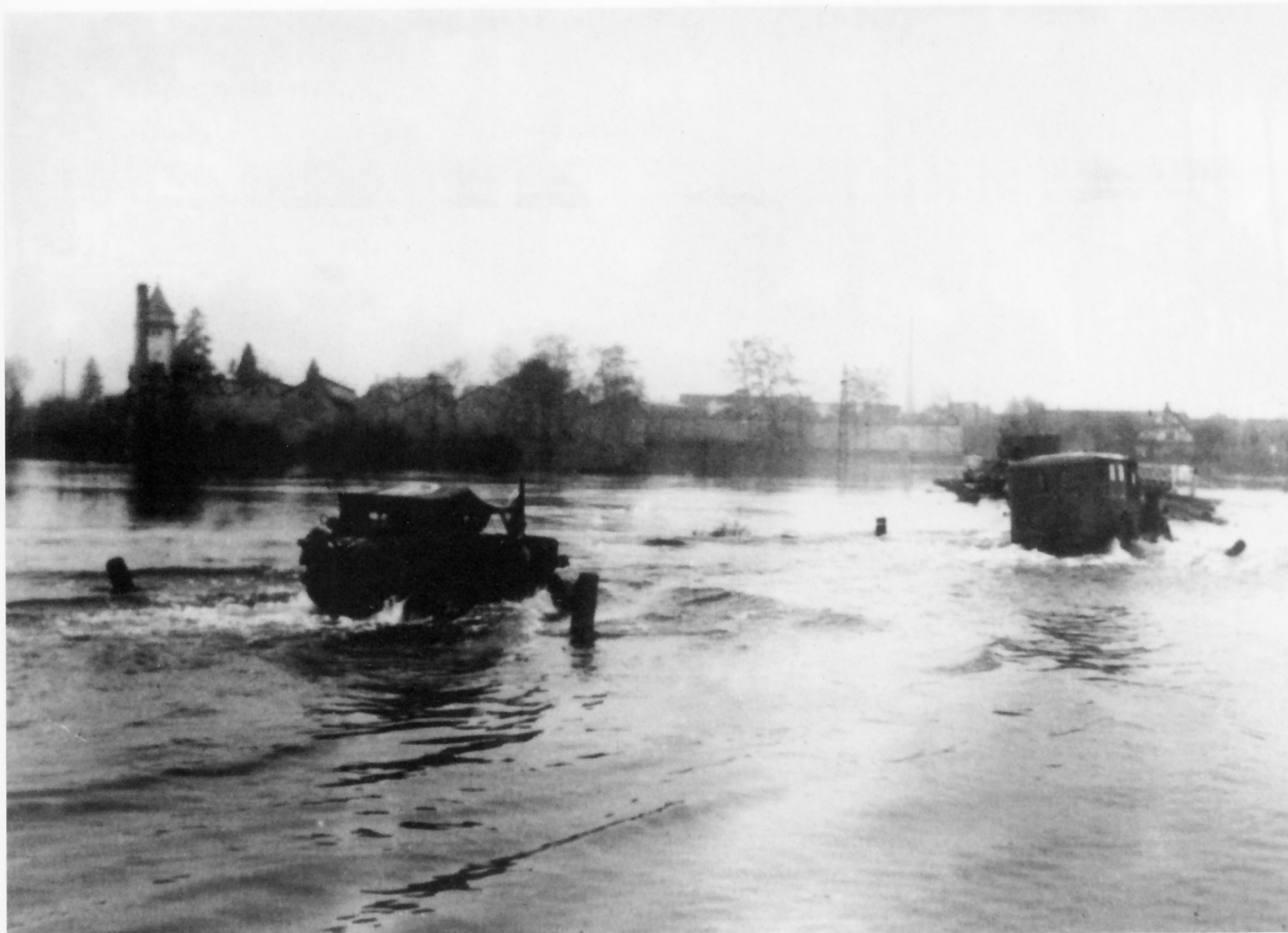
Der Straßenverlauf ist nur noch an den Markierungspfählen zu erkennen – für den VW-Schwimmkübel (hier mit aufgezo- genem Verdeck gefahren) kein Problem. Seine volle Schwimmfähigkeit garantierte auch hier das Vor- wärtskommen.
