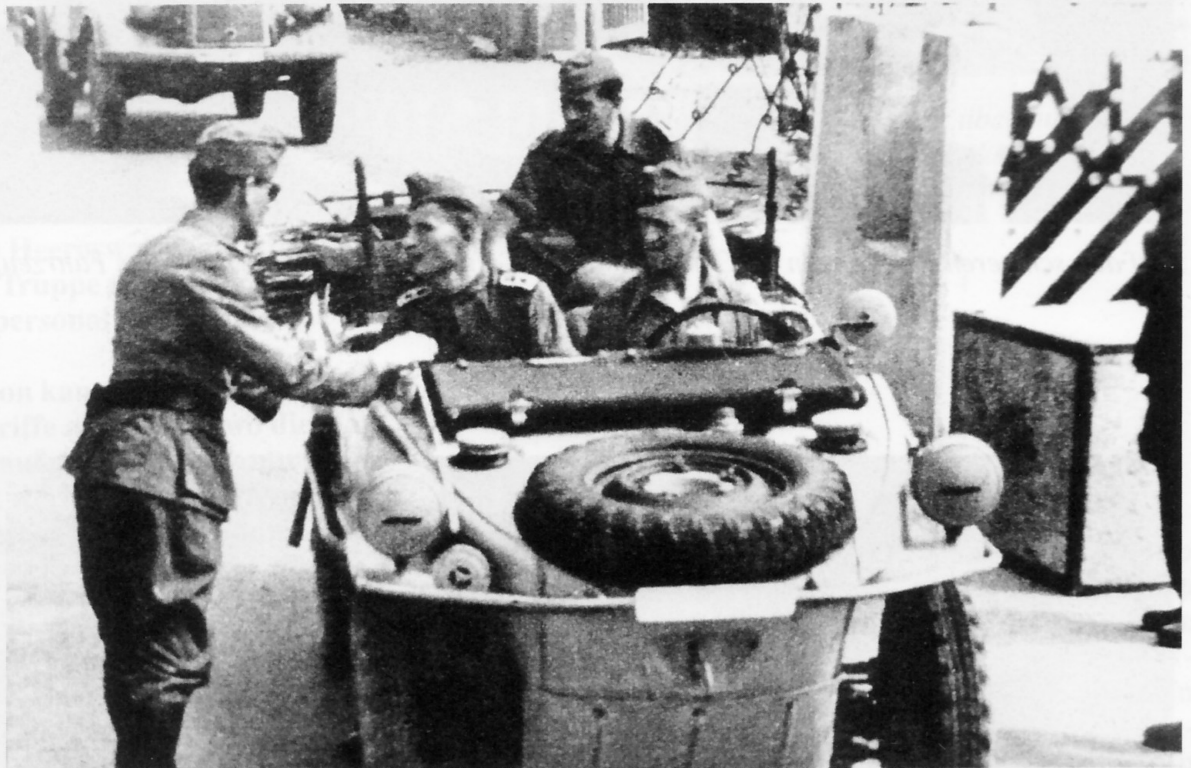
Besonderes Kennzeichen des VW-Kübels war das vorn aufliegende Reserverad. Das Foto entstand 1943 in Italien.
