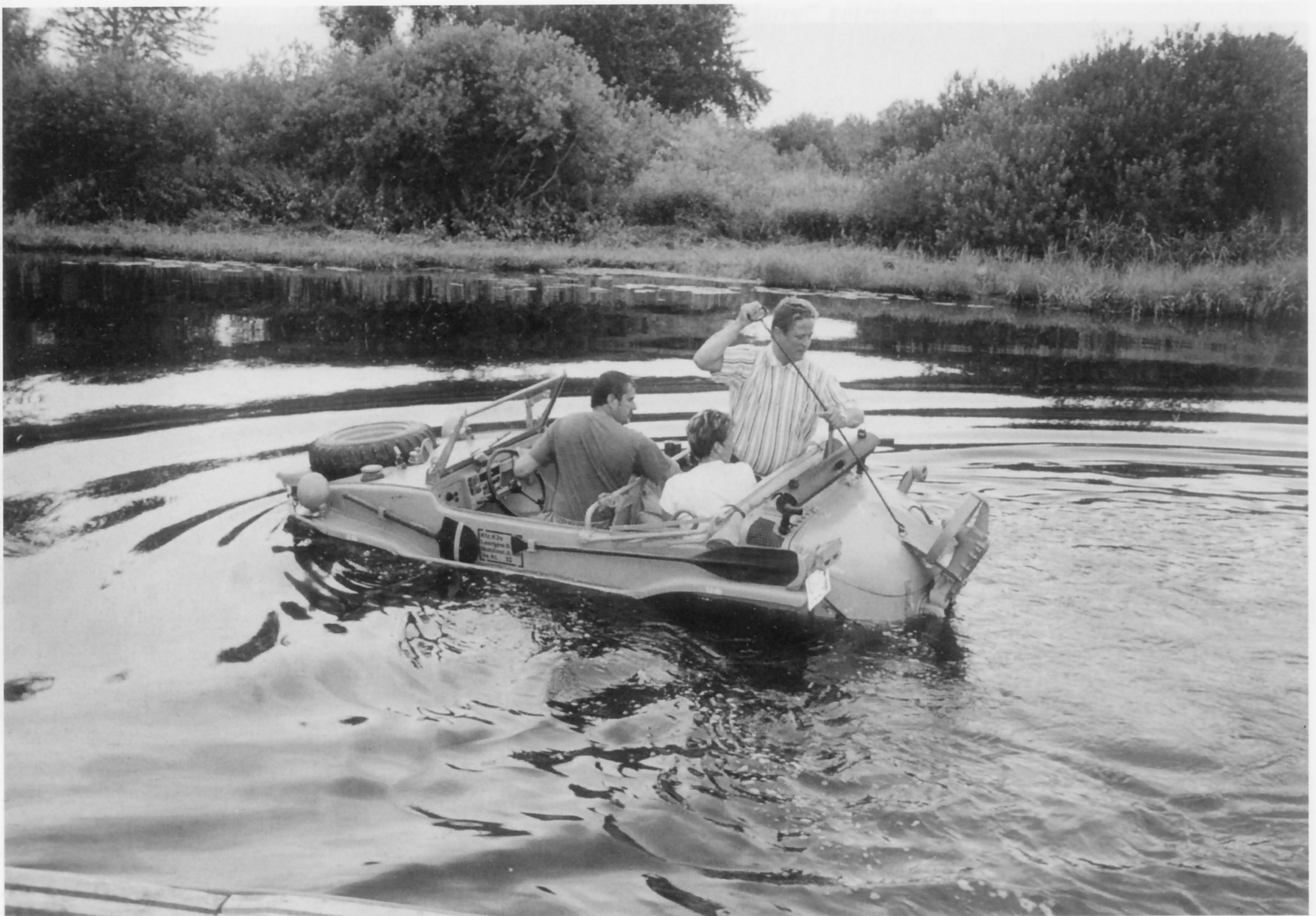
Hier ist gut zu erkennen, wie mit der Stange die Arretierung gelöst wird, damit die Schraube heruntergelassen werden kann.
