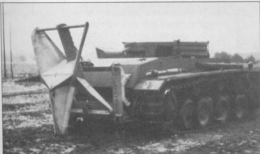
Прототип VK 3001 (H) на ходовых испытаниях. На машине смонтирован плуг для рытья земляных укреплений.
