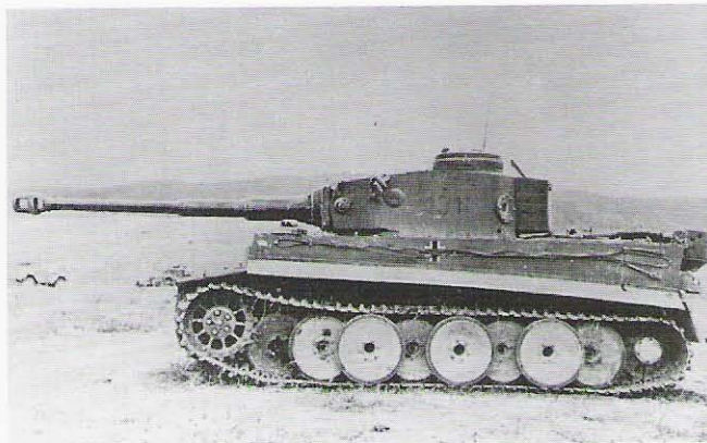
Dwie fotografie zdobytego czołgu PzKpfw VI „Tiger” Ausf. H1 nr „131” z 1. kompanii 504. Batalionu Czołgów Ciężkich, Tunezja, kwiecień 1943 roku. Two photos of captured PzKpfw VI „Tiger” Ausf. H1 coded No “131” tank of 1st Company 504th schwere Heeres Panzer Abteilung, Tunisia, April 1943. [Tank Museum 292/A4, 292/A2]
