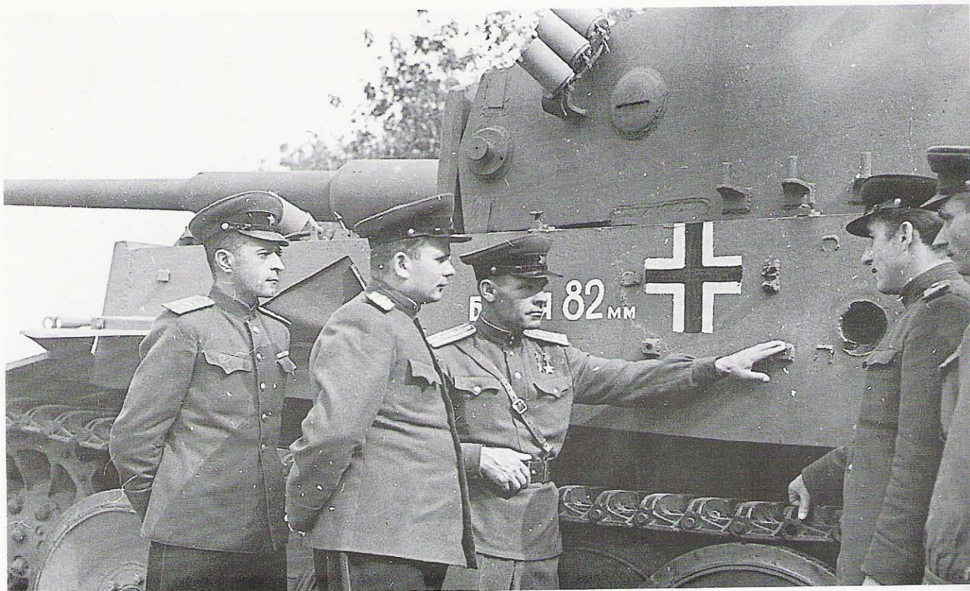
Oficerowie sowieccy oglądają przebity pancierz boczny czołgu PzKpfw VI Sd Kfz 181 Ausf. H1 „Tiger“ prawdopodobnie z 503. Batalionu Czołgów Ciężkich, lipiec 1943 roku. Soviet officers inspecting penetrated side armor of PzKpfw VI Sd Kfz 181 Ausf. H1 “Tiger” tank probably from the 503rd schwere Heeres Panzer Abteilung, July 1943. [ASKM]
