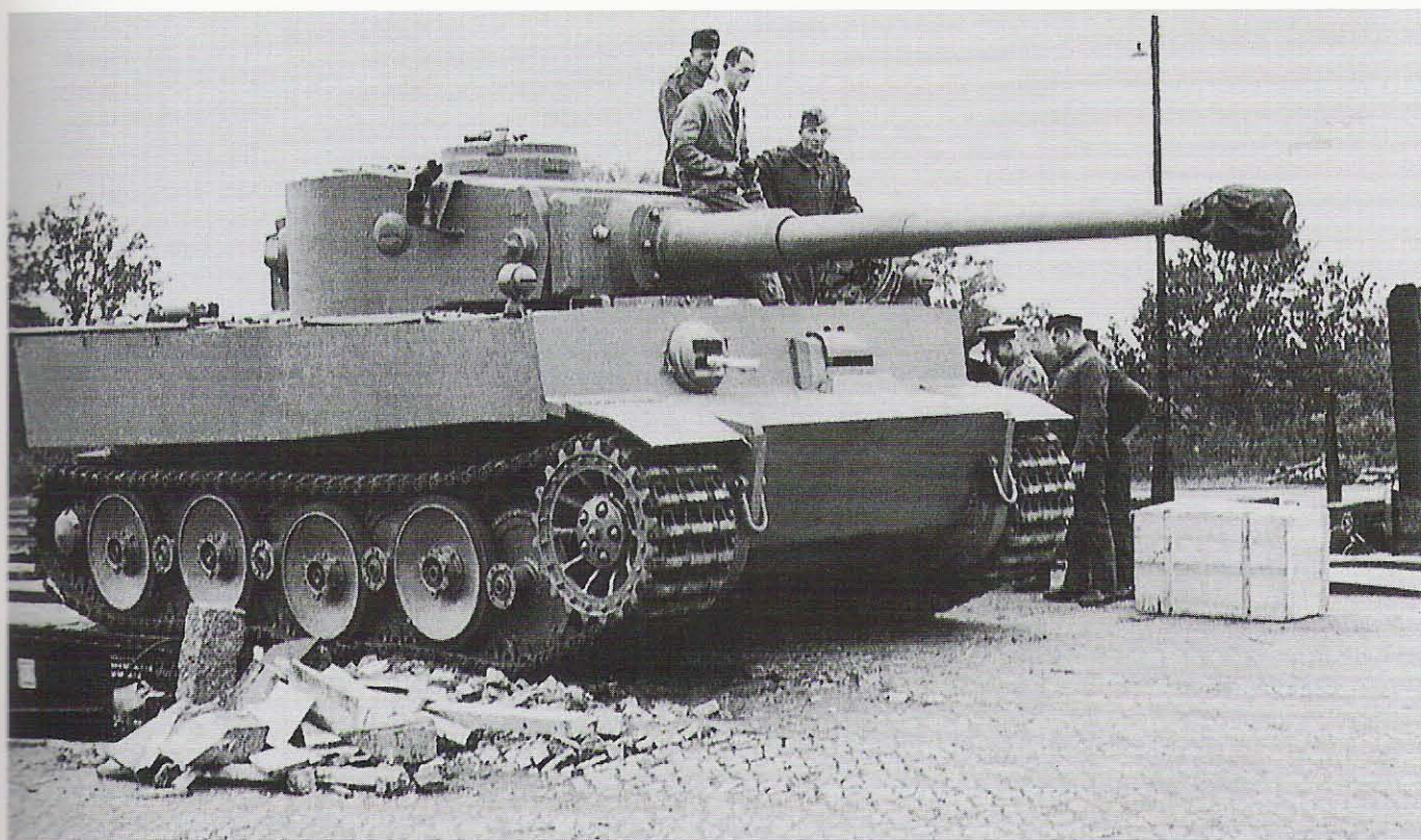
Czołg „Tiger” oznaczony Fgst 250 014 z pierwszych serii produkcyjnych, bez zasobnika z tyłu wieży dostarczony do 501. Batalionu Czołgów Ciężkich w sierpniu 1942 roku. One of the first “Tiger” tanks registered Fgst 250 014 without turret stowage bin delivered to the 501st schwere Heeres Panzer Abteilung in August 1942. [ASKM]
