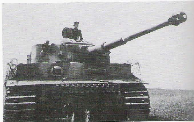
Czołg PzKpfw VI „Tiger” Ausf. H1 z 505. Batalionu Czołgów Ciężkich, Kursk, lipiec 1943 rok. Z boku kadłuba zamocowany drut kolczasty utrudniający działanie sowieckich „łowców czołgów”. PzKpfw VI “Tiger” Ausf. H1 tank of 505th schwere Heeres Panzer Abteilung, Kursk in July 1943. Tank fitted with wires mounted on the side of the hull to prevent actions of Soviet AT hunters. [Tank Museum 2399/A4]
