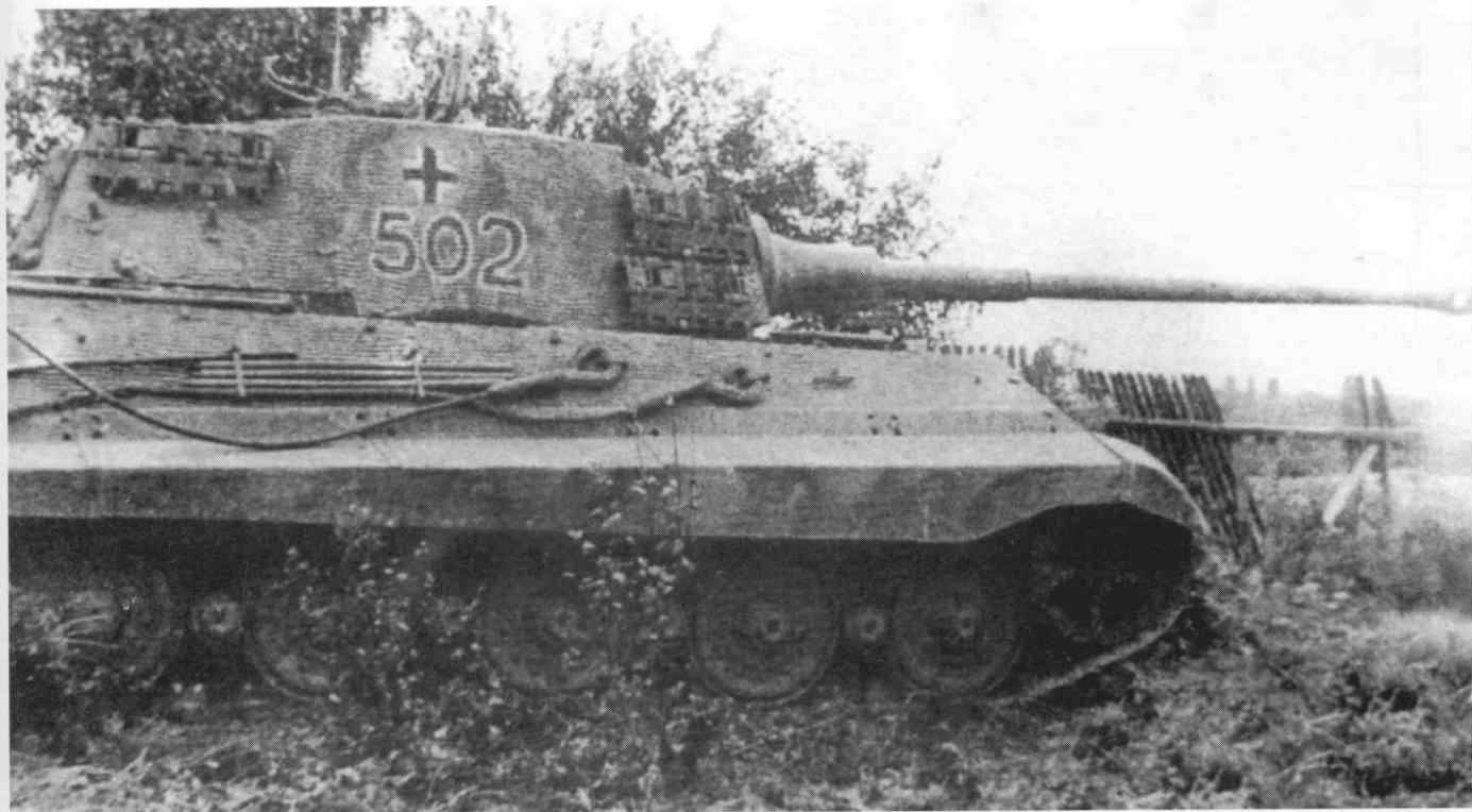
Zdobyty wóz dowodzenia Panzerbefehlswagen VI „König Tiger“ nr „502“ z wieżą typu Henschel z 501. Batalionu Czołgów Ciężkich, wieś Oględów 13 sierpnia 1944 roku. A captured Panzerbefehlswagen VI “König Tiger” coded “502” command tank fitted with Henschel-type turret of the 501st schwere Heeres Panzer Abteilung, Oględow village, Poland, August 13, 1944. [Tank Master]
