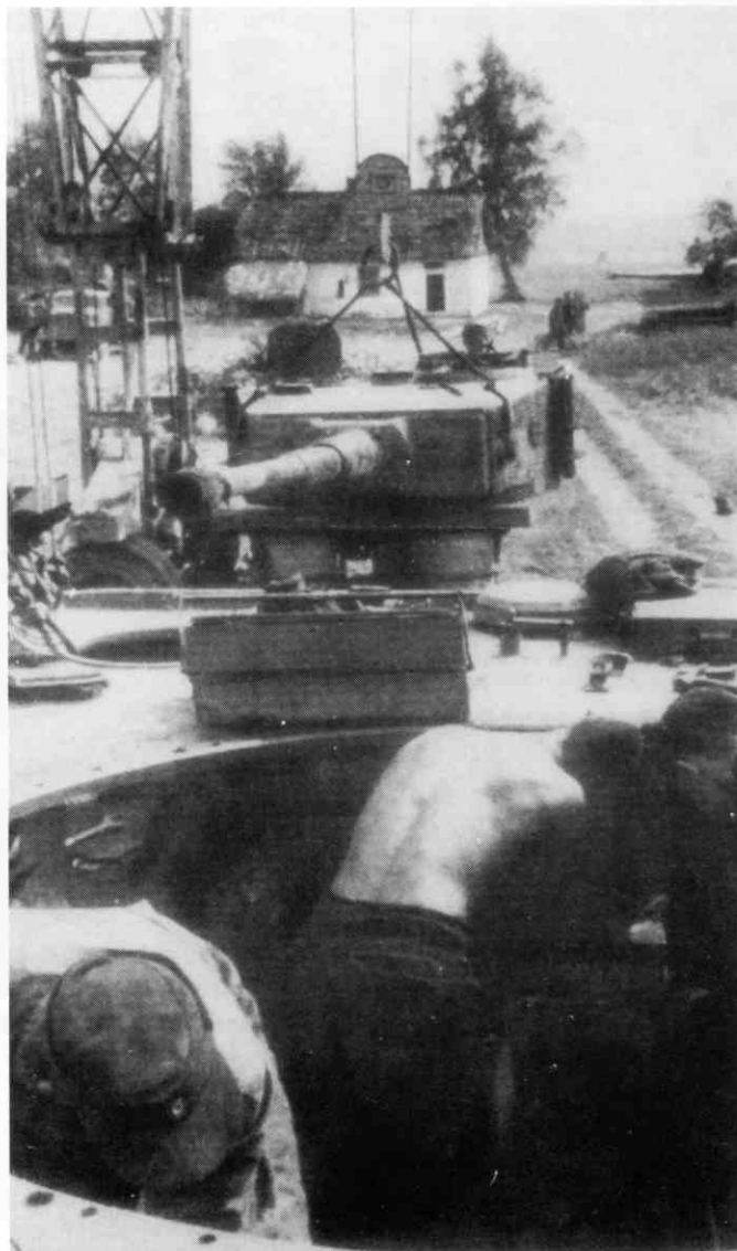
Naprawa czołgu PzKpfw VI „Tiger” Ausf. E, widoczna wieża uniesiona przez dźwig. The repair of a PzKpfw VI “Tiger” Ausf. E tank. Note a crane lifting turret. [Tank Museum]
