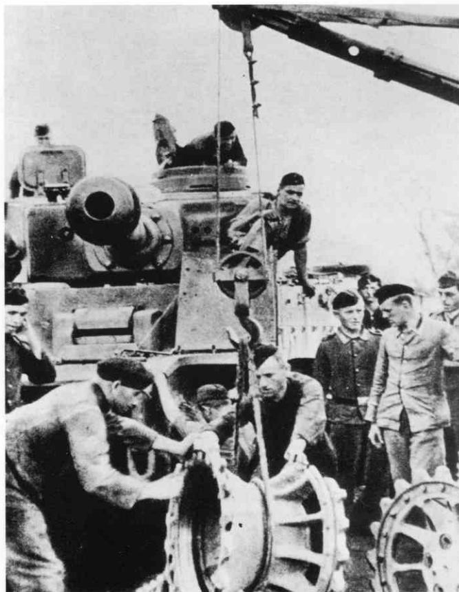
Naprawa przekładni bocznej czołgu PzKpfw VI „Tiger” Ausf. E. The repair of steering gearbox of a PzKpfw VI “Tiger” Ausf. E tank. [Tank Museum]
