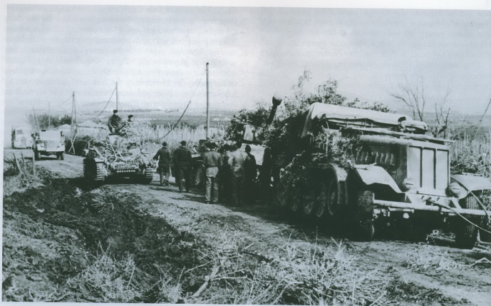
Ciągnik Sd Kfz 9 sZgkw 12ton wyciąga zagrzebany czołg PzKpfw VI Sd Kfz 181 Ausf. E „Tiger” z 3. kompanii 508. Batalionu Czołgów Ciężkich. A Sd Kfz 9 sZgkw 12ton tractor towing a bogged down PzKpfw VI Sd Kfz 181 Ausf. E “Tiger” tank from the 3rd Company 508th schwere Heeres Panzer Abteilung. [NAC]
