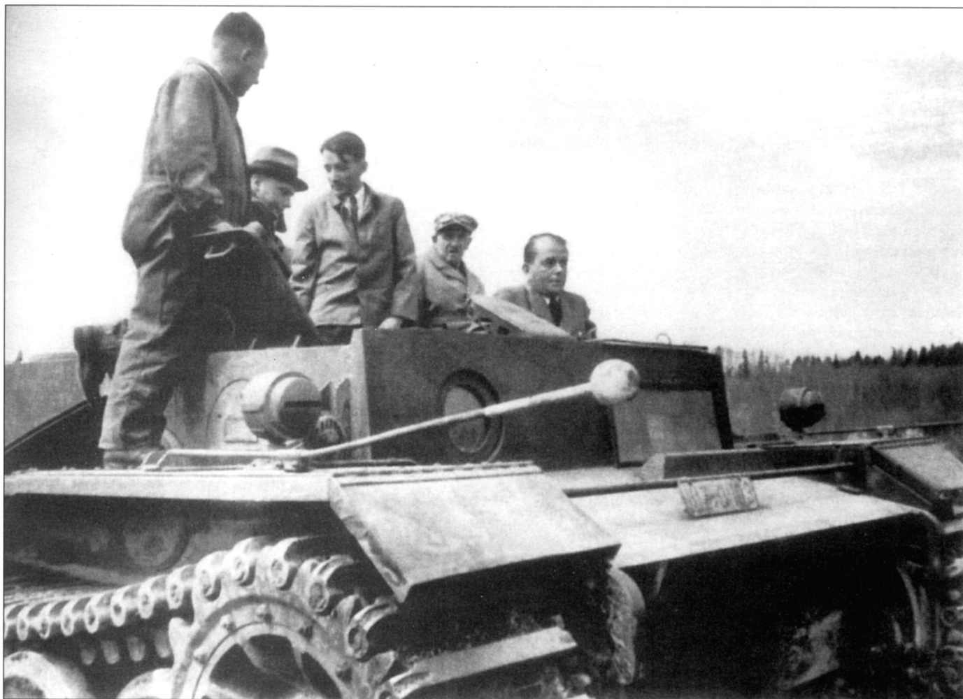
Еще один снимок прототипа VK3601 (H) во время испытаний под Фридрихсхафеном, на озере Констанс. Здесь опробовались различные виды трансмиссий, в частности - ZZG-77.
