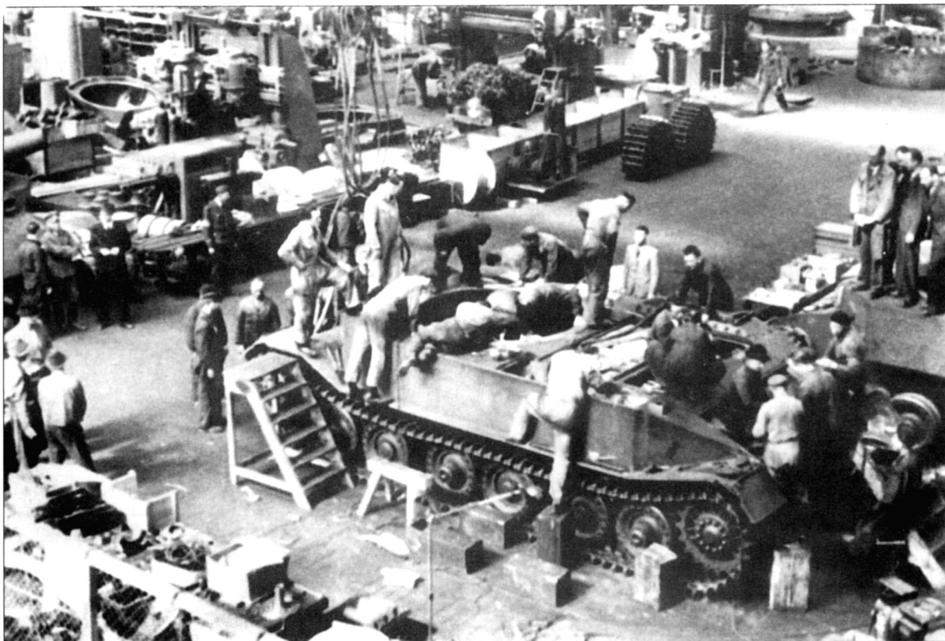
Сборка шасси прототипа танка VK4501 (P) Tiger в заводском цеху фирмы Нибелунгенверке.
