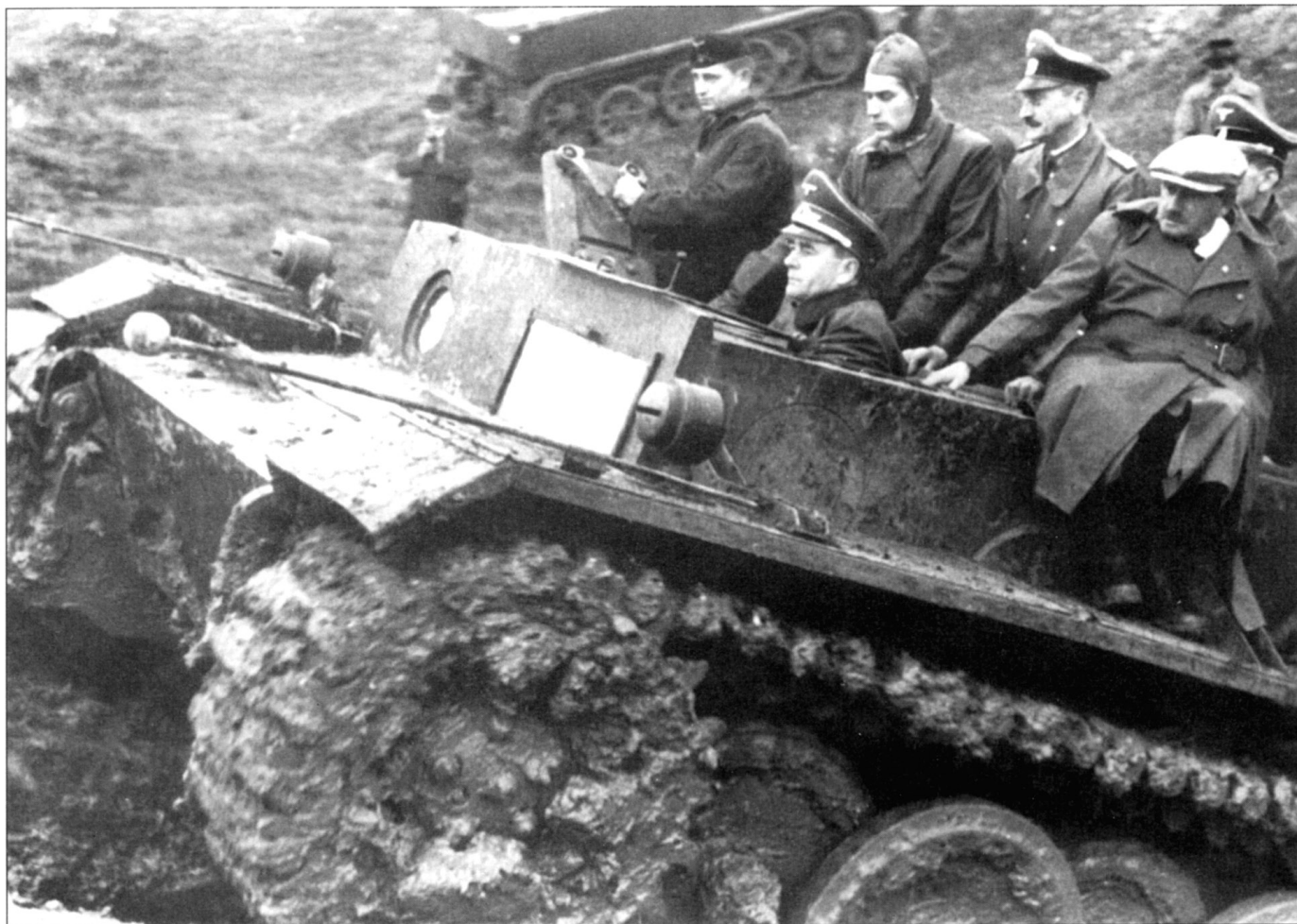
Прототип VK3601 (H), проверка на проходимость по размокнувшему грунту и пересеченной местности. Военный фуражке - министр вооружений Альберт Шпеер. Обратите внимание на закрытые плексиглазом проемы в лобовом бронелисте корпуса, один - под люк механика-водителя, второй - под шаровую установку курсового пулемета.
