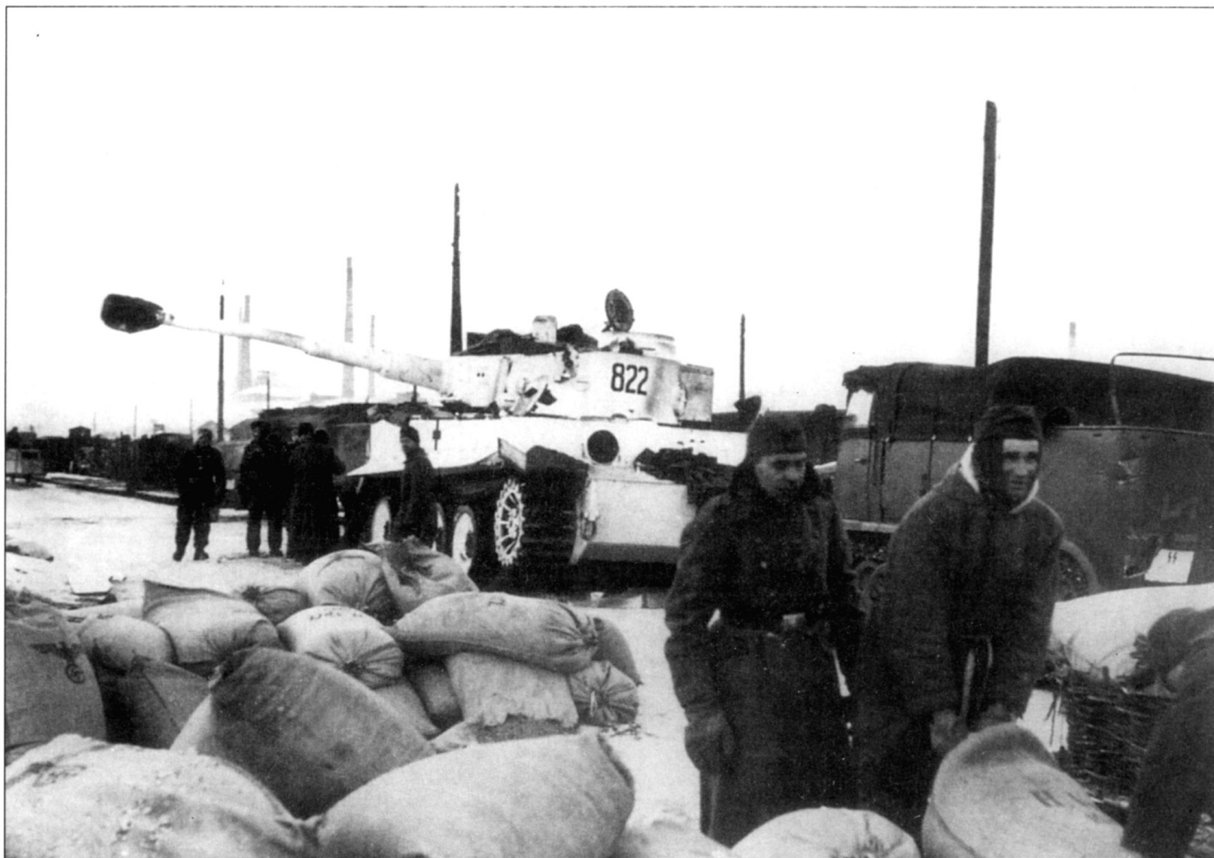
Один из «Тигров» из 8-й танковой роты schwere SS-Panzer Regiment 2 панцергренадерской дивизии СС «Дас Рейх», 1-2 февраля 1943 г., Харьков. Бросаются в глаза узкие транспортные гусеницы. Дульный тормоз закрыт брезентовым чехлом, а шаровая установка курсового пулемета - резиновой заглушкой, которая вообще-то должна использоваться при преодолении глубоких бродов. Танк целиком окрашен в белый цвет. Tактический номер «822» красного цвета (2-й танк 2-го взвода 8-й роты). Перед танком - артиллерийский тягач Sd.Kfz. 111, на номерной табличке тягача видна эмблема дивизии СС «Дас Рейх».
