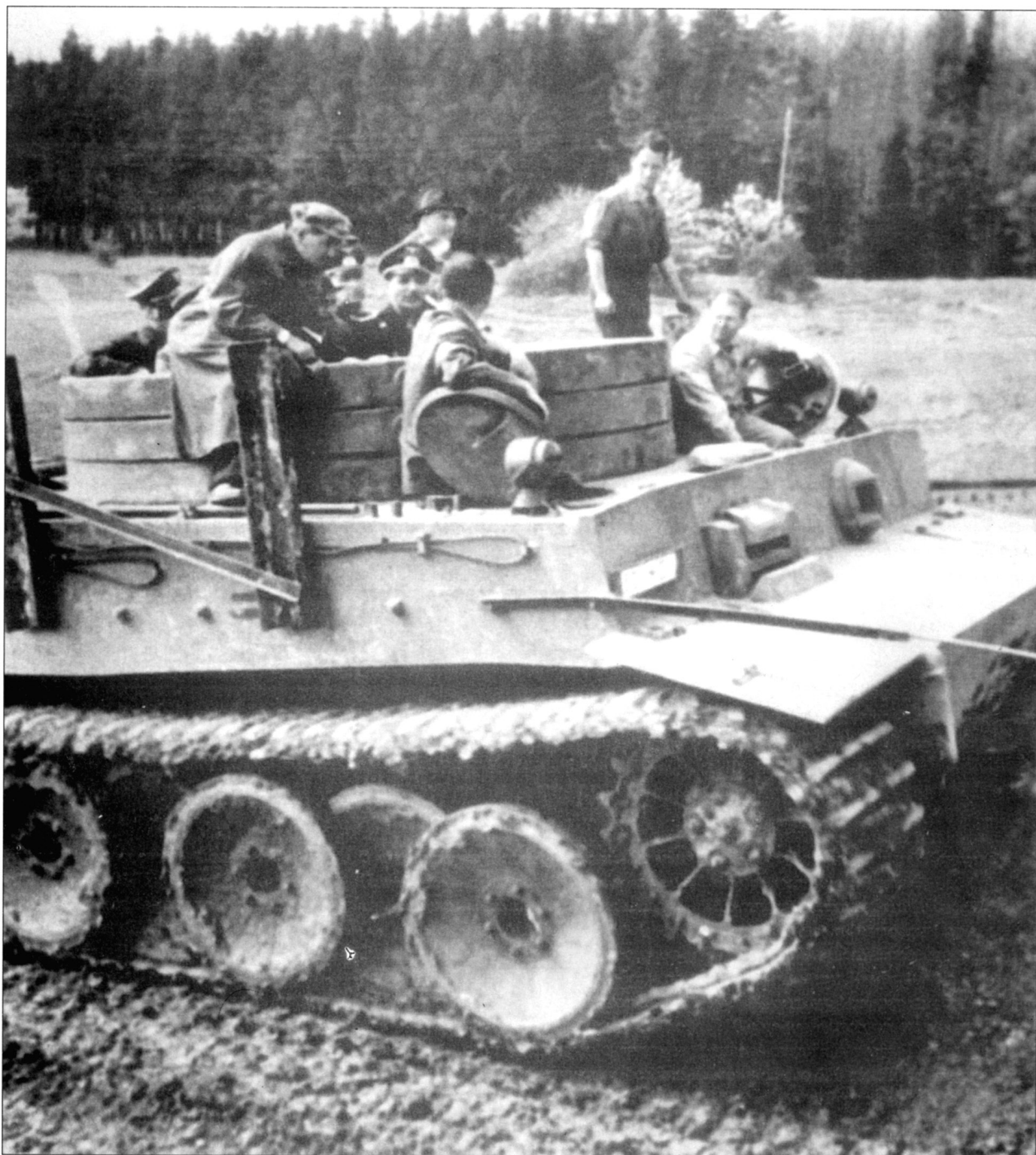
Шасси танка Pz.Kpfw. VI Ausf. H1 (номер шасси вероятно 250019) на испытаниях электротрансмиссии фирмы Zahnradfabrik из Фридрихсхафена. Вместо башни уложены бетонные кольца - весовые имитаторы башни. Узлы навески крыльев на борту корпуса впервые появились на последних машинах второго десятка серийных «Тигре».
