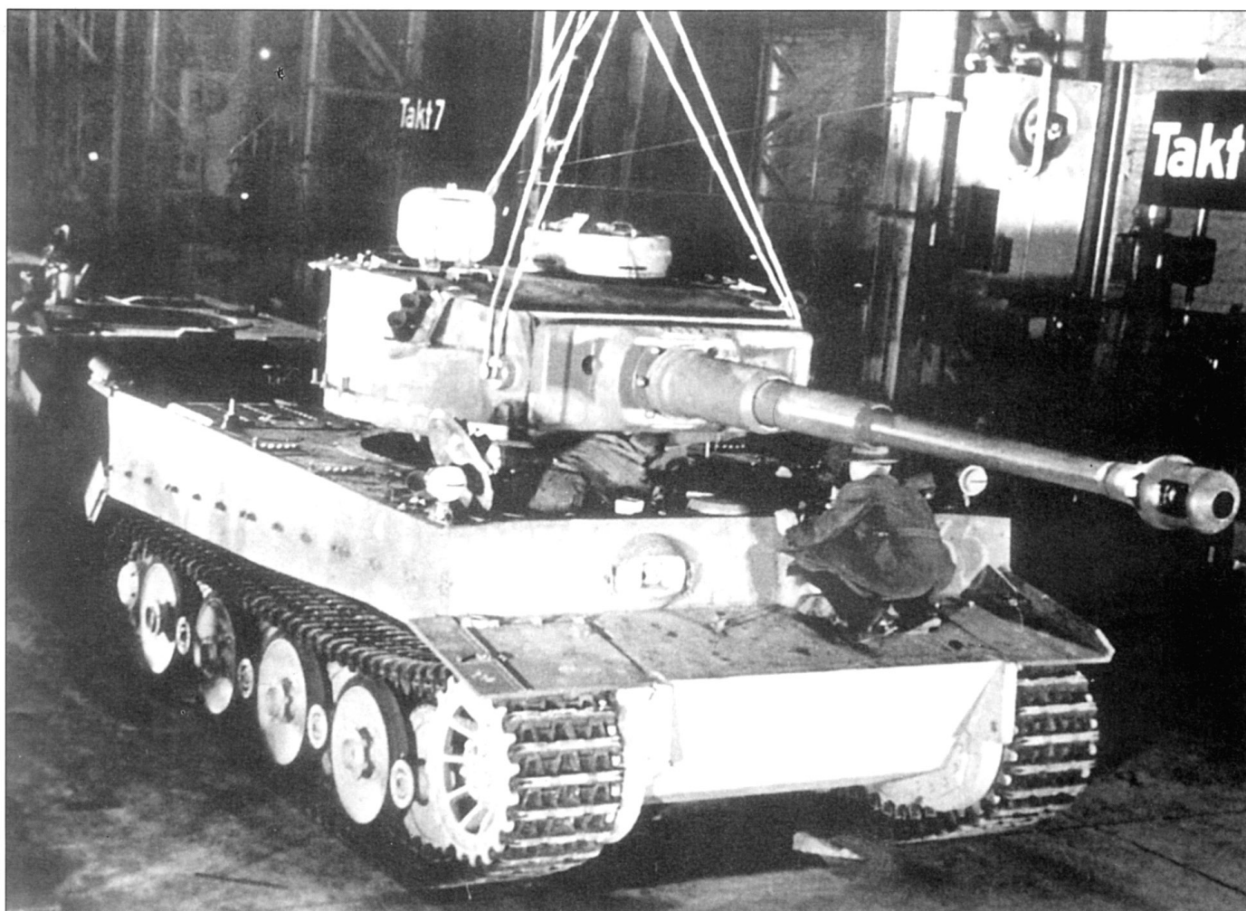
Окончательная сборка тяжелых танков «Тигр» велась на заводе фирмы Вегманн. Данный снимок сделан в 1943 г. Корпус и башня полностью окрашены в темно-зеленый цвет. Обратите внимание на снятый внешний ряд опорных катков и узкие транспортные гусеницы. Башни с серийными номерами с 184 по 286 оснащались дымовыми гранатомерами и не имели эпископов заряжающего. На снимке - одна из этих башен.
