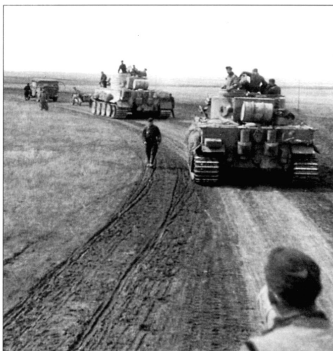
«Тигры» из 503-го тяжелого танкового батальона на пути к Мариуполю. На крыше моторного отделения каждого танка закреплена 200-литровая бочка с бензином. Снимок сделан 11 апреля 1943 г. Обратите внимание на отсутствие кожухов на выхлопных патрубках и фильтров Feifel.
