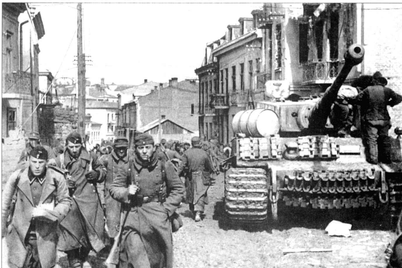
Малый запас хода «Тигра» приводил к тому, что экипажи старались возить с собой бензина как можно больше. Бочки крепились впереди танка...
