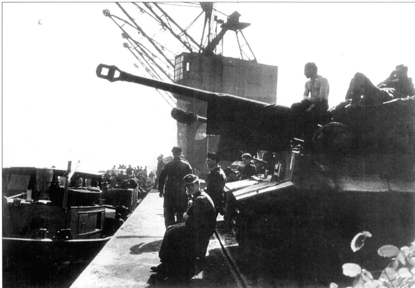
Экипажи и танки («Тигры» раннего выпуска) ожидают начала погрузки на транспортные суда. На танки установлены транспортные гусеницы, внешние опорные катки сняты.
