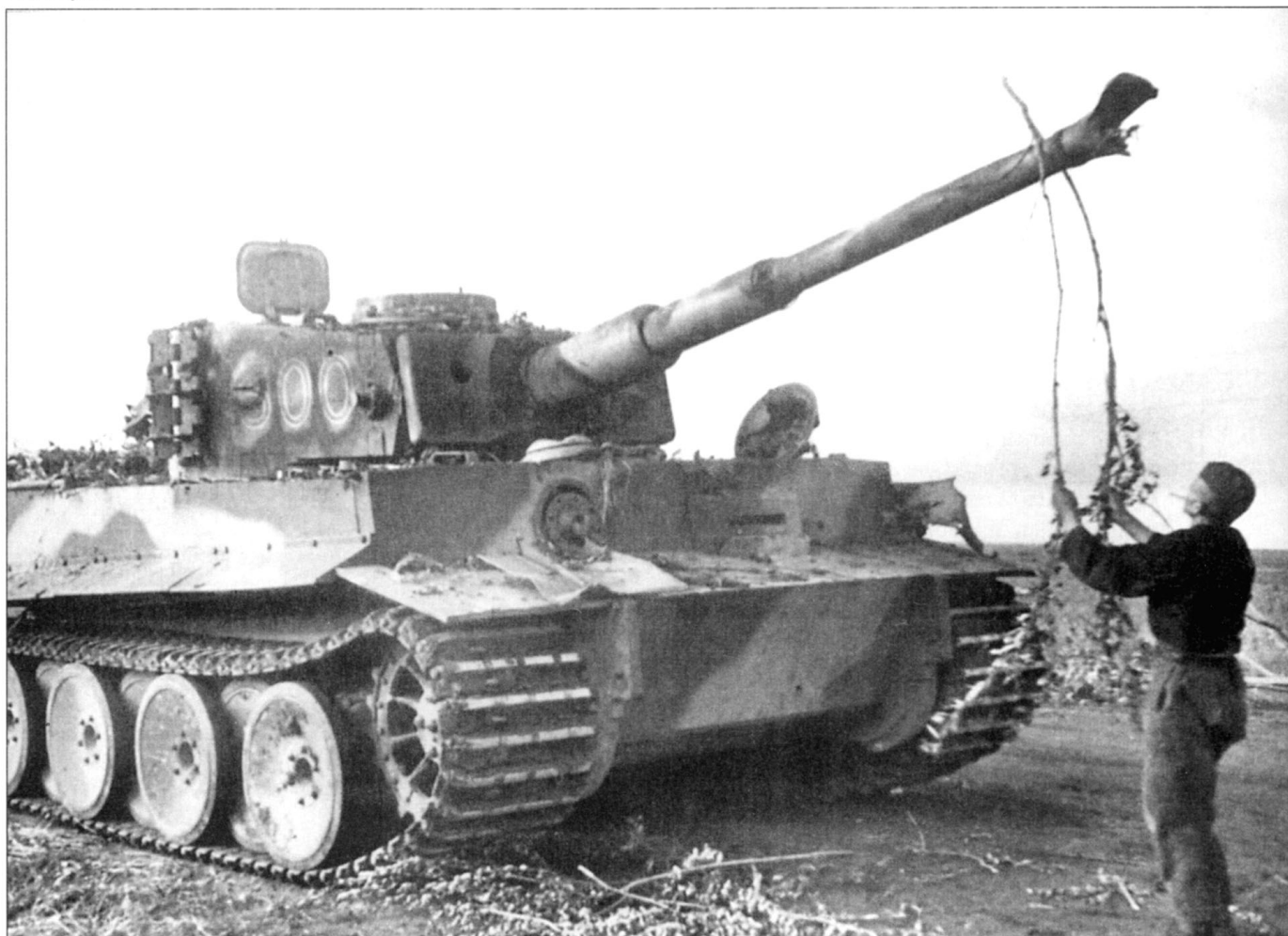
«Тигр» командира 3-й роты 505-го тяжелого танкового батальона. Машину пришлось бросить, так как не нашлось тягачей подходящей мощности. Экипаж постарался вывести машину из строя -поврежден дульный тормоз пушки, следы внутренней детонации заметны на маске курсового пулемета. Дульный тормоз выведен из строя простым способом: из откатника было слито масло, а затем из пушки произведен выстрел. Дульный тормоз при выстреле разрушился. Обратите внимание на интересный рисунок камуфляжа, летом 1943 г. характерный для «Тигров» 505-го батальона.
