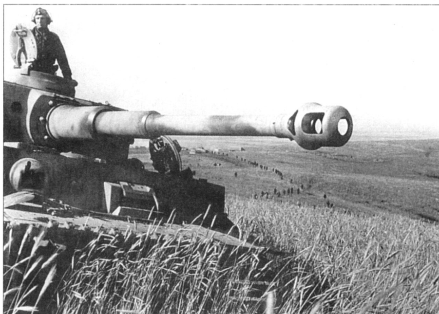
«Тигр» на огневой позиции. Крупный план ствола пушки и дульного тормоза.
