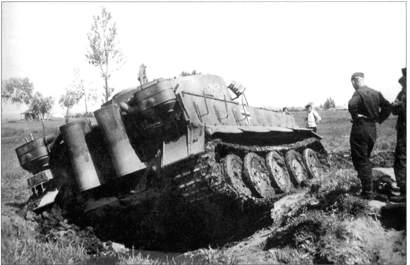
«Тигр» из 3-го взвода 3-й роты 503-го тяжелого танкового батальона. Машина прочно застряла. Это танк раннего выпуска: на башне смонтированы гранатометы, в кормовой части башни видны фильтры Feifel. К правому борту корпуса приварены скобы для хранения бревен. Бревна далеко не всегда помогли «Тигры» выбраться из грязи - тут нужен еще один «Тигр» или пара-тройка мощных тягачей.
