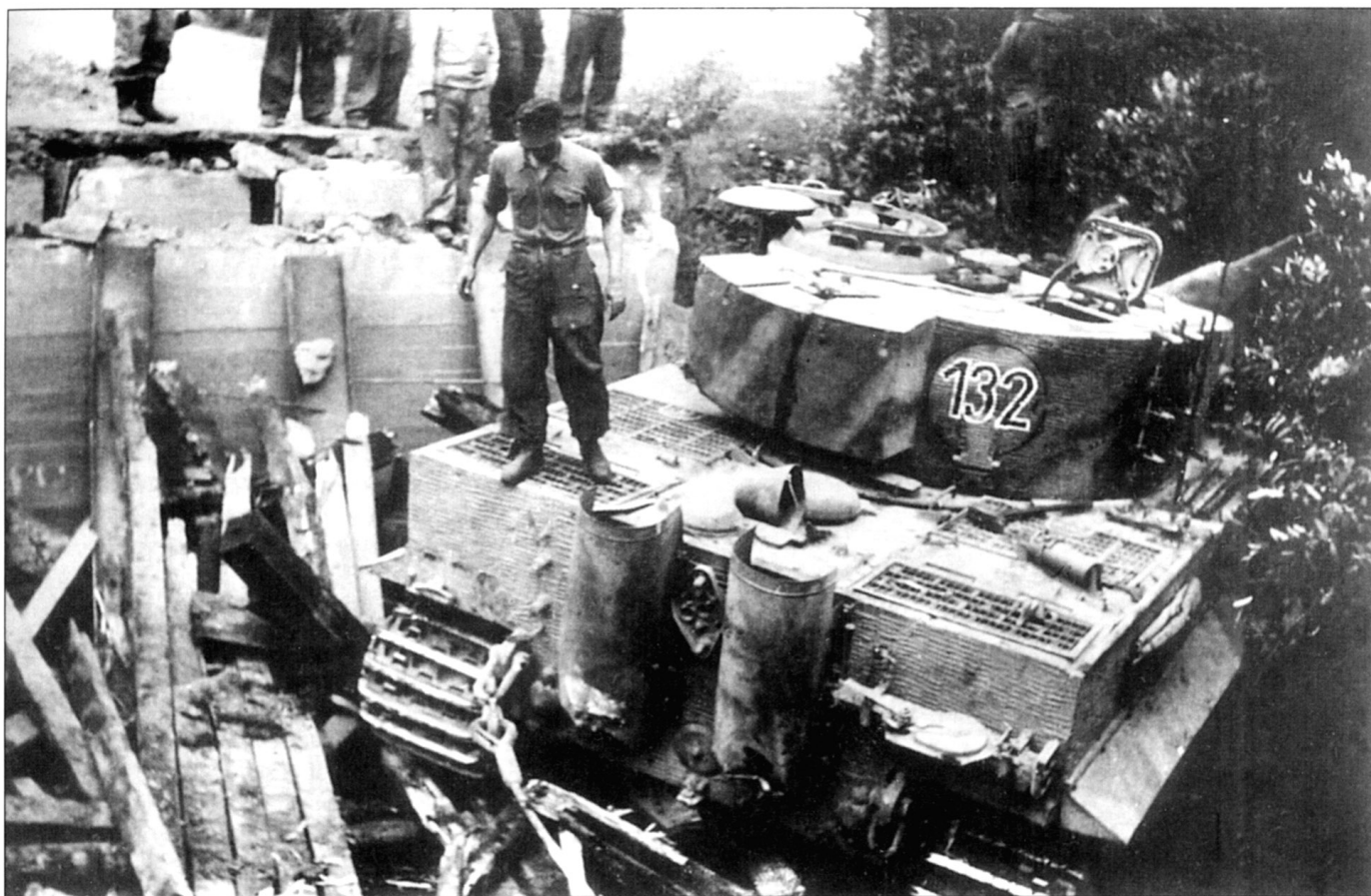
Типичная картина - «Тигр» продавил мост. Танк принадлежит 3-му взводу 1-й роты 503-го тяжелого танкового батальона. Башня - позднего выпуска: литая командирская башенка со сдвижным люком, изменено место установки колпака вентилятора, установлена мортирка для самообороны и эпископ заряжающего. Корпус, наоборот, ранней постройки. Танк оснащен двигателем HL-210 P-30 - хорошо виден узел для крепления инерционного стартера между кожухами выхлопных патрубков. Фильтры Feifel сняты. Корпус и башня покрыты циммеритом.
