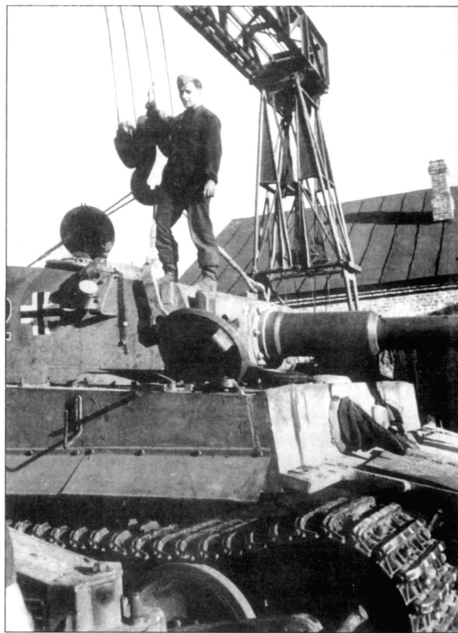
Установка башни на «Тигр» в плевых ремонтных мастерских с помощью крана Freise грузоподъемностью 15 т. Обратите внимание на установленные «уши» для монтажных работ с башней.
