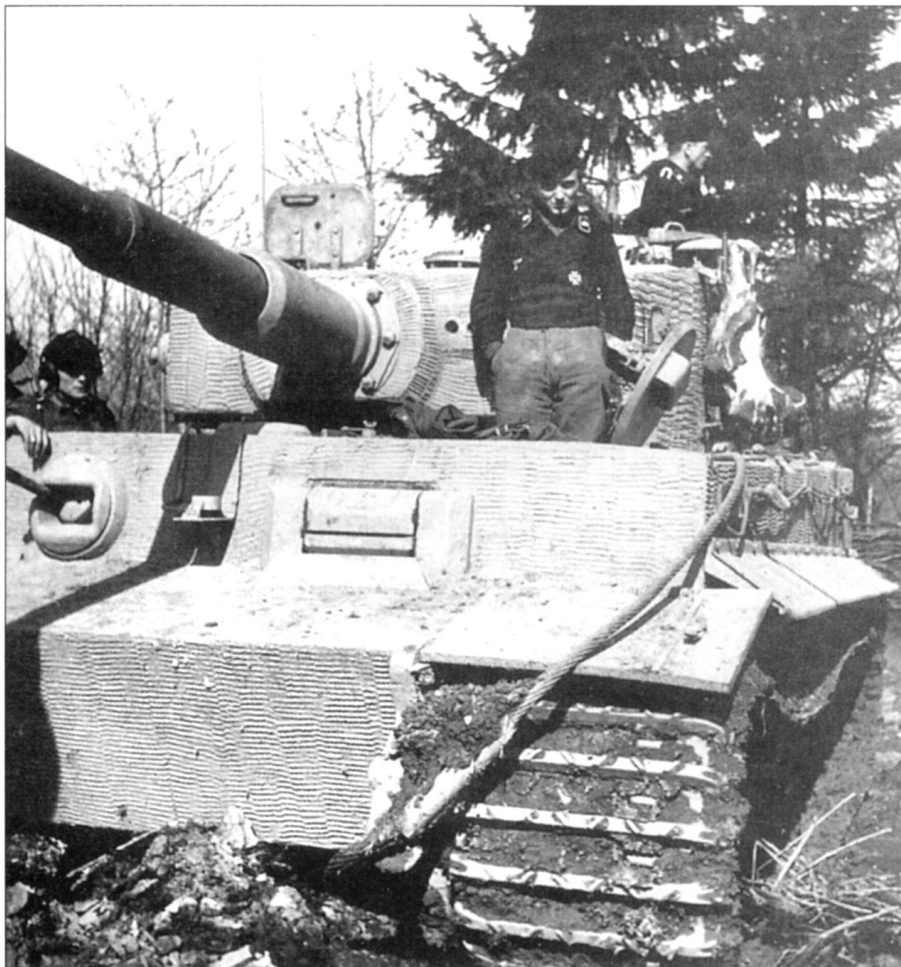
Экипажи и танки («Тигры» раннего выпуска) ожидают начала погрузки на транспортные суда. На танки установлены транспортные гусеницы, внешние опорные катки сняты.
