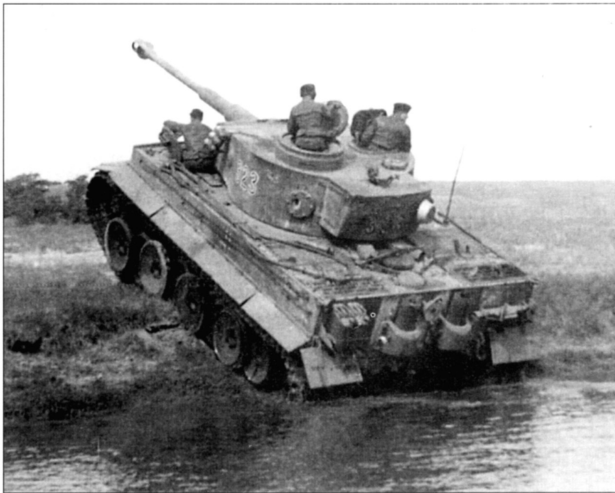
«Тигр» из 2-го взвода 3-й роты 503-го тяжелого танкового батальона. Снимок сделан за несколько недель до начала операции «Цитадель». Сняты фильтры Feifel и кожухи с выхлопных патрубков.
