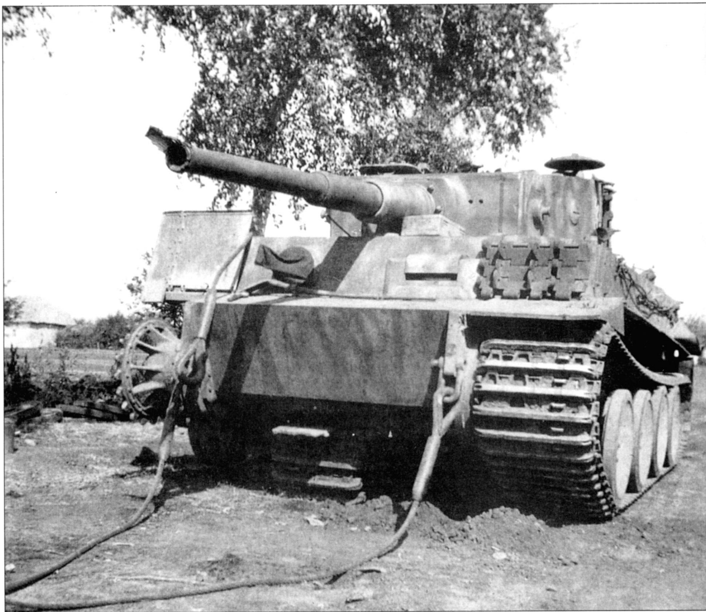
Этот поврежденный «Тигр» удалось вытащить с поля боя в августе 1943 г. Ствол пушки оторвало скорее всего из-за технологического дефекта, допущенного при изготовлении орудия. Башня - старой модели, но прошедшая модернизацию: сняты кронштейны для гранатометов, установлена литая командирская башенка нового образца и новый люк. На снимке хорошо видна внутренняя часть ведущего колеса.
