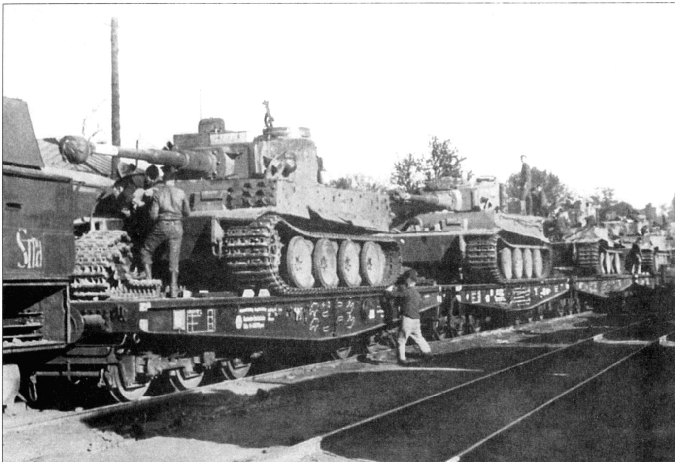
Сложно, но можно - перевозка «Тигров» по железной дороге в «боевом» варианте», с широкими гусеницами и внешними опорными катками. На переднем «Тигре» все-таки одеты узкие гусеницы, но внешний ряд опорных катков оставлен. Скорее всего, просто не было времени на подготовку танков к перевозке.
