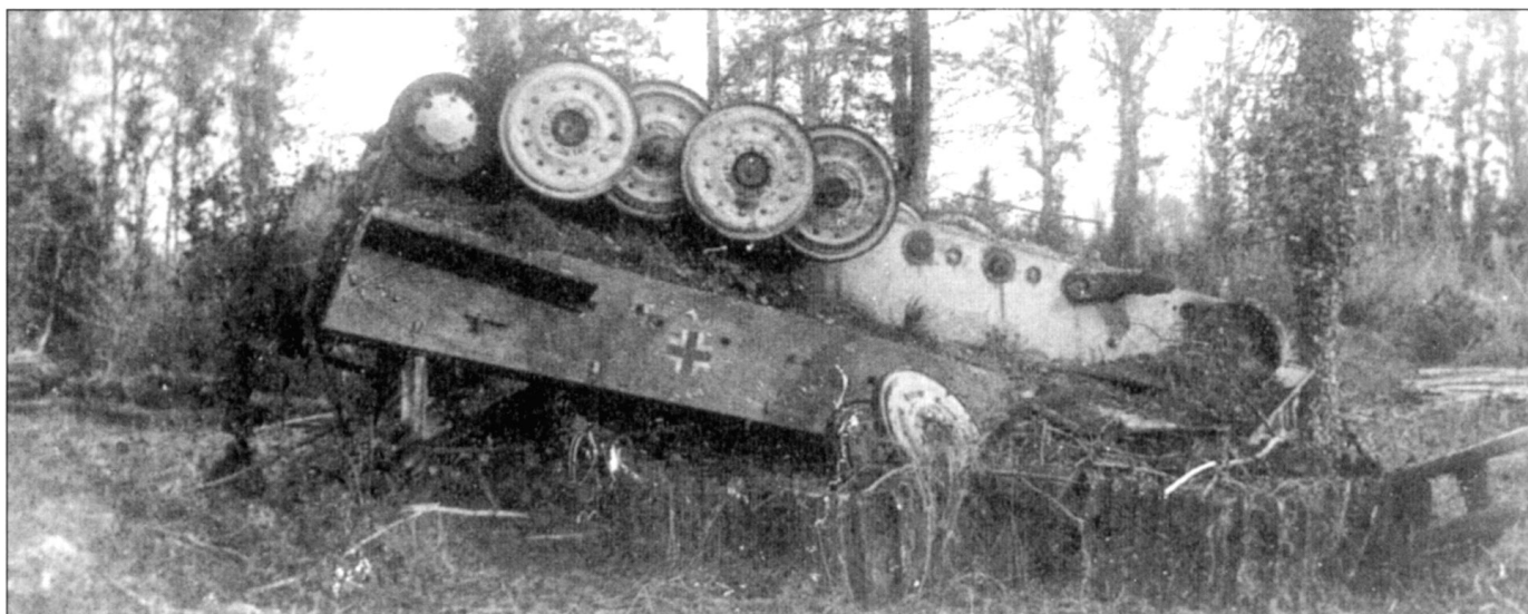
Еще одна фотография перевернутого взрывом бомбы «Тигра» с бортовым номером «313». Обратите внимание на сбитые взрывной волной опорные катки.
