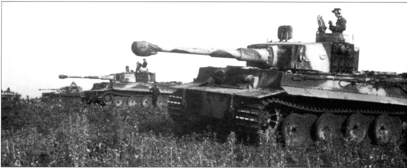
Снимок сделан через несколько дней после начала операции «Цитадель», «тигры» заняли исходную позицию для атаки. На переднем плане - танки с бортовыми номерами «321» и «323». Камуфляжная окраска танка представляет собой полосы красно-коричневого цвета, нанесенные поверх базовой песочно-желтой окраски. Чаще всего эмблема батальона изображалась в левой части вертикального лобового бронелиста со стороны механика-водителя. В период проведения операции «Цитадель» «Тигры» 505-го тяжелого танкового батальона в районе высоты 274,5 уничтожили порядка 60 советских танков, собственные потери батальона составили пять танков.
