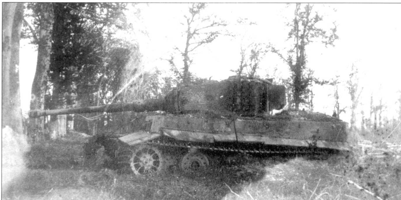
Танк «Тигр» с бортовым номером «322», бортовой номер позже был изменен на «222». На вооружении 1-й роты 503-го тяжелого танкового батальона находились как танки «Тигр I», так и - «Тигр II». В отличие от танков других тяжелых батальонов, «Тигры» s.Pz.Abt.-503 не имели запасных гусеничных траков на вертикальном лобовом бронелисте корпуса.
