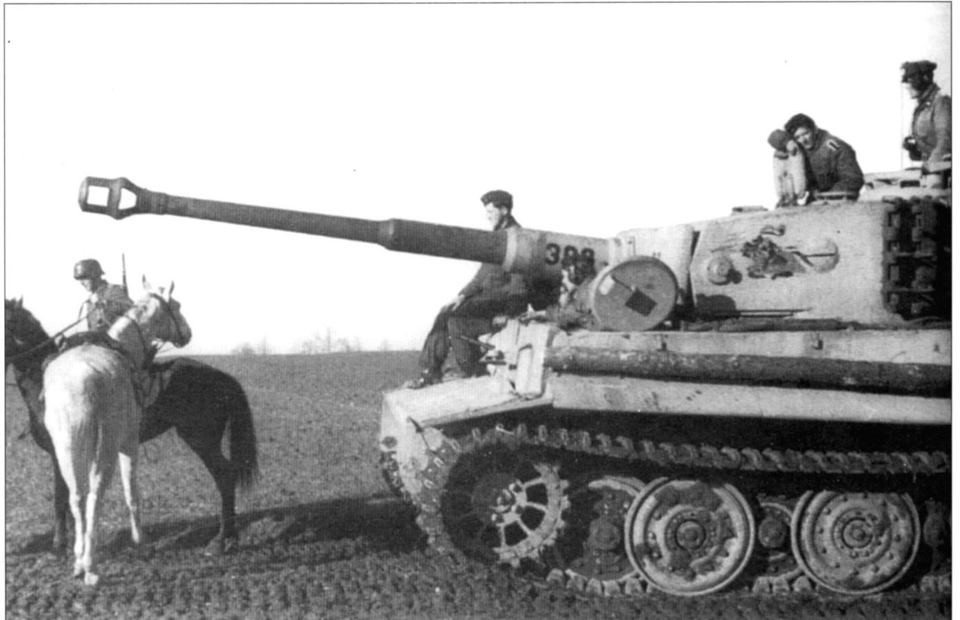
Танкисты из 505-го тяжелого танкового батальона сфотографированы у танка «Тигр» с бортовым номером «300». Танком командовал лейтенант Рёдер (стоит в командирском люке). На борту корпуса укреплены тросы и бревно, на борту башины - гусеничные траки. С осени 1943 г. бортовые номера стали наносить на стволы орудий, сначала прямо на базовую окраску, затем, с весны 1944 г. для лучшей идентификации - на ярко-желтый фон. В передней части борта башины изображался конный рыцарь - эмблема s.Pz.-Abt. 505.
