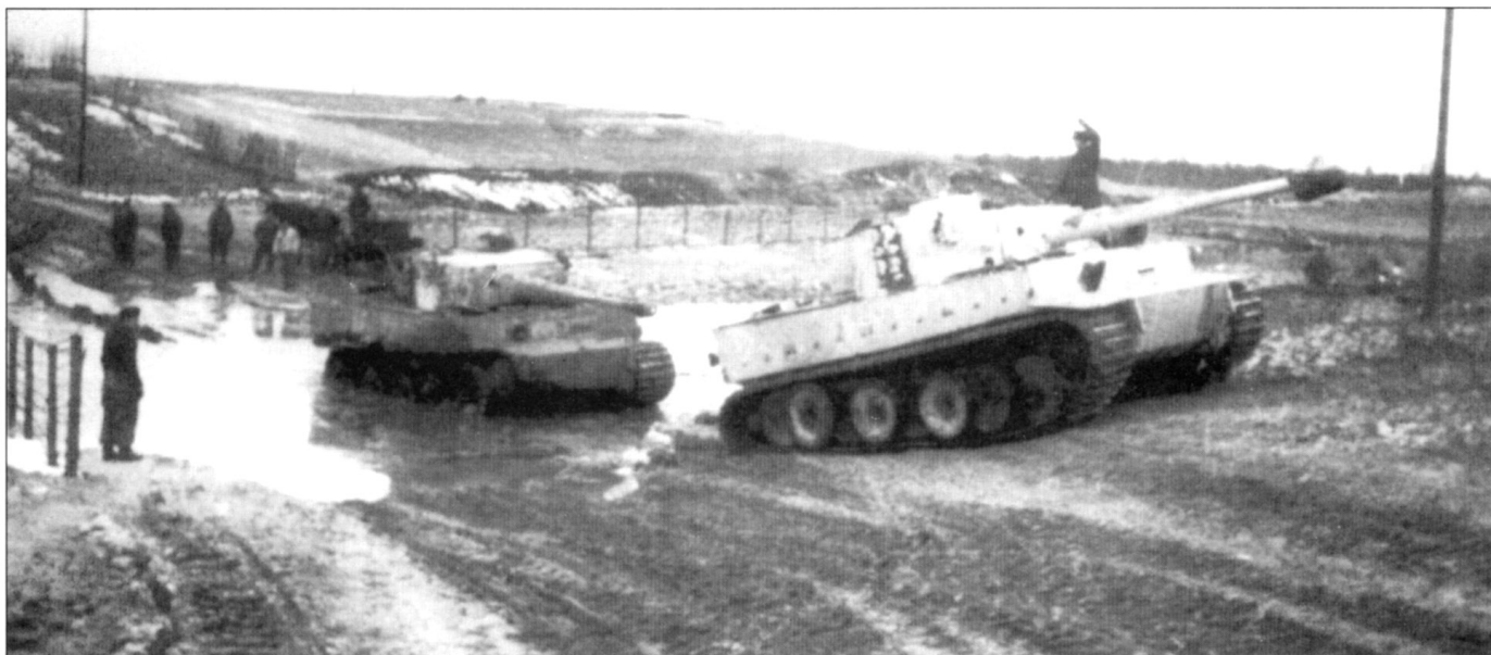
Еще один снимок, отображающий вытаскивание из российской «дороги» одного «Тигра» другим. Танки уже перекрашены в белый зимний цвет.
