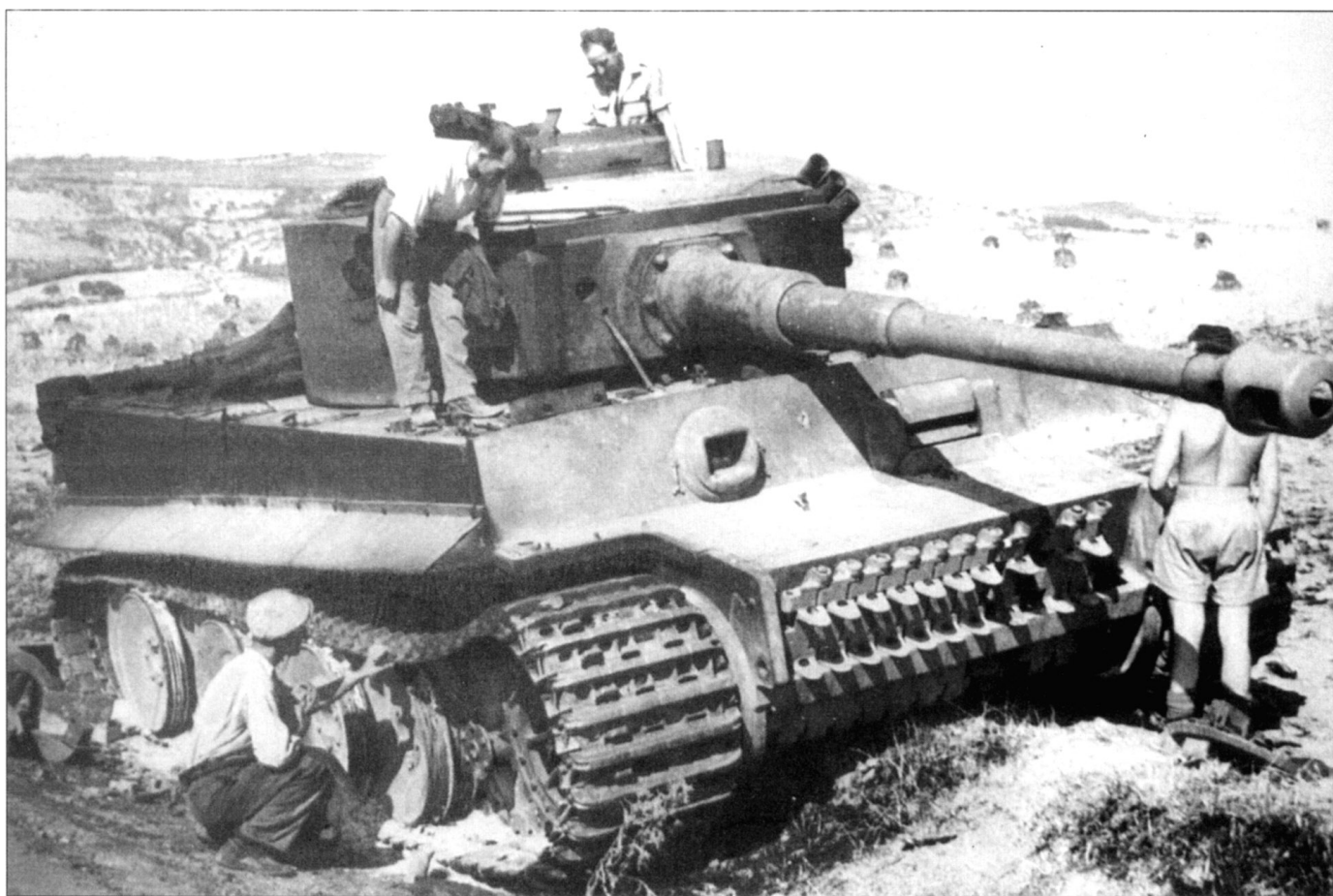
Подбитый в районе Милителло, Сицилия, танк «Тигр». Снимок датирован 19 июля 1943 г., однако «Тигр» подбит 12-го числа. Видимых повреждений машина не имеет. Машина оснащена воздушными фильтрами Feiffel. Запасные гусеничные траки укреплены на нижнем лобовом бронелисте. Отдельные с позволения сказать «эксперты» критикуют такое размещение траков, однако они обеспечивали дополнительную защиту довольно уязвимой части танка.
