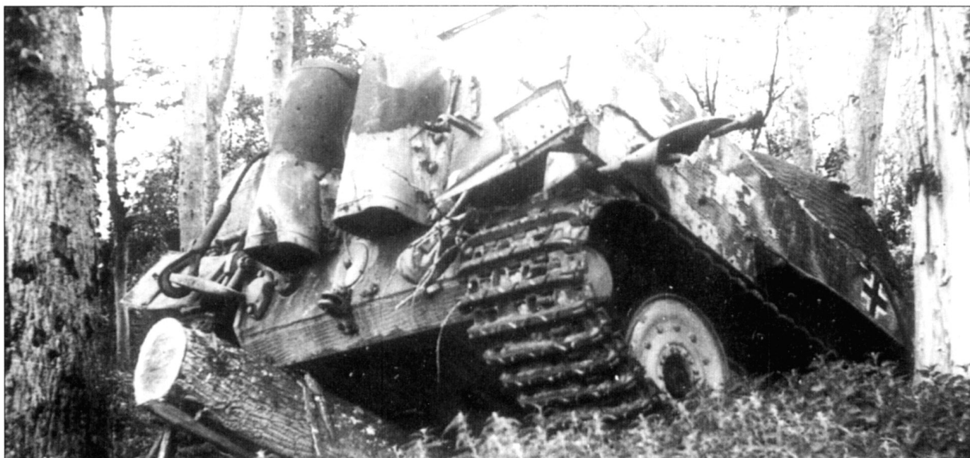
Вид сзади на танк «Тигр» с бортовым номером «213». Экипаже выбрал рискованную позицию: если танк свалиться в низину, то вытащить его оттуда будет непросто. На всякий случай под корпус подсунуто мощное бревно.
