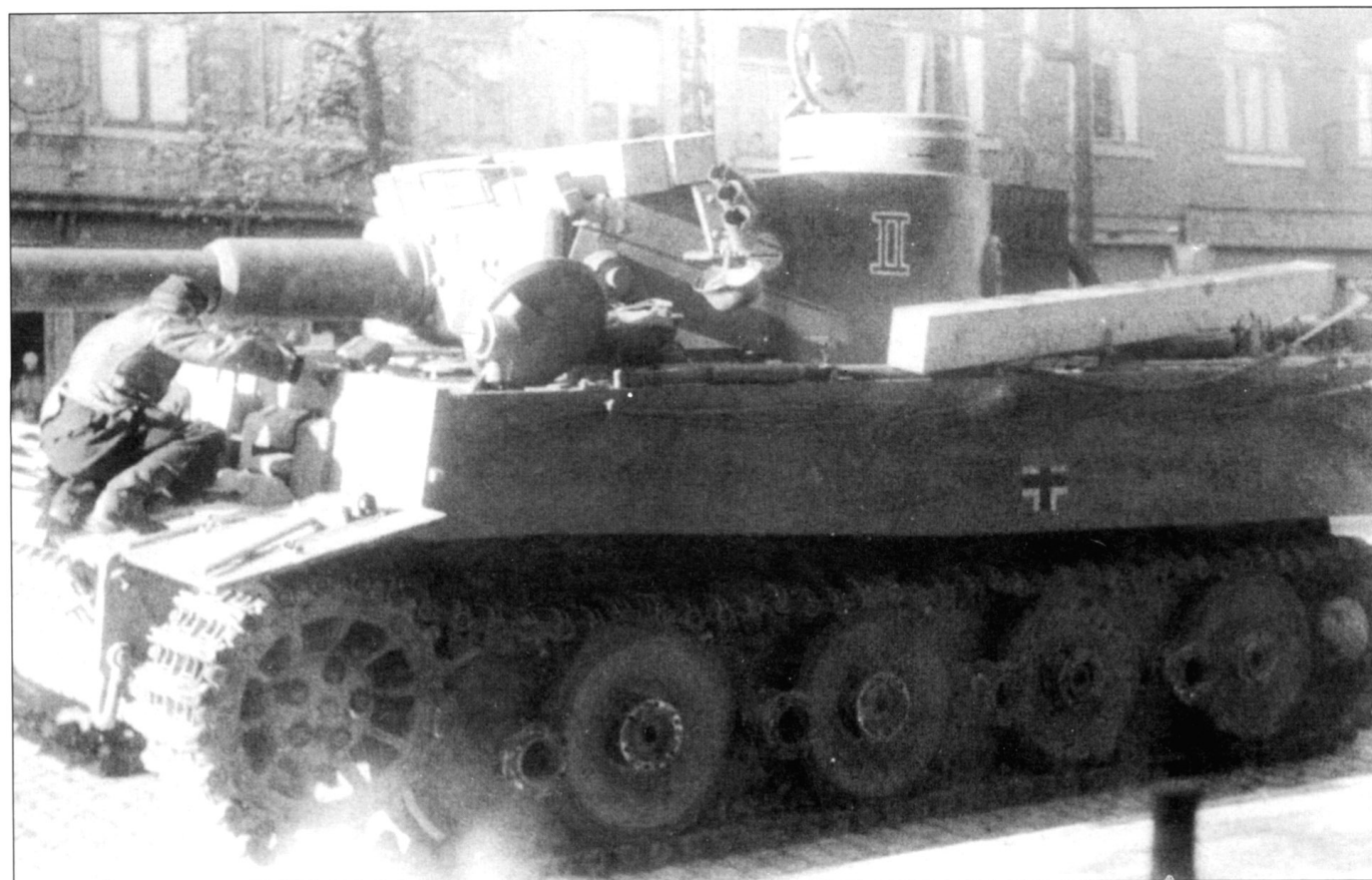
«Тигр» с бортовым номером «II» принадлежал штабу 505-го тяжелого танкового батальона. Снимок сделан 1 мая 1943 г. в Бельгии. На танк одеты транспортные гусеницы.
