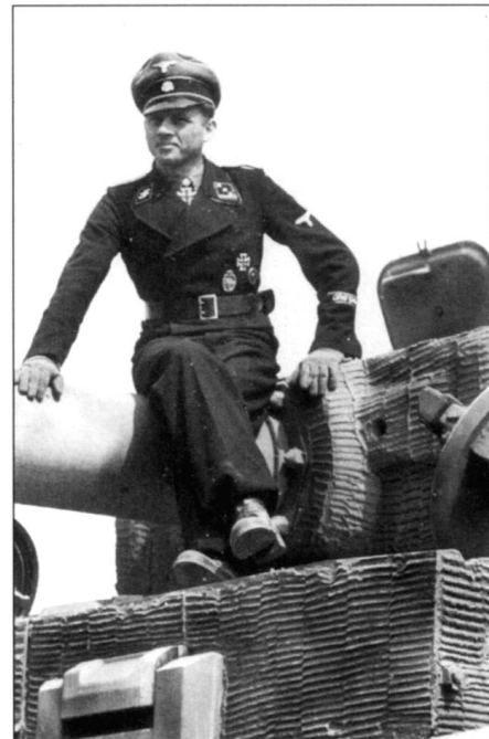
Классический пропагандистский снимок Михаэля Витмана. В данном случае не меньший, чем Витман, интерес представляет циммерит, фактура которого прекрасна видна.
