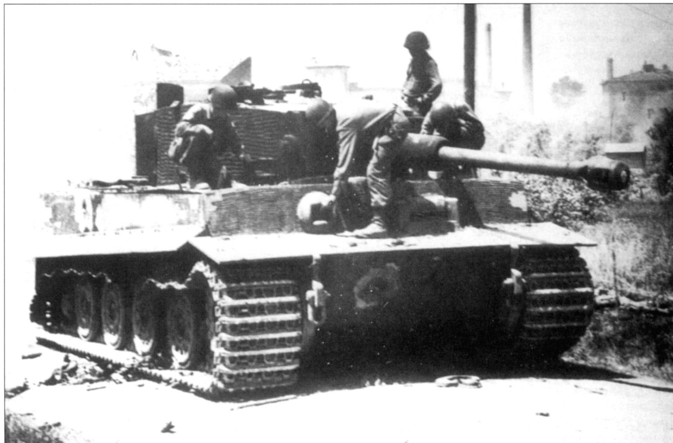
Район Цесины, 3 июля 1944 г. Вероятно этот «Тигр» был выведен из строя в бою 1 июня 1944 г. Обратите внимание на дырцу в нижнем бронелисте корпуса.
