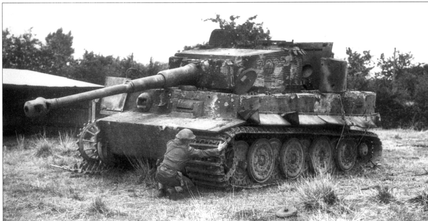
Снимок сделан канадскими солдатами 30 августа 1944 г. «Тигр» с тактическим номером «223» был брошен экипажем из-за разорванной правой гусеницы 25 августа в нескольких километрах от Сены.
