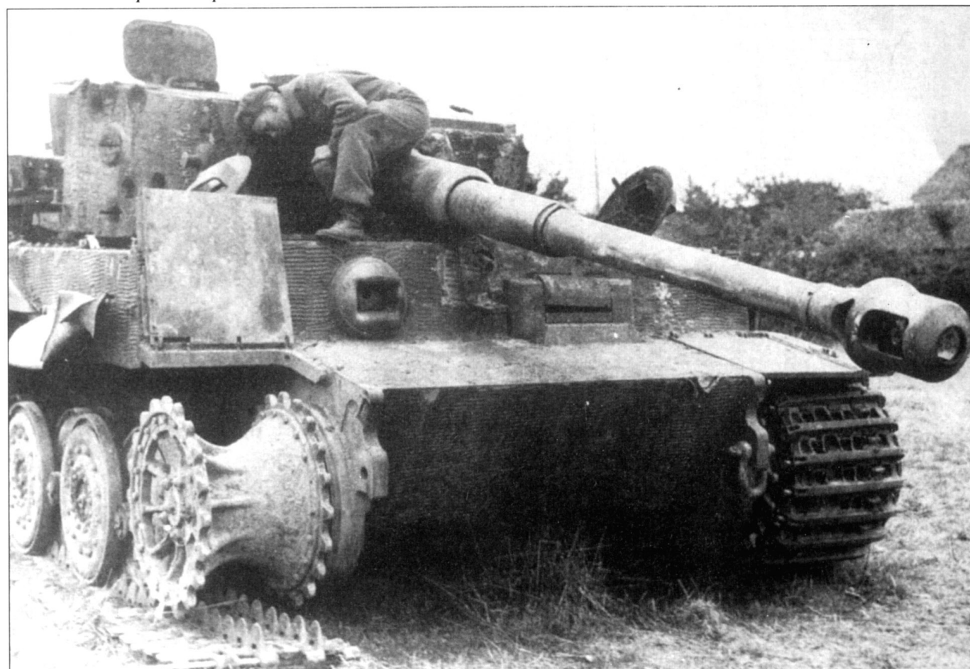
В этот «Тигр» из 2-й роты попало несколько снарядов. Обратите внимание - из пробоины в вертикальном лобовом бронелисте корпуса (непосредственно ниже ствола орудия) торчит неразорвавшийся снаряд.
