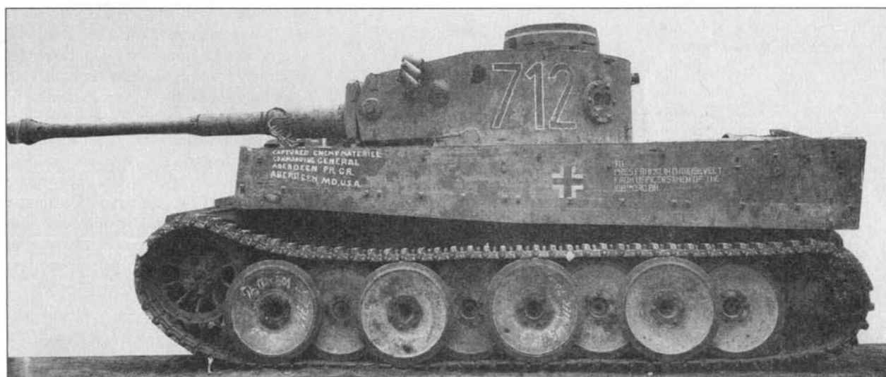
Общий вид танка «Тигр» «712», захваченного в Северной Африке и испытанного союзниками в 1943 году. Все навесное оборудование демонтировано. Над смотровым прибором механика-водителя виднеется эмблема 501-го батальона тяжелых танков - крадущийся тигр.
