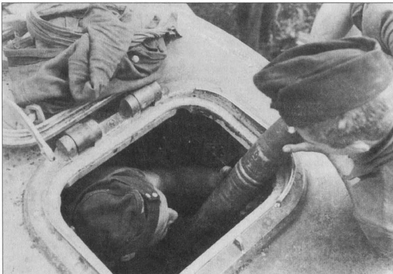
Погрузка боеприпасов в танк через люк заряжающего
