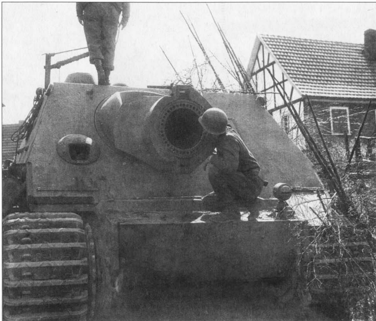
Еще один захваченный американцами «Штурмтигр». Машина не обработана циммеритом, имеет дополнительную лобовую бронеплиту, хорошо виден противовес на дульном срезе ствола ракетомета.
