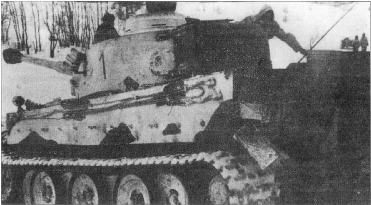
«Тигр» из 502-го батальона, зима 1942-43. Первые полученные батальоном танки отличались отсутствием «юбки» по бортам корпуса.
