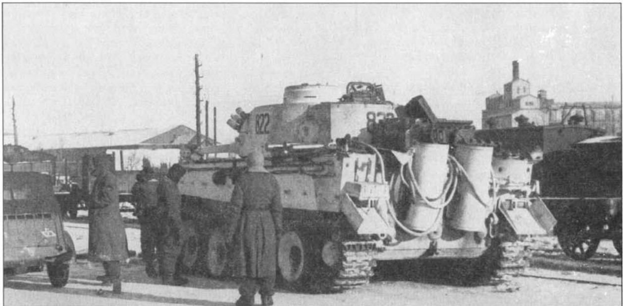
Танкисты дивизии СС «Дас Рейх» получают новые танки. Рота «Тигров» входила в состав одноименного танкового полка дивизии. «Тигры» роты принимали участие в боях за Харьков и в операции «Цитадель». Обратите внимание, что воздушные фильтры на танки уже не ставятся.
