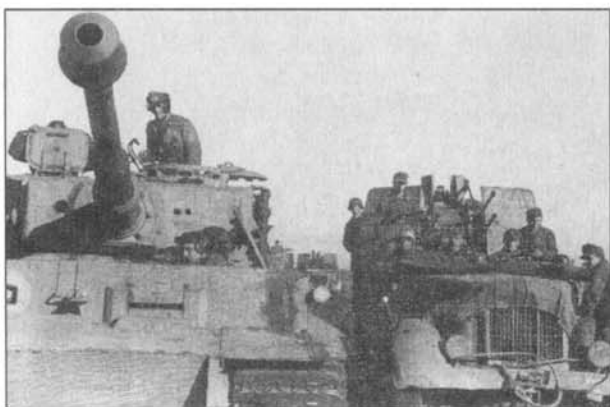
«Тигр» из 505 батальона. В апреле 1944 года батальон получил новые танки - машины поздних серий с катками без резинового бандажка. Справа от танка - счетверенная зенитка на полугусеничном шасси.
