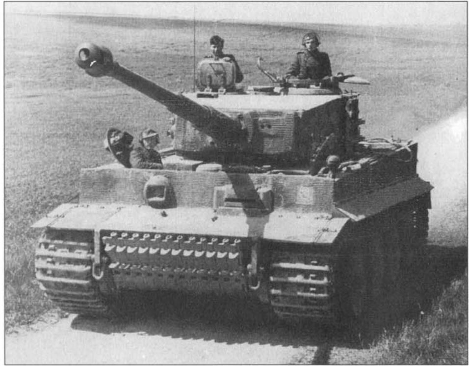
Во время серийного производства «Тигр» менялся не сильно. На снимке изображен танк 101-го батальона СС, Нормандия, 1944 г. Машина - средних серий с новой командирской башенкой, старыми катками с резиновым бандажем, покрыта циммеритом.
