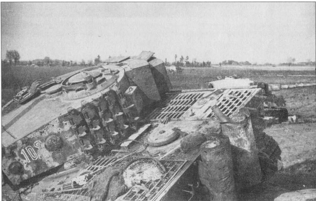
Подбитый «Тигр». Обратите внимание, что на забешенном ящике имеется еще один дополнительный отсек. Танк имеет множество пулевых отметин. На заднем плане - «Королевский тигр».
