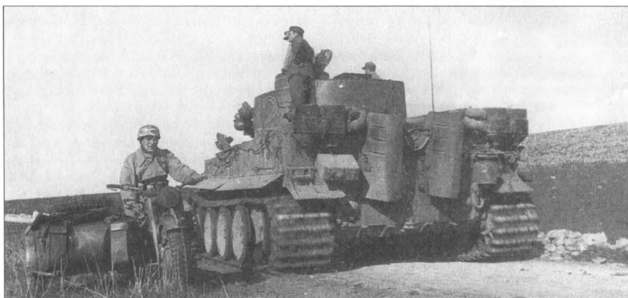
Два фото одного и того же танка - №142 из 501-го батальона, Тунис, 1942 г. Отличительными чертами «Тигров» этого батальона были фары, перенесенные на лобовую бронеплиту и кожухи выхлопных труб оригинальной формы. Передние крылья изогнуты - применялись на машинах, изготовленных до ноября 1942 г.
