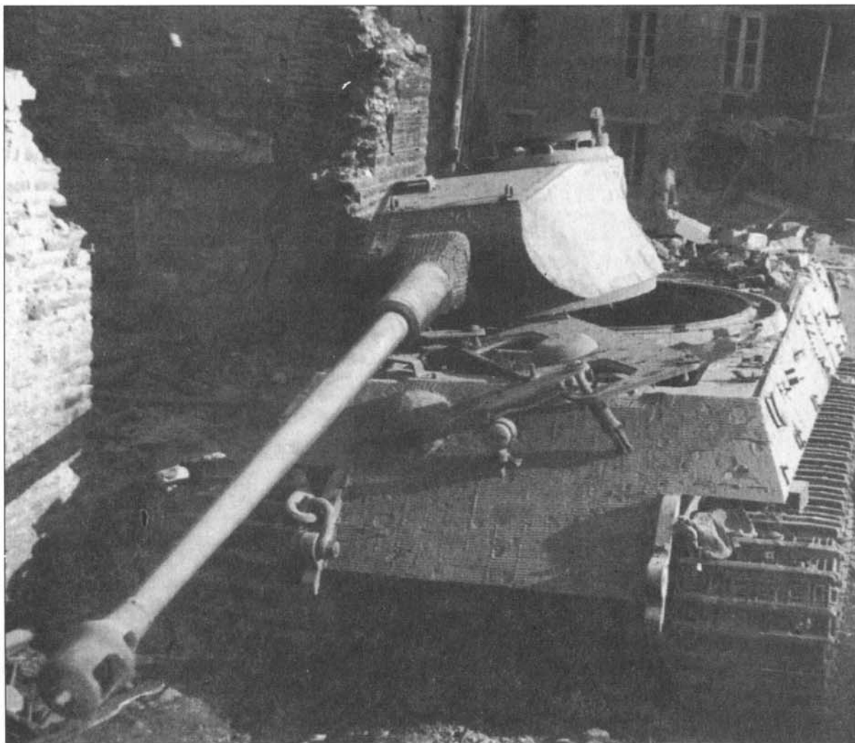
Уничтоженный «Королевский Тигр». Похоже что экипаж, отступая, сам взорвал свою машину, так как боевых повреждений нет. Много «Королевских Тиров» было потеряно из-за механических поломок, недостатка топлива и боеприпасов.
