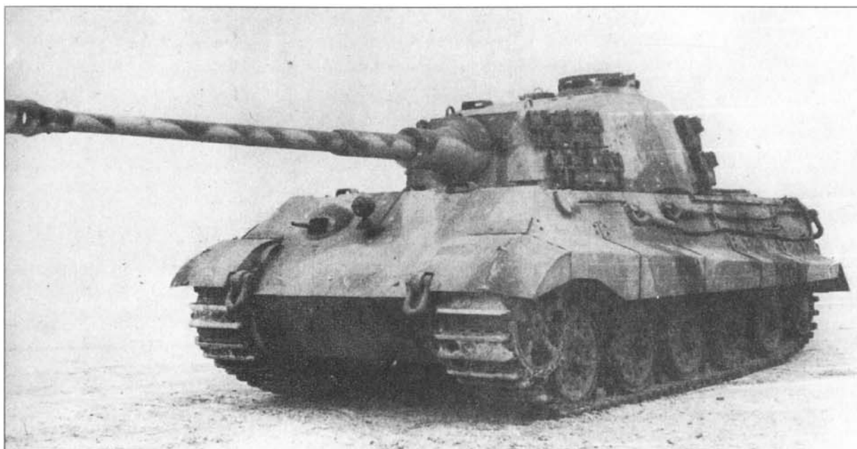
Типичный «Королевский Тигр» 1945-го года выпуска. Над отверстием для прицела - противодождевой козырек, камуфляжная окраска - засадная с мелкими пятнами.
