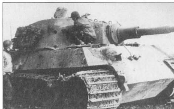
«Королевский Тигр», подбитый 90-мм пушкой американского истребителя танков М36. Один снаряд повредил ведущее колесо, второй разорвал гусеницу с правого борта, третий пробил борт башни.
