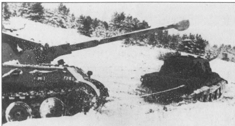
«Ягдтигр» тянет «Королевского Тигра» во время испытаний буксирных крюков на прочность и рациональность расположения.
