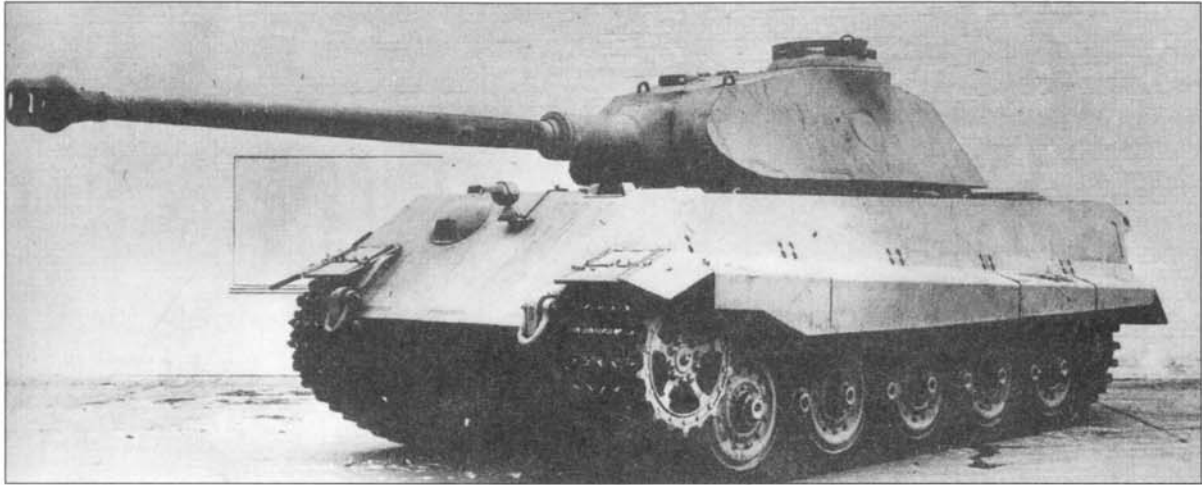
Прототип «Королевского Тигра» с башней Порше. Прямые передние крылья устанавливались только на первых трех машинах, следующие танки получили крылья округлой формы. Машина окрашена в желтый цвет и не несет циммеритного покрытия. Гусеницы - транспортные, орудие выполнено моноблоком, тогда как почти на всех серийных танках оно было составным.
