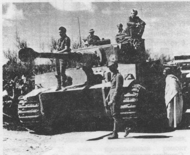
Танк 501-го sPzAbt, Тунис, 1942 г. Этот "Тигр" был придан 7-му полку 10-й танковой дивизии и активно использовался в боях, о чем красноречиво говорит полное отсутствие фар и бортовых экранов.
