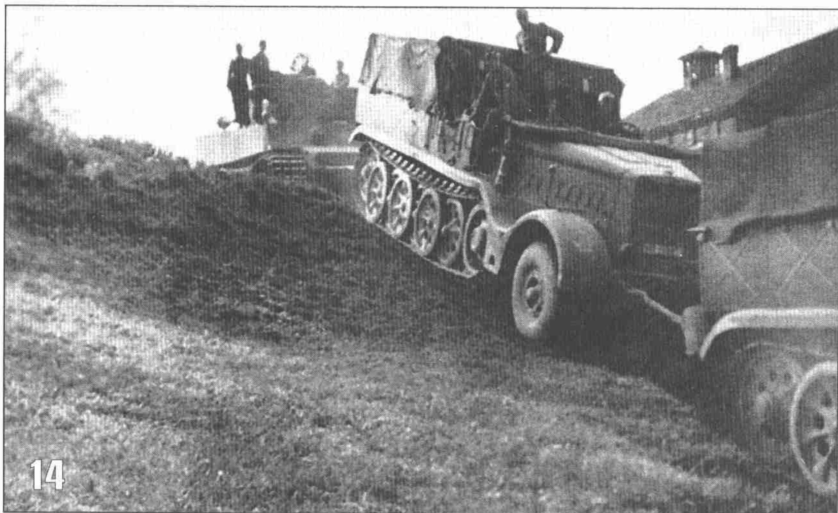
13, 14. Транспортировка «Тигра» (он же на фото 11) в тыл при помощи трех 18-тонных тягачей Sd. Kfz. 9. На крыле второго тягача (фото 14) видна эмблема sPzAbt 502 — белый мамонт.
