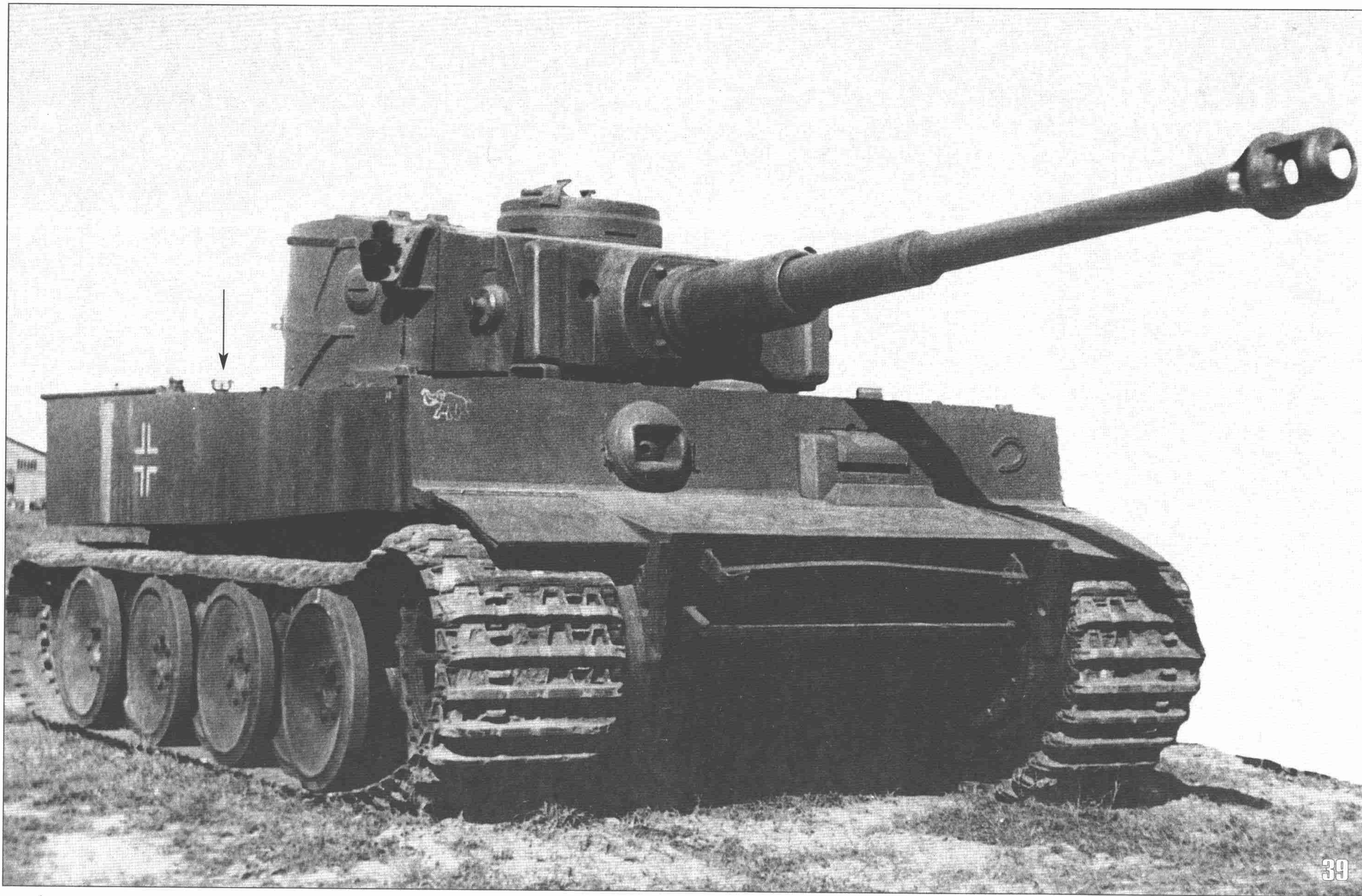
39. После экспонирования на выставке трофейной техники «Тигр» № 100 был доставлен на полигон в Кубинку. На этом фото видно, что у танка уже отсутствуют запасные траки на переднем листе корпуса. Стрелкой показана U-образная деталь на правом борту корпуса, предположительно служившая для крепления буксирного троса.
