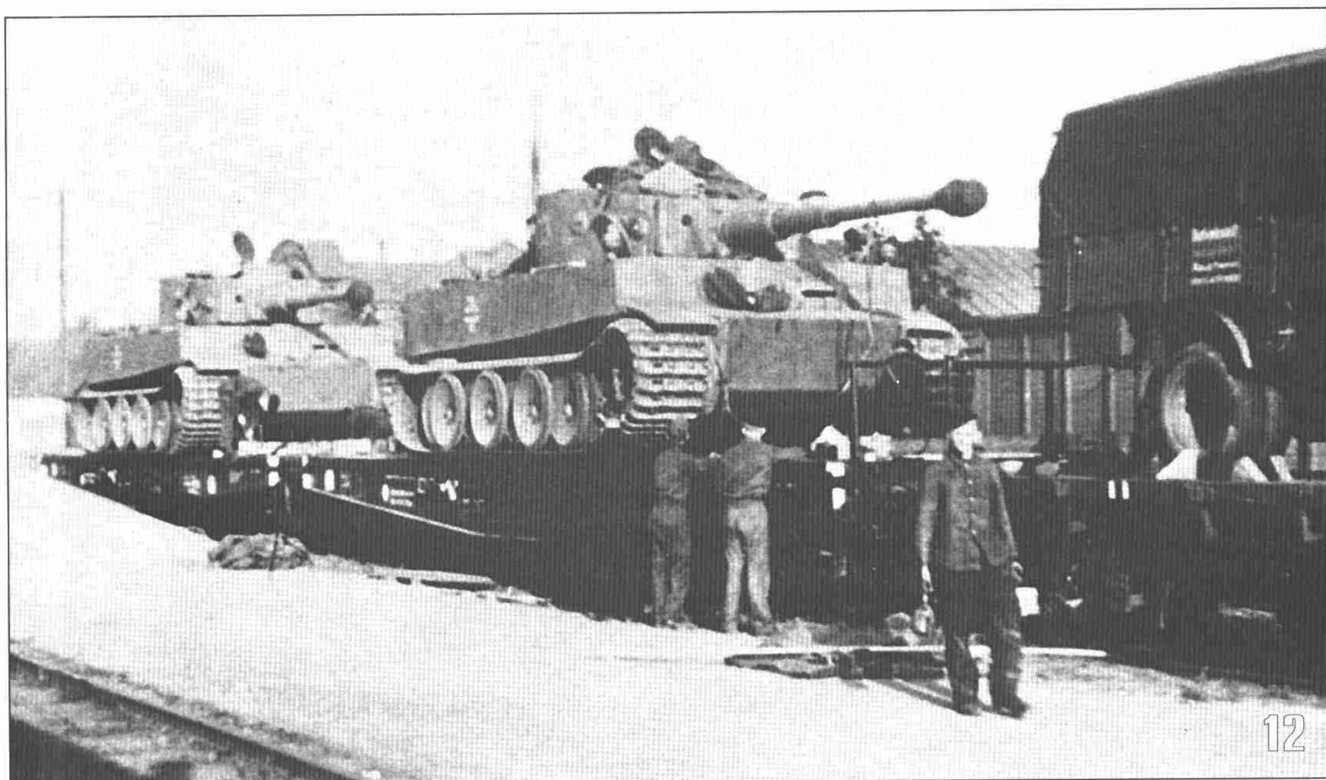
12. Эшелон с «тиграми» sPzAbt 502 на станции Мга. Сентябрь 1942 года. Танки перевозятся на боевых гусеницах шириной 725 мм.
