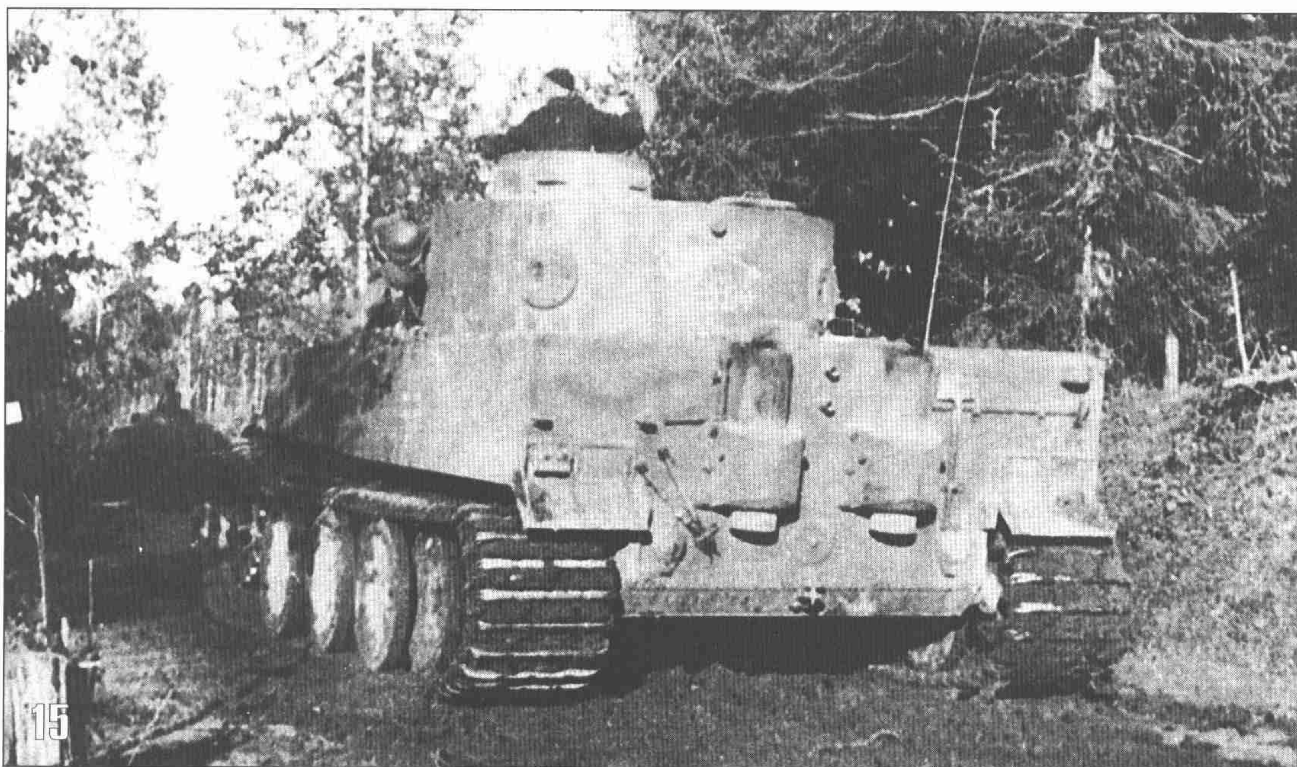
15. «Тигр» sPzAbt 502 с бортовым номером 111. Сентябрь 1942 года. На корме машины уже есть крепление для инструмента (ножницы для резки проволоки, лопата, лом), на задней части башни виден большой белый мамонт — эмблема батальона.
