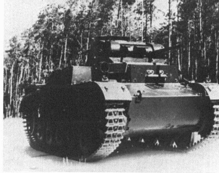
Der Panzer II mit schräger Bugplatte.
