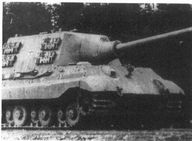
Dieser Jagdtiger hat im Sennelager zu Fahrversuchen die schmalere Verladekette aufgezogen.
