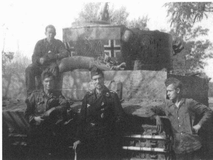
Auf dem Tiger 324 Uffz. Dolk, Gefr. Schade, unbekannt, unbekannt, 1943 in Snamenka. Der Turm ist auf 6Uhr gedreht und zeigt gut den Turmstaukasten mit der Fahrzeugnummer und doppeltem Balkenkreuz. (BB)
