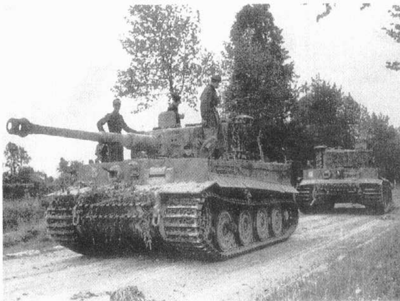
Tiger I mit dem „Spar-Laufrollen“-Fahrwerk (keine Gummibandagen) auf einer französischen Straße, Normandie 1944. Der hintere Tiger sichert mit Turm auf 6.00 Uhr.
