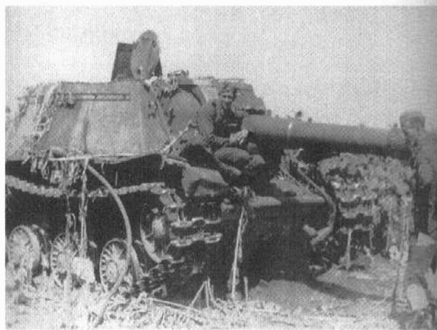
Das russische Sturmgeschütz SU-152 wurde ein ernster Gegner der Tiger-Panzer. Treffer von dem 15,2 cm-Geschütz konnte auch ein Tiger nur schwer verkraften. Hier wird ein erbeutetes Exemplar untersucht.
