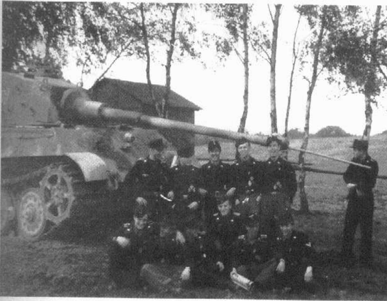
Ein Gruppenbild der 3./503 während einer Pause im Sennelager Okt.1944. Der Tiger II hat schmale Verladeketten aufgezogen um die breiteren Kampfketten zu schonen. (BB)
