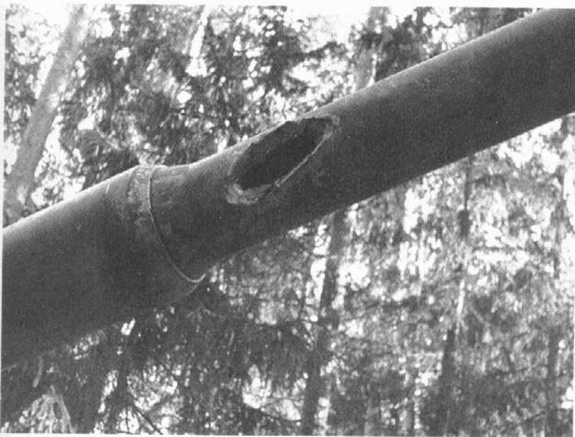
Seltener Zufallstreffer an einer 8,8cm-Tiger-Kanone. Das feindliche Geschoss traf schräg auf und schlitze eine Seite der Kanone auf.
