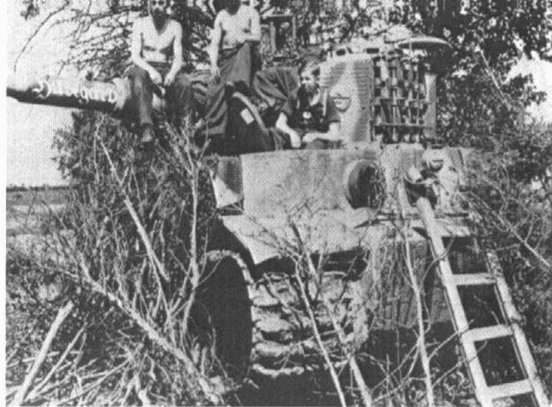
Im Einsatz gab es keine Leiter zum Einsteigen in den 2,88 m hohen Tiger.
