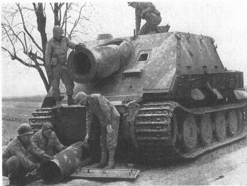
Einige Tiger I Schadpanzer wurden in sogenannte „Sturmiger“ umgebaut. Sie erhielten einen 38 cm-Raketenwerfer, der ursprünglich aus Marinebeständen kam. US-GI's bestaunen die riesige Raketen-Granate im Vordergrund des Sturmigers.
