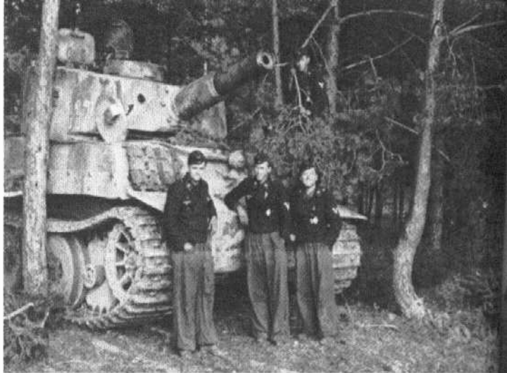
Rohrkrepierer beim Tiger 117 der 1./502.
