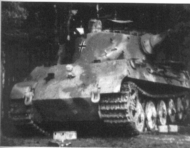
Unteroffizier Jaeckel auf seinem Tiger II im Sennelager, Sept/Okt.1944. Der Turm steht auf 10.00 Uhr, vor dem Tiger ein Patronenkasten mit MG-Munition. (BB)
