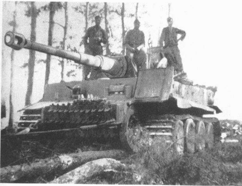
Dieser Tiger I wurde im Nordabschnitt der Ostfront von einer Granate am Triebbad getroffen. Um den Tiger weiterzubewegen, wurde die getroffene Seite der Kette gekürzt und nur mit einer Kette langsam zurückgesetzt.
