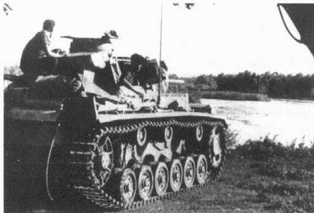
Der Panzer III mit 3,7cm-später 5cm-Kanone war als „mittlerer“ Panzer bis 1942 weitverbreitet. Seine Bewaffnung genügte jedoch schon lange nicht mehr.
