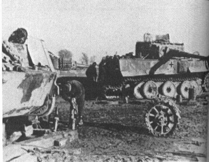
Der 2. Werkstattzug der sPzAbt. 507 hat das Triebrad abgebaut.
