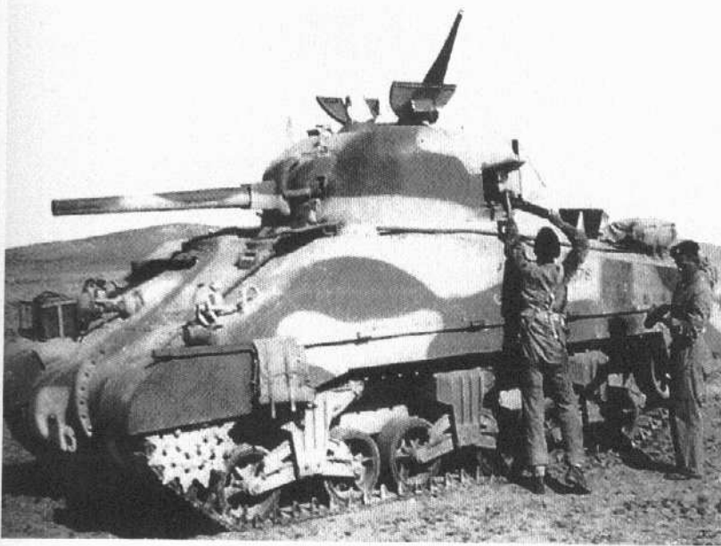
Der Sherman Panzer mit seiner 7,5cm-Kanone war einer der Standard-Panzer der alliierten Streitkräfte. In großen Verbänden auftretend, war er ein gefährlicher Gegner für die deutsche Panzerwaffe.
