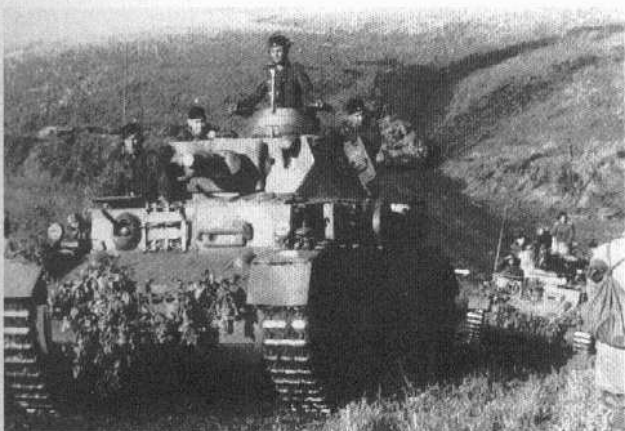
Der Panzer IV, mit kurzer 7,5cm-Kanone ausgestattet, war bis 1942 Deutschlands schwerster Panzer. Hauptargument für die kurzen Kanonen der Panzer war, daß auch im Ortskampf der Turm 360° drehbar sein mußte.
